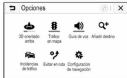
En función de la configuración anterior, el botón de la pantalla se etiqueta como **3D orientado arriba**, **2D orientado arriba** o **2D con Norte arriba**. La vista de mapa cambia en función del botón de pantalla.
