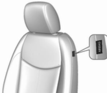
El sistema de airbag lateral consta de un airbag en cada uno de los respaldos de los asientos delanteros. La ubicación se puede identificar por el rótulo **AIRBAG**.
