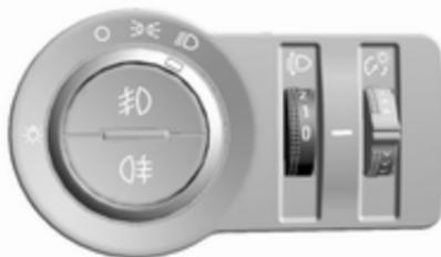
Para adaptar el alcance de los faros a la carga del vehículo y evitar el deslumbramiento: gire la rueda de ajuste
