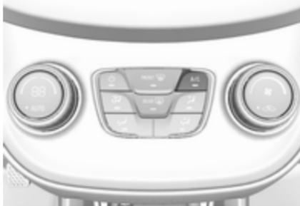
Pulse **A/C** para activar la refrigeración. El LED del botón se ilumina para indicar su activación. La refrigeración
