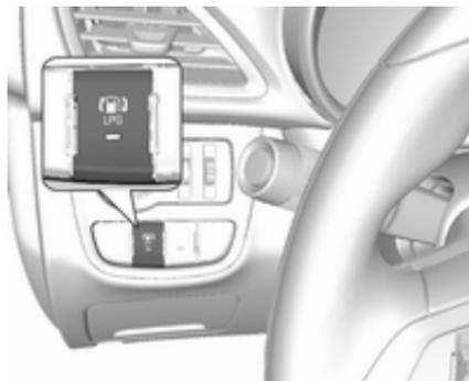
Pulse **LPG** para cambiar entre funcionamiento con gasolina y con gas licuado. El LED del botón muestra el modo de funcionamiento actual.
