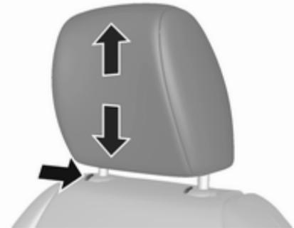
Pulse el botón de desbloqueo, ajuste la altura, enclave.
