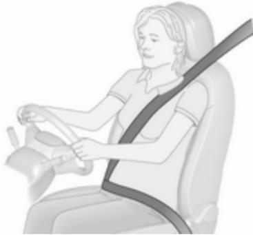
Al acelerar o frenar bruscamente el vehículo, los cinturones de seguridad se bloquean para sujetar a los ocupantes en la posición de asiento. De este modo se reduce considerablemente el riesgo de lesiones.
