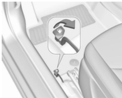
2. Tire de la palanca de desbloqueo de la tapa del depósito de combustible que está situada en el piso, en la parte delantera izquierda del asiento del conductor.
