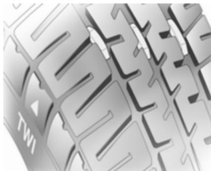
La profundidad mínima autorizada legalmente (1,6 mm) se ha alcanzado cuando el dibujo muestra un indicador de desgaste (TWI = Tread Wear
