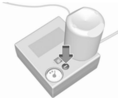
Si la presión prescrita no se alcanza en un plazo de diez minutos, desconecte el juego de reparación de neumáticos. Haga girar el neumático una vuelta completa. Vuelva a conectar el juego de reparación de neumáticos y continúe el proceso de inflado durante diez minutos. Si aún no se alcanza la presión prescrita, significa que el daño del neumático es demasiado grave. Recorra a la ayuda de un taller. Vacíe el exceso de presión de los neumáticos mediante el botón
