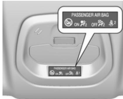
Testigo de control de desactivación del airbag ↗ 75.
