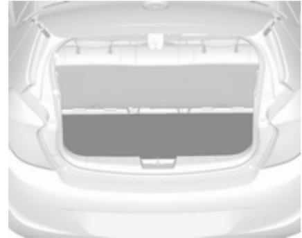
El juego de reparación de neumáticos está en la caja de herramientas, debajo de la cubierta del piso en el compartimento de carga.
