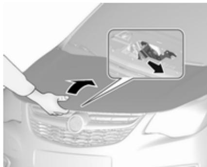
Mueva el cierre de seguridad hacia los lados, hacia el lateral izquierdo del vehículo y abra el capó.
