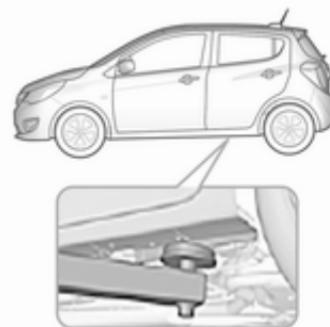
Posición del brazo trasero de la plataforma elevadora, ubicado centrado bajo el rebaje del estribo.
