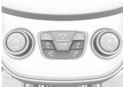
Pulse el botón apropiado para el ajuste deseado. La activación se indica mediante el LED del botón.
