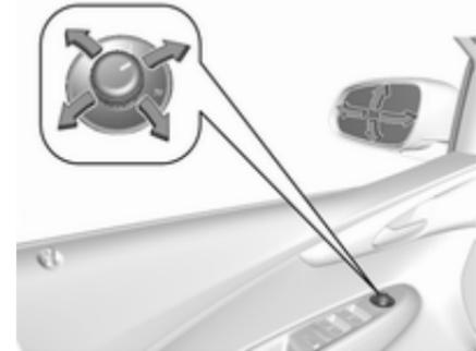
Seleccione el retrovisor exterior correspondiente girando el mando a la izquierda (L) o a la derecha (R). Luego bascule el mando para ajustar el retrovisor.
