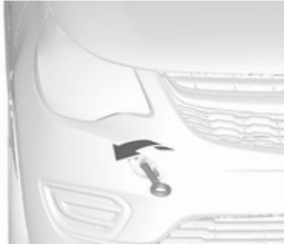
2. Enrosque la argolla de remolque todo lo posible hasta que quede en posición horizontal.
