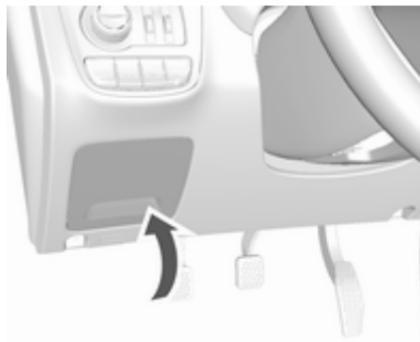
La caja de fusibles está situada en el lado del conductor detrás de una cubierta del tablero de instrumentos.
