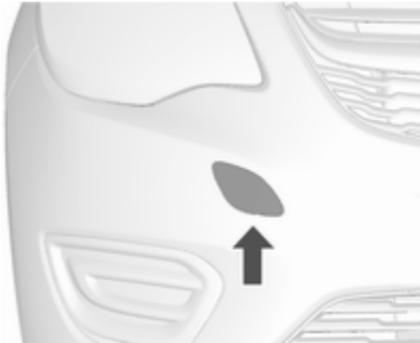
1. Desenclave la tapa usando el destornillador y desmóntela.
