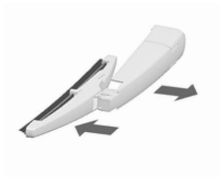
Levante el brazo del limpiaparabrisas. Presione la escobilla ligeramente inclinada respecto al brazo del limpiaparabrisas y empújela hasta que se desacople.
