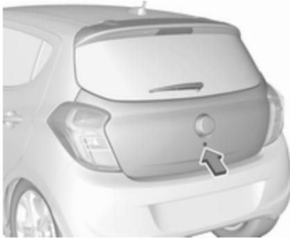
Para desbloquear el portón trasero, introduzca la llave en la cerradura y gírela hacia la izquierda hasta la posición horizontal. Levante el portón trasero para abrirlo.
