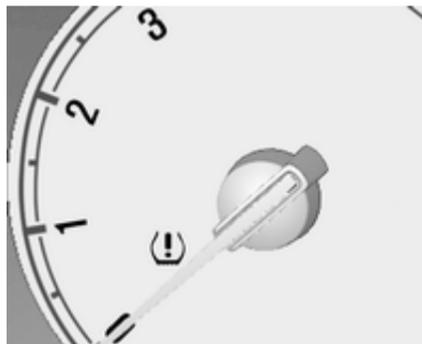
Si se detecta un problema de presión baja de los neumáticos, se indica mediante el testigo de control (⚠).
