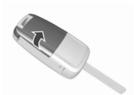
Despliegue la llave y abra la unidad lateralmente. Sustituya la pila (tipo CR 2032), prestando atención a la posición de montaje. Cierre la unidad y sincronice el mando a distancia.
