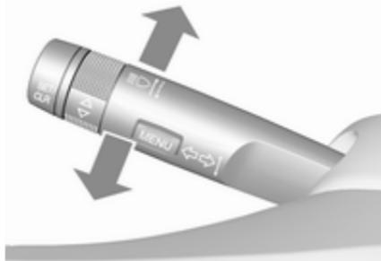
Para cambiar de luz de cruce a luz de carretera, pulse la palanca.
