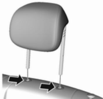
Presione los dos fiadores, tire del reposacabezas hacia arriba y desmóntelo.
