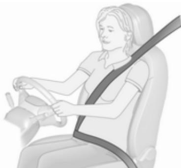
Extraiga el cinturón de seguridad y abroche en el cierre. El cinturón de seguridad no debe estar retorcido y debe quedar bien ajustado al cuerpo. El respaldo no debe estar demasiado inclinado hacia atrás (máximo aprox. 25°).
