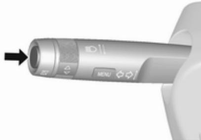
Pulse **SET/CLR** para seleccionar una función o para confirmar un mensaje. Los mensajes del vehículo y servicio son emergentes en el centro de información del conductor si es necesario. Confirme mensajes pulsando **SET/CLR**. Mensajes del vehículo ⇨ 86.
