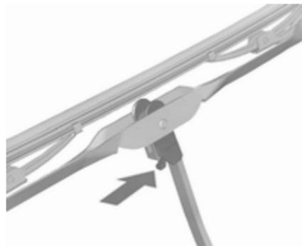
Levante el brazo del limpiaparabrisas. Pulse la palanca de desbloqueo y desacople la escobilla.
