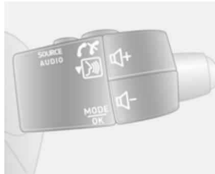
El sistema de infoentretenimiento se puede manejar con los mandos en la columna de la dirección.
