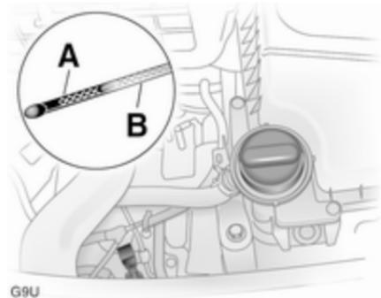
Si el nivel de aceite del motor está por debajo de la marca de "añadir aceite" (A), rellene el aceite del motor.
