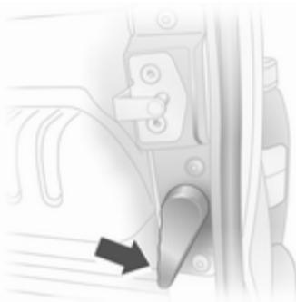
La puerta trasera derecha se desbloquea utilizando la palanca.
