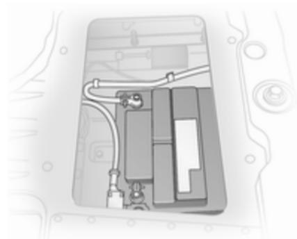
Desmonte la cubierta para acceder a la batería.
