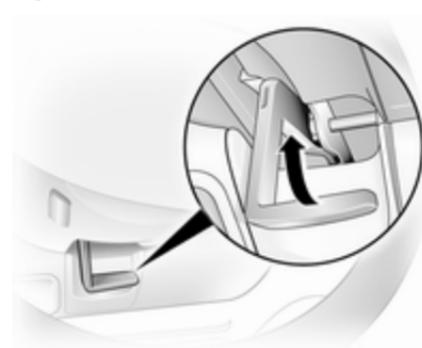
Desbloquee la palanca, ajuste el volante, luego enclave la palanca y asegúrese de que esté totalmente bloqueada.
