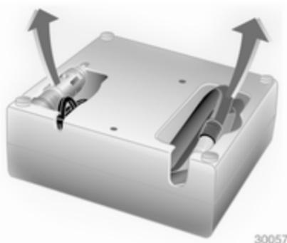
1. Desmonte el compresor del juego de reparación de neumáticos.
