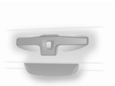
Después de desbloquear con el mando a distancia, pulse el botón y suba el portón trasero hasta la posición totalmente abierta.
