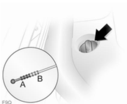
En los motores F9Q, la varilla de medición va montada en el tapón de llenado de aceite, que debe girarse en sentido antihorario para abrirlo.
