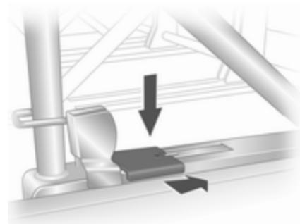
Suelte los asientos presionando hacia abajo y deslizando hacia delante el gancho de bloqueo, que está situado en los soportes derecho e izquierdo del asiento.
