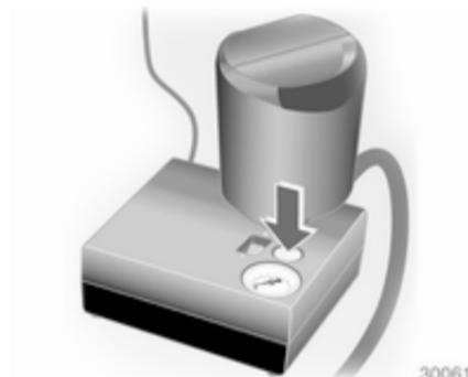
9. Ponga el interruptor basculante del compresor en I. El neumático se llenará con el sellador.
