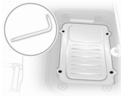
La batería está situada debajo del panel del piso del asiento delantero izquierdo. Levante el revestimiento del piso y utilice la herramienta incluida en el juego de herramientas (o en el juego de reparación de neumáticos) para aflojar los 4 tornillos.
