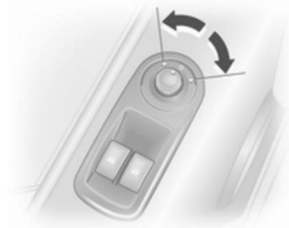
Seleccione el retrovisor exterior relevante girando el mando hacia la izquierda o la derecha. En la posición central no hay seleccionado ningún retrovisor.
