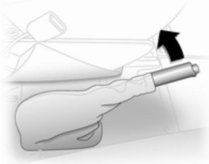
Accione siempre el freno de estacionamiento firmemente sin pulsar el botón de desbloqueo; en pendientes, accione el freno de mano con toda la firmeza posible.
