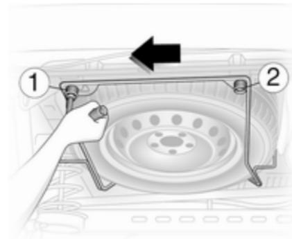
La rueda de repuesto va montada en la parte trasera de los bajos y puede estar sujeta con un tornillo de seguridad que sólo se puede desmontar con la herramienta que se suministra.
