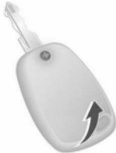
Desmonte el tornillo y abra el compartimento de la pila insertando una moneda en la ranura y girándola.
