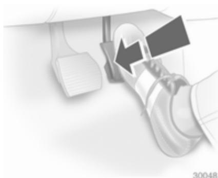
Si se pisa a fondo el acelerador, sobrepasando el punto de presión, se cambia a una marcha más corta dependiendo del régimen del motor. Toda la potencia del motor estará disponible para acelerar.
