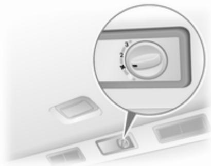
El caudal de aire está determinado por el ventilador. La temperatura del aire se controla usando el mando de la temperatura en el tablero de instrumentos.
