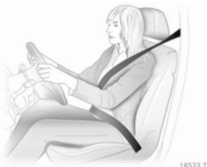
Extraiga el cinturón de seguridad y enclávelo en el cierre. El cinturón de seguridad no debe estar retorcido y debe quedar bien ajustado al cuerpo. El respaldo no debe estar demasiado inclinado hacia atrás (máximo aprox. 25°).
