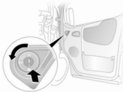
El sistema de airbags del acompañante se puede desactivar mediante un interruptor situado en la puerta del acompañante.
