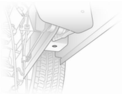
3. Levante el vehículo colocando el puntal almohadillado de elevación del gato debajo del orificio situado más cerca de la rueda afectada. Asegúrese de que el gato esté correctamente colocado. Ajuste la altura necesaria del gato antes de colocarlo debajo del orificio, de modo que no pueda resbalar.
