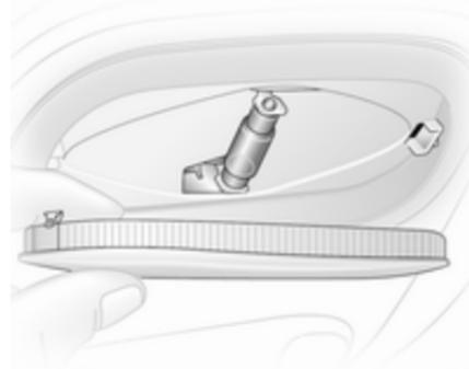
1. Desmonte la lente con un destornillador de punta plana.
