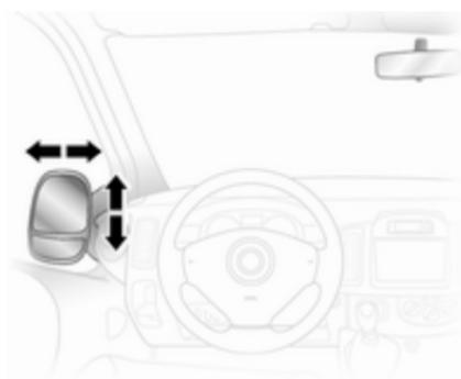
Ajuste los retrovisores basculando la palanca en la dirección requerida.
