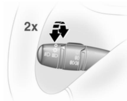
Con el motor en marcha, se conectan los faros en condiciones de poca luz exterior.
