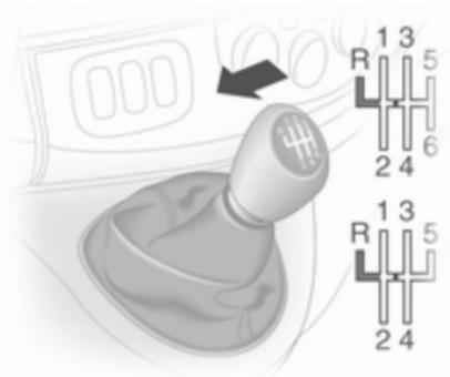
Marcha atrás: con el vehículo parado, espere 3 segundos después de pisar el pedal de embrague y levante el anillo de la palanca selectora y engrane la marcha.
