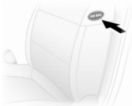
El sistema de airbags laterales se compone de un airbag en cada respaldo de los asientos delanteros. Se puede identificar por la palabra **AIRBAG**.
