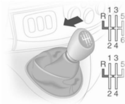
Para engranar la marcha atrás, con el vehículo parado pise el pedal de embrague, levante el anillo de la palanca selectora y engrane la marcha superando la resistencia.
