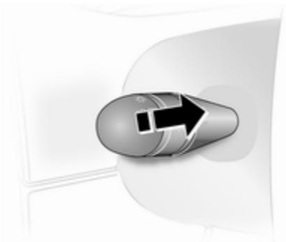
Para cambiar entre luz de cruce y de carretera, tire de la palanca hasta percibir un clic.
