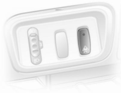
Si se requiere que las ruedas motrices patinen, puede desactivarse el ESP®Plus.
