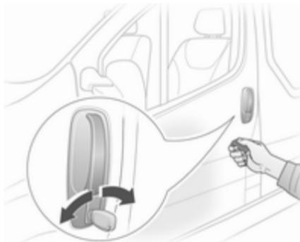
Gire la llave en la cerradura de la puerta del conductor. Abra las puertas tirando de la manilla correspondiente.
