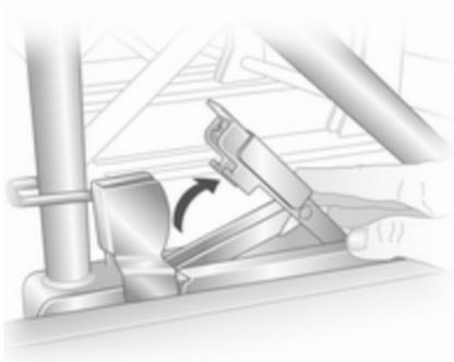
Con ambos ganchos levantados, empuje el asiento hacia atrás y suéltelo de los puntos de anclaje del piso. A continuación, puede levantar y sacar el asiento del vehículo.
