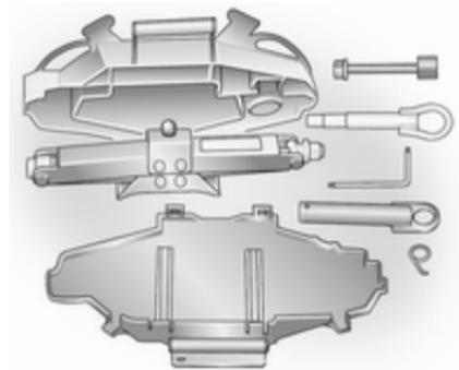
El gato, los adaptadores, la llave de carraca, la llave torx, el gancho para los tapacubos, la argolla de remolque y la herramienta de seguridad de la rueda de repuesto van dentro de una unidad, que se guarda debajo del asiento del conductor.
