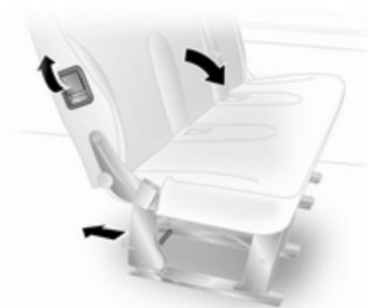
Desmonte los reposacabezas ↻ 32. Tire de la manilla lateral para desbloquear el respaldo y abátalo sobre la banqueta del asiento; si fuera necesario, suelte los cinturones de seguridad de dos lengüetas de sus cierres.
