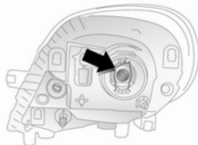
1. Desmonte el conector del mazo de cables.
