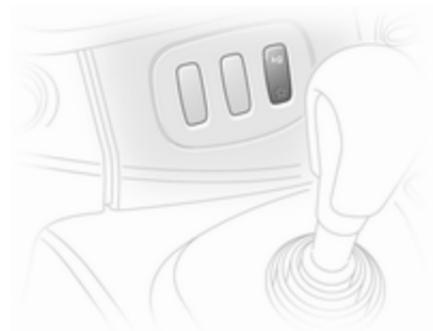
El modo de carga se puede utilizar tanto en modo automático como manual. En ambos casos, las relaciones del cambio de marchas se adaptan automáticamente al transporte de una mayor carga útil.
