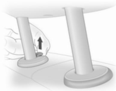
Para desmontar los reposacabezas, tire de la lengüeta de bloqueo y tire del reposacabezas hacia arriba.
