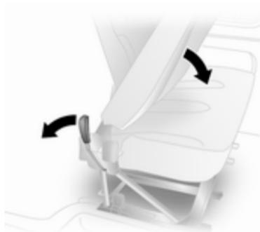
Para facilitar el acceso a los asientos traseros, abata el respaldo del asiento hacia delante. Si fuera necesario, suelte el cinturón de seguridad de dos lengüetas de sus cierres.
