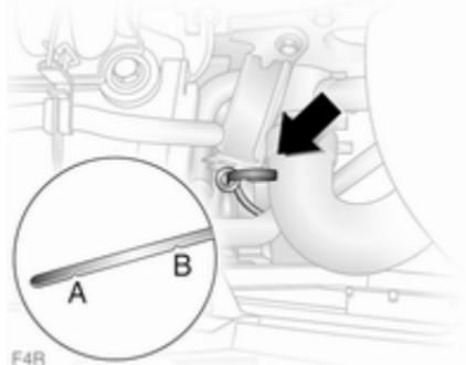
Se utilizan distintos tipos de varilla de medición del aceite, según el tipo de motor. Las ilustraciones muestran la comprobación y reposición de aceite en los motores de gasolina y diésel, respectivamente.
