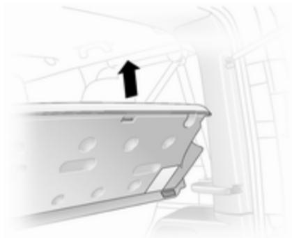
Levante la cubierta y sáquela de las guías laterales.
