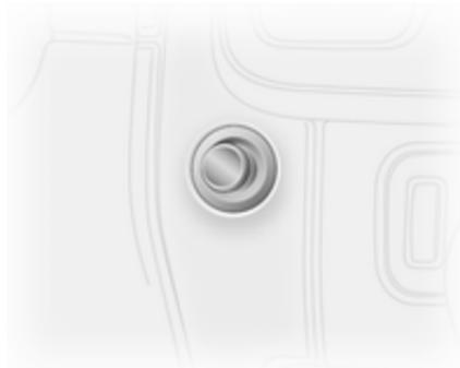
Hay tomas de corriente de 12 V situadas en el tablero de instrumentos y en la parte trasera del vehículo.
