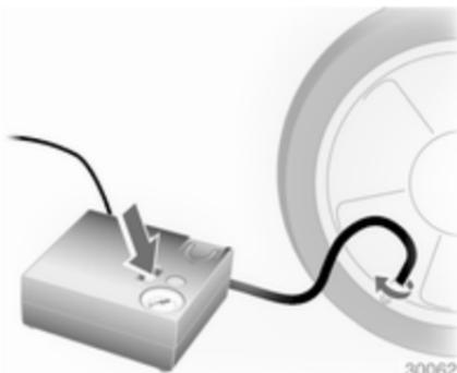
16. Continúe la marcha inmediatamente para que el sellador se distribuya uniformemente por todo el neumático. Después de conducir unos 10 km (no más de 10 minutos), pare y compruebe la presión del neumático usando el compresor. Para ello, conecte directamente el tubo flexible de aire a la válvula del neumático y al compresor.
