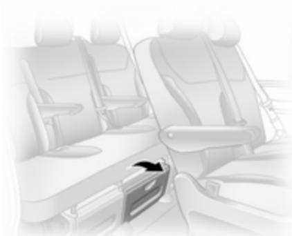
Para facilitar el alojamiento de objetos largos debajo de los asientos, la cubierta de revestimiento del asiento central se puede desenganchar.
