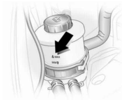
Si el nivel del líquido en el depósito desciende por debajo de la marca **MIN**, recorra a un taller.
