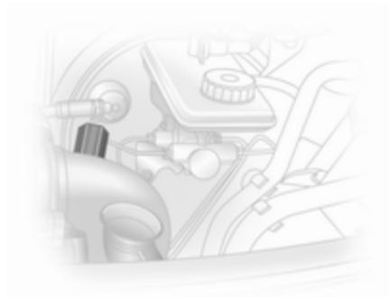
En determinados modelos hay un indicador situado en el sistema de admisión del motor que indica si la admisión de aire está restringida.
