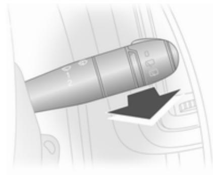
Tire de la palanca. Se pulveriza líquido de lavado sobre el parabrisas.
