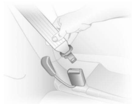
Antes de montar el cinturón, inserte la lengüeta inferior en el cierre de la parte exterior del asiento.
