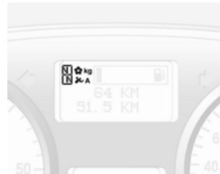
La marcha o el modo seleccionado del cambio manual automatizado se muestra en el centro de información del conductor.
