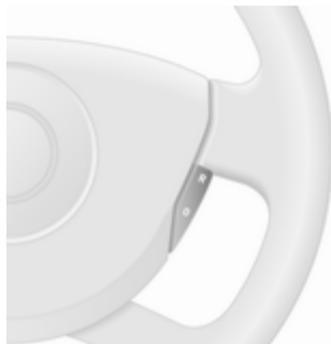
Pulse el interruptor **O**: el regulador de velocidad se desactiva y el testigo de control
