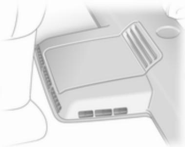
El ventilador de la calefacción trasera ayuda a distribuir el flujo de aire hacia la parte trasera del habitáculo a través de las salidas de ventilación traseras.
