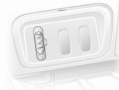
Adapte el alcance de los faros a la carga del vehículo para evitar el deslumbramiento de los vehículos que vienen de frente.
