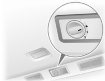
El ventilador del aire acondicionado trasero ayuda a distribuir el flujo de aire hacia la parte trasera del habitáculo a través de las salidas de ventilación traseras.
