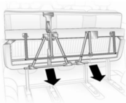
Para devolver el asiento abatible a la posición vertical, sujete el conjunto del asiento y suelte la barra tirando de ella hacia usted.
