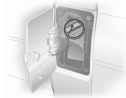
Para desbloquear y abrir el tapón del depósito, inserte la llave y gírela en sentido antihorario. Cuando haya repostado, vuelva a colocar el tapón y gire la llave en sentido horario hasta el tope.
