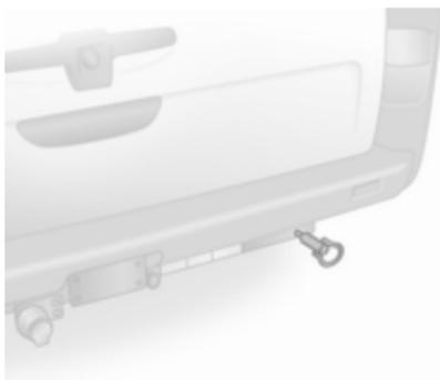
Los vehículos con enganche de remolque, tienen un alojamiento para la argolla de remolque desmontable. Enrosque la argolla de remolque, incluida en las herramientas del vehículo, hasta el fondo en el alojamiento.
