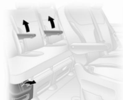
Cuando pliegue o desmonte el asiento trasero, asegúrese de que los reposabrazos estén replegados en posición vertical.
