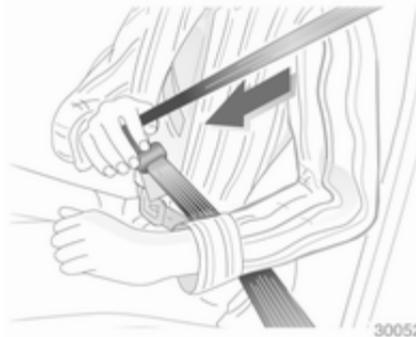
Extraiga el cinturón del retractor, guíelo por encima del cuerpo sin retorcerlo e inserte la lengüeta en el cierre. Durante el viaje, tense frecuentemente el cinturón abdominal tirando suavemente de la banda torácica.
