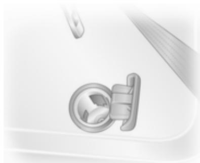
Si se conectan accesorios eléctricos con el motor parado, se descargará la batería. El consumo máximo no debe superar los 120 vatios. No conecte accesorios de suministro de corriente, como pueden ser dispositivos de carga eléctrica o baterías.
