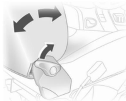
Tire de la palanca, ajuste la inclinación y suelte la palanca. Deje que el respaldo enclave audiblemente.
