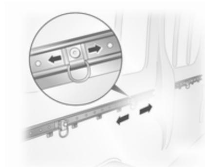
Los raíles de anclaje de la carga montados en el compartimento de carga ofrecen puntos de anclaje para asegurar la carga.
