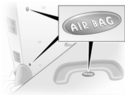
El sistema de airbags de cortina se compone de un airbag en el marco del techo a cada lado. Se puede identificar por la palabra **AIRBAG** en el revestimiento del techo.
