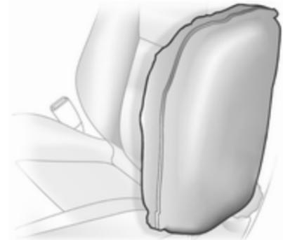
Los airbags inflados amortiguan el impacto, reduciendo considerablemente el riesgo de lesiones en la parte superior del cuerpo y la pelvis en caso de una colisión lateral.
