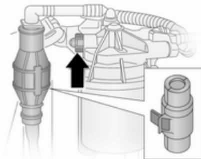
Si se ha agotado el depósito, hay que purgar el aire del sistema de combustible diésel.
