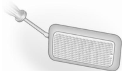
1. Desmonte el grupo óptico con un destornillador de punta plana.
