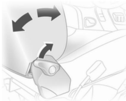
Tire de la palanca, ajuste la inclinación y suelte la palanca. Deje que el asiento se enclave. No se apoye en el respaldo mientras lo ajusta.
