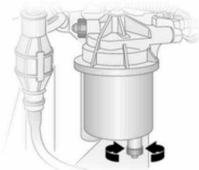
Purgue el agua residual del filtro de combustible diésel en cada cambio de aceite del motor.
