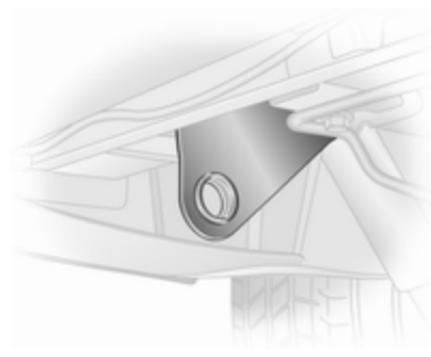
La argolla de remolque fija está situada debajo del parachoques trasero.
