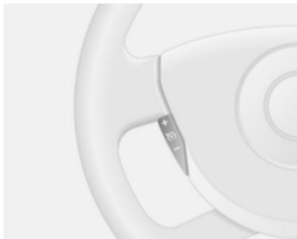
Acelere hasta la velocidad deseada y pulse el interruptor **+** o **-**. La velocidad actual queda memorizada y se mantiene, se puede dejar de pisar el pedal del acelerador.
