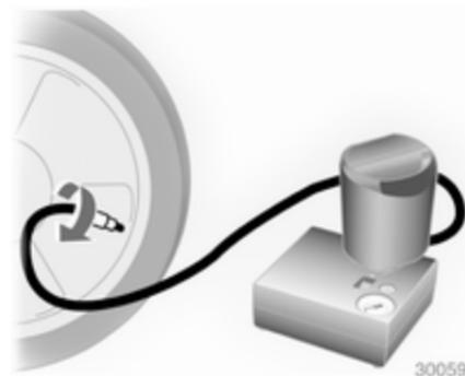
6. Enrosque el tubo flexible de llenado a la válvula del neumático.
