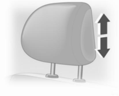
Tire hacia arriba del reposacabezas o empuje el reposacabezas hacia abajo.
