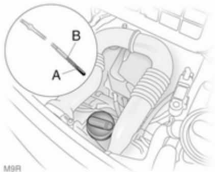
En los motores M9R, gire el tapón en sentido antihorario, saque la varilla de medición, límpiela con un trapo y vuelva a introducirla hasta el fondo.
