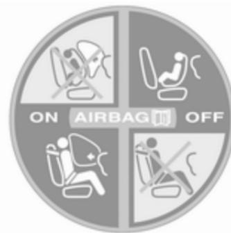
El sistema para desactivar los airbags del asiento del acompañante se indica mediante una etiqueta en el lateral del tablero de instrumentos, visible cuando la puerta del acompañante está abierta.
