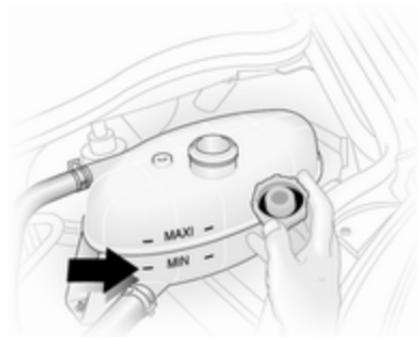
Con el sistema de refrigeración frío, el nivel del refrigerante debería estar justo por encima de la marca **MIN**. Rellene si el nivel es más bajo.
