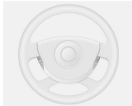
El regulador de velocidad y el limitador de velocidad se pueden manejar con los mandos en el volante.
