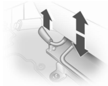
Levante la palanca y ajuste el peso del cuerpo sobre el asiento para subirlo o bajarlo.
