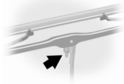
Levante el brazo del limpiaparabrisas, empuje el clip de sujeción hacia el brazo y desacople la escobilla.
