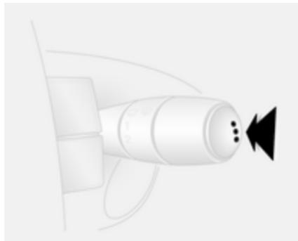
Las funciones se pueden seleccionar pulsando repetidamente el botón situado en el extremo de la palanca del limpiaparabrisas.
