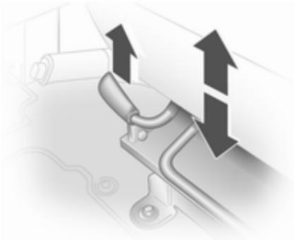
Levante la palanca y ajuste el peso del cuerpo sobre el asiento para regular la altura.
