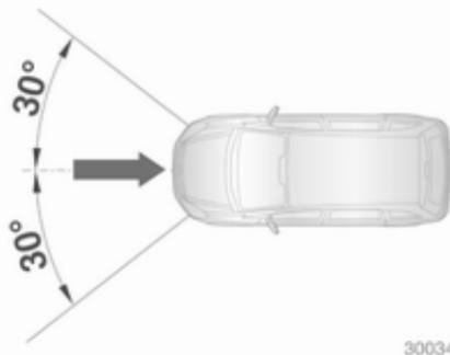
El sistema de airbags frontales se activa en caso de choque de una determinada gravedad en el sector indicado. El encendido debe estar conectado.
