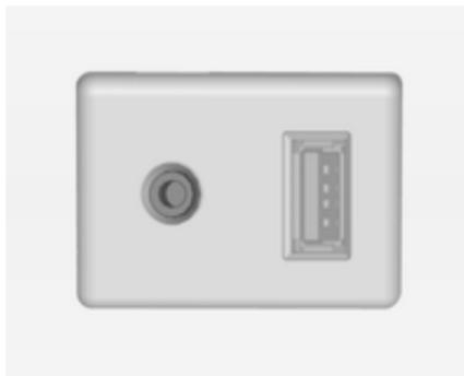
Dans la console centrale, sous les commandes de climatisation et sur le panneau de commande de l'Infotainment System, se trouve des entrées AUX permettant la connexion de sources audio externes.
