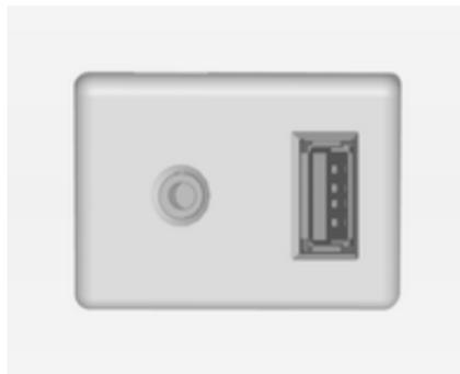
Dans la console centrale, sous les commandes de climatisation, se trouve une prise USB permettant la connexion de sources de données audio externes.
