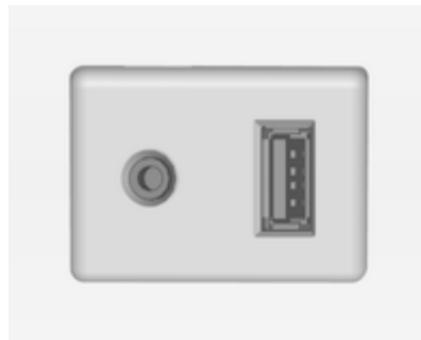
Dans la console centrale, sous les commandes de climatisation, figurent une prise AUX et une prise USB pour la connexion de sources de données audio externes.
