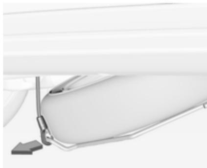
6. Soulever un peu le support de roue de secours à la main et détacher le câble de sécurité.
