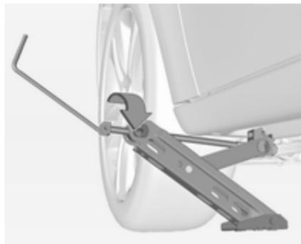
Attacher la manivelle de cric, aligner correctement le cric et tourner la manivelle jusqu'à ce que la roue ait quitté le sol.
