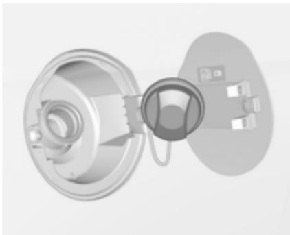
Le bouchon de remplissage peut être déposé dans le support sur la trappe à carburant.
