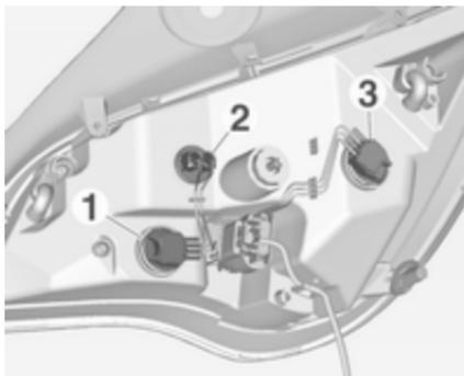
4. Tourner la douille d'ampoule dans le sens anti-horaire et retirer. Remplacer l'ampoule en retirant les éléments suivants :
