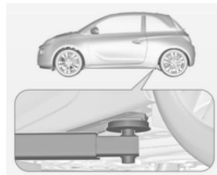
Positionner le bras arrière du pont élévateur centrée sous le creux du seuil.
