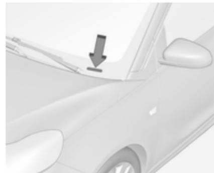
Le numéro d'identification du véhicule peut être estampé sur le tableau de bord et il est alors visible à travers le pare-brise.
