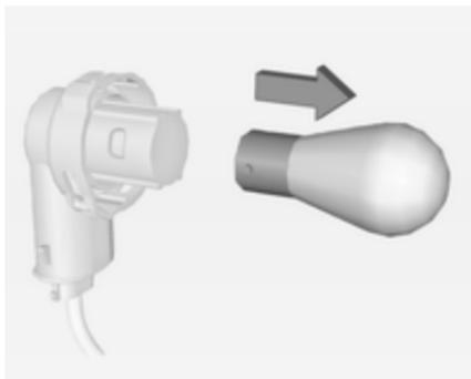
5. Retirer l'ampoule en tournant légèrement dans le sens anti-horaire, puis en la retirant. Remplacer l'ampoule.
