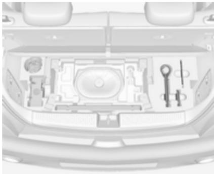
Sur les versions avec caisson de basse, les outils et l'œillet de remorquage se trouvent avec le kit de réparation des pneus et le triangle de présignalisation dans la boîte sous le tapis de sol. Pour accéder, retirer tout d'abord le tapis de sol : plier la partie arrière vers l'avant et tirer le tapis vers l'arrière ↪ 69.
