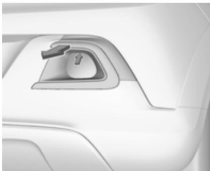
1. Déposer le cache en tirant avec le doigt sur la position indiquée, voir la flèche sur le graphique.
