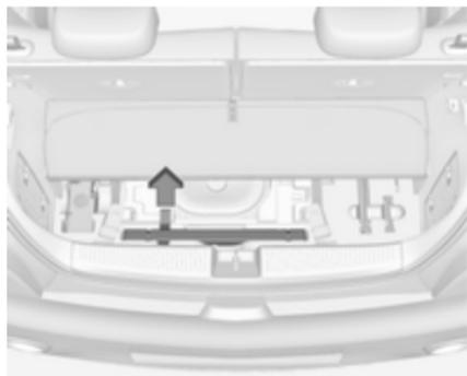
Soulever la partie arrière du recouvrement de plancher. Tirer sur la poignée pour retirer le triangle de présignalisation.
