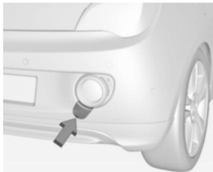
Insérer un tournevis dans la fente sur la partie basse courbe du capuchon. Désengager le capuchon en enfouissant avec précaution le tournevis vers le bas.
