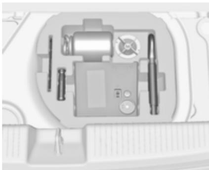
Certains outils et l'oeillet de remorquage sont rangés avec le kit de réparation des pneus dans une boîte à outils dans le coffre sous le recouvrement de plancher. Sur les versions avec une boîte de rangement, déposer tout d'abord la boîte ↪ 68.
