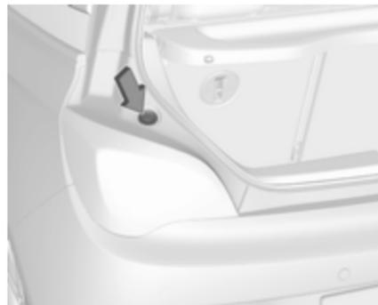
Monter l'ensemble du feu avec les goupilles de retenue dans les renforcements de la carrosserie du véhicule et visser l'écrou de fixation par l'intérieur du coffre. Tirer le joint circulaire au-dessus du logement dans le boîtier de phare.
