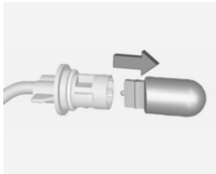
3. Tirer sur l'ampoule pour la sortir de la douille et la remplacer.
