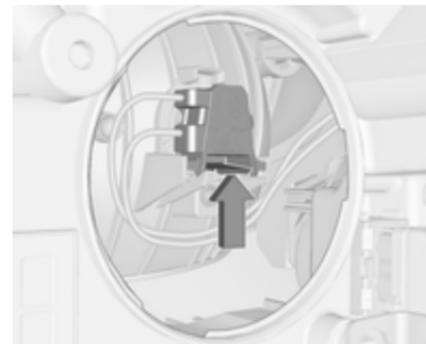
2. Appuyer sur l'attache pour désengager la douille. Retirer la douille de l'ampoule du réflecteur.
