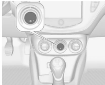
Appuyer sur le bouton
