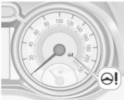
En cas de défaillance dans le système,  $\triangle!$  s'allume et un message est affiché sur le centre d'informations du conducteur.
