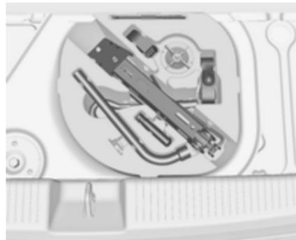
Le cric, la clé de roue, les outils et deux sangles de retenue de la roue endommagée se trouvent dans la boîte à outils sous le tapis de sol du coffre ↪ 69.
