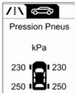
Tourner la molette pour sélectionner le système de surveillance de la pression des pneus.
