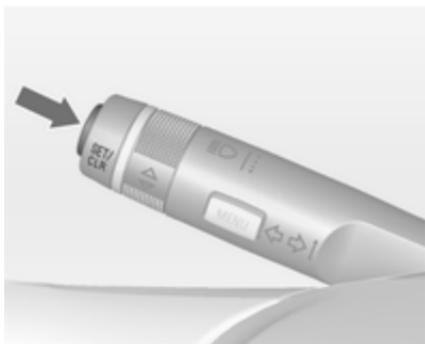
Sélectionner une place de stationnement parallèle ou perpendiculaire dans le centre d'informations du conducteur en appuyant sur le bouton SET/CLR.
