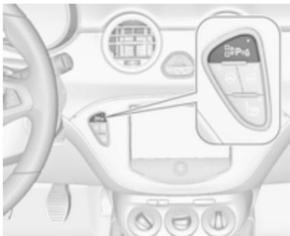
L'aide au stationnement avant-arrière et le système avancé d'assistance au stationnement utilisent tous les deux le même bouton pour l'activation et la désactivation :
