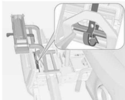
4. Passer la sangle attachée à l'adaptateur sous le levier pour la faire revenir sur le système de transport arrière. Attacher la sangle.
