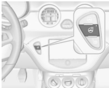
Activer le chauffage en appuyant sur le bouton
