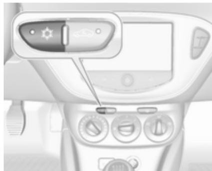
Appuyer sur le bouton
