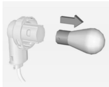
4. Retirer l'ampoule en tournant légèrement dans le sens anti-horaire, puis en la retirant. Remplacer l'ampoule.
