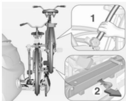
Maintenir le cadre (1) du vélo à l'arrière avec une main et tirer sur la boucle (2) pour la désengager.
