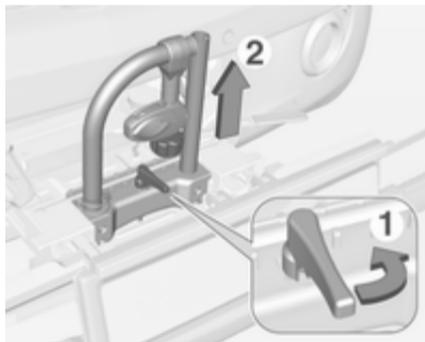
Disposer l'étrier de fixation conformément à l'illustration.
