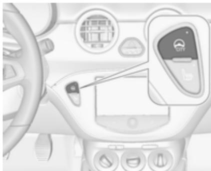
Appuyer sur le bouton
