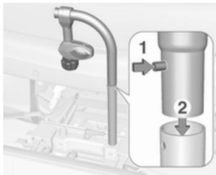
Appuyer sur le bouton (1) et insérer la partie gauche de la galerie dans la partie droite (2).
