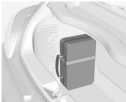
Sur les versions avec un système de transport arrière ou un moteur à gaz liquide, le kit de réparation des pneus se trouve dans une valise fixée avec une sangle sur la paroi latérale gauche du coffre.
