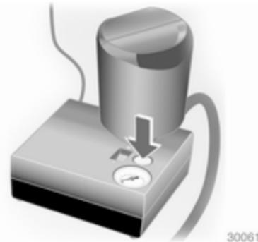
Si la pression de pneu prescrite n'est pas atteinte dans les 10 minutes, démonter le kit de réparation de pneus. Avancer ou reculer le véhicule d'un tour de roue. Brancher à nouveau le kit de réparation de pneus et poursuivre la procédure de remplissage pendant 10 minutes. Si la pression de gonflage prescrite n'est toujours pas atteinte, c'est que le pneu est trop fortement endommagé. Prendre contact avec un atelier.
