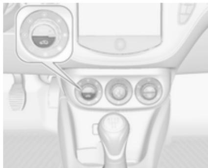
Appuyer sur le bouton
