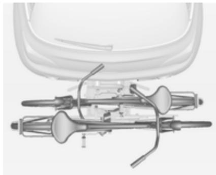
2. Positionner les vélos sur le système de transport arrière en les alignant en alternance vers la gauche ou la droite.
