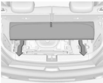
Sur les versions avec un caisson de graves extrêmes, le kit de réparation des pneus se trouve sous le tapis de sol du coffre. Pour utiliser le kit de réparation des pneus, retirer tout d'abord le tapis de sol : plier la partie arrière vers l'avant et tirer le tapis vers l'arrière ↗ 69.
