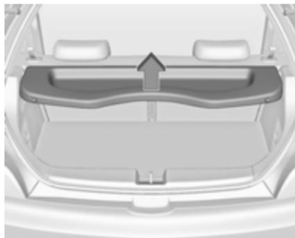
Soulever le couvercle à l'arrière. Il s'engage alors dans une position quasi-verticale. Une ouverture supérieure est possible. Pour fermer, abaisser le couvercle au-delà du point d'enclenchement.
