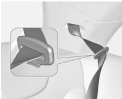
Insérer le verrou plat de la ceinture de sécurité dans le support latéral pour protéger la ceinture des dommages.
