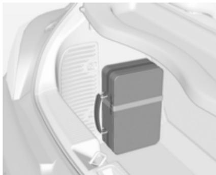
Sur les versions avec un système de transport arrière ou un moteur à gaz liquide, les outils se trouvent avec l'oeillet de remorquage et le kit de réparation des pneus, dans une valise fixée avec une sangle sur la paroi gauche du coffre.
