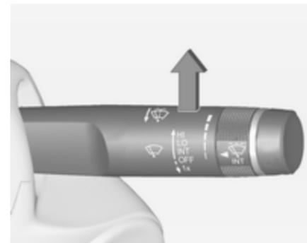
**INT** = Balayage automatique avec capteur de pluie
