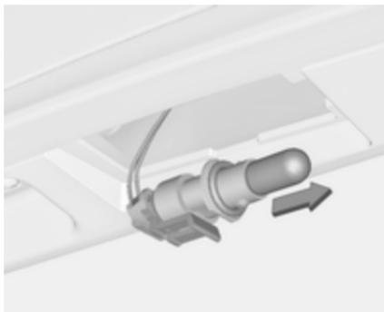
3. Retirer la douille du boîtier de phare en tournant dans le sens anti-horaire.
