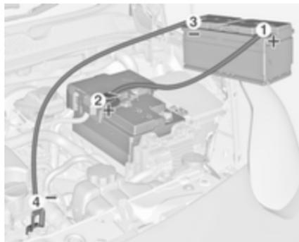
Séquence de raccordement des câbles :
