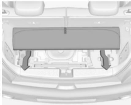
Déposer le recouvrement du plancher pour accéder aux équipements de dépannage d'urgence ainsi que pour remplacer les ampoules des feux arrière :
