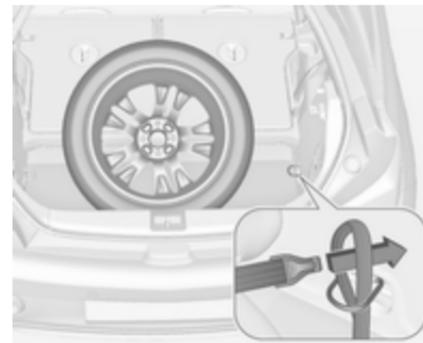
4. Sortir la sangle **1** et placer l'extrémité de boucle de la sangle dans l'anneau d'arrimage de droite.
