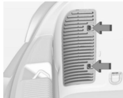
1. Détacher le capot sur le côté concerné et déposer.
