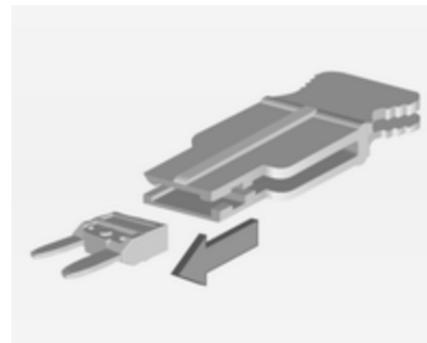
Placer la pince à fusibles par le haut sur les différents types de fusibles et retirer le fusible.
