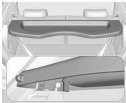
Pousser le couvercle vers le haut des côtés gauche et droit depuis le côté inférieur et déposer.
