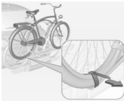
5. De plus, attacher les deux roues du vélo à l'arrière aux logements de roue en utilisant les sangles de serrage.
