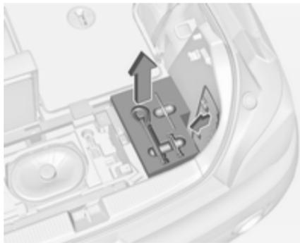
Pour accéder au recouvrement droit du coffre, par exemple pour le remplacement des ampoules, rabattre le dossier arrière droit et sortir la boîte à outils à côté du caisson de basse.
