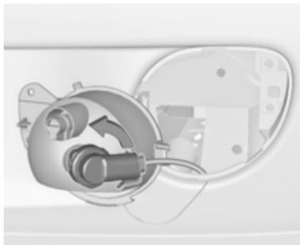
3. Désengager et retirer la douille en tournant dans le sens anti-horaire.
