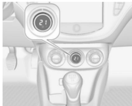
Si la température minimale **Lo** est réglée, le système de commande de climatisation fonctionne avec sa capacité maximale de refroidissement, si le refroidissement
