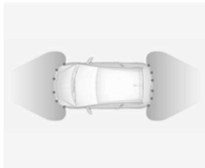
Le système avancé d'assistance au stationnement est toujours associé à l'aide au stationnement avant-arrière. Voir la section précédente. Les deux systèmes utilisent les mêmes capteurs sur les pare-chocs avant et arrière.
