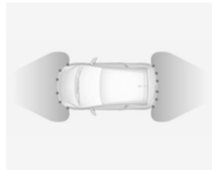
Le système possède six capteurs de stationnement à ultrasons disposés dans les pare-chocs arrière et avant.
