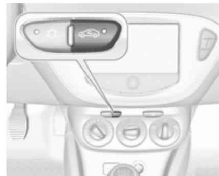
Appuyer sur le bouton pour activer le mode de recyclage de l'air. L'activation est signalée par la LED dans le bouton.
