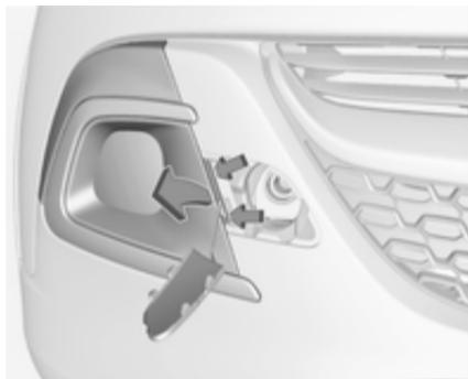
2. Déposer le cache en tirant avec les doigts sur les positions indiquées, voir les flèches sur l'illustration.
