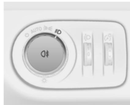
Pour les enclencher, appuyer sur
