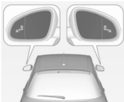
L'alerte d'angle mort latéral est activée lorsque le véhicule roule à des vitesses allant de 10 km/h à 140 km/h. Conduire à une vitesse supérieure à 140 km/h désactive le système, ce qui est indiqué par les symboles d'avertissement à faible luminosité  $\text{R}^{\text{B}}$  sur les deux rétroviseurs extérieurs. Ralentir à nouveau éteindra les symboles d'avertissement. Si un véhicule est alors détecté dans la zone d'angle
