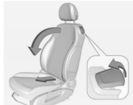
Tirer la poignée de déverrouillage vers l'avant et plier le dossier vers l'avant. Glisser ensuite le siège vers l'avant jusqu'à ce qu'il soit bloqué.
