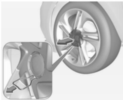
1.1. Insérer la pince dans la fente ouverte du capuchon central et retirer le capuchon de la jante. Outil de bord ↻ 196.
