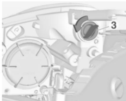
1. Faire tourner la douille de l'ampoule (3) dans le sens antihoraire pour la désencliqueter. Retirer la douille de l'ampoule du boîtier de phare.
