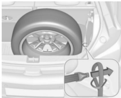
4. Retirer la sangle 1 de la boîte à outils et placer l'extrémité de boucle de la sangle dans l'anneau d'arrimage de droite.
