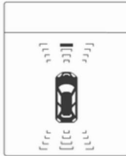
La distance par rapport à un obstacle avant ou arrière est indiquée par un changement des lignes de distance au niveau du centre d'informations du conducteur.
