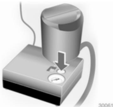
Si la pression des pneus prescrite n'est pas atteinte dans les dix minutes, démonter le kit de réparation de pneus. Avancer ou reculer le véhicule d'un tour de roue. Brancher à nouveau le kit de réparation des pneus et poursuivre la procédure de remplissage pen-
