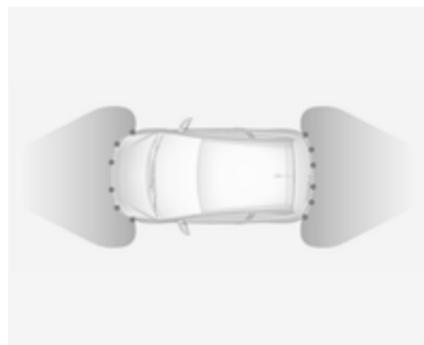
Le système avancé d'assistance au stationnement est toujours associé à l'aide au stationnement avant-arrière.
