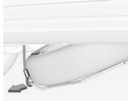
6. Soulever un peu le support de roue de secours à la main et détacher le câble de sécurité.
