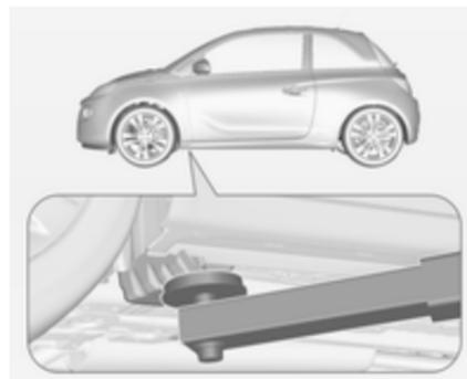
Positionner le bras avant du pont élévateur au niveau du soubassement.
