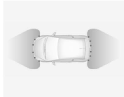
Le système comporte six capteurs de stationnement à ultrasons intégrés dans les deux pare-chocs, arrière et avant.
