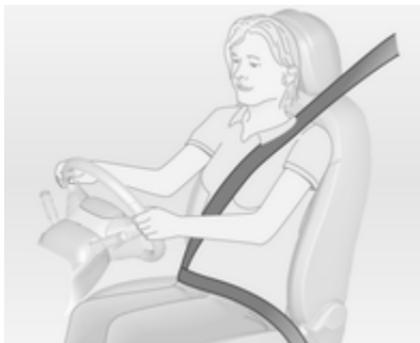
Tirer la ceinture de sécurité et l'encliquer dans la serrure de ceinture. La ceinture de sécurité ne doit pas être vrillée et doit être placée près du corps. Le dossier ne doit pas être incliné trop en arrière (environ 25° maximum).
