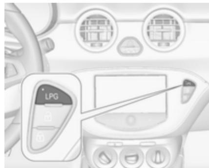
Appuyer sur **LPG** pour permuter entre fonctionnements à l'essence ou au gaz de pétrole liquéfié. La LED du bouton indique le mode de fonctionnement actuel.
