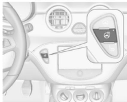
Activer le chauffage en appuyant sur
