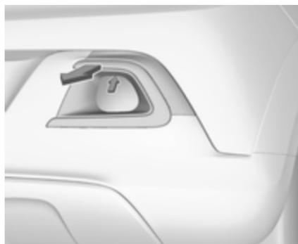
1. Déposer le cache en tirant à la main vers la position repérée, voir la flèche sur l'illustration.
