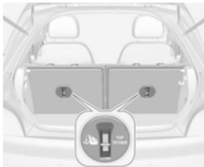
En plus de la fixation ISOFIX, attacher la sangle Top-Tether aux anneaux de fixation Top-Tether.
