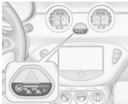
Si le témoin
