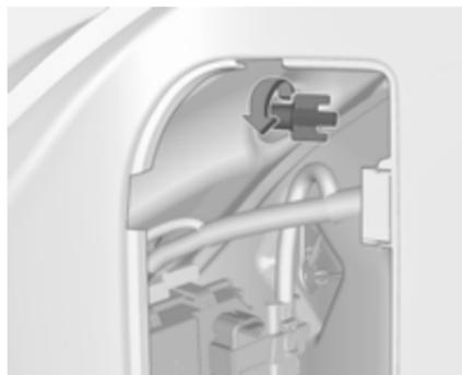
2. Dévisser de l'intérieur à la main l'écrou de fixation en plastique.
