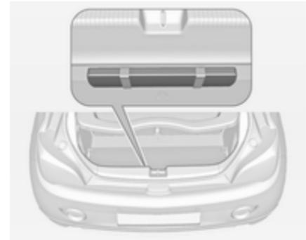
Le triangle de présignalisation est rangé avec des sangles élastiques dans le coffre, en dessous du hayon.
