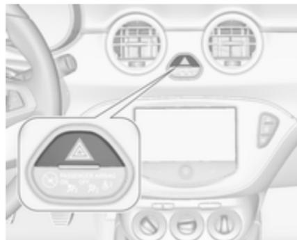
Pour les enclencher, appuyer sur
