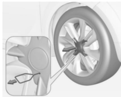
1.2. Insérer l'extracteur dans l'évidement du capuchon central et retirer le capuchon de la jante. Outil de bord ↻ 196.
