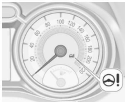
En cas de défaillance dans le système,
