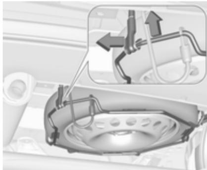
4. Soulever un peu le support de roue de secours à la main et détacher le loquet.
