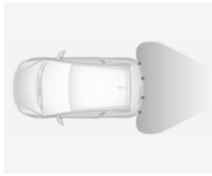
Le système possède quatre capteurs de stationnement à ultrasons disposés dans le pare-chocs arrière.
