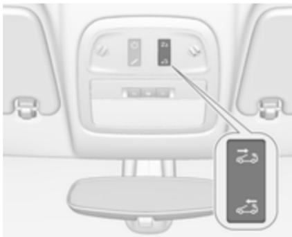
Le commutateur peut être actionné de deux façons : en appuyant brièvement dessus pour un déplacement automatique et en le maintenant en position enfoncée pour un déplacement manuel.
