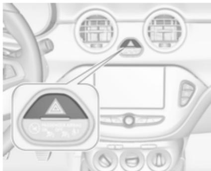
Pour les enclencher, appuyer sur
