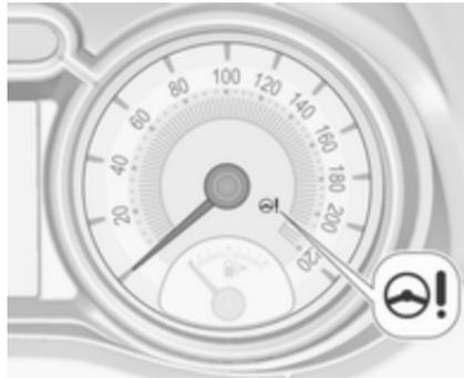
En cas de défaillance dans le système,
