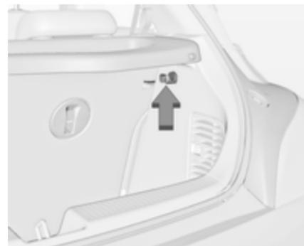
Utiliser le crochet sur la paroi latérale droite du coffre pour accrocher les sacs. Charge maximale : 5 kg.
