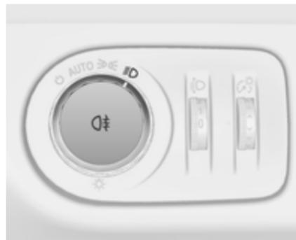
Pour les enclencher, appuyer sur
