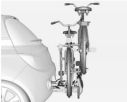
Le système de transport arrière (système Flex-Fix) permet de fixer une bicyclette au support de transport extractible intégré dans le plancher du véhicule. Il est possible de fixer un vélo supplémentaire sur un adaptateur. Le transport d'autres objets n'est pas autorisé.
