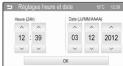
Pour régler les paramètres d'heure et de date, appuyer sur les points de menu **^** et **v**.
