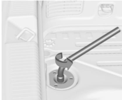
3. Poser la clé de roue sur le boulon hexagonal à côté de la boîte à outils et la tourner dans le sens anti-horaire jusqu'à ce qu'une certaine résistance soit ressentie.
