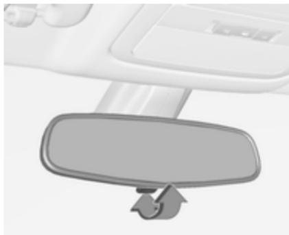
Pour éviter d'être ébloui, régler le levier sous le rétroviseur vers l'avant ou l'arrière. Pour la conduite normale, le levier est placé en position centrale.
