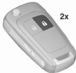
Appuyer deux fois sur le bouton
