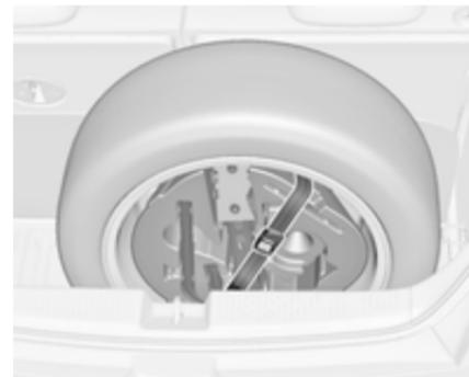
9. Placer la boîte à outils à l'intérieur de la roue et fixer avec la sangle 2 insérée dans deux rayons de la roue.
