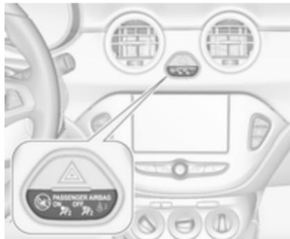
Si le témoin
