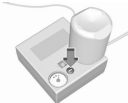
Si la pression des pneus prescrite n'est pas atteinte dans les dix minutes, démonter le kit de réparation de pneus. Avancer ou reculer le véhicule d'un tour de roue. Brancher à nouveau le kit de réparation des pneus et poursuivre la procédure de remplissage pen-
