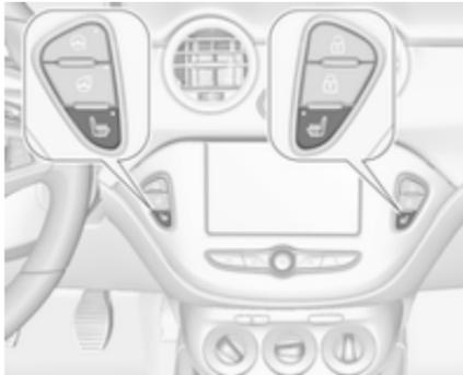
Activer le chauffage du siège en appuyant sur
