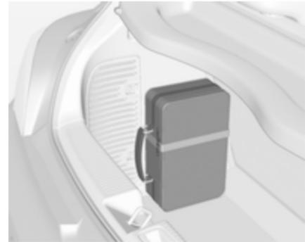
Sur les versions avec un système de transport arrière ou un moteur à gaz liquide, les outils ainsi que l'œillet de remorquage se trouvent dans une valise fixée avec une sangle sur la paroi gauche du coffre.
