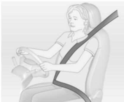
Tirer la ceinture de sécurité et l'attacher dans la boucle de ceinture. La ceinture de sécurité ne doit pas être vrillée et doit être placée près du corps. Le dossier ne doit pas être incliné trop en arrière (environ 25° maximum).
