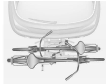
2. Positionner les vélos sur le système de transport arrière en les alignant en alternance vers la gauche ou la droite.
