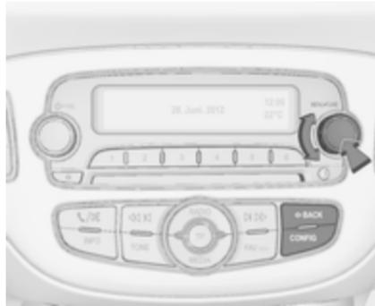
Sélectionner **Paramètres**, puis **Réglages véhicule**.
