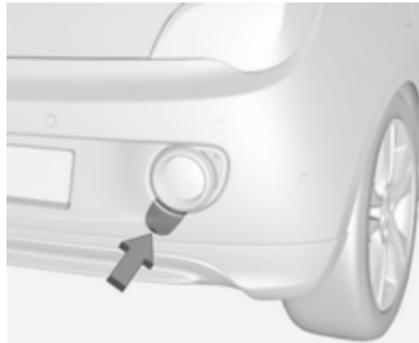
Envelopper d'un linge l'extrémité d'un tournevis plat pour ne pas endommager la peinture. Insérer le tournevis dans la fente de la courbure basse du capuchon. Désengager le capuchon en enfonçant avec précaution le tournevis vers le bas.
