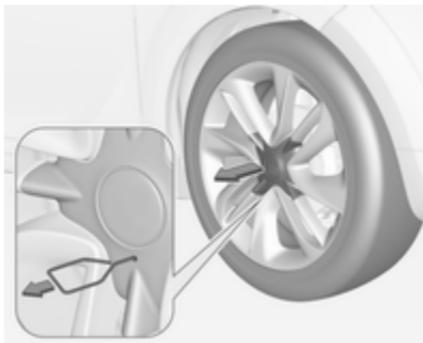
Insérer l'extracteur dans l'évidement du capuchon central et retirer le capuchon de la jante.
