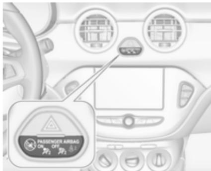
Si le témoin
