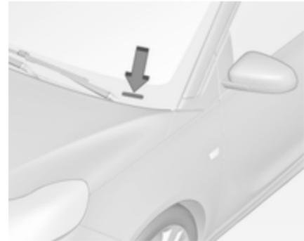
Le numéro d'identification du véhicule peut être estampé sur le tableau de bord et visible à travers le pare-brise, ou dans le compartiment moteur sur le panneau de carrosserie de droite.
