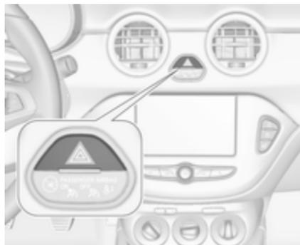
Pour les enclencher, appuyer sur
