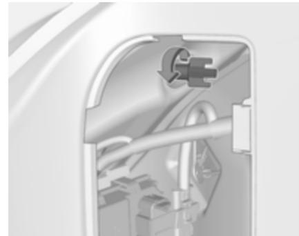
2. Dévisser de l'intérieur à la main l'écrou de fixation en plastique.
