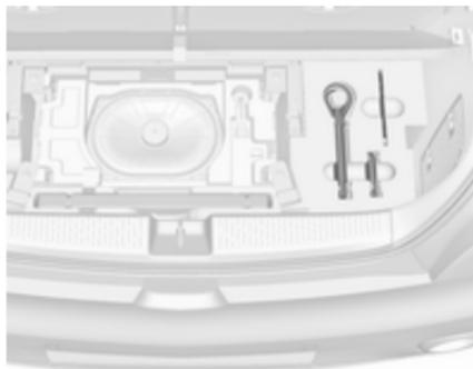
Sur les versions avec caisson de basse, les outils et l'œillet de remorquage se trouvent avec le triangle de présignalisation dans la boîte sous le tapis de sol. Pour accéder, retirer tout d'abord le tapis de sol : plier la partie arrière vers l'avant et tirer le tapis vers l'arrière ↻ 69.
