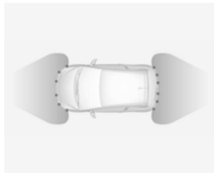
Le système comporte six capteurs de stationnement à ultrasons intégrés dans les deux pare-chocs, arrière et avant.
