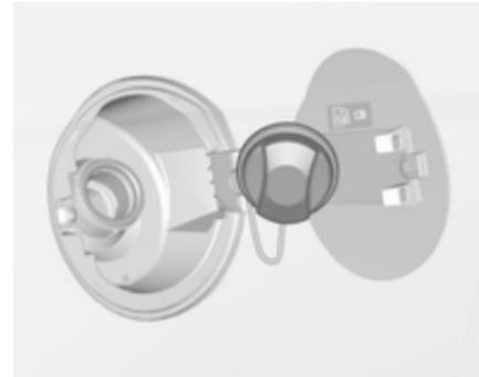
Le bouchon de remplissage peut être déposé dans le support sur la trappe à carburant.
