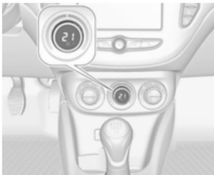
Si la température minimale **Lo** est réglée, le système de commande de climatisation fonctionne avec sa capacité maximale de refroidissement, si le refroidissement
