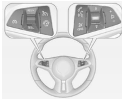
L'Infotainment System, le régulateur de vitesse et un appareil mobile connecté peuvent être commandés à partir du volant.
