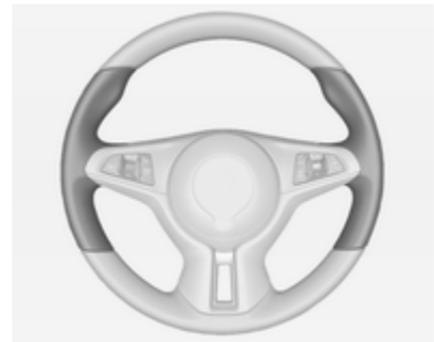
Les zones mises en relief pour tenir le volant sont chauffées plus rapidement et à une température plus élevée que le reste du volant.
