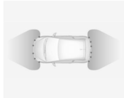
Le système avancé d'assistance au stationnement est toujours associé à l'aide au stationnement avant-arrière. Voir la section précédente. Les deux systèmes utilisent les mêmes capteurs sur les pare-chocs avant et arrière.
