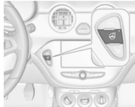
Activer le chauffage en appuyant sur
