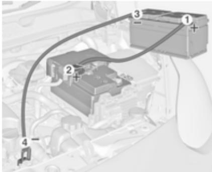
Séquence de raccordement des câbles :
