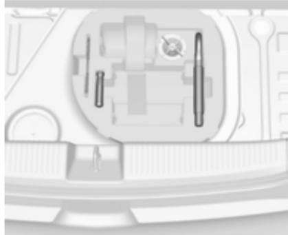
Certains outils et l'œillet de remorquage sont rangés dans une boîte à outils dans le coffre sous le recouvrement de plancher. Sur les versions avec une boîte de rangement, déposer tout d'abord la boîte ↪ 67.
