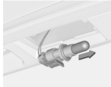
3. Retirer la douille du boîtier de phare en tournant dans le sens anti-horaire.
