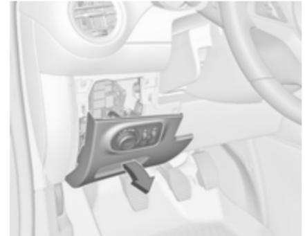
La boîte à fusibles se trouve derrière le commutateur d'éclairage du tableau de bord.
