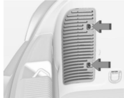
1. Détacher le capot sur le côté concerné et déposer.
