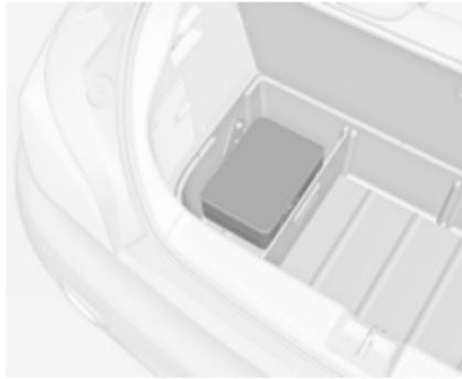
Sur les versions avec un boîtier de rangement dans le coffre, la valise avec le kit de réparation des pneus se trouve dans une chambre du boîtier ↻ 67.
