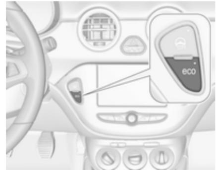
Pour désactiver le système Stop/Start manuellement, appuyer sur **eco**. La désactivation est signalée par l'extinction de la LED dans le bouton.
