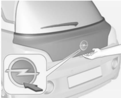
Appuyer sur l'emblème de la marque sur la moitié inférieure pour déverrouiller et ouvrir le hayon.
