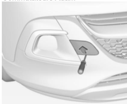
1. Envelopper d'un linge l'extrémité d'un tournevis plat pour ne pas endommager la peinture. Désengager le petit cache à l'aide du tournevis à l'endroit indiqué.
