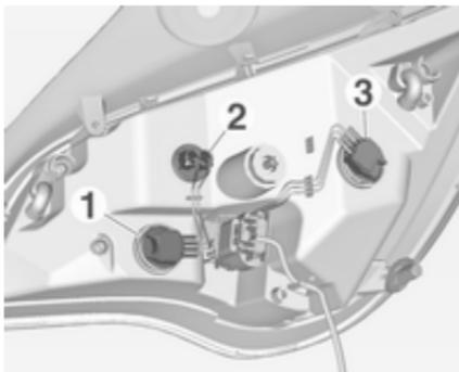
4. Tourner la douille d'ampoule dans le sens anti-horaire et retirer.
