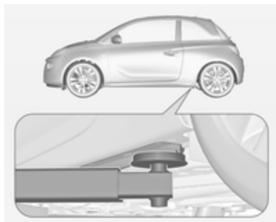
Position du bras arrière du pont élévateur, positionné centralement sous le creux du seuil.
