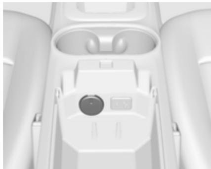
Des prises de courant de 12 volts sont situées dans l'espace de rangement de l'accoudoir avant et la console de plancher centrale avant.
