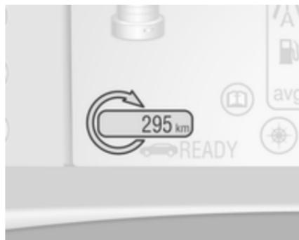
Affiche l'autonomie totale du véhicule en associant l'autonomie électrique et l'autonomie en carburant.
