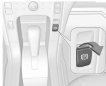
Le frein de stationnement électrique peut toujours être actionné, même avec le contact coupé. Pour éviter l'épuisement de la batterie 12 volts, éviter d'actionner le système de frein de stationnement électrique à répétition lorsque le contact est coupé.
