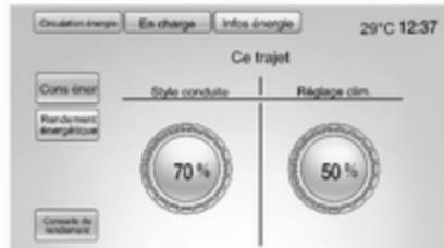
On accède à cet écran en appuyant sur **Rendement énergétique** sur l'écran **Infos énergie**. Cet écran affiche l'efficacité énergétique au cours du cycle de conduite sur base du style de conduite et des réglages de la climatisation. Conduire de manière plus efficace augmentera le pourcentage relatif au cycle de conduite. Minimiser
