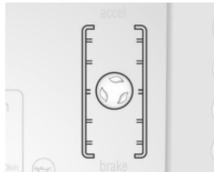
Cette jauge sert de guide pour une conduite efficace lorsque la bille reste verte et au centre de la jauge. Les feuilles arrêtent de tourner lorsque le véhicule s'arrête ou lorsque la bille s'éloigne du centre de la jauge.
