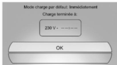
Lorsque le système de chargement programmable est désactivé, l'écran et la fenêtre de l'état de mode de charge par défaut affiche - - - - pour l'heure de charge terminée. Le système de chargement programmable sera désactivé si l'heure de fin de charge ne peut être estimée de ma-
