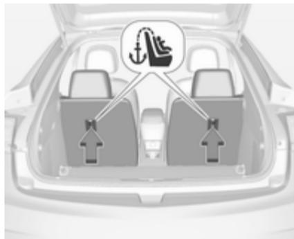
Les ancrages Top-Tether des positions d'assise arrière extérieures se trouvent au dos du dossier de siège arrière. Veiller à utiliser un ancrage situé du même côté du véhicule que la position d'assise où sera placé le système de sécurité pour enfant.
