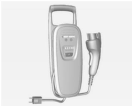
Lorsque seul le témoin de défaillance ① clignote rouge, le cordon de chargement peut être défectueux. Le cordon de chargement tentera automatiquement une réinitialisation. Si le témoin de défaillance ① continue à clignoter pendant plus de 30 secondes, débrancher le cordon de chargement du mur pour réinitialiser. Si la défaillance subsiste, contacter un atelier.
