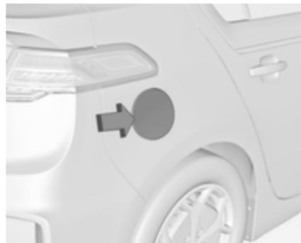
2. Lorsqu'un message s'affiche dans le DIC indiquant que le système est prêt à être rempli, la trappe à carburant du côté arrière droit du véhicule se déverrouille. Enfoncer le bord arrière de la trappe à carburant et relâcher pour ouvrir la trappe.
