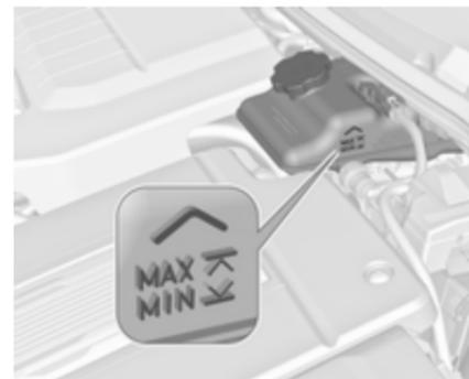
Lorsque le véhicule ne fonctionne pas pendant au moins une minute, le niveau maximum de liquide se situe au sommet du corps du réservoir. Lorsque le véhicule est en fonctionnement, le niveau du liquide doit se trouver dans la plage de fonctionnement correcte entre les repères **MIN** et **MAX**. Si tel n'est pas le cas, faire contrôler le circuit hydraulique de freinage pour vérifier s'il y a une fuite.
