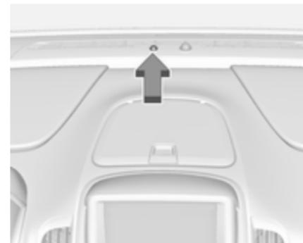
Le véhicule est doté d'un indicateur d'état de charge placé au centre du tableau de bord, à proximité du pare-brise. Lorsque le véhicule est branché et hors tension, l'indicateur d'état de charge se présente comme suit :
