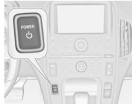
Le véhicule est doté d'un démarrage à bouton-poussoir électronique. Le témoin du bouton  $\odot$  clignote lorsque la porte du conducteur est ouverte et que le contact n'est pas mis. Le clignotement du témoin peut éventuellement s'arrêter. Le témoin du bouton  $\odot$  reste allumé lorsque le contact est
