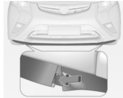
Le déflecteur d'air avant permet à l'air de circuler plus proprement sous le véhicule. Si le déflecteur d'air avant
