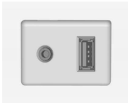
Ce véhicule est doté d'une prise AUX et d'une prise USB dans la console centrale pour la connexion de sources de données audio externes.
