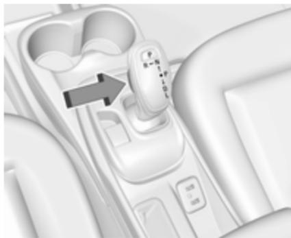
Le bouton de déverrouillage est conçu pour éviter une sortie accidentelle de la position de stationnement **P** aussi longtemps que le véhicule n'a pas démarré, que la pédale de frein est enfoncée et que le bouton de déverrouillage est pressé.
