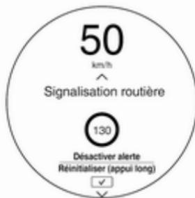
Une fois activée, la limite de vitesse et les panneaux d'interdiction de dépasser sont affichés comme des alertes en surimpressions sur le centre d'informations du conducteur.
