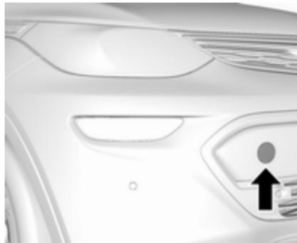
Envelopper d'un linge l'extrémité d'un tournevis pour ne pas endommager la peinture. Insérer le tournevis dans la fente sur le bord court du capuchon. Dégager le capuchon en enfonçant avec précaution le tournevis vers le côté.
