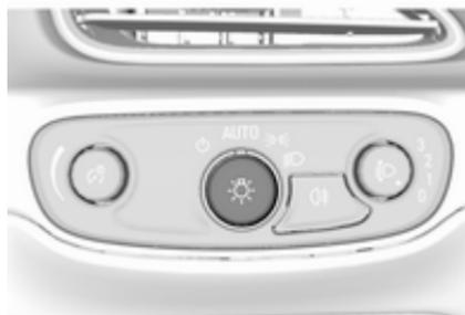
Quand la fonction de commande automatique des feux est activée et que le véhicule est activé, le système bascule automatiquement entre les feux de jour et les phares, en fonction des conditions d'éclairage extérieur.
