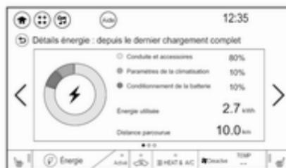
L'écran **Détails énergie** affiche comment l'énergie est utilisée depuis le dernier chargement complet de la batterie haute tension. Ceci inclut **Conduite et accessoires**, **Paramètres de la climatisation** et **Conditionnement de la batterie**. Le graphisme circulaire affiche ces pourcentages. **Énergie utilisée** et **Distance parcourue** sont également affichés.
