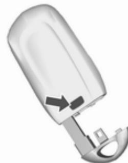
1. Appuyer sur le bouton au dos de la clé électronique et retirer la lame de la clé du boîtier.
