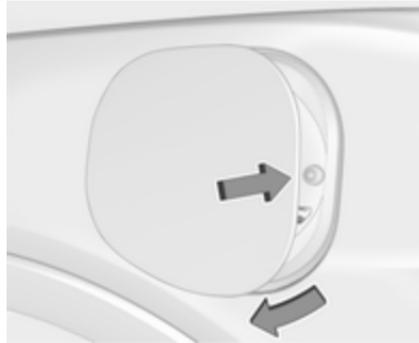
2. Enfoncer le bord arrière de la prise de charge et le relâcher pour ouvrir la trappe.
