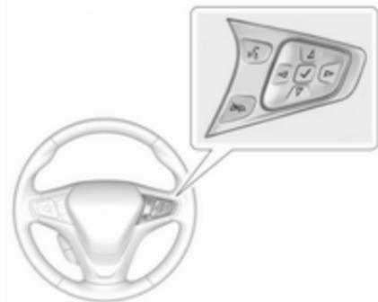
Choisir **Infos véhic.** au moyen des boutons du volant de direction. Appuyer sur  $\Delta$  ou  $\nabla$  pour sélectionner la page d'assistant de détection des panneaux routiers  $\curvearrowright$  85.
