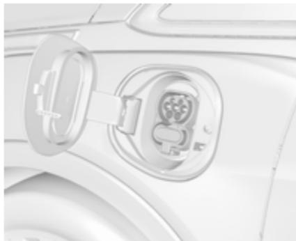
5. Brancher la fiche véhicule du cordon de chargement dans la prise de charge du véhicule. Vérifier si le témoin de l'état de chargement est allumé sur le haut du tableau de bord et si un signal sonore est émis.
