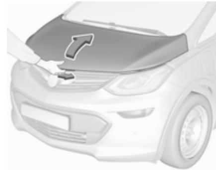
2. Déplacer le verrou de sécurité sur le côté gauche du véhicule et ouvrir le capot.
