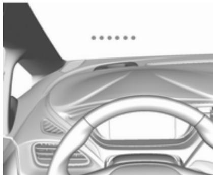
Lorsque le véhicule approche d'un piéton détecté à l'avant trop rapidement, une alerte par diode rouge clignotante est projetée sur le pare-brise dans le champ de vision du conducteur et une sonnerie d'avertissement retentit. Le système de freinage peut se préparer à ce que le conducteur freine plus rapidement, ce qui peut entraîner une légère et brève décélération. Continuer à appuyer sur la pédale de frein selon les besoins.
