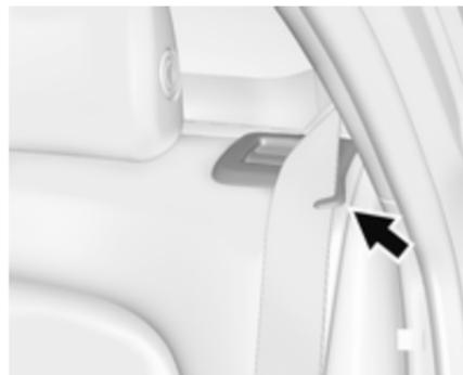
Guider les ceintures de sécurité des sièges extérieurs dans les guides de ceinture.
