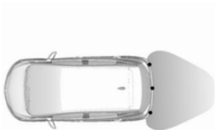
Le système possède trois capteurs de stationnement à ultrasons disposés dans le pare-chocs arrière.
