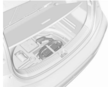
3. Ouvrir le hayon. Lever le recouvrement des rangements dans le plancher arrière et déposer le cordon de chargement.
