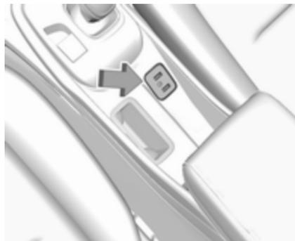
Un port AUX et USB pour la connexion d'appareils externes se trouvent dans la console centrale.
