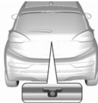
La caméra est montée entre les lampes d'éclairage de la plaque d'immatriculation et a un angle de vision de 130°.
