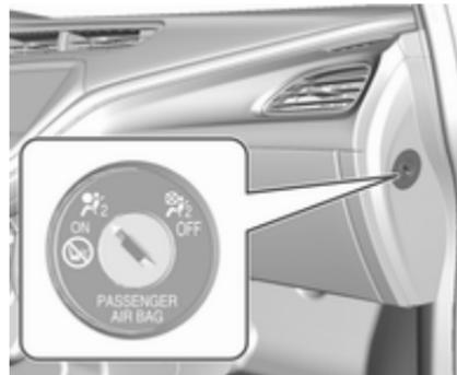
Le système d'airbag de passager avant peut être désactivé via un commutateur à clé situé sur le côté passager de la planche de bord.
