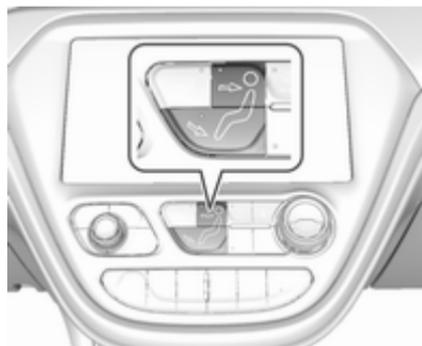
Appuyer sur le bouton approprié pour la répartition souhaitée. L'activation est signalée par l'allumage de la diode du bouton.
