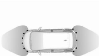
Le système avancé d'assistance au stationnement est toujours associé à l'aide au stationnement avant-arrière. Les deux systèmes utilisent les mêmes capteurs sur les pare-chocs avant et arrière.
