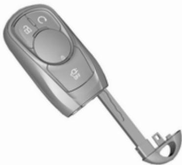
2. Insérer la panne de la clé sur environ 6 mm et tourner la clé pour ouvrir le boîtier. Une insertion plus profonde de la clé peut endommager le boîtier.
