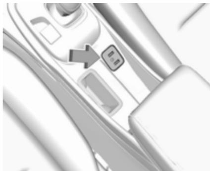
Deux ports USB se trouvent dans la console centrale. Ces ports peuvent être utilisés pour le chargement et la connexion d'Infodivertissement.
