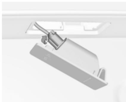
3. Déposer le boîtier de lampe du support d'ampoule en faisant tourner le support d'ampoule dans le sens horaire.
