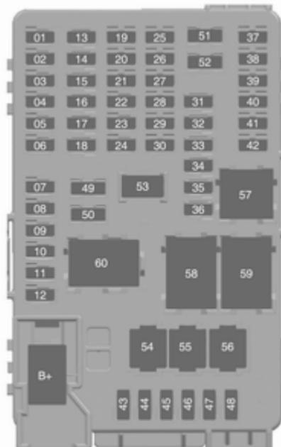
La boîte à fusibles du tableau de bord se trouve sur le côté gauche du tableau de bord. Pour accéder aux fusibles, ouvrir la trappe en tirant dessus.
