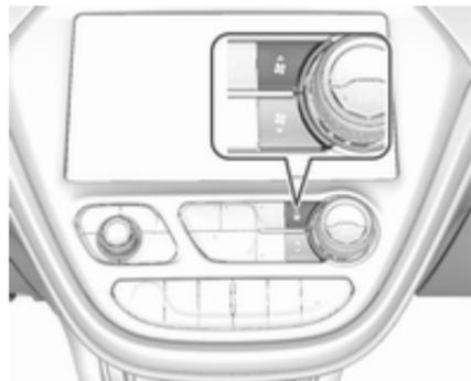
Appuyer sur le bouton inférieur pour réduire la vitesse de soufflerie ou le bouton supérieur pour l'augmenter. Le régime de ventilateur est indiqué dans la zone inférieure d'affichage.
