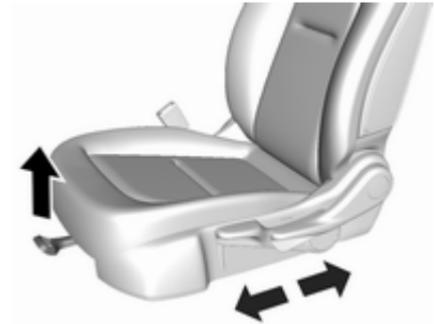
Tirer la poignée, déplacer le siège et relâcher la poignée. Essayer de déplacer le siège d'avant en arrière pour s'assurer qu'il est bien verrouillé en place.
