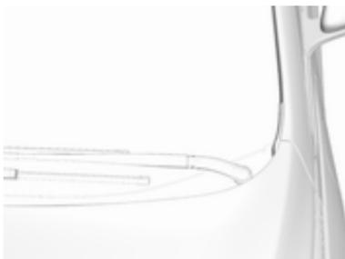
Le numéro d'identification du véhicule peut être estampé sur le tableau de bord, visible à travers le pare-brise ou dans le compartiment moteur sur le panneau de carrosserie de droite.
