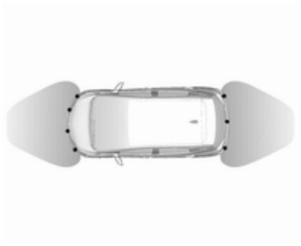
Le système possède quatre capteurs ultrasoniques de stationnement dans le pare-chocs avant trois capteurs ultrasoniques de stationnement dans le pare-chocs arrière.
