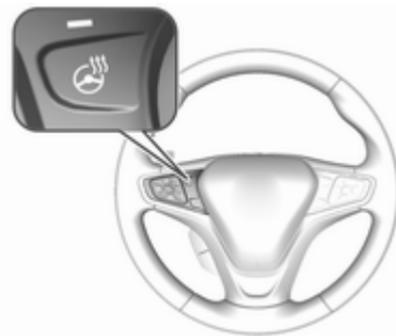
Activer le chauffage en appuyant sur
