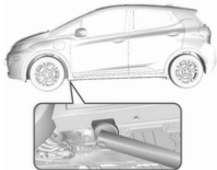
Position du bras avant du pont élévateur au niveau du soubassement.
