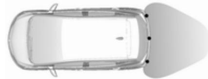
Le système possède trois capteurs de stationnement à ultrasons disposés dans le pare-chocs arrière.
