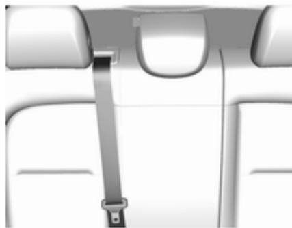
La ceinture de sécurité du siège central peut être bloquée quand le dossier est relevé trop rapidement. Pour débloquer l'enrouleur, rentrer la ceinture de sécurité ou la sortir d'environ 20 mm, puis relâcher.
