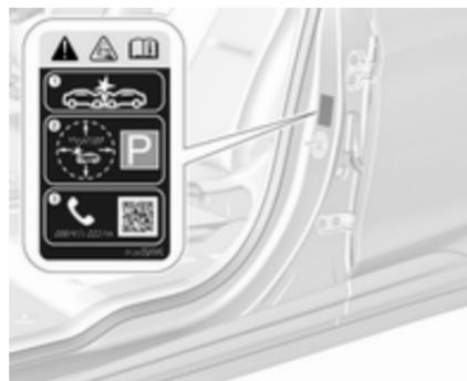
L'étiquette après collision est placée dans l'embrasure de porte du conducteur.
