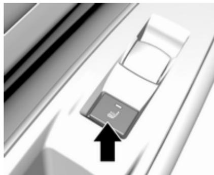
Activer le chauffage de siège en appuyant sur
