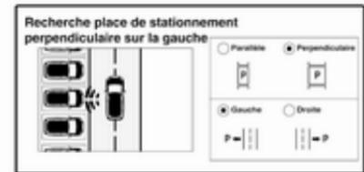
Sélectionner une place de stationnement parallèle ou perpendiculaire en effleurant l'icône correspondante de l'Affichage d'informations.
