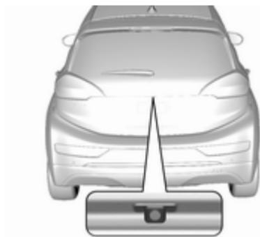
La caméra est montée entre les lampes d'éclairage de la plaque d'immatriculation et a un angle de vision de 130°.
