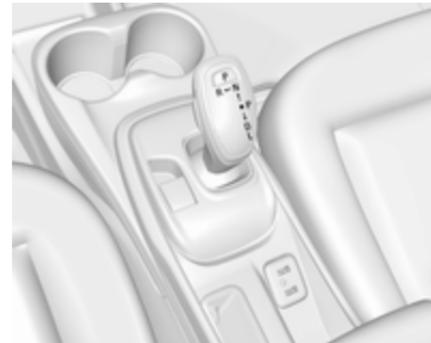
**P** : Position de stationnement, roues bloquées, engager uniquement lorsque le véhicule n'est pas en mouvement
