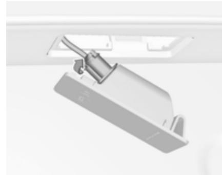
3. Déposer le boîtier de lampe du support d'ampoule en faisant tourner le support d'ampoule dans le sens horaire.
