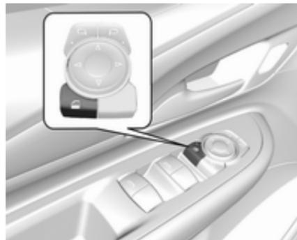
Pour désactiver les lève-vitres électriques des portes arrière, appuyer sur . La diode s'allume.
