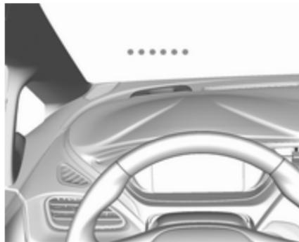
Lorsque le véhicule approche d'un piéton détecté à l'avant trop rapidement, une alerte par diode rouge clignotante est projetée sur le pare-brise dans le champ de vision du conducteur et une sonnerie d'avertissement retentit. Le système de freinage peut se préparer à ce que le conducteur freine plus rapidement, ce
