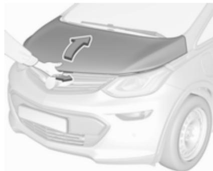
2. Déplacer le verrou de sécurité sur le côté gauche du véhicule et ouvrir le capot.
