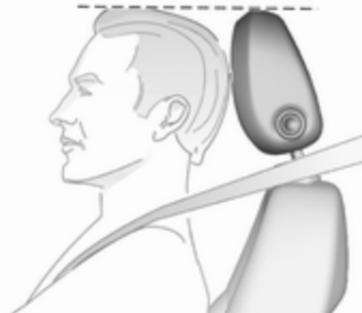
Le bord supérieur de l'appui-tête doit toujours être au niveau du haut de la tête. Si cela s'avérait impossible pour des personnes de très grande taille, l'appui-tête doit être réglé sur la posi-
