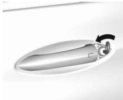
Déverrouiller manuellement la porte du conducteur en introduisant et en tournant la clé dans le barillet de la serrure.
