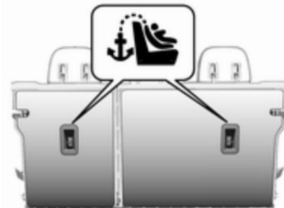
En plus des supports de montage ISOFIX, attacher la sangle d'attache supérieure aux ancrages d'attache supérieure.
