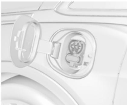
5. Brancher la fiche véhicule du cordon de chargement dans la prise de charge du véhicule. Vérifier si le témoin de l'état de chargement est allumé sur le haut du tableau de bord et si un signal sonore est émis. État du chargement ↗ 221.
