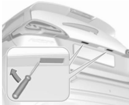
1. Insérer un tournevis dans la fente à gauche de la lampe et faire pivoter le tournevis.
