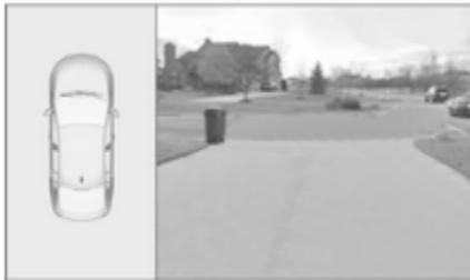
Une vue de la zone avant du véhicule peut s'afficher dans l'Affichage d'informations. La vue avant s'affiche après le passage de **R** à **D** et lorsque le véhicule avance plus lentement que 8 km/h.
