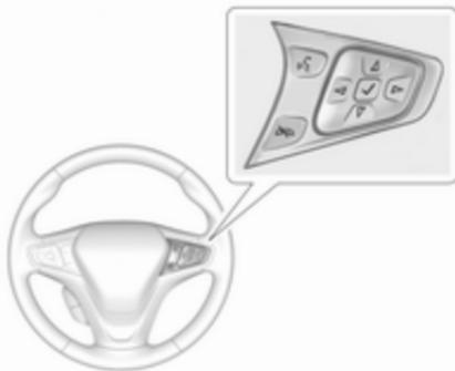
Choisir **Infos véhic.** au moyen des boutons du volant de direction. Appuyer sur  $\Delta$  ou  $\nabla$  pour sélectionner la page d'assistant de détection des panneaux routiers  $\curvearrowright$  86.
