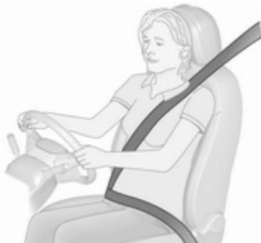
Tirer la ceinture de sécurité et l'attacher dans la boucle de ceinture. La ceinture de sécurité ne doit pas être vrillée et doit être placée près du corps. Le dossier ne doit pas être incliné trop en arrière (environ 25° maximum).
