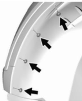
1. Incliner la roue et déposer les vis de l'extérieur du passage de roue. Utiliser le tournevis de l'outillage du véhicule.
