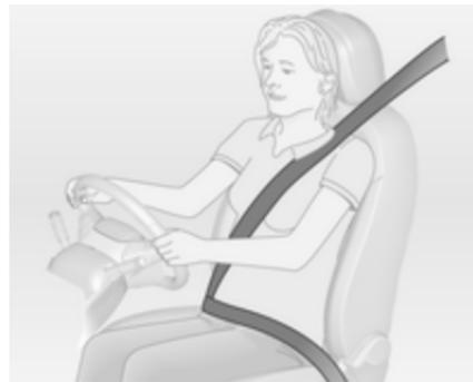
Tirer la ceinture de sécurité et l'enclencher dans la serrure de ceinture. La ceinture de sécurité ne doit pas être vrillée et doit être placée près du corps. Le dossier ne doit pas être incliné trop en arrière (environ 25° maximum).
