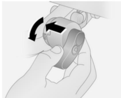
Déverrouiller la boule d'attelage et retirer la clé. Pousser le levier vers la gauche en direction de la barre d'attelage et le tourner vers le bas. Sortir la barre d'attelage de son logement.
