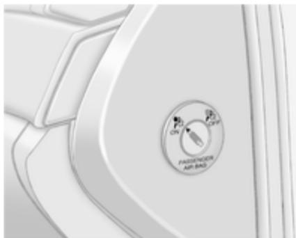
Le système d'airbag de passager avant peut être désactivé via un commutateur à clé situé sur le côté droit de la planche de bord.
