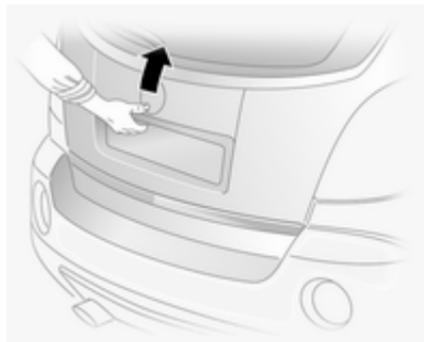
Appuyer sur le bouton au-dessus de la plaque d'immatriculation et lever le hayon.
