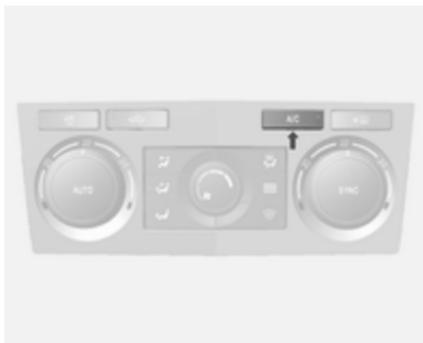
Pour changer les réglages de la climatisation, appuyer sur le bouton **A/C** ou bien régler la vitesse de la soufflerie ou le commutateur de répartition de l'air. Une modification de réglage désactivera le mode Automatique.
