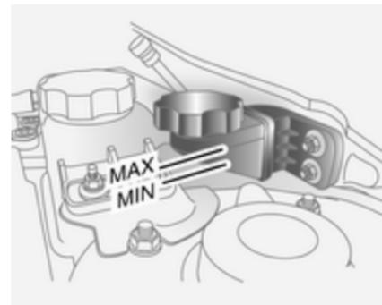
Si le liquide dans le réservoir descend sous le repère **MIN**, prendre contact avec un atelier.
