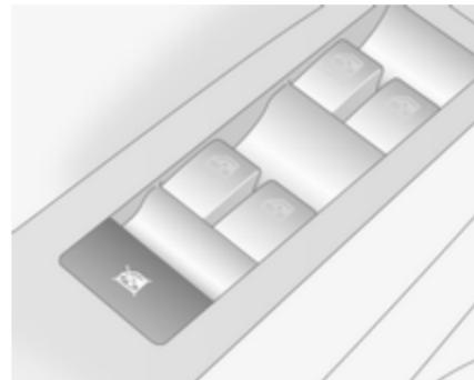
Appuyer sur le bouton
