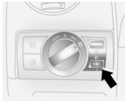
Allumer les feux de croisement et régler la hauteur des phares en fonction de la charge du véhicule. Un réglage correct de la portée des phares diminue l'éblouissement des autres usagers de la route.
