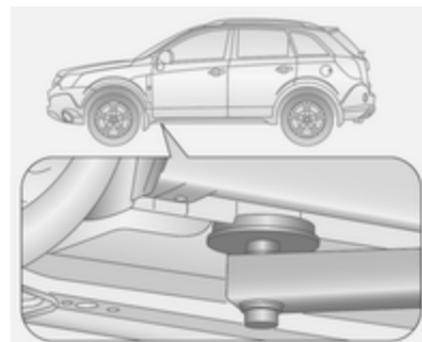
Position du bras avant du pont élévateur centrée sous le creux du seuil.
