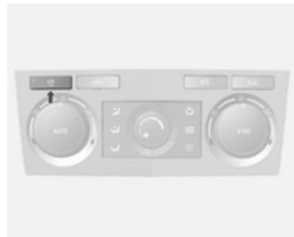
Actionnement avec le bouton 🔄. L'activation est signalée par la LED dans le bouton.
