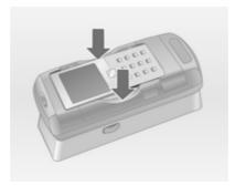
Avec les consoles de l'adaptateur ouvertes, insérez le téléphone mobile verticalement dans l'adaptateur comme indiqué sur l'illustration cidessus jusqu'à ce que les consoles latérales s'engagent.
