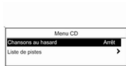
Tournez le bouton multifonction pour marquer la fonction à activer ou à désactiver. Appuyez sur le bouton multifonction pour activer **Mar** ou désactiver **Arrêt** le paramètre.
