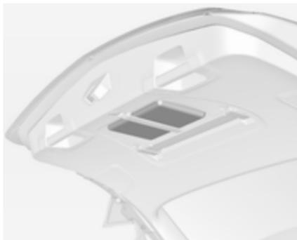
Replier la sangle. Ranger la trousse de secours dans l'espace derrière la sangle sur la face intérieure du hayon.
