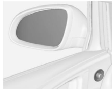
Sélectionner le rétroviseur extérieur souhaité en tournant la commande à gauche (**L**) ou à droite (**R**). Puis pincer le bouton de commande pour régler le rétroviseur.
