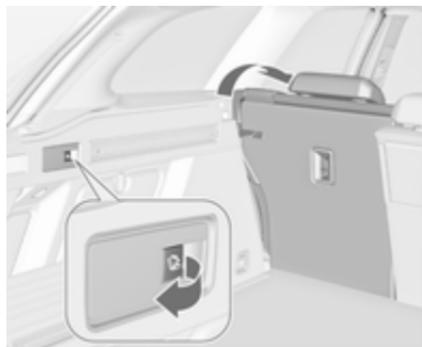
Tirer sur le commutateur se trouvant sur la cloison gauche ou droite du coffre pour replier la partie correspondante du siège arrière.
