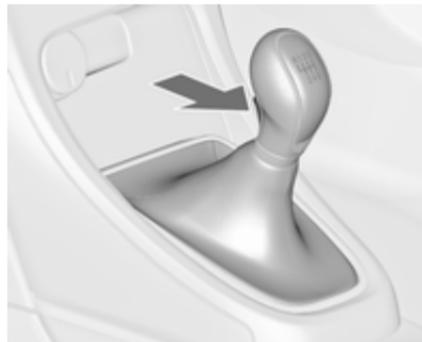
Marche arrière : le véhicule étant à l'arrêt, enfoncer la pédale d'embrayage, enfoncer le bouton de verrouillage du levier sélecteur et engager le rapport.
