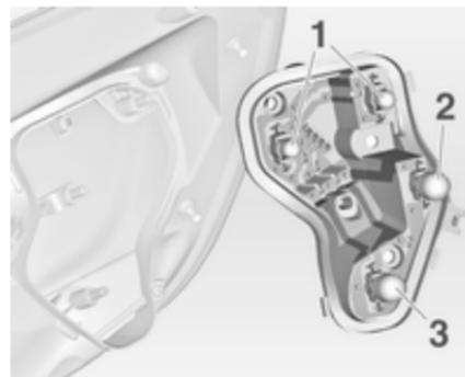
7. Enlever et remplacer l'ampoule.
