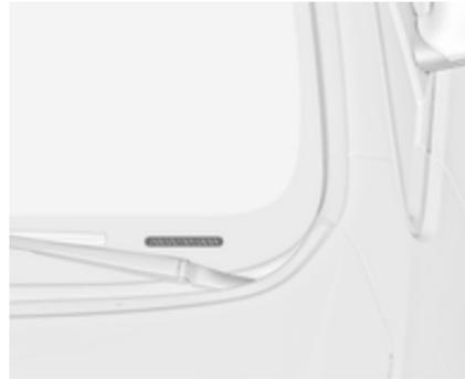
Le numéro d'identification du véhicule est visible à travers le pare-brise.
