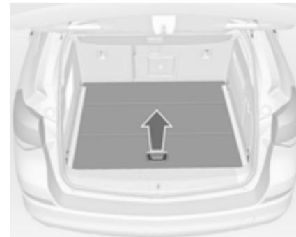
Soulever le recouvrement de plancher arrière en tirant la poignée. Rabattre le recouvrement et le placer derrière les sièges arrière.
