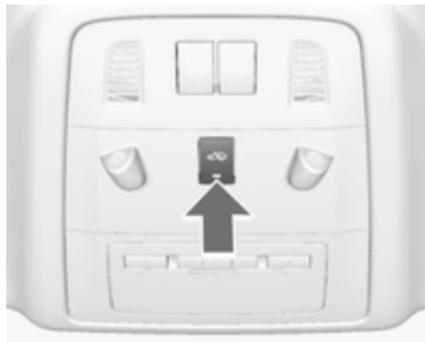
Arrêter la surveillance de l'habitacle et de l'inclinaison du véhicule quand des personnes ou des animaux restent dans le véhicule, en raison de la grande quantité de signaux ultrasoniques et de leurs mouvements déclenchant l'alarme, et quand le véhicule est à bord d'un ferry ou d'un train.
