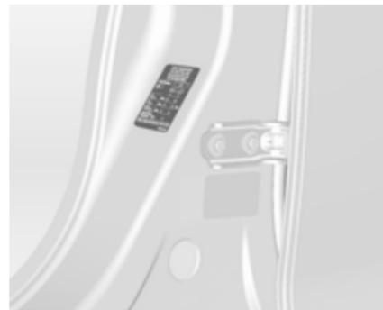
Pression de gonflage ⇨ 233 et sur l'étiquette apposée sur le cadre de porte avant gauche.
