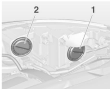
Phares avec systèmes séparés pour les feux de croisement 1 (ampoules extérieures) et les feux de route 2 (ampoules intérieures).
