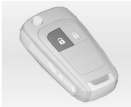
Appuyer sur le bouton
