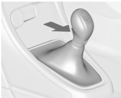
Pour engager la marche arrière, appuyer sur le bouton de verrouillage se trouvant sur le levier sélecteur avec le véhicule à l'arrêt et engager le rapport.
