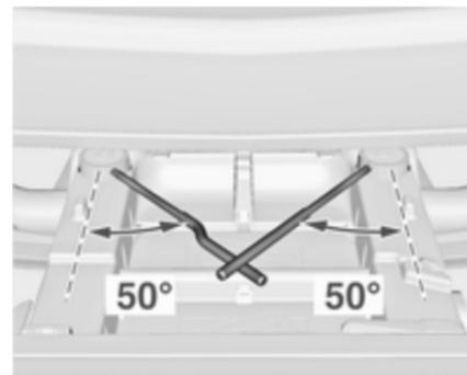
Le système de transport arrière est verrouillé lorsque les poignées de verrouillage ont été pivotées d'environ 50°. Sinon la fonction de sécurité ne peut pas être garantie.
