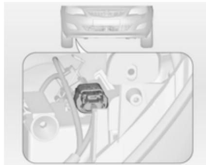
Les ampoules sont accessibles par le bas du véhicule.
