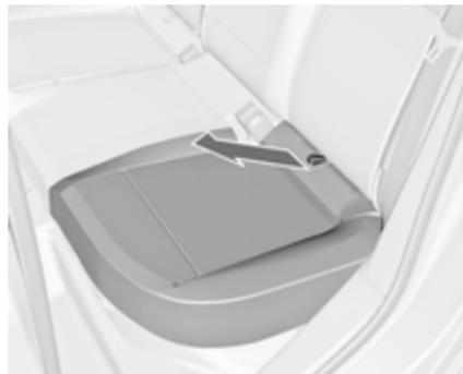
Tirer la sangle sur une ou les deux assises et soulever l'arrière des assises vers l'avant.
