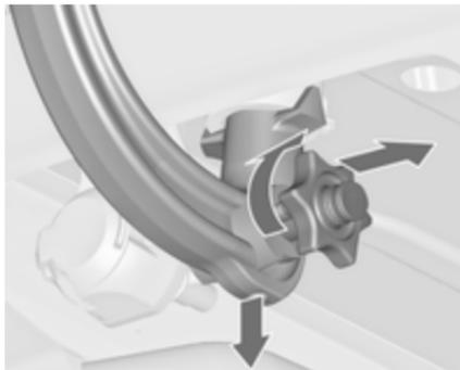
Ouvrir le volet de protection et tourner la clé en position
