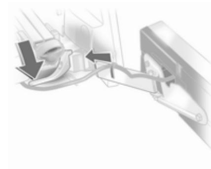
Enfoncer la poignée de verrouillage et pousser le support d'ampoule dans le dispositif de retenue jusqu'à ce qu'il s'enclique.
