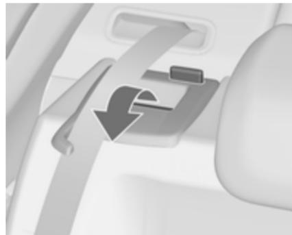
Guider les ceintures de sécurité à travers les supports latéraux afin de les protéger de tout dégât. Lors du rabattement des dossiers, entraîner les ceintures de sécurité avec eux.
