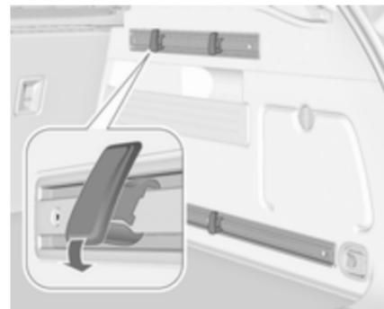
Introduire le crochet à la position désirée d'abord dans la rainure supérieure du rail, puis l'enfoncer dans la rainure inférieure. Pour la dépose, dégager d'abord de la rainure supérieure.
