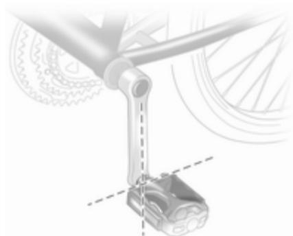
Tourner la pédale gauche (sans plateau) pour l'orienter verticalement vers le bas. La pédale de la manivelle gauche doit être horizontale.
