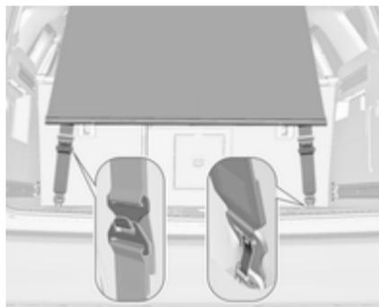
Régler la longueur de la sangle sur le filet de sécurité en fixant le crochet supérieur aux anneaux de la sangle. Fixer le crochet inférieur sur l'anneau de gauche et de droite du plancher.
