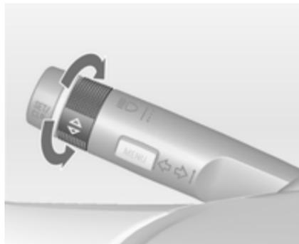
Les panneaux routiers sont affichés sur la page **Détection des panneaux routiers** dans le **Menu informations trajet/carbur.**, en sélectionnant avec la roue moletée de la manette des clignotants ↻ 104.
