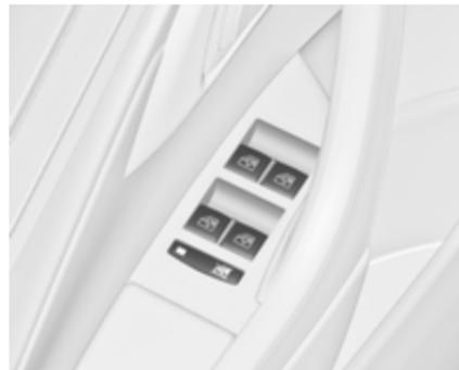
Appuyer sur le commutateur
