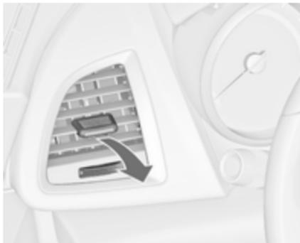
Régler la direction du flux d'air en faisant basculer et pivoter les lamelles. Pour fermer la bouche d'aération, tourner la molette de réglage vers le plus petit symbole ■.
