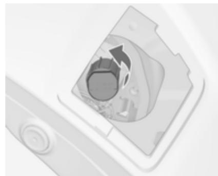
2. Retirer et remplacer l'ampoule du feu antibrouillard arrière
