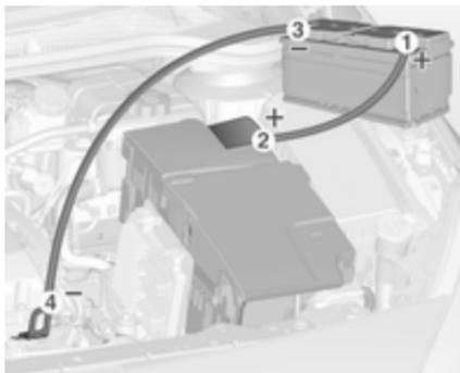
Séquence de raccordement des câbles :
