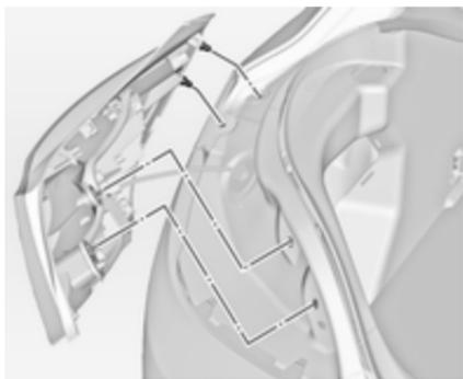
3. Retirer avec précaution l'ensemble de feu arrière des broches de retenue et enlever. S'assurer que la goulotte de câbles reste en place.
