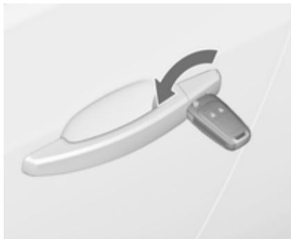
Déverrouiller manuellement la porte du conducteur en tournant la clé dans la serrure. Mettre le contact et appuyer sur le bouton de verrouillage central
