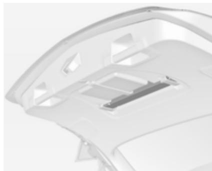
Replier les sangles. Ranger le triangle de présignalisation dans l'espace situé derrière les sangles sur face intérieure du hayon.
