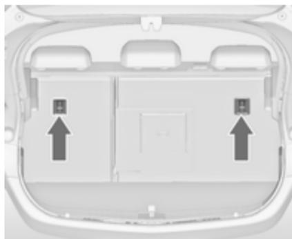
En plus de la fixation Isifix, attacher la sangle Top-Tether aux anneaux de fixation Top-Tether. La sangle doit alors passer entre les deux tiges de guidage de l'appui-tête.
