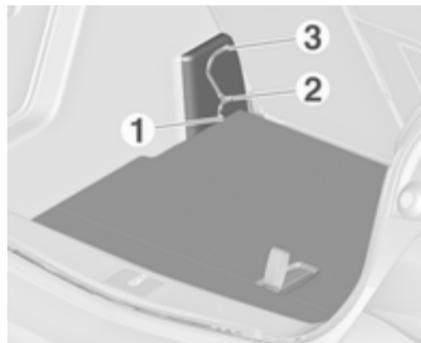
Le recouvrement réglable en hauteur peut être installé dans trois positions:
