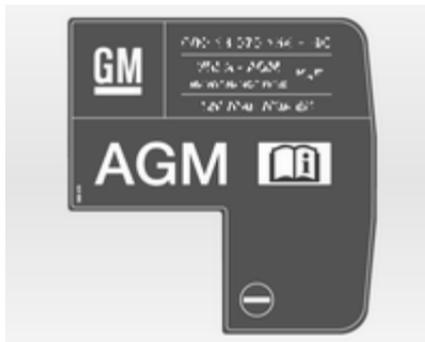
Une batterie AGM se reconnaît à l'étiquette sur la batterie. Nous recommandons d'utiliser une batterie d'origine Opel.
