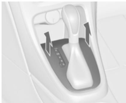
2. Dégager l'avant du garnissage du levier sélecteur de la console, le relever et le faire tourner vers la gauche.
