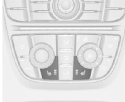
En fonction du niveau de chauffage voulu, appuyer une ou plusieurs fois sur le bouton
