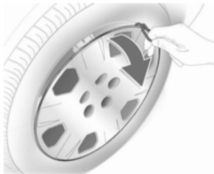
1. Dégager et retirer les capuchons des écrous de roue à l'aide d'un tournevis. Enlever l'enjoliveur à l'aide du crochet. Outillage de bord ↗ 211.
