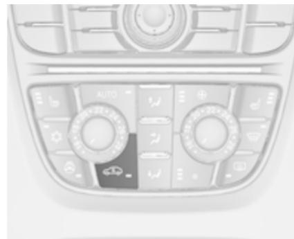
Appuyer une fois sur le bouton
