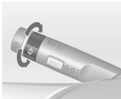
Les panneaux routiers sont affichés sur la page **Détection des panneaux routiers** dans le **Menu informations trajet/carbur.**, en sélectionnant avec la roue moletée de la manette des cliquotants ↻ 113.
