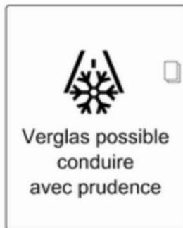
Si la température extérieure chute à 3 °C, un message d'avertissement s'affiche sur le centre d'informations du conducteur doté d'un affichage de niveau supérieur.
