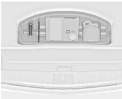
Les outils et le kit de réparation des pneus se trouvent dans un compartiment de rangement sous le recouvrement de plancher du coffre.
