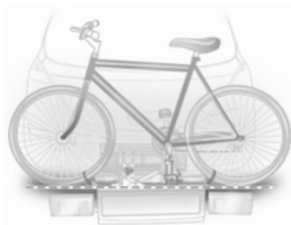
Positionner les logements de roue de sorte que le vélo soit plus ou moins horizontal. La distance entre les pédales et le hayon doit alors être d'au moins 5 cm.
