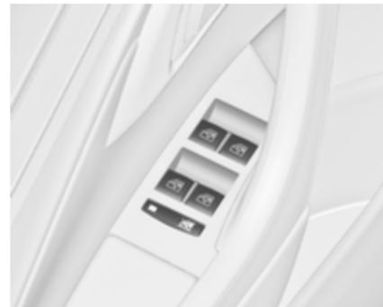
Appuyer sur le commutateur
