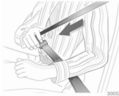
Tirer la ceinture hors de l'enrouleur, la guider sur le corps sans la vriller et insérer le verrou plat dans la serrure. En roulant, tendre régulièrement la sangle abdominale en tirant sur la sangle thoracique. Rappel de ceinture de sécurité
