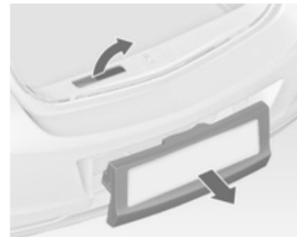
Tirer la poignée de déverrouillage vers le haut. Le système se déverrouille et est éjecté hors du pare-chocs.
