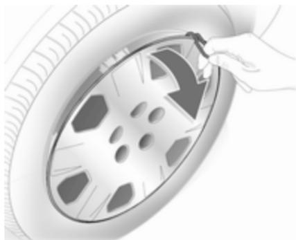
1. Dégager et retirer les capuchons des écrous de roue à l'aide d'un tournevis. Enlever l'enjoliveur à l'aide du crochet. Outillage de bord ⇨ 218.
