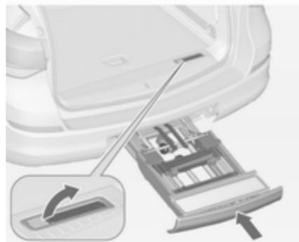
Tirer vers le haut la manette de déblocage et pousser le système de transport arrière dans le pare-chocs jusqu'à ce qu'il se verrouille.
