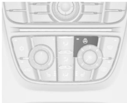
Activer le chauffage en appuyant sur le bouton
