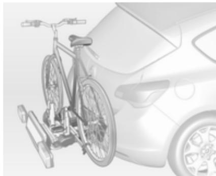
Le système de transport arrière (système Flex-Fix) permet de fixer des vélos au support de transport extractible intégré dans le plancher du véhicule. Le transport d'autres objets n'est pas autorisé.
