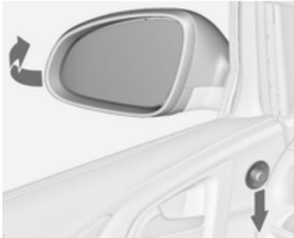
Mettre la commande sur 0, puis abaisser la commande. Les deux rétroviseurs extérieurs sont rabattus. Abaisser à nouveau la commande : les deux rétroviseurs extérieurs reprennent leur position initiale.
