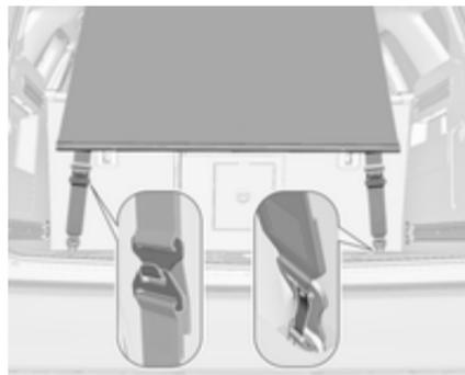
Fixer le crochet inférieur avec l'ouverture faisant face vers l'arrière sur l'anneau de gauche et de droite du plancher. Régler la longueur de la sangle sur le filet de sécurité en fixant le cro-
