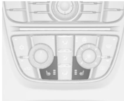
En fonction du niveau de chauffage voulu, appuyer une ou plusieurs fois sur le bouton
