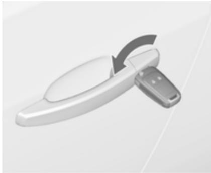
Déverrouiller manuellement la porte du conducteur en tournant la clé dans la serrure. Mettre le contact et appuyer sur le bouton de verrouillage central
