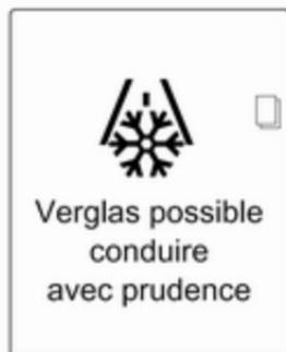
Si la température extérieure chute à 3 °C, un message d'avertissement s'affiche sur le centre d'informations du conducteur doté d'un affichage de niveau supérieur ou d'affichage de niveau supérieur-combi.
