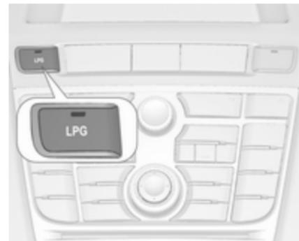
Le bouton **LPG** permet de choisir entre mode essence et mode gaz de pétrole liquéfié. La LED ● indique le mode de fonctionnement en cours.
