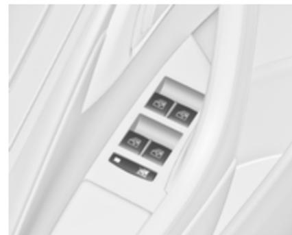
Appuyer sur le commutateur
