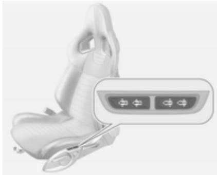
Ajuster la largeur de l'assise et la largeur du dossier en fonction de vos besoins personnels en utilisant les commutateurs.
