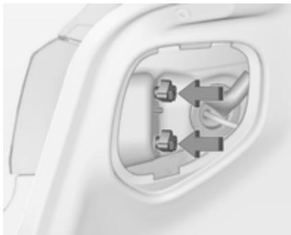
2. Dévisser de l'intérieur à la main les deux écrous de fixation en plastique.
