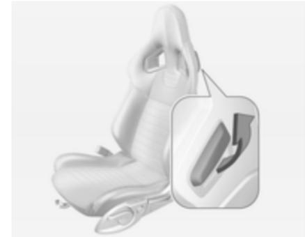
L'illustration montre le levier de déverrouillage d'un siège OPC.
