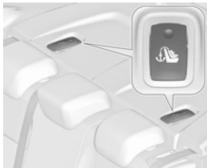
Sur le modèle tri-corps, ouvrir le rabat de l'oeillet d'attache concerné sur la zone de positionnement derrière les appuie-têtes; cette zone est repérée par le symbole de siège d'enfant.
