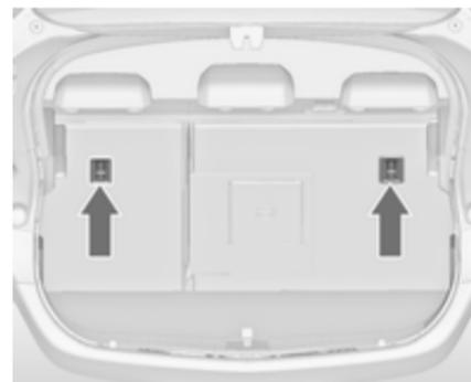
Sur les modèles Berline et Sports Tourer, les oeillets d'attache sont situés au dos des sièges arrière.
