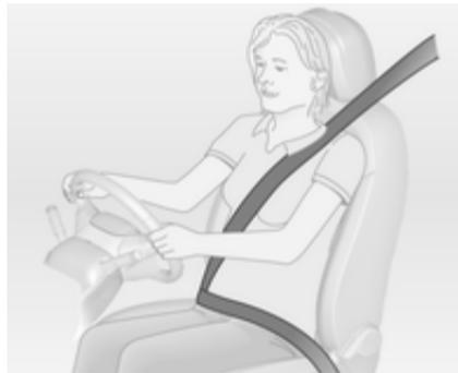
Tirer la ceinture de sécurité et l'encliqueter dans la serrure de ceinture. La ceinture de sécurité ne doit pas être vrillée et doit être placée près du corps. Le dossier ne doit pas être incliné trop en arrière (environ 25° maximum).
