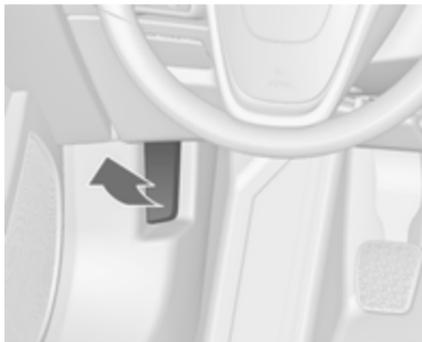
Tirer le levier de déverrouillage et le ramener dans sa position de départ.
