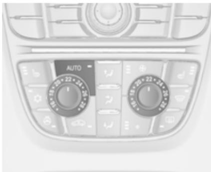
Si la température minimale est réglée, le système de commande de climatisation fonctionne avec sa capacité maximale de refroidissement, si le refroidissement
