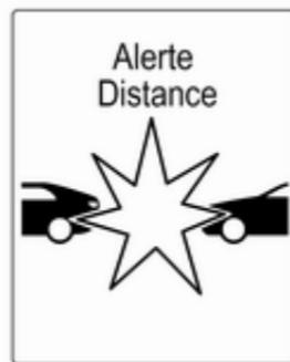
Lors de l'approche trop rapide d'un autre véhicule, la page d'alerte de collision sera affichée sur le centre d'informations du conducteur. En même temps, un carillon d'avertissement se fait entendre. Enfoncer la pédale de frein, si cela est exigé par la situation.
