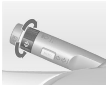
Les panneaux routiers sont affichés sur la page **Détection des panneaux routiers** sur le centre d'informations du conducteur, en sélectionnant avec la roue moletée de la manette des cliquotants ↻ 121.
