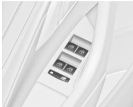
Appuyer sur le commutateur
