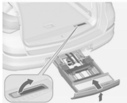
Pousser le levier de déverrouillage vers le haut et le tenir. Soulever légèrement le système et le pousser dans le pare-chocs jusqu'à ce qu'il s'enclenche.
