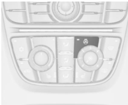
Activer le chauffage en appuyant sur le bouton
