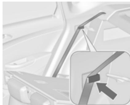
Si le véhicule doit être chargé via une porte arrière, sortir la ceinture de sécurité du guide de dossier et
