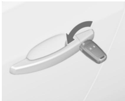
Déverrouiller manuellement la porte du conducteur en tournant la clé dans la serrure. Mettre le contact et appuyer sur le bouton de verrouillage central
