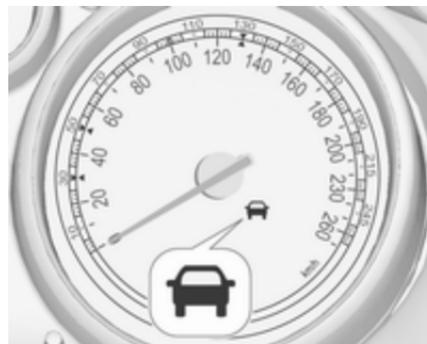
Le témoin de véhicule à l'avant allumé en vert
