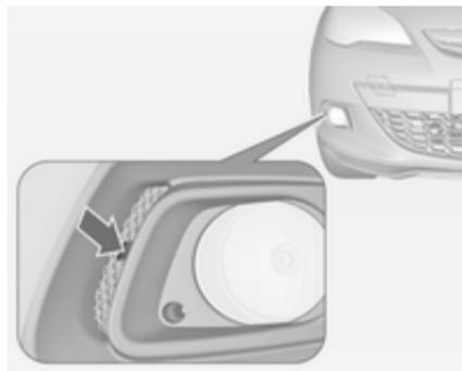
1. Décliqueter le couvercle avec un tournevis dans le logement et déposer le cache.
