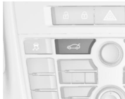
Avec les portes verrouillées par le verrouillage central, le couvercle du coffre ne peut pas être ouvert avec le bouton
