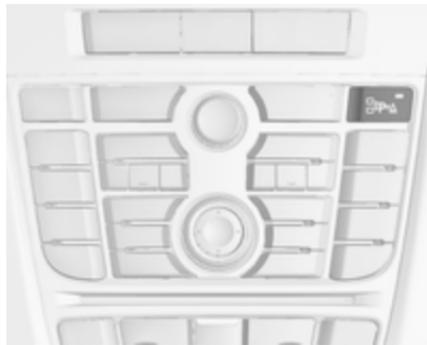
Lors de la recherche d'un emplacement de parking, le système doit être activé en poussant le bouton
