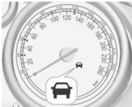
Le témoin de véhicule à l'avant allumé en vert
