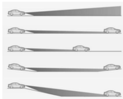
Une fonction d'évaluation topographique spéciale détecte les véhicules en avant lors de la conduite sur des pentes ou collines en reconnaissant le mouvement de l'éclairage arrière du véhicule en avant. Le système règle la hauteur de la portée de feux afin d'assurer un éclairage optimal de la route en avant sans éblouissement.
