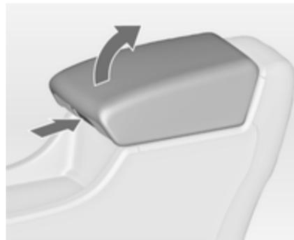
Appuyer sur le bouton pour relever l'accoudoir. L'accoudoir doit être relevé au maximum.
