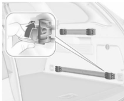
Ouvrir la plaque de fixation, placer l'adaptateur dans la rainure supérieure et inférieure du rail et les amener aux endroits voulus. Basculer la plaque de fixation vers le haut pour
