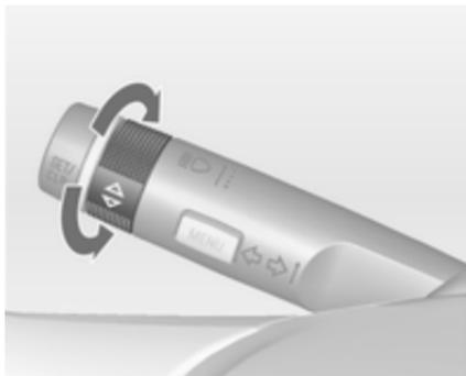
Les panneaux routiers sont affichés sur la page **Détection des panneaux routiers** sur le centre d'informations du conducteur, en sélectionnant avec la roue moletée de la manette des clignotants ↻ 124.
