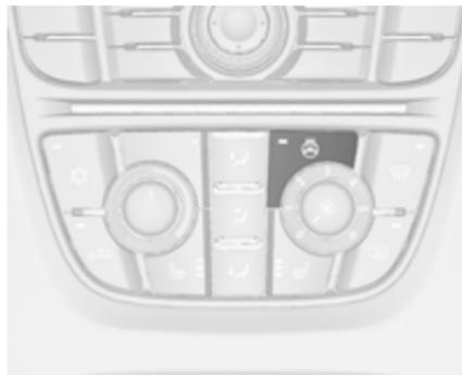
Activer le chauffage en appuyant sur le bouton
