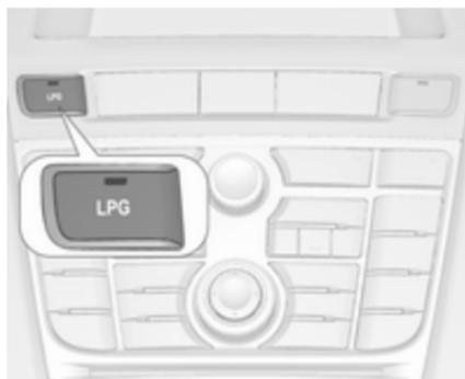
L'actionnement du bouton **LPG** permet le basculement entre les modes de fonctionnement à l'essence et au gaz de pétrole liquéfié dès que les paramètres requis (température de liquide de refroidissement et régime moteur minimal) ont été atteints. Les exigences sont généralement satisfaites environ après 60 secondes (en fonction de la température extérieure) et le premier enfoncement net de la pédale d'accélérateur. La LED indique le mode de fonctionnement en cours.
