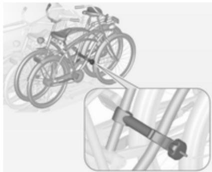
Utiliser l'étrier de montage court pour fixer le quatrième vélo. L'étrier doit être fixé entre les cadres du troisième et quatrième vélos.
