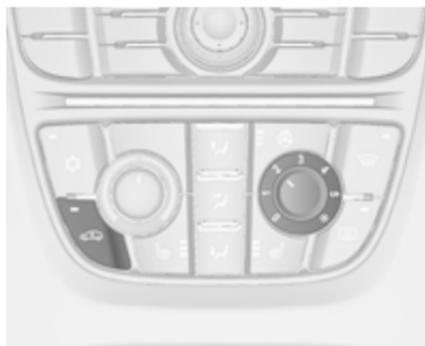
Appuyer sur le bouton
