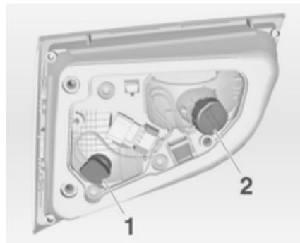
4. Déposer le support d'ampoule en le tournant dans le sens anti-horaire et remplacer l'ampoule en la soulevant ou la poussant légèrement dans la douille et la faire tourner dans le sens anti-horaire :
