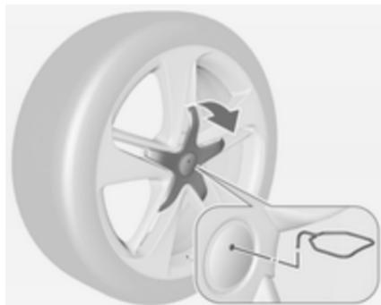
Roues en alliage léger avec capuchon d'écrou central : Dégager le capuchon central en insérant et en tirant l'extracteur dans le creux de l'emblème de la marque, outillage de véhicule ⇨ 275.
