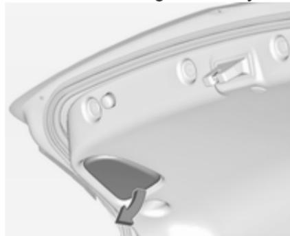
1. Ouvrir le hayon et déposer le capot du côté concerné.
