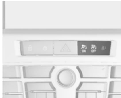
Si le témoin
