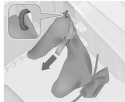
Le sac avec la barre d'attelage est rangé dans le compartiment de rangement arrière sur le plancher. Placer la sangle dans l'anneau d'arrimage, passer deux fois autour et serrer la sangle pour fixer le sac.
