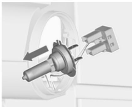
3. Désengager l'ampoule du connecteur en tirant.
