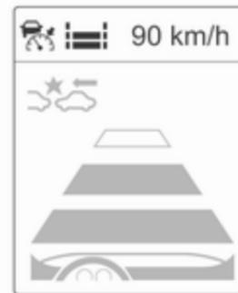
Il est à noter que le réglage de sensibilité de temporisation d'alerte est partagé avec le réglage de la distance vers l'avant du régulateur de vitesse adaptatif. Donc modifier la sensibilité de la temporisation d'alerte change le réglage de distance vers l'avant du régulateur de vitesse adaptatif.
