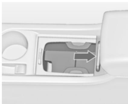
Selon le modèle, les porte-gobelets se trouvent sous un couvercle dans la console centrale. Faire glisser le couvercle vers l'arrière. Il est possible de ranger des bouteilles lorsque l'étagère intermédiaire est relevée ↪ 66.
