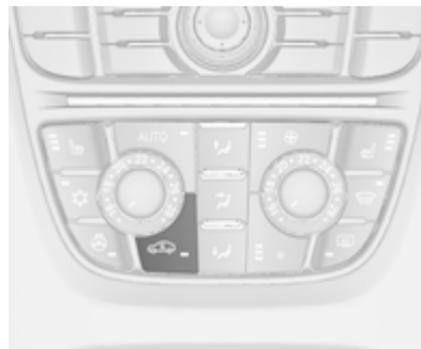
Appuyer sur le bouton
