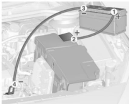
Séquence de raccordement des câbles :
