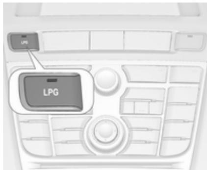
Appuyer sur le bouton **LPG** pour commuter entre mode essence et mode gaz de pétrole liquéfié. La LED ● indique le mode de fonctionnement en cours.
