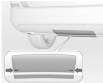
Enfoncer les fixations et déposer le recouvrement, sauf pour le modèle berline 3 portes.
