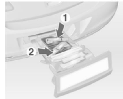
Rabattre les supports d'ampoule au dos des feux arrière.
