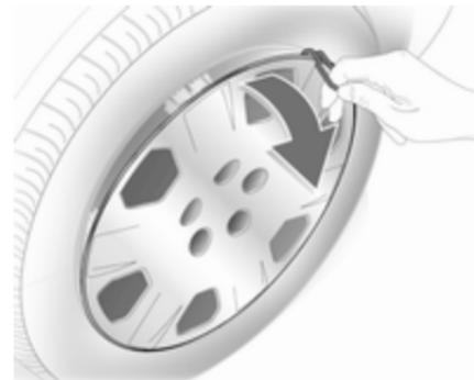
1. Dégager et retirer les capuchons des écrous de roue à l'aide d'un tournevis. Enlever l'enjoliveur à l'aide du crochet. Outillage de bord ↷ 275.
