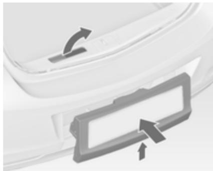
Pousser le levier de déverrouillage vers le haut et le tenir. Soulever légèrement le système et le pousser dans le pare-chocs jusqu'à ce qu'il s'enclenque.
