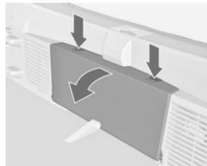
2. Uniquement modèle berline 3 portes : retirer le rangement à l'arrière en appuyant sur les deux boutons. Ouvrir le couvercle et extraire le rangement par le haut.
