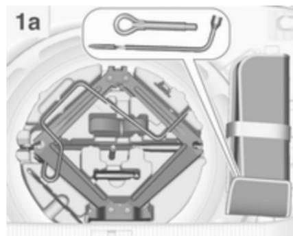
Le cric, les outils et une sangle de fixation pour roue endommagée se trouvent dans la boîte à outils, sous la roue de secours dans le coffre. La clé de roue et l'oeillet de remorquage sont rangés dans un sac à outils se trouvant dans la niche de roue de secours, à côté de la boîte à outils. Roue de secours ⇨ 291.
