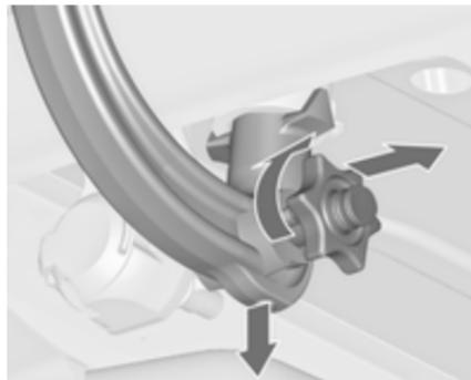
Ouvrir le volet de protection et tourner la clé en position
