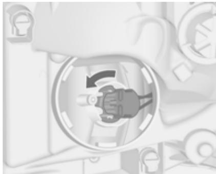
2. Faire tourner la douille de l'ampoule dans le sens antihoraire pour la désencliquer. Retirer la douille de l'ampoule du réflecteur.
