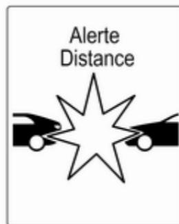
Lors de l'approche trop rapide d'un autre véhicule, la page d'alerte de collision sera affichée sur le centre d'informations du conducteur. En même temps, un carillon d'avertissement se fait entendre. Appuyer sur la pédale de frein, si la situation l'exige.
