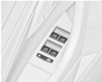
Appuyer sur le commutateur
