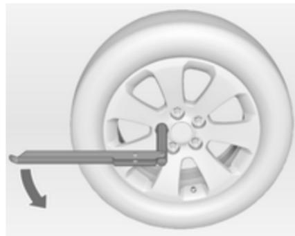
Déplier la clé de roue et la placer de sorte qu'elle soit bien positionnée et dévisser chaque écrou de roue d'un demi-tour.
