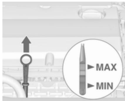
En fonction du moteur, différentes jauges d'huile sont utilisées.
