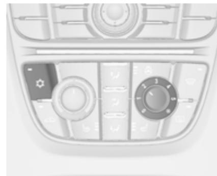
Appuyer sur le bouton
