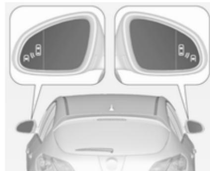
L'alerte d'angle mort latéral est activée lorsque le véhicule roule à des vitesses allant de 10 km/h à 140 km/h. Conduire à une vitesse supérieure à 140 km/h désactive le système, ce qui est indiqué par les symboles d'avertissement à faible luminosité <sup>a</sup><sup>b</sup> sur les deux rétroviseurs extérieurs. Ralentir à nouveau éteindra les symboles d'avertissement. Si un véhicule est alors détecté dans la zone d'angle
