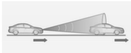
Le régulateur de vitesse adaptatif utilise un capteur de radar pour détecter le véhicule à l'avant. Si aucun
