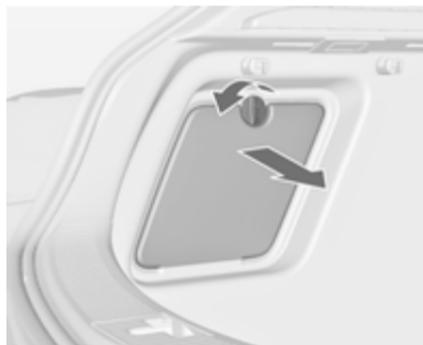
1. Détacher le capot sur le côté concerné et le déposer.
