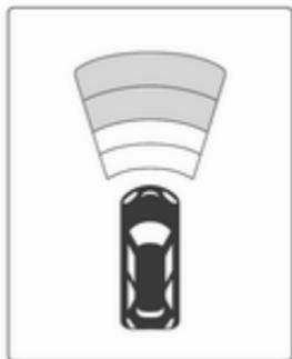
Sur les modèles avec affichage de niveau supérieur, la distance par rapport à un obstacle avant est indiquée par des segments variants.
