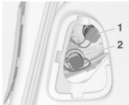
2. Déposer le support d'ampoule en le tournant et remplacer l'ampoule en la soulevant ou la poussant légèrement dans la douille et la faire tourner dans le sens anti-horaire :
