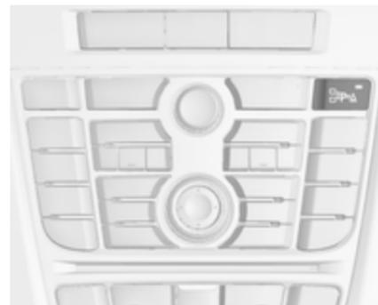
Lors de la recherche d'un emplacement de parking, le système doit être activé en poussant le bouton
