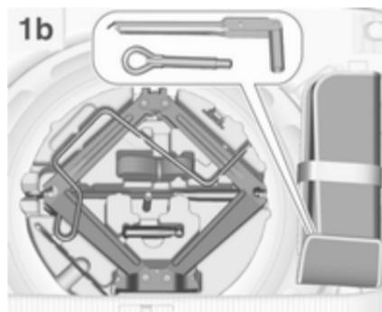
Même contenu que la variante **1a** mais avec une clé à écrou pliable à la place d'une clé à écrou rigide dans la trousse à outils.
