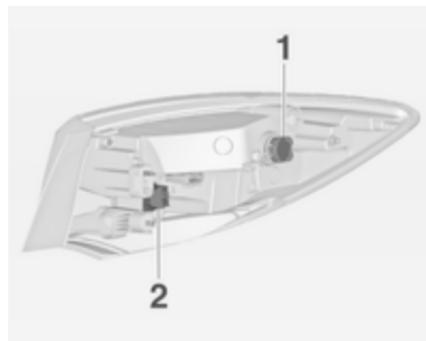
5. Déposer le support d'ampoule en le tournant et remplacer l'ampoule en la soulevant ou la poussant légèrement dans la douille et la faire tourner dans le sens anti-horaire :
