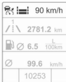
Le symbole de régulateur de vitesse adaptatif, le réglage de la distance vers l'avant et la vitesse réglée sont affichés sur la ligne supérieure du centre d'informations du conducteur.
