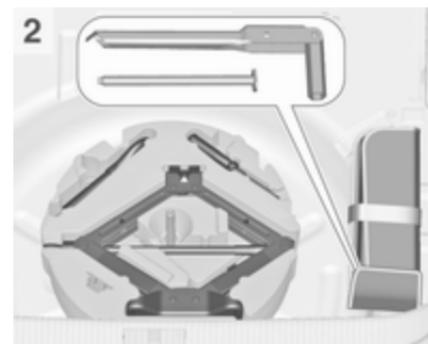
Le cric, les outils et l'oeillet de remorquage sont rangés dans la boîte à outils sous la roue de secours dans le coffre. La clé de roue et un boulon à tige longue pour la fixation de la roue endommagée (uniquement pour les véhicules dotés d'une roue de dépannage temporaire) sont placés dans le sac d'outils se trouvant dans la niche de roue de secours, à côté de la boîte à outils. Roue de secours ⇨ 291.
