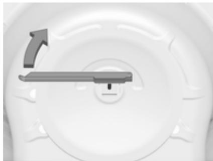
2. Uniquement Sports Tourer et tri-corps 4 portes avec roue de dépannage temporaire : remplacer le boulon à tige longue par un boulon court en utilisant la clé hexagonale de la clé à roue.
