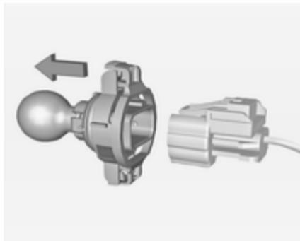
4. Dégager le connecteur de la douille d'ampoule en enfonçant la patte de retenue.
