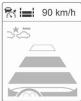
La distance vers l'avant sélectionnée est indiquée par les barres de distance remplies sur la page du régulateur de vitesse adaptatif.
