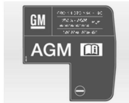
Une batterie AGM se reconnaît à l'étiquette sur la batterie. Nous recommandons d'utiliser une batterie de véhicule d'origine Opel.
