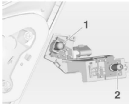
5. Déposer et remplacer l'ampoule en la soulevant ou la poussant légèrement dans la douille et la faire tourner dans le sens anti-horaire :
