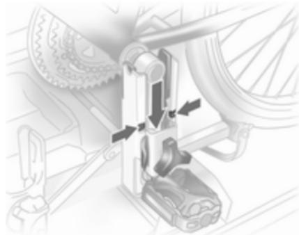
Introduire le support de manivelle dans le rail de chaque logement de manivelle depuis le haut et le coulisser vers le bas au moins jusqu'aux encoches.
