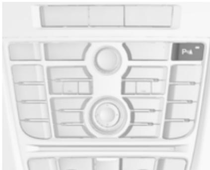
L'aide au stationnement sera activée et désactivée en appuyant sur le bouton d'aide au stationnement **P**
