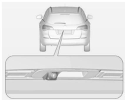
La caméra est montée sur la poignée du hayon et a un angle de vision de 130°.
