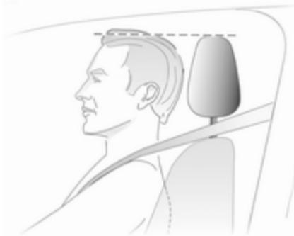
Le bord supérieur de l'appui-tête doit toujours être au niveau du haut de la tête. Si cela s'avérait impossible pour des personnes de très grande taille, l'appui-tête doit être réglé sur la posi-
