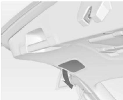
Le feu antibrouillard arrière et ensuite le feu de recul (2) selon le côté, peuvent être remplacés en déposant le couvercle dans le hayon sans avoir à retirer l'ensemble du feu : déposer le capot, tourner le support d'ampoule et remplacer l'ampoule en vissant dans le sens anti-horaire.
