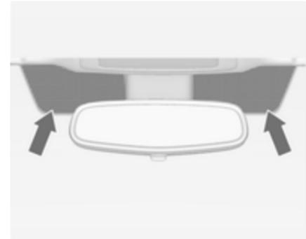
Les zones repérées du pare-brise ne sont pas recouvertes de ce film. Les dispositifs pour l'enregistrement de données électronique et le paiement
