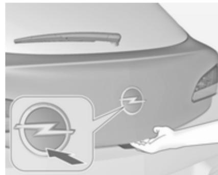
Appuyer sur le bouton
