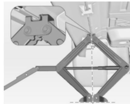
Passer le cric à la hauteur requise. Le placer directement sous le point de levage de manière à ce qu'il ne glisse pas.
