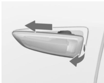
1. Du côté gauche du véhicule, faire coulisser le feu vers l'avant et l'extraire de l'aile avant avec l'extrémité arrière.
