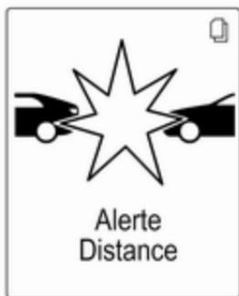
Lors de l'approche trop rapide d'un autre véhicule, la page d'alerte de collision sera affichée sur le centre d'informations du conducteur. En même temps, un carillon d'avertissement se fait entendre. Appuyer sur la pédale de frein, si la situation l'exige.
