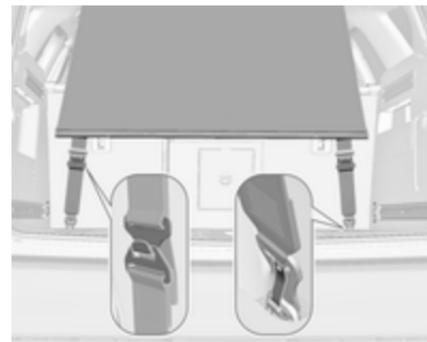
Fixer le crochet inférieur avec l'ouverture faisant face vers l'arrière sur l'anneau de gauche et de droite du plancher. Régler la longueur de la sangle
