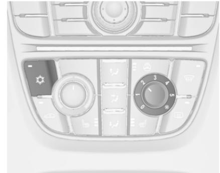
Appuyer sur le bouton
