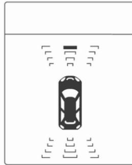
Sur le modèle avec affichage de niveau supérieur-combi, la distance par rapport à un obstacle avant et arrière est indiquée par les lignes de distance changeantes autour du véhicule.
