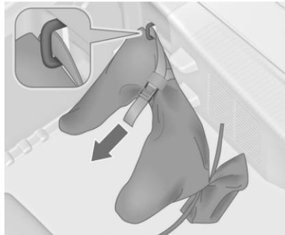
Le sac avec la barre d'attelage se trouve dans le compartiment de rangement arrière dans le plancher. Placer la sangle dans l'anneau d'arrimage, passer deux fois autour et serrer la sangle pour fixer le sac.
