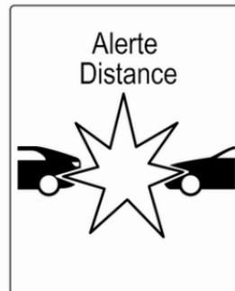
Lorsque la distance avec un véhicule en mouvement à l'avant est trop petite ou lorsque vous approchez trop rapidement d'un autre véhicule et qu'une collision est imminente, le symbole d'alerte de collision s'affiche dans le Centre d'informations du conducteur.
