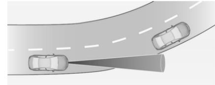
Le régulateur de vitesse adaptatif calcule une voie estimée, basée sur la force centrifuge. Cette voie estimée considère la caractéristique de virage réelle, mais ne peut pas considérer un changement de virage futur. Le système peut perdre le véhicule à l'avant ou considérer un véhicule qui n'est pas dans la voie actuelle. Ceci peut se réduire lors de l'entrée ou la sortie d'un virage ou si le virage devient plus prononcé ou moins
