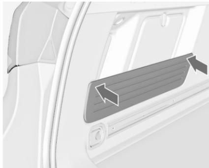
Lors de l'assemblage, enfoncer le cache sur le côté gauche dans les pastilles en caoutchouc pour obtenir une force de fixation maximale.
