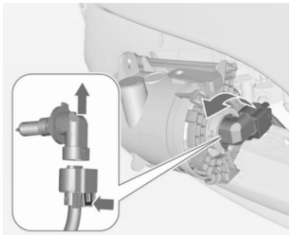
3. Tourner la douille d'ampoule dans le sens anti-horaire et l'enlever du réflecteur.
