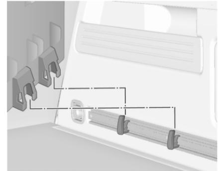
En variante, installer deux crochets dans le rail inférieur. Enficher les consoles inférieures de la boîte dans les crochets inférieurs, depuis le haut.
