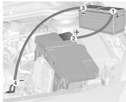
Séquence de raccordement des câbles :
