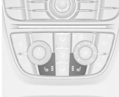
En fonction du niveau de chauffage voulu, appuyer une ou plusieurs fois sur le bouton ☀ du siège respectif. Le témoin dans le bouton indique le réglage sélectionné.
