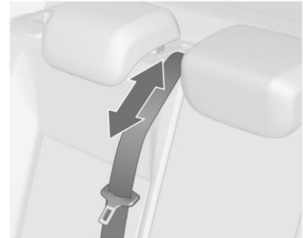
La ceinture de sécurité du siège central pourrait coincée lorsque le dossier est soulevé trop rapidement. Pour débloquer l'enrouleur, rentrer la ceinture de sécurité ou la sortir d'environ 20 mm, puis relâcher.
