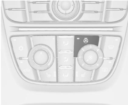
Activer le chauffage en appuyant sur le bouton . L'activation est signalée par la LED dans le bouton.
