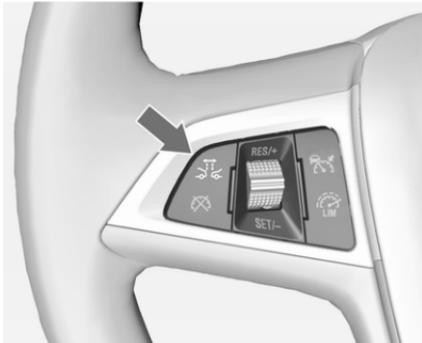
Appuyer sur le bouton ; le réglage actuel est affiché sur le centre d'informations du conducteur. Appuyer de nouveau sur le bouton pour changer la distance vers l'avant. Le réglage est également affiché sur la ligne supérieure du centre d'informations du conducteur.
