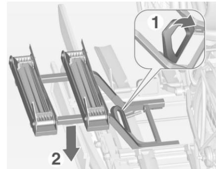
2. Tourner le levier (1) vers l'avant et le maintenir, abaisser alors l'adaptateur (2) sur l'arrière.
