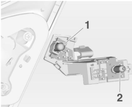
5. Déposer et remplacer l'ampoule en la soulevant ou la poussant
