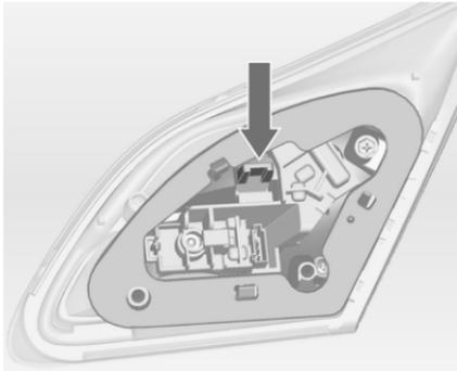
4. Enfoncer la patte de retenue et enlever le support d'ampoule de l'ensemble de feu.
