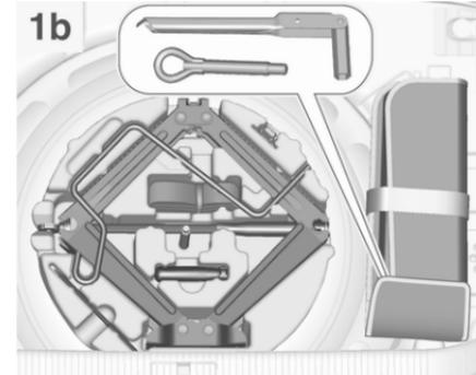
Même contenu que la variante 1a mais avec une clé à écrou pliable à la place d'une clé à écrou rigide dans la trousse à outils.
