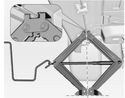
Régler le cric à la hauteur requise. Le positionner directement sous le point de levage de manière telle qu'il ne glisse pas.
