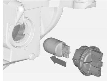
2. Retirer l'ampoule de la douille en tirant.
