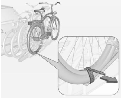
6. En plus, attacher les deux roues du quatrième vélo aux logements de roue en utilisant les sangles de serrage.
