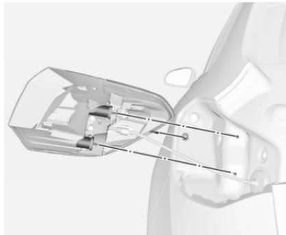
4. Retirer avec précaution l'ensemble de feu arrière du renforcement et le déposer. S'assurer que la goulotte de câbles reste en place.
