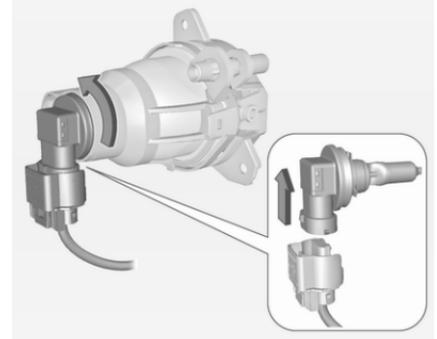
4. Tourner la douille d'ampoule dans le sens anti-horaire et l'enlever du réflecteur.
