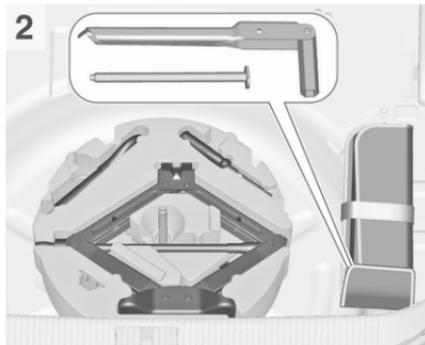
Le cric, les outils et l'oeillet de remorquage sont rangés dans la boîte à outils sous la roue de secours dans le coffre. La clé de roue et un boulon à tige longue pour la fixation de la roue endommagée (uniquement pour les véhicules dotés d'une roue de dépannage temporaire) sont placés dans le sac d'outils se trouvant dans la niche de roue de secours, à côté de la boîte d'outils. Roue de secours ↻ 287.
