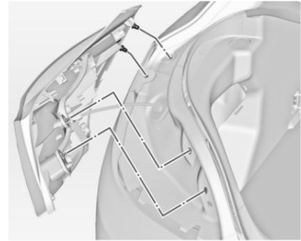
3. Retirer avec précaution l'ensemble de feu arrière du renforcement et le déposer. S'assurer que la goulotte de câbles reste en place.
