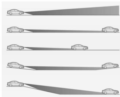
Une fonction d'évaluation topographique spéciale détecte les véhicules en avant lors de la conduite sur des
