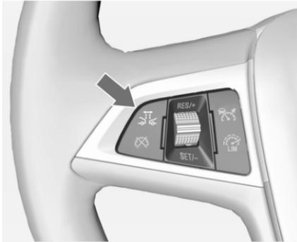
Appuyer sur le bouton ; le réglage actuel est affiché sur le centre d'informations du conducteur. Appuyer de nouveau sur le bouton pour changer la sensibilité de l'alerte. Le réglage est également affiché sur la ligne supérieure du centre d'informations du conducteur.
