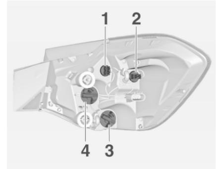
6. Déposer le support d'ampoule en le tournant dans le sens anti-horaire et remplacer l'ampoule en la soulevant ou la poussant légèrement dans la douille et la faire tourner dans le sens anti-horaire :
