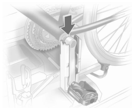
Placer le vélo. La manivelle de pédale doit alors être positionnée dans l'ouverture du logement pour manivelle, comme illustré.
