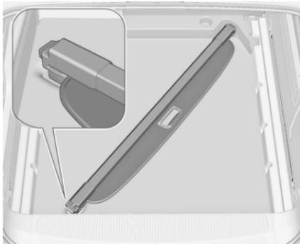
Une fois retiré, le cache peut être rangé sous le recouvrement de plancher arrière comme illustré.
