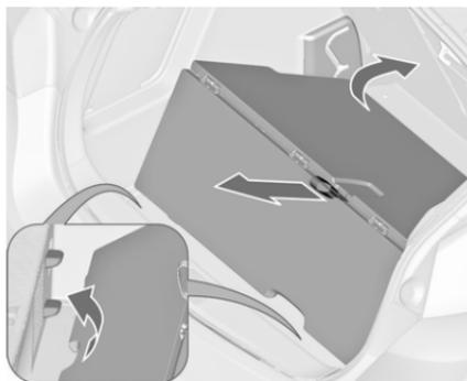
Pour relever le recouvrement à un niveau supérieur, tirer la boucle vers l'arrière et soulever le bord arrière du recouvrement sur les supports correspondants.
