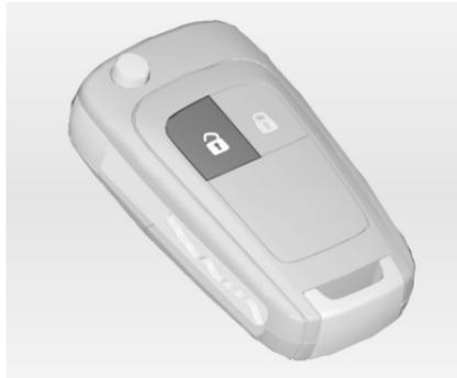
Appuyer sur le bouton
