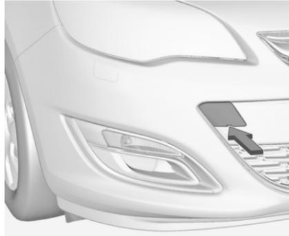
Insérer un tournevis dans la fente sur la partie basse du capuchon. Déga-ger le capuchon en enfonçant avec précaution le tournevis vers le bas. L'œillet de remorquage se trouve dans l'outillage du véhicule ↪ 270.
