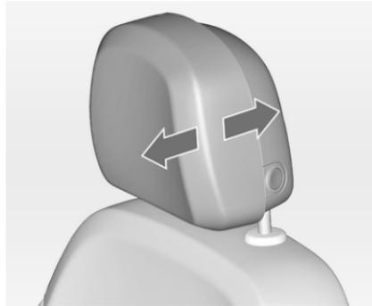
Pour procéder au réglage horizontal, tirer l'appui-tête vers l'avant. Il s'encliquette dans plusieurs positions.
