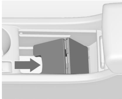
Un autre compartiment de rangement est situé sous l'étagère intermédiaire. Relever l'étagère intermédiaire et la fixer dans la position verticale. Le cadre du porte-gobelets peut être réinstallé pour ranger des bouteilles.
