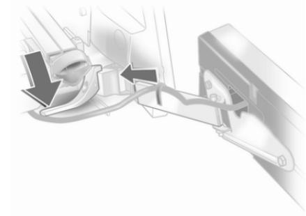
Enfoncer la poignée de verrouillage et pousser le support d'ampoule dans le dispositif de retenue jusqu'à ce qu'il s'enclique.
