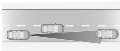
Si un autre véhicule entre dans la même voie de circulation, le régulateur de vitesse adaptatif considérera le véhicule lorsqu'il est complètement
