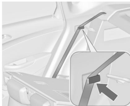
Si le véhicule doit être chargé via une porte arrière, sortir la ceinture de sécurité du guide de dossier et la placer derrière l'attache (comme illustré).
