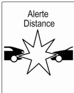
Si un véhicule directement devant est approché trop rapidement, un carillon d'avertissement retentit et une alarme est affichée sur le centre d'informations du conducteur.
