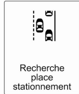
Quand le véhicule passe le long d'une rangée de voitures et que le système est activé, le système avancé d'assistance au stationnement commence à rechercher un emplacement de stationnement adéquat. Lorsqu'une place adéquate est trouvée, une information de retour visuelle s'affiche sur le centre d'informations du conducteur et un signal acoustique est donné.
