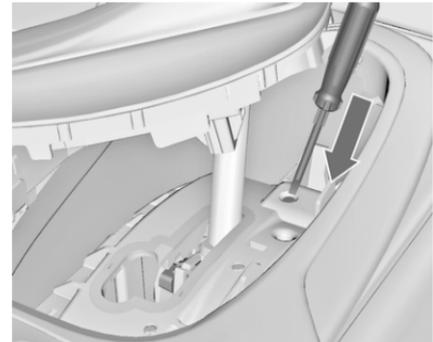
3. Introduire un tournevis aussi loin que possible dans l'ouverture et déplacer le levier sélecteur de la position **P** ou **N**. Si le levier sélecteur est à nouveau ramené en position **P** ou **N**, il sera à nouveau bloqué dans cette position. Faire corriger la cause de la coupure de courant par un atelier.
