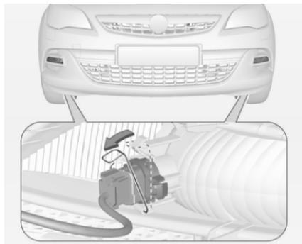
1. Désencliqueter l'attache ressort, puis la pivoter vers l'arrière.
