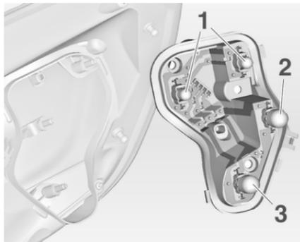
7. Déposer et remplacer l'ampoule en la soulevant ou la poussant
