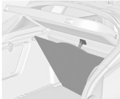
Le couvercle de plancher arrière peut être soulevé. Faire glisser la boucle dans le crochet sur le côté inférieur du cache-bagages.
