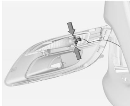
3. Dégager la douille d'ampoule du réflecteur en enfonçant les deux pattes de retenue.
