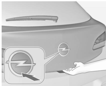
Appuyer sur le bouton
