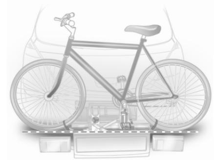
Disposer les logements de roue de sorte que le vélo soit plus ou moins horizontal. La distance entre les pédales et le hayon doit alors être d'au moins 5 cm.
