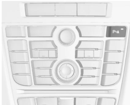
L'aide au stationnement avant-arrière est dotée du bouton **P▲**. Si le véhicule est en outre équipé d'un système avancé d'assistance au stationnement (voir plus bas la description distincte de ce système), le système est doté du bouton **P▲**. Dans ce cas, les deux systèmes seront opérés par le bouton **P▲**.
