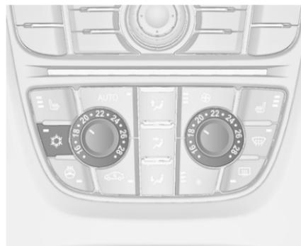
Appuyer sur le bouton ☼ pour mettre le refroidissement en marche. L'activation est signalée par la LED dans le
