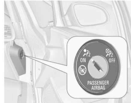
Le système d'airbag de passager avant peut être désactivé via un commutateur à clé situé sur le côté droit de la planche de bord.
