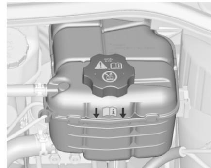
Si le système de refroidissement est froid, le niveau de liquide de refroidissement doit se trouver au-dessus du repère de niveau de remplissage. Faire l'appoint si le niveau est bas.
