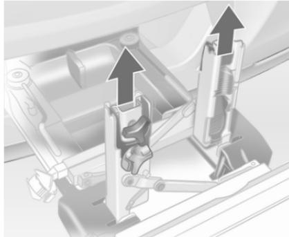
Enlever les fixations de manivelle de pédale des logements de manivelle de pédale.
