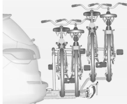
Le système de transport arrière (système Flex-Fix) permet de fixer deux vélos au support de transport extractible intégré dans le plancher du véhicule. Il est possible de fixer deux vélos supplémentaires sur un adaptateur. Le transport d'autres objets n'est pas autorisé.
