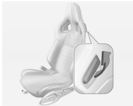
L'illustration montre le levier de déverrouillage d'un siège OPC.
