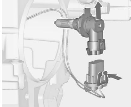
3. Dégager la douille d'ampoule du connecteur en enfonçant la patte de retenue.
