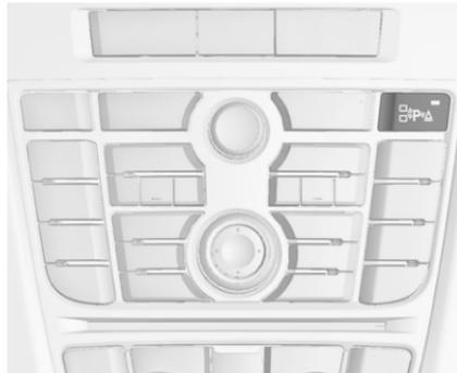
Lors de la recherche d'un emplacement de parking, le système doit être activé en appuyant sur le bouton
