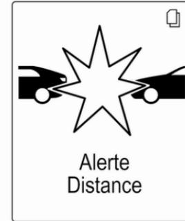
Un témoin de véhicule à l'avant vert s'allume sur le combiné d'instruments lorsque le système a détecté un véhicule sur la voie de circulation. Lorsque la distance avec un véhicule en mouvement à l'avant est trop petite ou lorsque vous approchez trop rapidement d'un autre véhicule et qu'une collision est imminente, le symbole d'alerte de collision s'affiche dans le Centre d'informations du conducteur. En même temps, un carillon d'avertissement se fait entendre.
