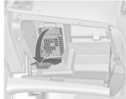
Dans les véhicules avec direction à droite, la boîte à fusibles se trouve derrière un cache dans la boîte à gants. Ouvrir la boîte à gants, puis ouvrir le couvercle et le rabattre.
