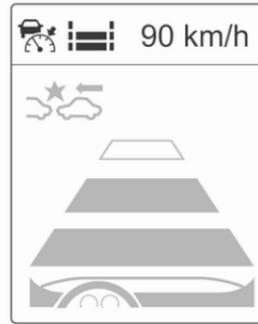
Il est à noter que le réglage de sensibilité de temporisation d'alerte est partagé avec le réglage de la distance vers l'avant du régulateur de vitesse adaptatif. Donc modifier la sensibilité de la temporisation d'alerte change le réglage de distance vers l'avant du régulateur de vitesse adaptatif.
