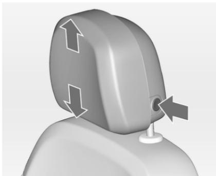
Appuyer sur le bouton de déverrouillage, régler la hauteur, engager.
