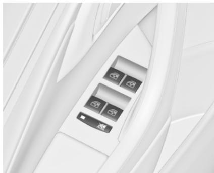
Appuyer sur le commutateur
