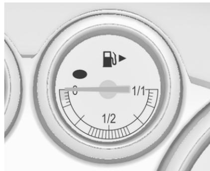
Affiche le niveau de remplissage de carburant ou le niveau de gaz dans le réservoir en fonction du mode de fonctionnement.
