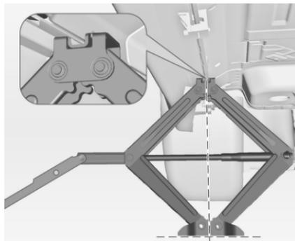
Régler le cric à la hauteur requise. Le positionner directement sous le point de levage de manière telle qu'il ne glisse pas.
