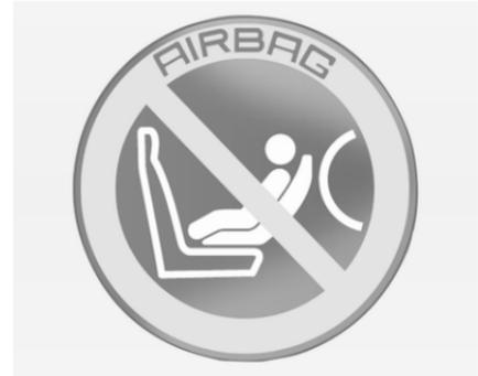
Par ailleurs, un autocollant d'avertissement se trouve sur le côté du tableau de bord, visible quand la porte du passager avant est ouverte ou sur le pare-soleil du passager avant.
