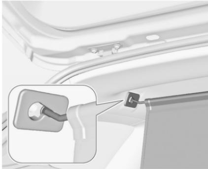
Il y a deux ouvertures de pose sur le cadre de toit : suspendre et engager la tige du filet sur un côté, comprimer la tige et suspendre et engager l'autre côté.
