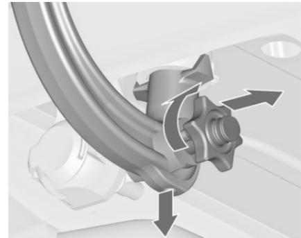
Ouvrir le volet de protection et tourner la clé en position
