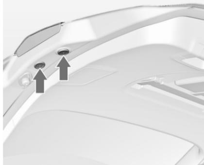
1. Ouvrir le hayon et déposer les caches du côté concerné.
