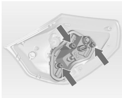
6. Dévisser les trois vis avec un tournevis et déposer le support d'ampoule de l'ensemble du feu.
