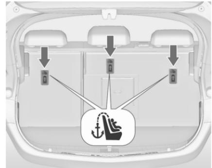
Sur les modèles Berline et Sports Tourer, les oeilletons d'attache sont situés au dos des sièges arrière.
