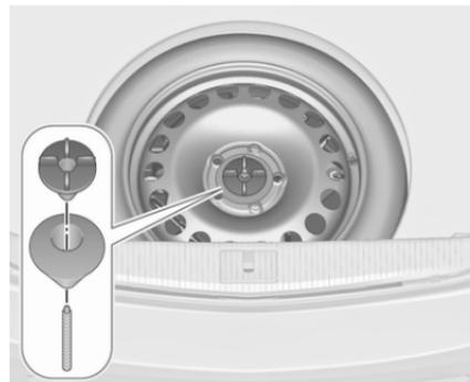
Uniquement modèle berline 3 portes : positionner le cône excentrique dans le renforcement de la roue de secours avant de revisser l'écrou papillon.
