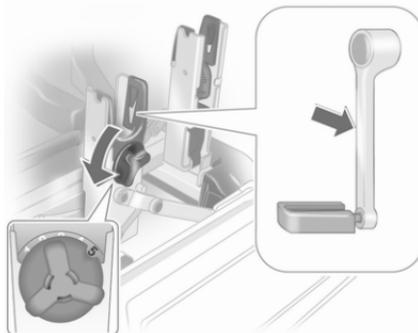
Grâce au levier rotatif du logement de manivelle de pédale, adapter grossièrement l'ensemble réglable pour manivelle au débordement de la manivelle de pédale.
