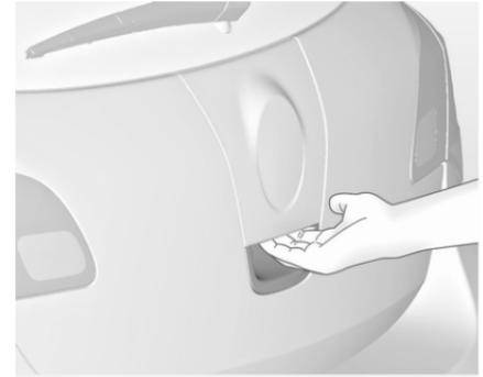
Après le déverrouillage, toucher le commutateur tactile sous l'emblème de la marque et ouvrir le hayon.
