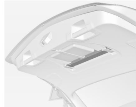
Replier les sangles. Ranger le triangle de présignalisation dans l'espace situé derrière les sangles sur face intérieure du hayon.
