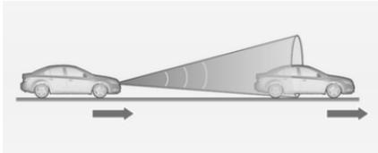
Le régulateur de vitesse adaptatif utilise un capteur de radar pour détecter le véhicule à l'avant. Si aucun véhicule n'est détecté dans la voie, le régulateur de vitesse adaptatif se comportera comme un régulateur de vitesse traditionnel.
