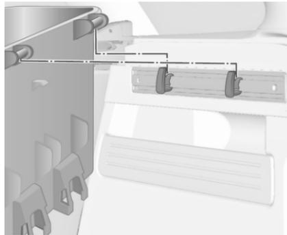
Installer deux crochets dans le rail supérieur. Introduire les consoles supérieures de la boîte dans les crochets depuis le haut.
