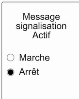
Une fois que la page des réglages est affichée, sélectionner **Arrêt** pour désactiver la fonction de surimpression. Réactiver en choisissant **Marche**. En mettant le contact, la fonction de surimpression est désactivée.
