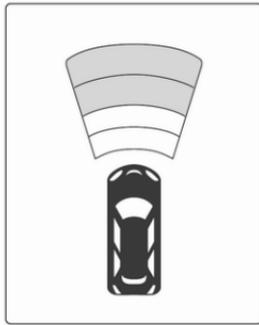
Sur les modèles avec affichage de niveau supérieur, la distance par rapport à un obstacle avant est indiquée par des segments variants.
