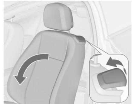
Soulever la poignée de déverrouillage et replier le dossier vers l'avant. Coulisser le siège vers l'avant.
