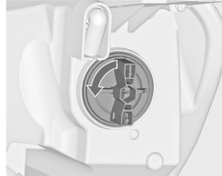
1. Faire tourner la douille de l'ampoule (2) dans le sens antihoraire pour la désencliqueter. Retirer la douille de l'ampoule du réflecteur.
