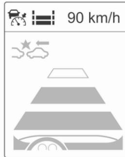
La distance vers l'avant sélectionnée est indiquée par les barres de distance remplies sur la page du régulateur de vitesse adaptatif.
