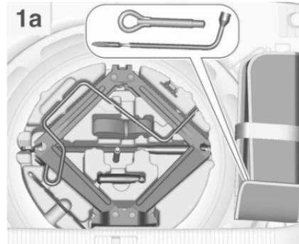
Le cric, les outils et une sangle de fixation pour roue endommagée se trouvent dans la boîte à outils, sous la roue de secours dans le coffre. La clé de roue et l'oeillet de remorquage sont rangés dans un sac à outils se trouvant dans la niche de roue de secours, à côté de la boîte à outils. Roue de secours ↻ 287.
