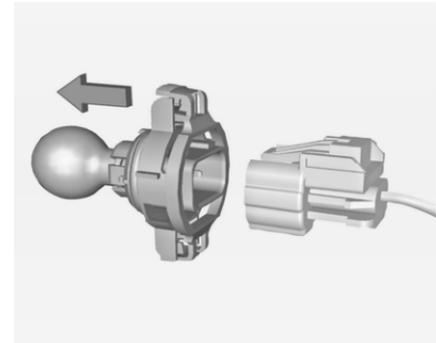
4. Dégager le connecteur de la douille d'ampoule en enfonçant la patte de retenue.
