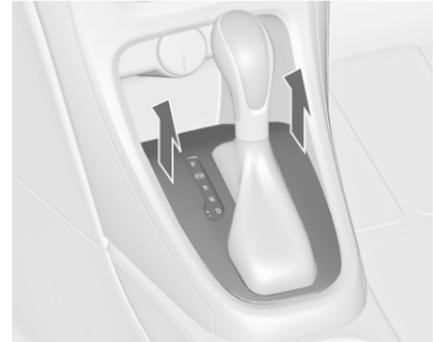
2. Dégager l'avant du garnissage du levier sélecteur de la console, le relever et le faire tourner vers la gauche.
