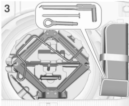
Le cric et les outils sont rangés dans la boîte à outils sous la roue de secours dans le coffre. La clé de roue, l'oeillet de remorquage et un boulon à tige longue pour la fixation de la roue endommagée (uniquement pour les véhicules dotés d'une roue de dépannage temporaire) sont placés dans le sac d'outils se trouvant dans la niche de roue de secours, à côté de la boîte d'outils. Roue de secours ↻ 287.
