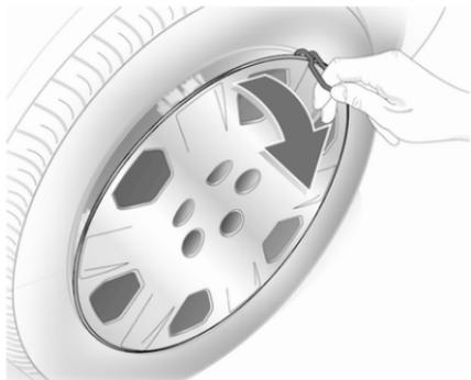
1. Dégager et retirer les capuchons des écrous de roue à l'aide d'un tournevis. Enlever l'enjoliveur à l'aide du crochet. Outillage de bord ⇨ 270.
