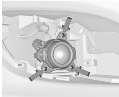
3. Dévisser les trois vis et déposer l'ensemble du feu antibrouillard du pare-chocs.
