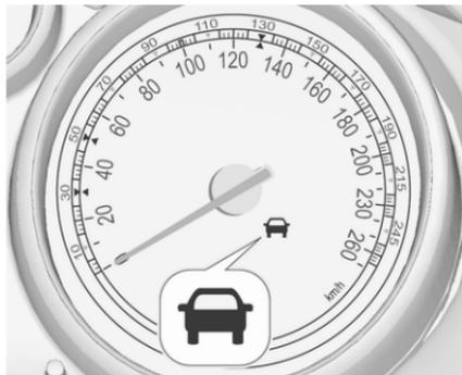
Le témoin de véhicule à l'avant allumé en vert
