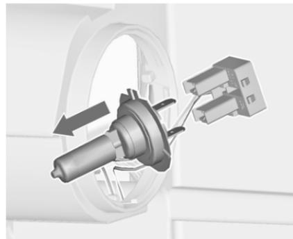
3. Désengager l'ampoule du connecteur en tirant.
