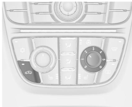
Appuyer sur le bouton
