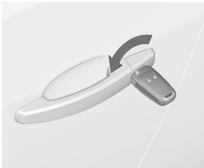
Déverrouiller manuellement la porte du conducteur en tournant la clé dans la serrure. Mettre le contact et appuyer sur le bouton de verrouillage central
