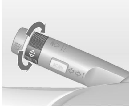
Les panneaux routiers sont affichés sur la page **Détection des panneaux routiers** sur le centre d'informations du conducteur, en sélectionnant avec la roue moletée de la manette des clignotants ↻ 122.
