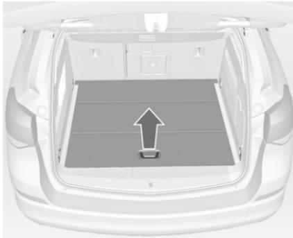
Soulever le recouvrement de plancher arrière en tirant la poignée.
