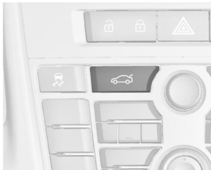
Avec les portes verrouillées par le verrouillage central, le couvercle du coffre ne peut pas être ouvert avec le bouton
