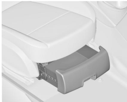
Appuyer sur le bouton de l'enfoncement et sortir le tiroir. Charge maximale : 3 kg. Pour fermer, repousser et engager.
