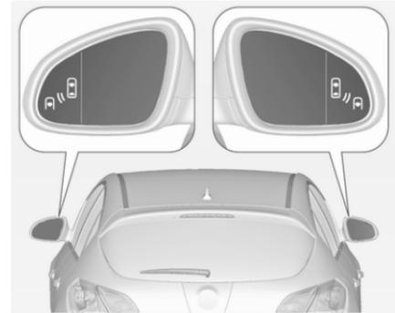
L'alerte d'angle mort latéral est activée lorsque le véhicule roule à des vitesses allant de 10 km/h à 140 km/h. Conduire à une vitesse supérieure à 140 km/h désactive le système, ce qui est indiqué par les symboles d'avertissement à faible luminosité **A** sur les deux rétroviseurs extérieurs. Ralentir à nouveau éteindra les symboles d'avertissement. Si
