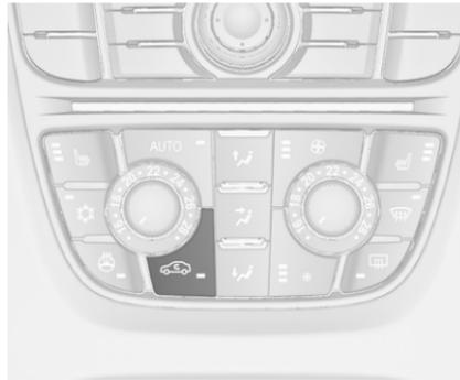
Appuyer sur le bouton
