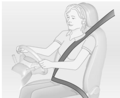
Tirer la ceinture de sécurité et l'enclenquer dans la serrure de ceinture. La ceinture de sécurité ne doit pas être vrillée et doit être placée près du corps. Le dossier ne doit pas être incliné trop en arrière (environ 25° maximum).
