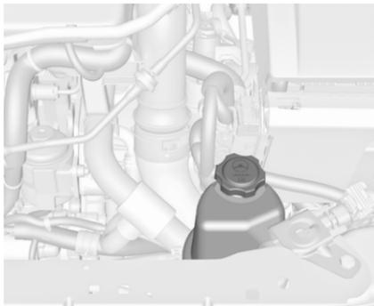
Le niveau du liquide de direction assistée ne doit normalement pas être vérifié. Si un bruit inhabituel est
