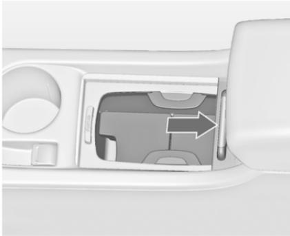
Selon le modèle, les porte-gobelets se trouvent sous un couvercle dans la console centrale. Faire glisser le couvercle vers l'arrière. Il est possible de ranger des bouteilles lorsque l'étagère intermédiaire est relevée
