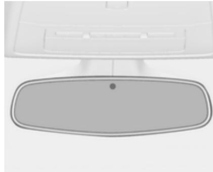
L'éblouissement dû aux véhicules suivants est automatiquement réduit lors des déplacements de nuit.
