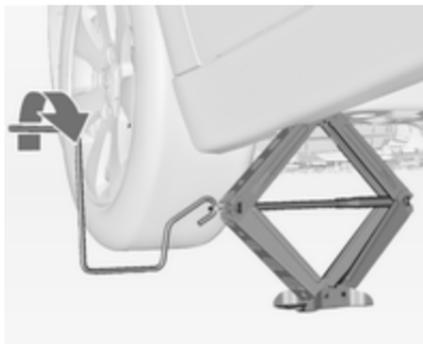
Attacher la poignée de cric avec le cric correctement aligné, faire tourner la poignée jusqu'à ce que la roue soit dégagée du sol.
