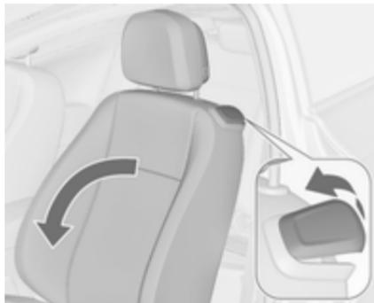
Soulever la poignée de déverrouillage et replier le dossier vers l'avant. Coulisser le siège vers l'avant.
