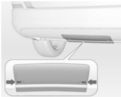
Toutes les versions, sauf berline 3 portes : Appuyer sur les attaches vers l'intérieur et plier le couvercle vers le bas à l'avant. Retirer le couvercle.
