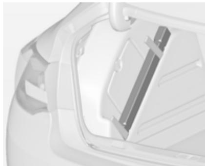
Ranger le triangle de présignalisation dans le renforcement sur le côté gauche du coffre.
