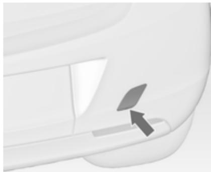
Insérer un tournevis dans la fente sur la partie basse courbe du capuchon. Dégager le capuchon en enfonçant avec précaution le tournevis vers le bas.
