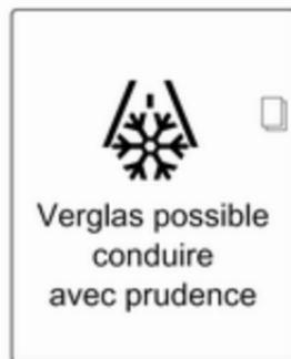
Si la température extérieure descend jusqu'à 3 °C, un message d'avertissement est affiché sur le centre d'informations du conducteur avec affichage de combiné de niveau supérieur.
