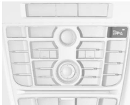
Lors de la recherche d'un emplacement de parking, il convient d'activer le système en appuyant sur le bouton
