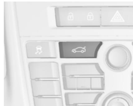
Avec les portes verrouillées par le verrouillage central, le couvercle du coffre ne peut pas être ouvert avec le bouton
