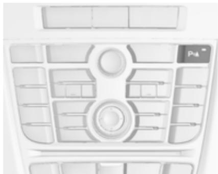
L'aide au stationnement avant-arrière est dotée du bouton **P**▲. Si le véhicule est en outre équipé d'un système avancé d'aide au stationnement (voir la description distincte ci-après), le système est équipé du bouton **P**▲. Dans ce cas, les deux systèmes seront opérés par le bouton **P**▲.
