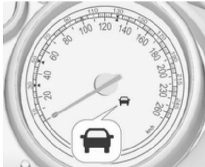
Le témoin de véhicule à l'avant allumé en vert
