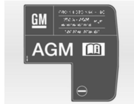
Une batterie AGM se reconnaît à l'étiquette sur la batterie. Nous recommandons d'utiliser une batterie de véhicule d'origine Opel.
