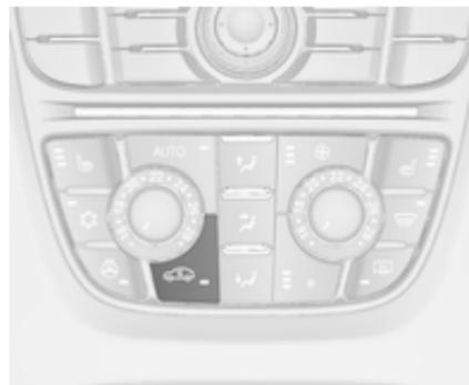
Appuyer sur le bouton
