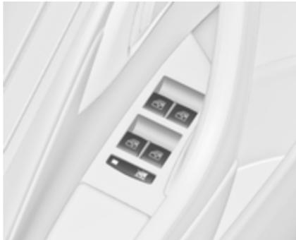
Appuyer sur le commutateur
