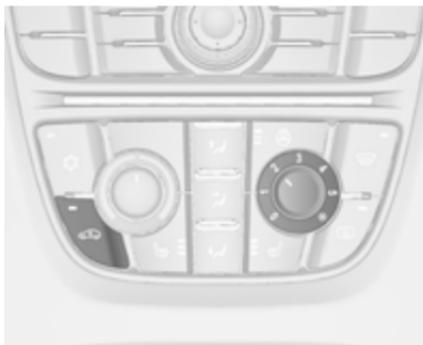
Appuyer sur le bouton
