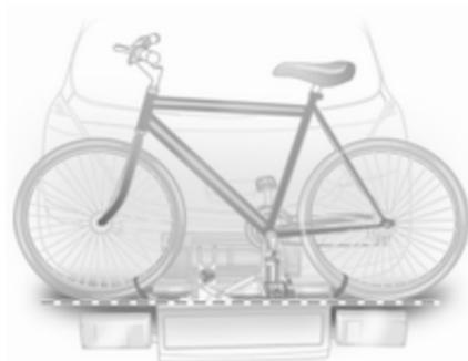
Disposer les logements de roue de sorte que le vélo soit plus ou moins horizontal. La distance entre les pédales et le hayon doit alors être d'au moins 5 cm.
