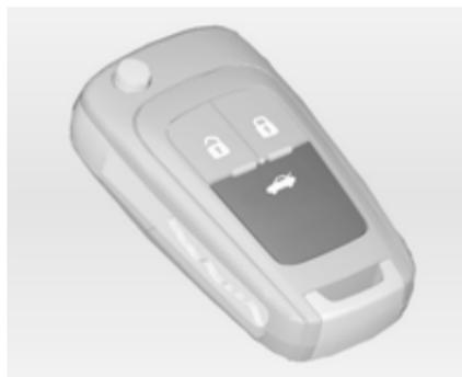
Appuyer sur le bouton
