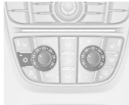
Appuyer sur le bouton
