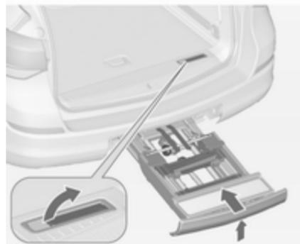
Pousser le levier de déverrouillage vers le haut et le tenir. Soulever légèrement le système et le pousser dans le pare-chocs jusqu'à ce qu'il s'enclique.
