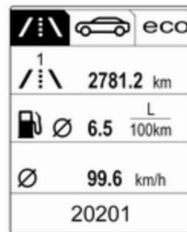
Sur l'affichage de niveau supérieur-combi, les principaux menus suivants peuvent être sélectionnés en appuyant sur le bouton **MENU**. Les symboles de menu sont indiqués sur la ligne supérieure de l'affichage :
