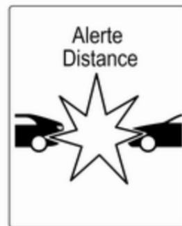
Lorsque la distance avec un véhicule en mouvement à l'avant est trop petite ou lorsque vous approchez trop rapidement d'un autre véhicule et qu'une collision est imminente, le symbole d'alerte de collision s'affiche dans le Centre d'informations du conducteur. En même temps, un carillon d'avertissement se fait entendre. Appuyer sur la pédale de frein, si la situation l'exige.
