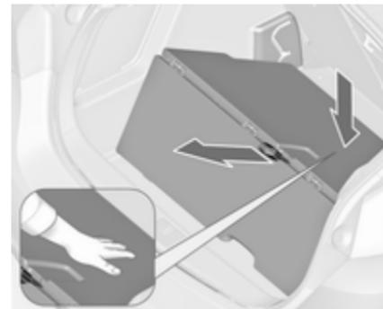
Pour abaisser le recouvrement, tirer la sangle vers l'arrière tout en abaissant le centre avant du recouvrement.
