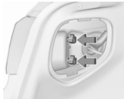
2. Dévisser de l'intérieur à la main les deux écrous de fixation en plastique.
