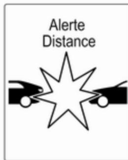
Lorsque la distance avec un véhicule en mouvement à l'avant est trop petite ou lorsque vous approchez trop rapidement d'un autre véhicule et qu'une collision est imminente, le symbole d'alerte de collision s'affiche sur le DIC.
