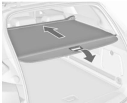
Tirer la poignée à l'extrémité du cache sur l'arrière et vers le bas. Il s'enroule automatiquement.
