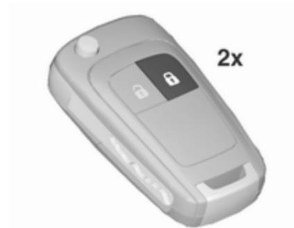
Appuyer deux fois sur le bouton ② de la télécommande radio en 15 secondes.
