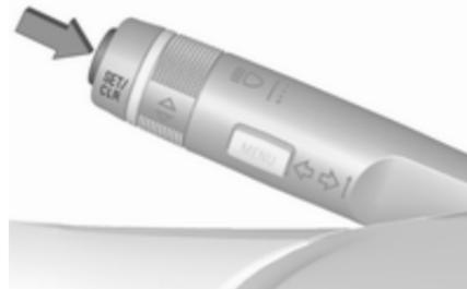
La fonction d'alerte peut être activée ou désactivée dans le menu **Réglages** de la page d'assistant de détection des panneaux routiers en appuyant sur **SET/CLR** sur le levier des clignotants.
