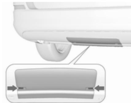
Toutes les versions, sauf berline 3 portes : Appuyer sur les attaches vers l'intérieur et plier le couvercle vers le bas à l'avant. Retirer le couvercle.
