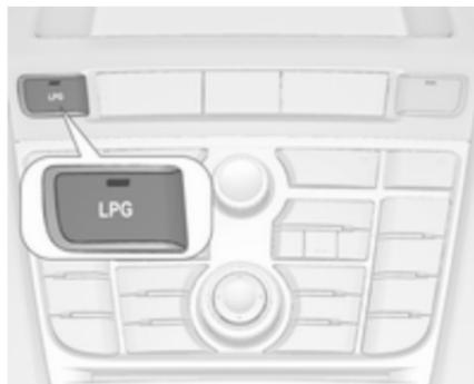
Appuyer sur **LPG** pour permuter entre fonctionnements à l'essence ou au gaz de pétrole liquéfié. La LED
