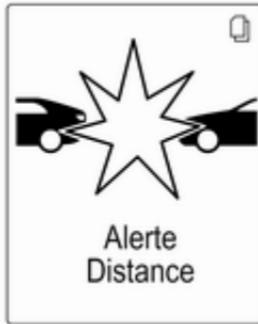
Un témoin de véhicule à l'avant vert
