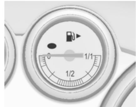
Affiche le niveau de remplissage de carburant ou le niveau de gaz dans le réservoir en fonction du mode de fonctionnement.
