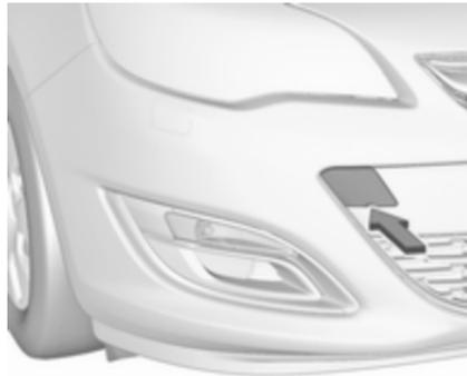
Insérer un tournevis dans la fente sur la partie basse du capuchon. Décaler le capuchon en enfonçant avec précaution le tournevis vers le bas. L'œillet de remorquage se trouve dans l'outillage du véhicule ↻ 276.
