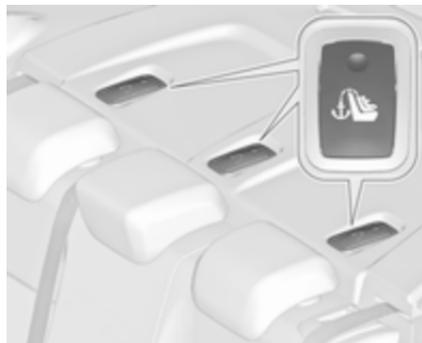
Sur le modèle tri-corps, ouvrir le rabat de l'oeilleton d'attache concerné sur la zone de positionnement derrière les appuis-tête ; cette zone est repérée par le symbole de siège d'enfant.
