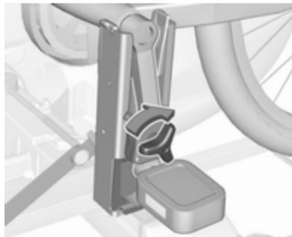
Fixer la manivelle en tournant la vis de serrage sur la fixation de manivelle.
