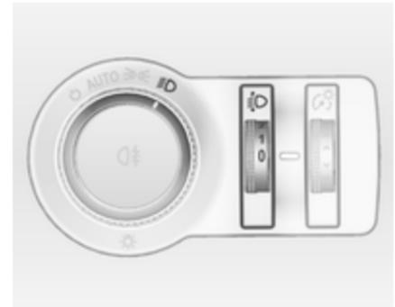
Pour adapter la portée des phares en fonction du chargement du véhicule afin d'éviter l'éblouissement : tourner la molette  $\text{D}$  dans la position désirée.
