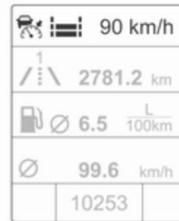
Le symbole de régulateur de vitesse adaptatif, le réglage de la distance vers l'avant et la vitesse réglée sont affichés sur la ligne supérieure du centre d'informations du conducteur (DIC).
