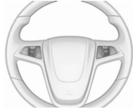
L'Infotainment System, le régulateur de vitesse et un téléphone mobile connecté peuvent être commandés à partir du volant.
