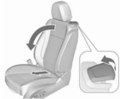
Soulever la poignée de déverrouillage et replier le dossier vers l'avant. Le siège glisse automatiquement vers l'avant jusqu'à la butée.
