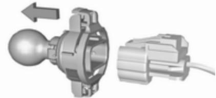
4. Dégager le connecteur de la douille d'ampoule en enfonçant la patte de retenue.
