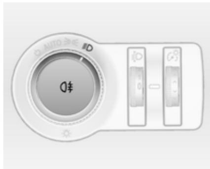
Pour les enclencher, appuyer sur
