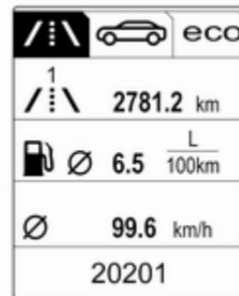
Sur l'affichage de combiné de niveau supérieur, les principaux menus suivants peuvent être sélectionnés en appuyant sur **MENU**. Les symboles de menu sont indiqués sur la ligne supérieure de l'affichage :
