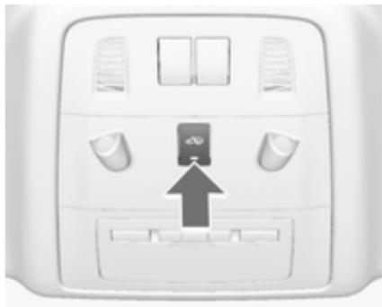
Désactiver la surveillance de l'habitacle et de l'inclinaison du véhicule quand des animaux sont laissés dans le véhicule en raison de la grande quantité de signaux ultrasoniques ou de leurs mouvements déclenchant l'alarme. La désactiver également quand le véhicule est à bord d'un ferry ou d'un train.
