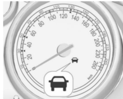
Le témoin de véhicule à l'avant allumé en vert
