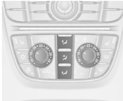
Appuyer sur le bouton correspondant au réglage souhaité. L'activation est signalée par l'allumage de la LED dans le bouton.
