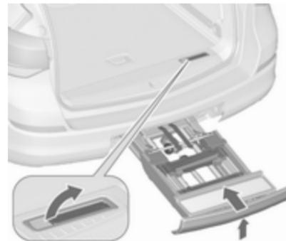
Pousser le levier de déverrouillage vers le haut et le tenir. Soulever légèrement le système et le pousser dans le pare-chocs jusqu'à ce qu'il s'enclique.
