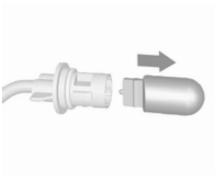
3. Tirer l'ampoule de la douille d'ampoule et la remplacer.
