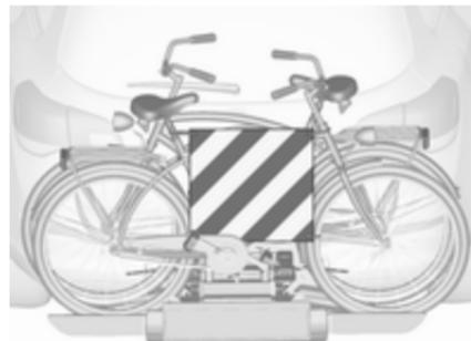
Il est recommandé de fixer un signal avertisseur sur le vélo le plus à l'arrière pour augmenter la visibilité.
