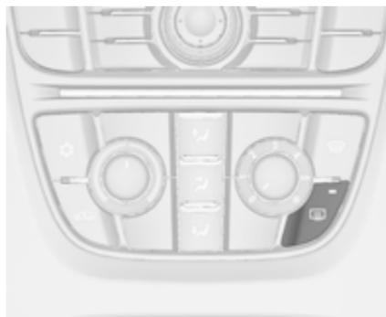
Pour les enclencher, appuyer sur
