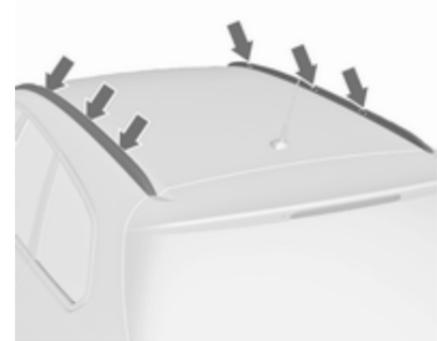
Fixer la galerie de toit dans la zone des orifices, comme cela est indiqué par les flèches sur l'illustration.
