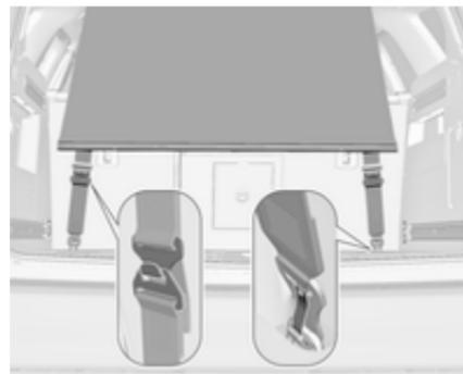
Fixer le crochet inférieur avec l'ouverture faisant face vers l'arrière sur l'anneau de gauche et de droite du plancher. Régler la longueur de la sangle sur le filet de sécurité en fixant le crochet supérieur aux anneaux de la sangle. S'assurer que la sangle est tendue lors de la pose de la tige.
