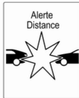
Si un véhicule directement devant est approché trop rapidement, un signal sonore retentit et une alarme est affichée sur le centre d'informations du conducteur (DIC).
