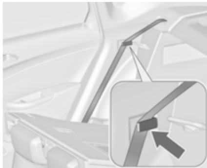
Si le véhicule doit être chargé via une porte arrière, sortir la ceinture de sécurité du guide de dos-
