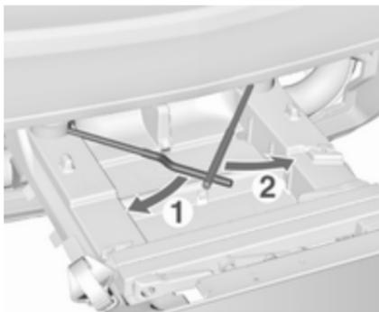
Pivoter à fond d'abord la poignée de verrouillage gauche (1), puis celle de droite (2).
