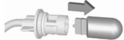
3. Tirer l'ampoule de la douille d'ampoule et la remplacer.
