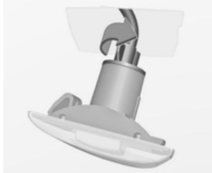
2. Faire tourner la douille d'ampoule dans le sens inverse des aiguilles d'une montre et la déposer du logement.
