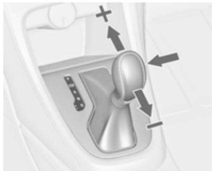
Déplacer le levier sélecteur hors de la position **D** vers la gauche pour sélectionner le mode manuel **M**.
