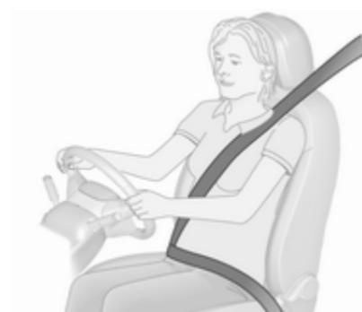
Tirer la ceinture de sécurité et l'enclenquer dans la serrure de ceinture. La ceinture de sécurité ne doit pas être vrillée et doit être placée près du corps. Le dossier ne doit pas être incliné trop en arrière (environ 25° maximum).
