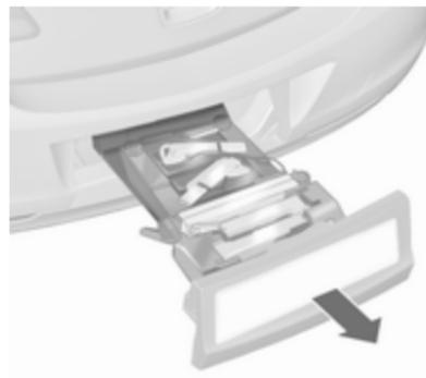
Sortir complètement le système de transport arrière jusqu'à ce qu'il se verrouille de manière audible.
