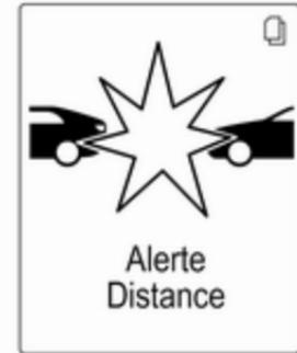
Un témoin de véhicule à l'avant vert s'allume sur le combiné d'instruments lorsque le système a détecté un véhicule sur la voie de circulation. Lorsque la distance avec un véhicule en mouvement à l'avant est trop petite ou lorsque vous approchez trop rapidement d'un autre véhicule et qu'une collision est imminente, le symbole d'alerte de collision s'affiche dans le centre d'informations du conducteur. En même temps, un carillon d'avertissement se fait entendre.
