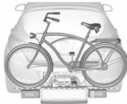
Disposer les logements de roue de sorte que le vélo soit plus ou moins horizontal. La distance entre les pédales et le hayon doit alors être d'au moins 5 cm.
