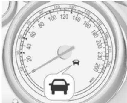
Le témoin de véhicule à l'avant allumé en vert
