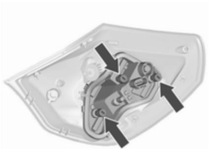
6. Dévisser les trois vis avec un tournevis et déposer le support d'ampoule de l'ensemble du feu.
