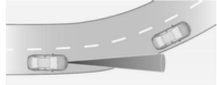
Le régulateur de vitesse adaptatif calcule une voie estimée, basée sur la force centrifuge. Cette voie estimée considère la caractéristique de virage réelle, mais ne peut pas considérer un changement de virage futur. Le système peut perdre le véhicule à l'avant ou considérer un véhicule qui n'est pas dans la voie actuelle. Ceci peut se réduire lors de l'entrée ou la
