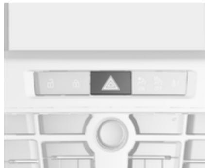
Pour les enclencher, appuyer sur
