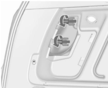
3. Dévisser de l'intérieur à la main les deux écrous de fixation en plastique.
