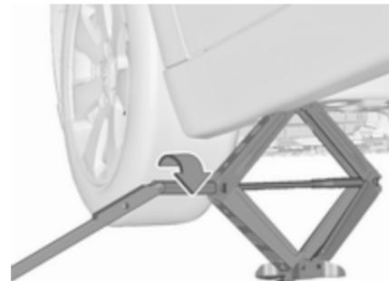
Attacher la clé de roue, aligner correctement le cric et tourner la
