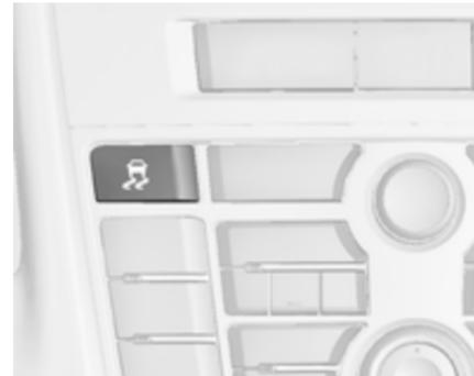
Pour une conduite à très hautes performances, il est possible de désactiver séparément l'ESC et le TC. Les modes suivants peuvent être sélectionnés :
