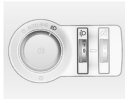
Pour adapter la portée des phares en fonction du chargement du véhicule afin d'éviter l'éblouissement : tourner la molette  $\text{D}$  dans la position désirée.
