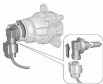
4. Tourner la douille d'ampoule dans le sens anti-horaire et l'enlever du réflecteur.
