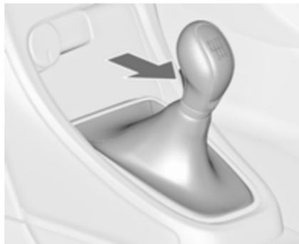
Pour engager la marche arrière, le véhicule étant à l'arrêt, enfoncer la pédale d'embrayage, appuyer sur le bouton de déverrouillage du levier sélecteur et engager le rapport.
