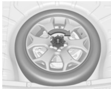
Une roue de taille normale endommagée doit être rangée à l'extérieur de la niche de roue de secours en la fixant avec l'écrou papillon.
