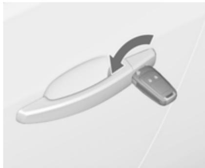
Déverrouiller manuellement la porte du conducteur en tournant la clé dans la serrure. Mettre le contact et appuyer sur le bouton de verrouillage central
