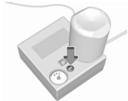
Si la pression des pneus prescrite n'est pas atteinte dans les dix minutes, démonter le kit de réparation de pneus. Avancer ou reculer le véhicule d'un tour de roue. Brancher à nouveau le kit de réparation des pneus et poursuivre la procédure de remplissage pendant dix minutes. Si la pression de gonflage prescrite n'est toujours pas atteinte, c'est que le pneu est trop fortement endommagé. Prendre contact avec un atelier.
