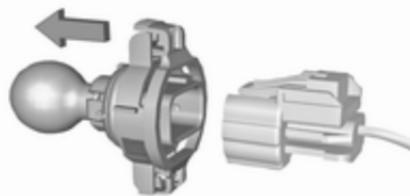
4. Dégager le connecteur de la douille d'ampoule en enfonçant la patte de retenue.
