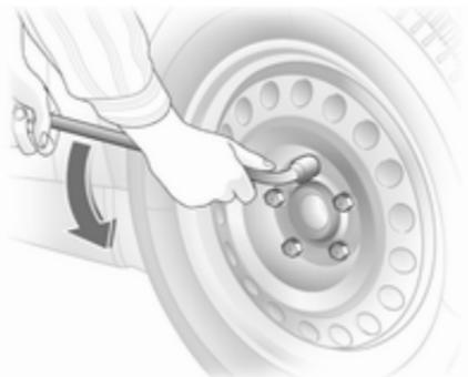
Placer la clé de roue en s'assurant qu'elle soit bien positionnée et desserrer chaque écrou de roue d'un demi-tour.
