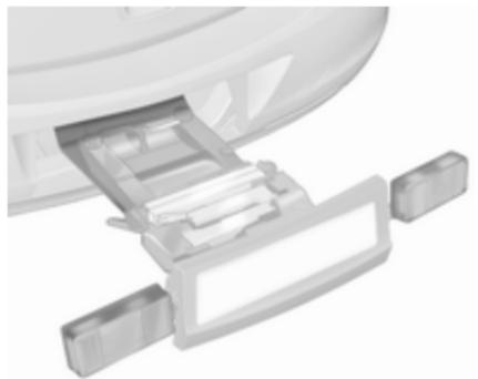
Vérifier la position des câbles et des feux pour s'assurer qu'ils sont correctement montés et positionnés.
