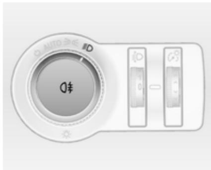
Pour les enclencher, appuyer sur
