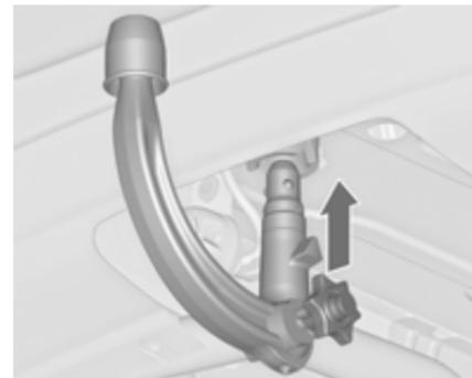
Insérer la barre d'attelage serrée dans l'ouverture et la pousser fermement vers le haut jusqu'à ce qu'un déclic de verrouillage se fasse entendre.
