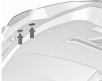
1. Ouvrir le hayon et déposer les caches du côté concerné.
