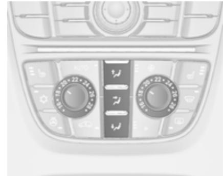
Appuyer sur le bouton correspondant au réglage souhaité. L'activation est signalée par l'allumage de la LED dans le bouton.
