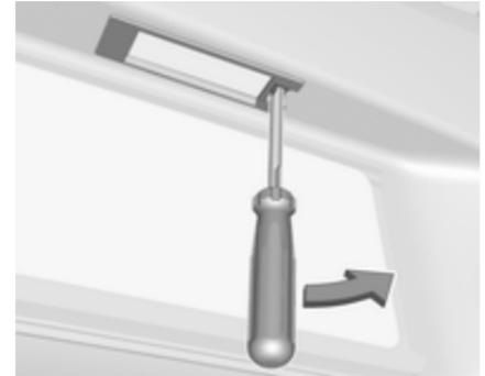
1. Introduire un tournevis dans le creux du couvercle, appuyer sur le côté et libérer le ressort.
