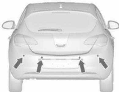
Le système possède quatre capteurs de stationnement à ultrasons disposés dans le pare-chocs arrière.
