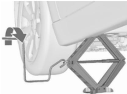
Attacher la poignée de cric avec le cric correctement aligné, faire tourner la poignée jusqu'à ce que la roue soit dégagée du sol.
