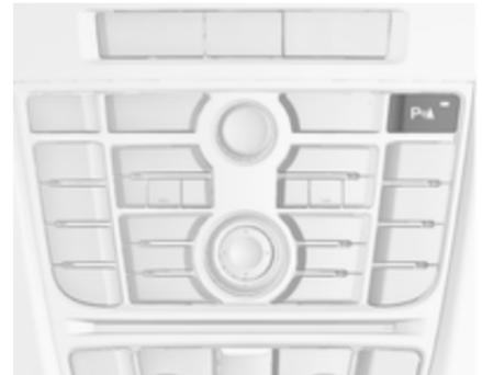
L'aide au stationnement avant-arrière est dotée du bouton **P**▲. Si le véhicule est en outre équipé d'un système avancé d'aide au stationnement (voir la description distincte ci-après), le système est équipé du bouton **P**▲. Les deux systèmes seront actionnés par **P**▲.
