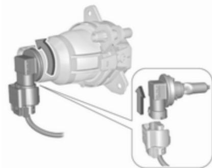
4. Tourner la douille d'ampoule dans le sens anti-horaire et l'enlever du boîtier du réflecteur.
