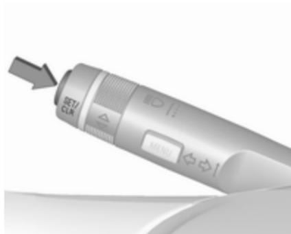
La fonction d'alerte peut être activée ou désactivée dans le menu Réglages de la page d'assistant de détection des panneaux routiers en appuyant sur **SET/CLR** sur le levier des clignotants.
