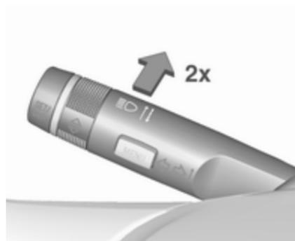
Les feux de route automatiques sont allumés en poussant deux fois le levier de clignotant lorsque le véhicule roule à une vitesse supérieure à 40 km/h.
