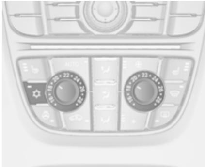
Appuyer sur ☼ pour mettre le refroidissement en marche. L'activation est signalée par l'éclairage de la LED dans le bouton. Le refroidissement ne fonctionne que lorsque le moteur est en marche et que la soufflerie de la climatisation est allumée.
