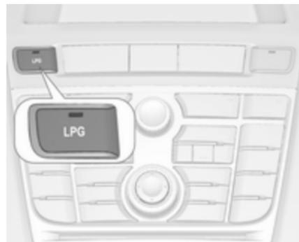
L'actionnement de **LPG** permet le basculement entre les modes de fonctionnement à l'essence et au gaz de pétrole liquéfié dès que les paramètres requis (température de liquide de refroidissement et régime moteur minimal) ont été atteints. Les exigences sont généralement satisfaites environ après 60 secondes (en fonction de la température extérieure) et le premier enfoncement net de la pédale d'accélérateur. La LED indique le mode de fonctionnement en cours.
