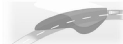
Le faisceau lumineux pivote en fonction de l'angle de braquage du volant et la vitesse, ce qui améliore l'éclairage des virages.
