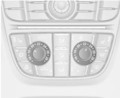
Si la température minimale **Lo** est réglée, le système de commande de climatisation fonctionne avec sa capacité maximale de refroidissement, si le refroidissement
