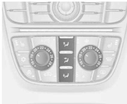
Appuyer sur le bouton correspondant au réglage souhaité. L'activation est signalée par l'éclairage de la LED dans le bouton.
