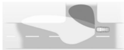
Dans les virages serrés ou lors des changements de direction, en fonction de l'angle de braquage du volant ou des clignotants, un réflecteur supplémentaire, à gauche ou à droite, est activé pour éclairer la route sous
