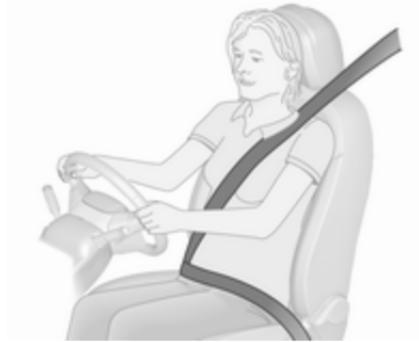
Les ceintures de sécurité sont bloquées lors d'accélération ou de décélération brutales du véhicule, ce qui assure le maintien des occupants en position assise. Le risque de blessure est ainsi sensiblement réduit.
