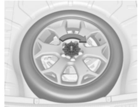
Une roue de taille normale endommagée doit être rangée à l'extérieur de la niche de roue de secours en la fixant avec l'écrou papillon.
