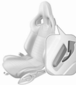
L'illustration montre le levier de déverrouillage d'un siège OPC.
