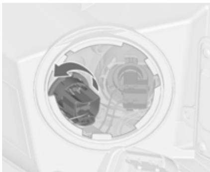
2. Faire tourner la douille dans le sens anti-horaire pour la dégager et la retirer du boîtier du réflecteur.
