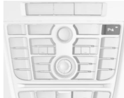
L'aide au stationnement avant-arrière est dotée du bouton **P**▲. Si le véhicule est en outre équipé d'un système avancé d'aide au stationnement (voir la description distincte ci-après), le système est équipé du bouton **P**▲. Les deux systèmes seront actionnés en appuyant sur **P**▲.
