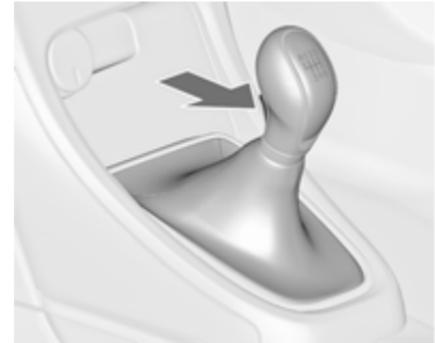
Marche arrière : le véhicule étant à l'arrêt, enfoncer la pédale d'embrayage, enfoncer le bouton de déverrouillage du levier sélecteur et engager le rapport.
