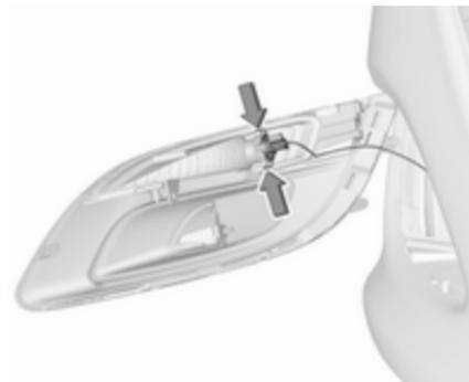
3. Dégager la douille d'ampoule du boîtier du réflecteur en enfonçant les deux pattes de retenue.
