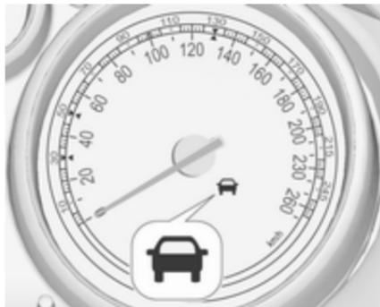
Le témoin de véhicule à l'avant allumé en vert
