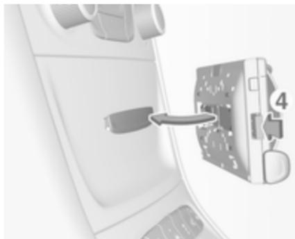
2. Fixer le support du téléphone aux connecteur d'alimentation et appuyer sur les deux leviers de verrouillage (4) pour verrouiller.
