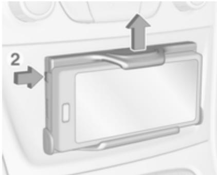
2. Appuyer sur le bouton (2) sur le côté supérieur gauche pour dégager le levier pour le réglage de la hauteur.
