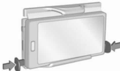
4. Régler la largeur du support de téléphone sur la largeur du téléphone en poussant ensemble les leviers.
