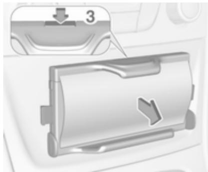
2. Appuyer le bouton de déverrouillage (3) et retirer le support du téléphone.
