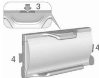
1. Appuyer sur le bouton de déverrouillage (3) pour dégager les leviers de verrouillage (4).
