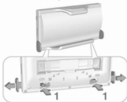
1. Appuyer sur les deux supports (1) à l'arrière pour dégager les leviers pour le réglage de la largeur et les tirer vers l'extérieur.
