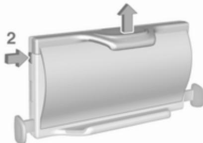
2. Appuyer sur le bouton (2) sur le côté supérieur gauche pour dégager le levier pour le réglage de la hauteur.
