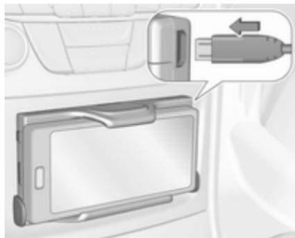
Connecter le smartphone au support de téléphone en utilisant le câble de connexion compatible. Plusieurs versions du câble de connexion sont disponibles en accessoire.
