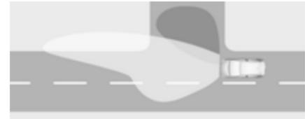
En désactivant, en fonction de l'angle de braquage et du feu clignotant, des DEL particulières se déclenchent pour éclairer la direction du déplacement. Il est activé jusqu'à une vitesse de 40 km/h.
