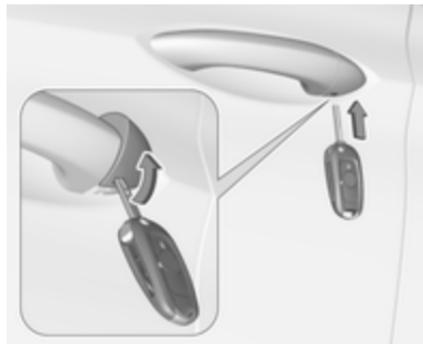
**Télécommande** : pour retirer le capuchon, introduire la clé dans le renfoncement au bas du capuchon et faire pivoter la clé vers le haut.
