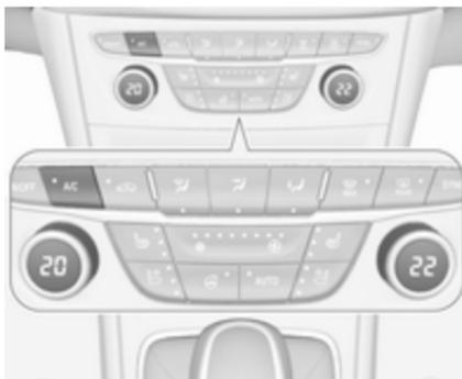
Appuyer sur **A/C** pour mettre le refroidissement en marche. L'activation est signalée par l'allumage de la LED dans le bouton. Le refroidissement ne fonctionne que lorsque le moteur est en marche et que la soufflerie de la climatisation est allumée.
