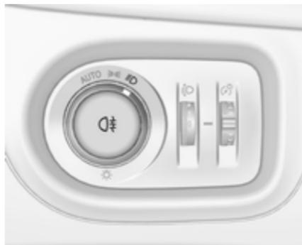
Pour les enclencher, appuyer sur
