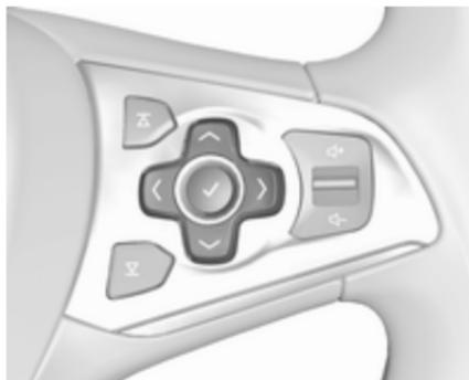
Sur l'affichage de niveau supérieur, choisir le menu **Info** à l'aide des boutons à droite du volant et appuyer sur  $\vee$  ou  $\wedge$  pour sélectionner la page d'assistant de détection des panneaux routiers ↷ 103.
