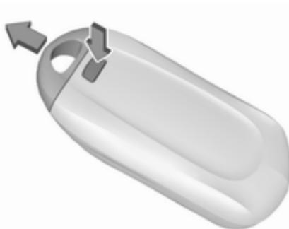
1. Appuyer sur le bouton au dos de la clé électronique et retirer la lame de la clé du boîtier.
