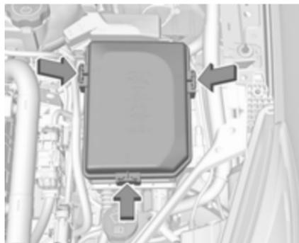
La boîte à fusibles se trouve à l'avant gauche du compartiment moteur. Dégager le couvercle et l'enlever.
