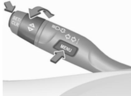
Sur l'affichage de niveau médian, sélectionner le menu **Réglages** en appuyant sur **MENU** sur le levier des cliquotants. Tourner la molette pour sélectionner la page **Durée de vie restante, huile**.
