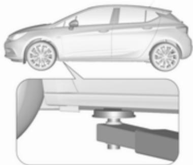
Position du bras avant du pont élévateur sous le renforcement avant du seuil.
