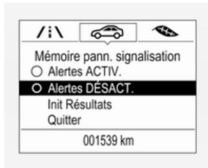
Sélectionner **Alertes ACTIV.** ou **Alertes DÉSACT.** en tournant la molette de réglage et appuyer sur **SET/CLR**.
