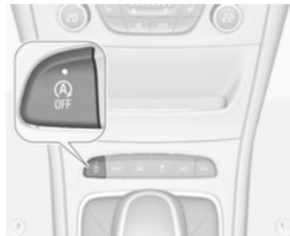
Désactiver le système d'arrêt-démarrage manuellement en appuyant sur **OFF**. La désactivation est indiquée lorsque la DEL dans le bouton s'allume.
