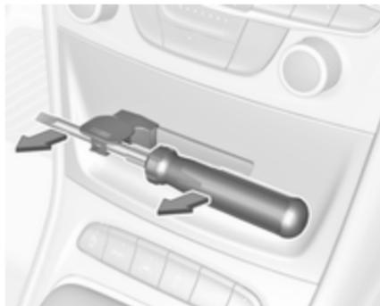
Pousser le tournevis par le renforcement dans l'adaptateur. Retirer le couvercle en tirant le tournevis.
