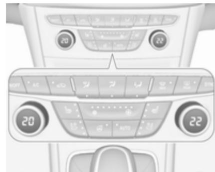
Régler les températures à la valeur souhaitée. Le bouton du côté passager permet de modifier la température du côté passager. Le bouton du côté conducteur permet de modifier la température du côté conducteur ou des deux côtés selon l'activation de la synchronisation **SYNC**.
