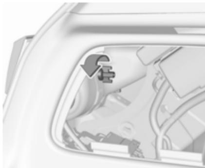
3. Dévisser de l'intérieur à la main l'écrou de fixation en plastique.
