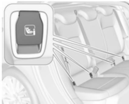
Fixer les systèmes de sécurité pour enfant ISOFIX homologués pour le véhicule supports de montage ISO-FIX. Les positions des systèmes de sécurité pour enfant ISOFIX spécifiques du véhicule sont indiquées dans le tableau ISOFIX ↻ 65.
