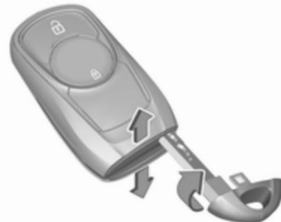
2. Introduire un tournevis plat ou la lame de la clé sur le côté du boîtier et détacher le couvercle noir de l'unité électronique en tournant le tournevis ou la lame de la clé.
