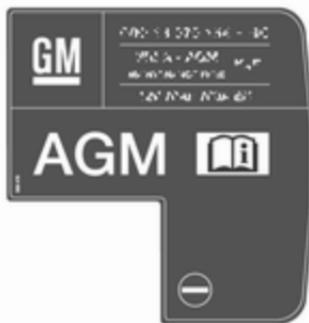
Une batterie AGM se reconnaît à l'étiquette sur la batterie. Nous recommandons d'utiliser une batterie de véhicule d'origine Opel.
