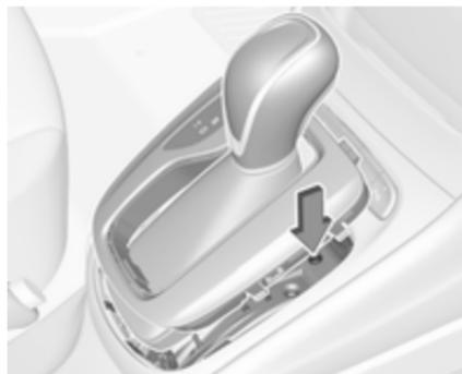
3. Introduire une petite tige (par exemple un stylo ou un tournevis) dans l'ouverture près du levier sélecteur. Pousser la tige verticalement vers le bas et sortir le levier sélecteur du **P**. Si cette position est à nouveau enclenchée, le levier sélecteur sera à nouveau verrouillé. Faire corriger la cause de la coupure de courant par un atelier.
