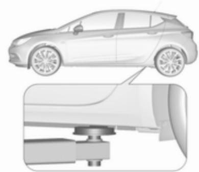
Position du bras arrière du pont élévateur sous le renforcement arrière du seuil.
