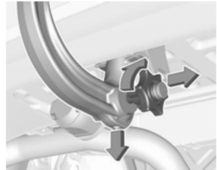
Ouvrir le volet de protection et tourner la clé en position
