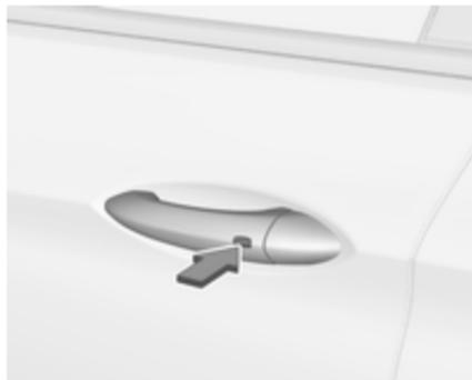
Système à clé électronique : Le déverrouillage du véhicule en appuyant sur le bouton ou en actionnant l'une des poignées extérieures de porte désactive le système antivol.
