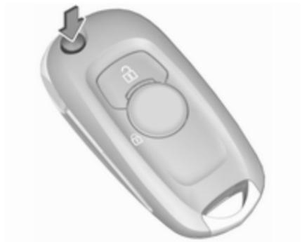
Appuyer sur le bouton pour l'ouvrir. Pour replier la clé, appuyer d'abord sur le bouton.
