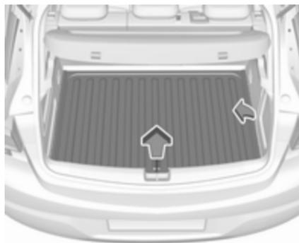
Le recouvrement du plancher arrière peut être retiré. Soulever le recouvrement à l'arrière et le tourner légèrement de côté avant de le retirer.
