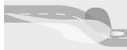
Des DEL particulières, basées sur l'angle de braquage et la vitesse, sont en plus déclenchées pour améliorer l'éclairage dans les virages. Cette fonction est activée à des vitesses entre 40 km/h et 70 km/h et réagit à l'angle de braquage.
