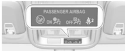
Le pictogramme du siège du passager avant s'allume ou clignote en rouge sur la console de toit, quand le siège est occupé.
