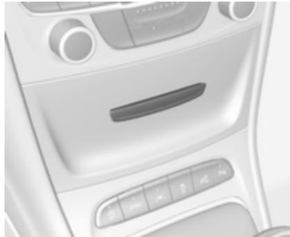
Le connecteur d'alimentation (barre PowerFlex) est fixé au couvercle de la boîte à fusibles du tableau de bord. Un diffuseur de parfum (AirWellness) ou un support de téléphone peuvent être fixés au connecteur d'alimentation.
