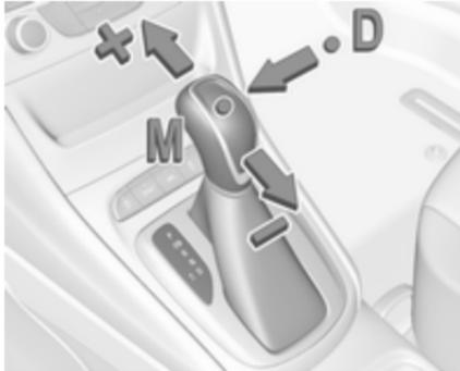
Déplacer le levier sélecteur de la position **D** vers la gauche, sur la position **M**.
