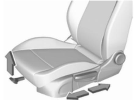
Tirer la poignée, déplacer le siège et relâcher la poignée. Essayer de déplacer le siège vers l'arrière et l'avant pour s'assurer que le siège est verrouillé en place.
