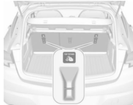
En plus des supports de montage ISOFIX, attacher la sangle Top-Tether aux œillets de fixation Top-Tether. La sangle doit alors passer entre les deux tiges de guidage de l'appui-tête.
