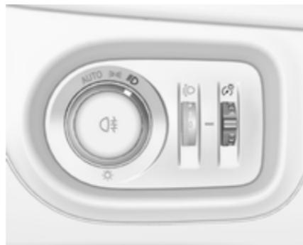
La luminosité des phares suivants peut être réglée en position **AUTO** lorsque le capteur de lumière détecte des conditions de nuit, ou en position **ON** ou **OFF**.
