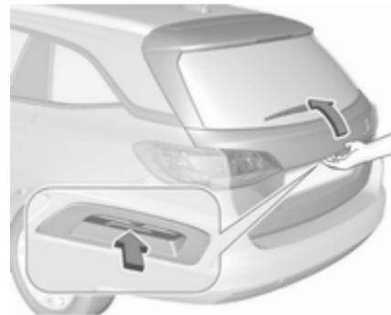
Pour ouvrir le hayon, pousser et maintenir le commutateur tactile sous la moulure de hayon jusqu'à ce que le hayon commence à se déplacer. Si le
