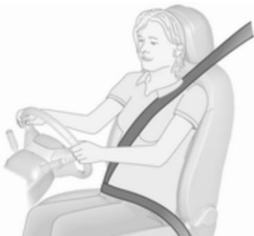
Les ceintures de sécurité sont bloquées lors d'accélération ou de décélération fortes du véhicule, ce qui assure le maintien des occupants en position assise. Le risque de blessure est ainsi sensiblement réduit.
