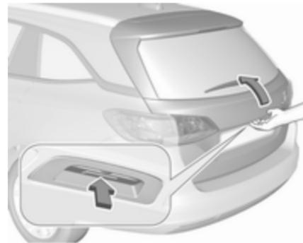
Après le déverrouillage, appuyer sur le commutateur du pavé tactile sous la moulure du hayon et ouvrir le hayon à la main.
