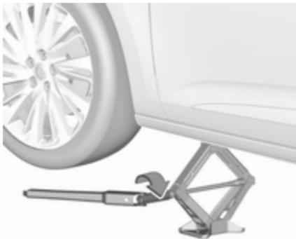
Attacher la clé de roue, aligner correctement le cric et tourner la clé de roue jusqu'à ce que la roue
