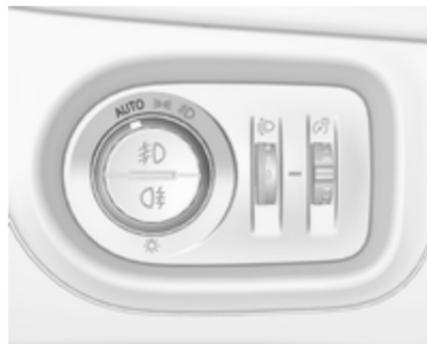
Quand la fonction de commande automatique des feux est activée et que le moteur tourne, le système bascule automatiquement entre les feux de jour et les phares, en fonction des conditions d'éclairage extérieur et des informations communiquées par le système de détecteur de pluie.
