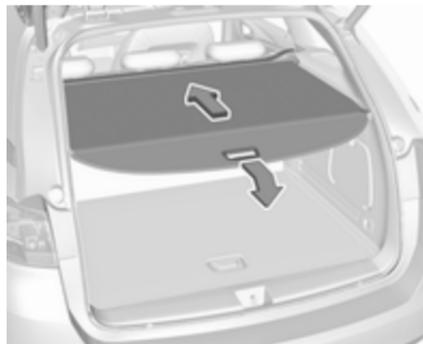
Tirer la poignée à l'extrémité du store vers l'arrière et vers le bas. Il s'enroule automatiquement.
