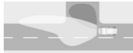
En désactivant, en fonction de l'angle de braquage et du feu clignotant, des DEL particulières se déclenchent pour éclairer la direction du déplacement. Il est activé jusqu'à une vitesse de 40 km/h.
