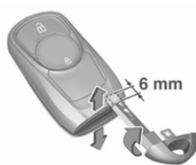
2. Insérer de nouveau le panne de la clé sur environ 6 mm et tourner la clé pour ouvrir le boîtier. Une insertion plus profonde de la clé peut endommager le boîtier.
