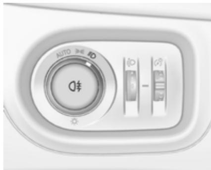
Pour les enclencher, appuyer sur . Commutateur d'éclairage en position **AUTO** : l'enclenchement des feux antibrouillard arrière fera automatiquement s'allumer les phares.
