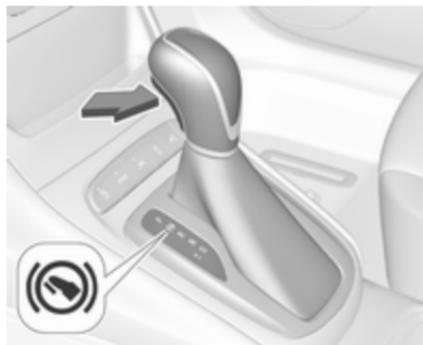
Le levier sélecteur est verrouillé en position **P** et ne peut être déplacé lorsque le contact est mis, lorsque le
