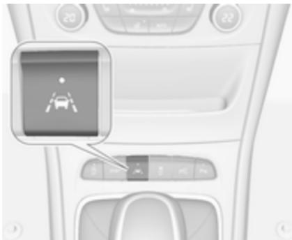
L'assistance au maintien de trajectoire est activée en appuyant sur
