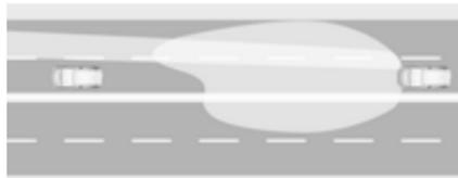
Les feux de route automatiques comprennent un mode pour autoroute spécial. En roulant à plus de 115 km/h sur une autoroute, le faisceau lumineux se raccourcit pour ne pas éblouir la circulation en sens inverse. En suivant des véhicules qui précèdent ou qui croisent, le reflet éblouissant des rétroviseurs de ces véhicules est réduit.
