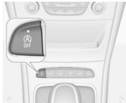
Pour désactiver le système Stop/Start manuellement, appuyer sur
