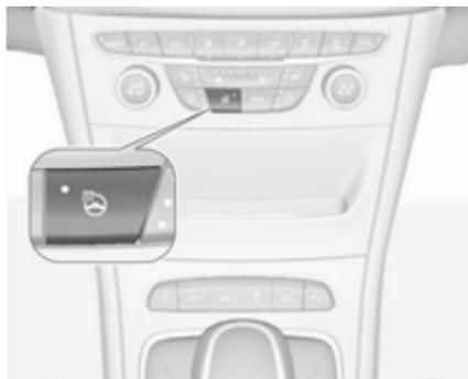
Activer le chauffage en appuyant sur
