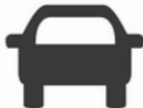
Le témoin de véhicule à l'avant allumé en vert
