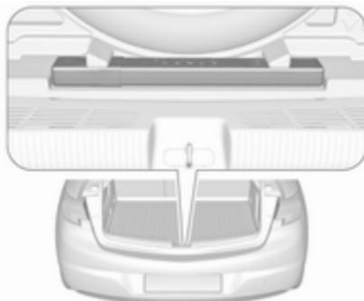
Ranger le triangle de présignalisation dans le renforcement à l'avant du hayon.
