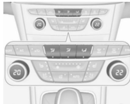
Appuyer sur le bouton approprié pour le réglage souhaité. L'activation est signalée par l'éclairage de la LED dans le bouton.
