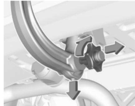
Ouvrir le volet de protection et tourner la clé en position
