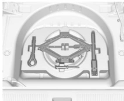
Le cric, l'anneau de remorquage et les outils se trouvent dans la boîte à outils sous la roue de secours. Roue de secours ↗ 288.
