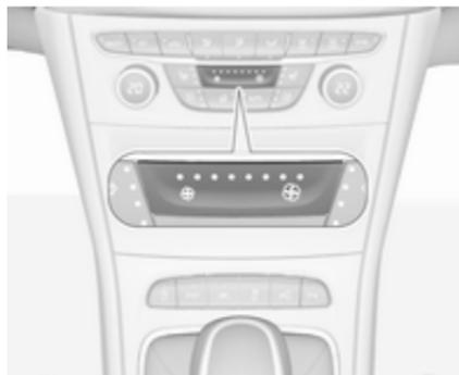
Appuyer sur le bouton gauche pour diminuer ou sur le bouton droit pour augmenter la vitesse du ventilateur. La vitesse du ventilateur est indiquée par le nombre de DEL dans le bouton.
