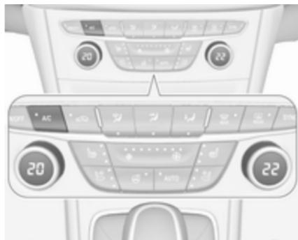
Appuyer sur **A/C** pour mettre le refroidissement en marche. L'activation est signalée par l'éclairage de la LED
