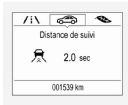
Sur l'affichage de niveau supérieur, sélectionner le menu **Info** avec les boutons du volant et appuyer sur
