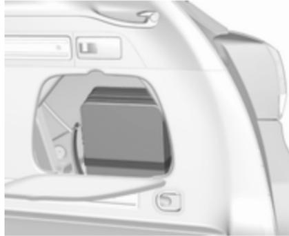
Ouvrir le recouvrement sur le côté droit du coffre.
