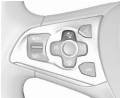
Sur les véhicules dotés d'une caméra avant, le freinage d'urgence actif peut être désactivé en appuyant plusieurs fois sur le commutateur d'espace- ➔ sur le réglage **Arrêt** ➔ 208. S'il est désactivé, un message s'affiche dans le centre d'informations du conducteur.
