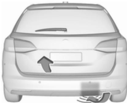
Pour ouvrir ou fermer le hayon, avancer et reculer le pied sous le pare-chocs arrière dans la zone illustrée. Si le véhicule est équipé de l'aide au stationnement, cette zone est reconnaissable sous le capteur indiqué. Ne pas laisser le pied trop longtemps ou le bouger trop lentement sous le pare-chocs. La clé électronique doit se trouver à l'extérieur du véhicule dans un rayon d'environ un mètre du côté du hayon.
