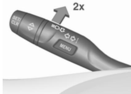
Activer les feux de route automatiques en poussant deux fois le levier des clignotants. Les feux de route s'allument automatiquement à une vitesse supérieure à 50 km/h. Les feux de route s'éteignent à une vitesse inférieure à 35 km/h, mais les feux de route automatiques restent actifs.
