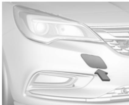
Insérer un tournevis dans la fente sur la partie basse du capuchon. Déga-ger le capuchon en enfonçant avec précaution le tournevis vers le bas.
