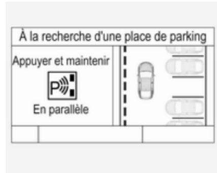
Sélectionner une place de stationnement parallèle ou perpendiculaire dans le centre d'informations du conducteur par une pression longue sur
