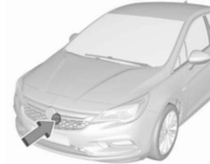
Le radar est monté derrière la calandre du radiateur derrière ou sous l'emblème de la marque.
