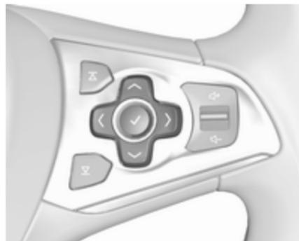
Sur l'affichage de niveau supérieur, choisir le menu **Info** à l'aide des boutons à droite du volant et appuyer sur **∨** ou **∧** pour sélectionner la page d'assistant de détection des panneaux routiers ↻ 121.
