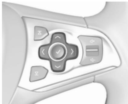
Sur l'affichage de niveau supérieur, choisir le menu **Info** à l'aide des boutons à droite du volant et appuyer sur  $\vee$  ou  $\wedge$  pour sélectionner la page d'assistant de détection des panneaux routiers
