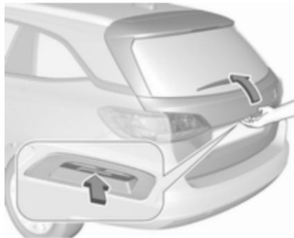
Après le déverrouillage, appuyer sur le bouton du hayon sous la moulure de hayon et ouvrir le hayon manuellement.
