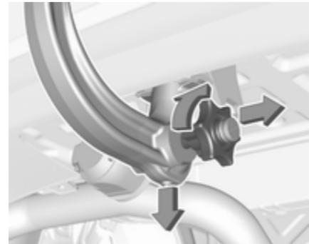
Ouvrir le volet de protection et tourner la clé en position
