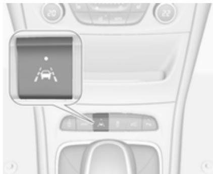
L'assistance au maintien de trajectoire est activée en appuyant sur
