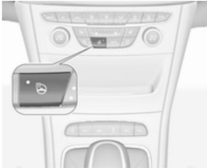
Activer le chauffage en appuyant sur
