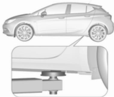
Position de centrage du bras porteur avant du pont élévateur sous le point de levage du véhicule.
