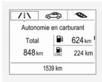
Affichage de l'autonomie approximative en carburant et pour chaque réservoir de carburant (GNC et essence). Un niveau bas de carburant dans un des réservoirs est indiqué par **FAIBLE** dans la section correspondante.
