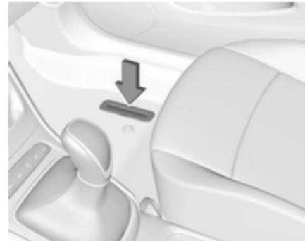
Le numéro d'identification du véhicule peut être frappé sur la plaque d'identification et sur le plancher, sous le tapis de sol, abrité par un cache.
