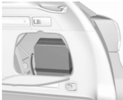
Sur le Sports Tourer, le kit de réparation des pneus se trouve dans une valise sur le côté droit du coffre derrière un couvercle. La valise est maintenue par une sangle.
