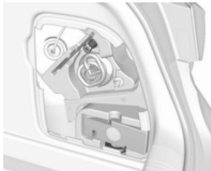
Ouvrir le recouvrement dans la paroi droite du coffre.
