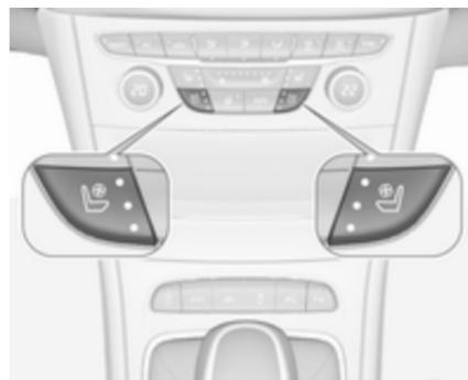
Régler la ventilation au niveau souhaité en appuyant une ou plusieurs fois sur du siège correspondant. Le témoin dans le bouton indique le réglage sélectionné.
