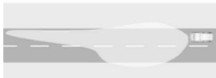
Activés automatiquement à une vitesse supérieure à environ 55 km/h en conduisant dans des zones rurales. L'éclairage de la voie et du bas-côté est amélioré. Les véhicules qui arrivent et qui précèdent ne sont pas éblouis.
