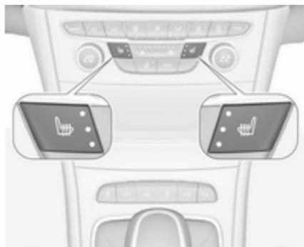
Selon le chauffage voulu, appuyer une ou plusieurs fois sur du siège respectif. Le témoin dans le bouton indique le réglage sélectionné.
