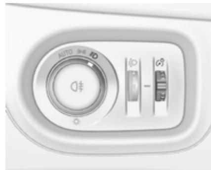
La luminosité des phares suivants peut être réglée en position **AUTO** lorsque le capteur de lumière détecte des conditions de nuit, ou en position  $\Rightarrow$  ou  $\Leftarrow$ .
