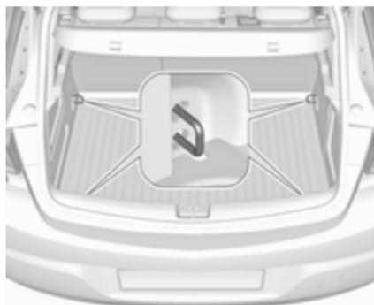
Sur les véhicules équipés d'une roue de secours, les anneaux d'arrimage avant sont situés au niveau des parois latérales.
