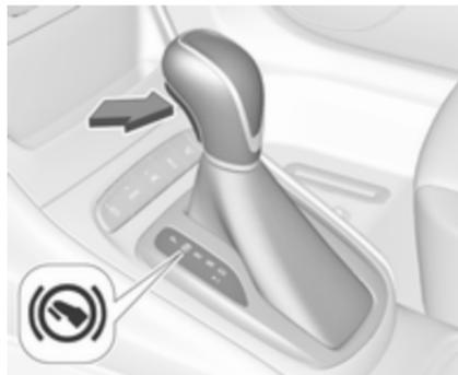
Le levier sélecteur est verrouillé en position **P** et ne peut être déplacé que lorsque le contact est mis, lorsque le bouton de déverrouillage sur le levier sélecteur est poussé et que la pédale de frein est enfoncée.
