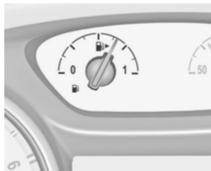
Affiche le niveau de carburant ou de gaz (GNC) contenu dans le réservoir selon le mode de fonctionnement actif.
