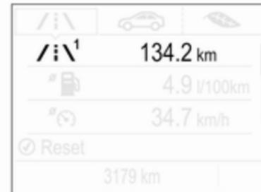
Sélectionner  $/i\backslash$  en appuyant sur **Menu** du levier de clignotants. Tourner la molette de réglage sur le levier de clignotants et sélectionner  $/i\backslash 1$  ou  $/i\backslash 2$ . Chaque page du compteur kilométrique journalier peut être réinitialisée séparément en appuyant pendant quelques secondes sur **SET/CLR** du levier de clignotants sur le menu concerné.
