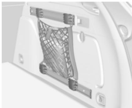
Introduire les adaptateurs dans les rails à la position désirée. Le filet de rangement peut être accroché aux adaptateurs.
