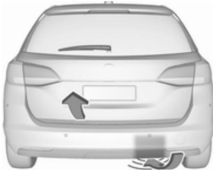
Pour ouvrir ou fermer le hayon, avancer et reculer le pied sous le pare-chocs arrière dans la zone illustrée. Si le véhicule est équipé de l'aide au stationnement, cette zone est reconnaissable sous le capteur indiqué. Ne pas laisser le pied trop longtemps ou le bouger trop lentement sous le pare-chocs. La clé électronique doit se trouver à l'extérieur du véhicule dans un rayon d'environ 1 m du hayon.
