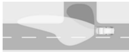
En retour de virage, en fonction de l'angle de braquage et des feux de direction, des LED particulières sont allumées dans le sens du déplacement. Il est activé jusqu'à une vitesse de 40 km/h.
