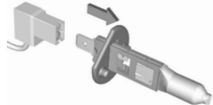
4. Séparer l'ampoule de la douille d'ampoule et remplacer l'ampoule.
