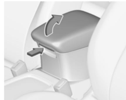
Appuyer sur le bouton pour relever l'accoudoir. L'accoudoir doit être reculé au maximum.
