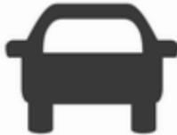
Le témoin de véhicule à l'avant allumé en vert
