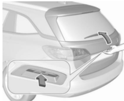
Pour ouvrir le hayon, appuyer sur le bouton du hayon sous la moulure de hayon et le maintenir enfoncé jusqu'à ce que le hayon commence à se déplacer. Si le véhicule est verrouillé,
