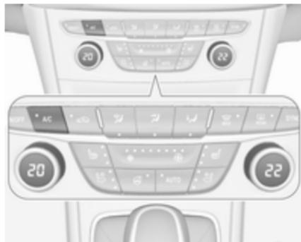
Appuyer sur **A/C** pour mettre le refroidissement en marche. L'activation est signalée par l'éclairage de la LED dans le bouton. Le refroidissement ne fonctionne que lorsque le moteur est en marche et que la soufflerie de la climatisation est allumée.
