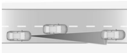
Si un autre véhicule entre dans la même voie de circulation, le régulateur de vitesse adaptatif considérera le véhicule lorsqu'il est complètement sur votre voie. Être prêt à agir et enfoncer la pédale de frein, si un freinage plus rapide est nécessaire.
