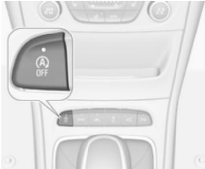
Pour désactiver le système Stop/Start manuellement, appuyer sur
