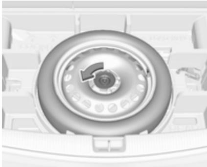
2. La roue de secours est fixée avec un écrou papillon. Dévisser l'écrou papillon pour sortir la roue de secours.
