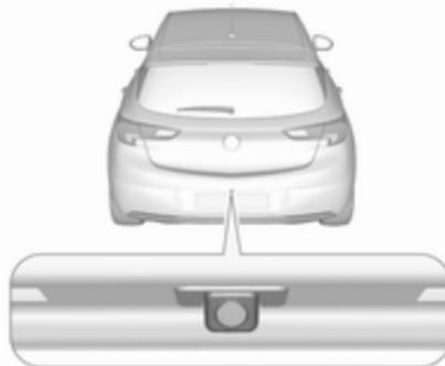
Sur le modèle 5 portes, la caméra est placée entre les éclairages de plaque d'immatriculation.
