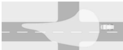
Activés automatiquement à une vitesse maximale d'environ 55 km/h et en cas de lumière ambiante extérieure. Le faisceau lumineux est large et symétrique. Un type spécial de
