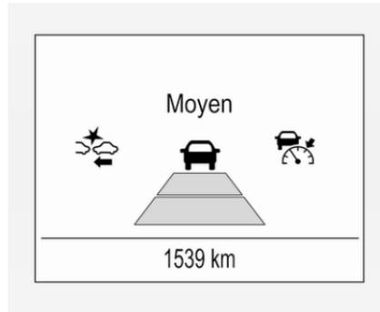
La distance vers l'avant sélectionnée est indiquée par les barres de distance remplies sur la page du régulateur de vitesse adaptatif.
