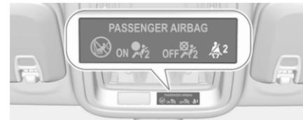
☞ du siège du passager avant s'allume ou clignote en rouge sur la console de toit, quand le siège est occupé.
