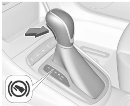
Le levier sélecteur est verrouillé en position **P** et ne peut être déplacé lorsque le contact est mis, lorsque le bouton de déverrouillage sur le levier sélecteur est poussé et que la pédale de frein est enfoncée.
