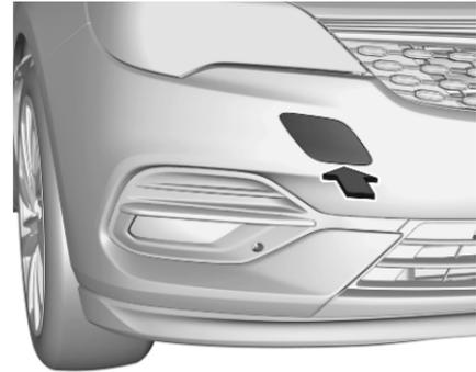
Envelopper d'un linge l'extrémité d'un tournevis plat pour ne pas endommager la peinture. Insérer le tournevis dans la fente sur le bord du capuchon. Libérer le capuchon en faisant doucement lever dessus.
