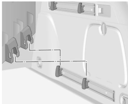
En variante, installer deux crochets dans le rail inférieur. Enfiler les consoles inférieures de la boîte dans les crochets inférieurs, depuis le haut.
