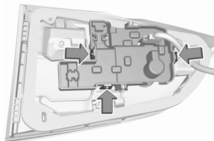
4. Enfoncer les trois pattes de retenue et enlever le support d'ampoule de l'ensemble de feu.
