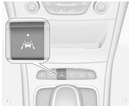
L'assistance au maintien de trajectoire est activée en appuyant sur
