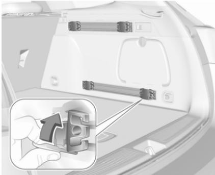
Ouvrir la plaque de fixation, placer l'adaptateur dans la rainure supérieure et inférieure du rail et les amener aux endroits voulus. Basculer la plaque de fixation vers le haut pour bloquer l'adaptateur. Pour la dépose, tourner la plaque de fixation vers le bas et la sortir du rail.
