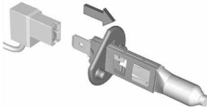
4. Séparer l'ampoule de la douille d'ampoule et remplacer l'ampoule.
