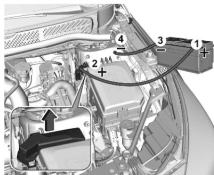
Séquence de raccordement des câbles :
