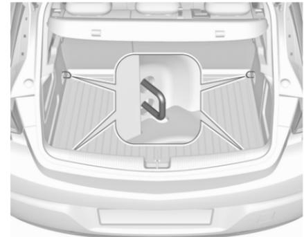
Sur les véhicules équipés d'une roue de secours, les anneaux d'arrimage avant sont situés au niveau des parois latérales.
