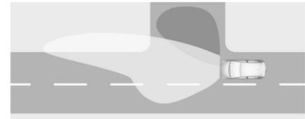
En retour de virage, en fonction de l'angle de braquage des feux de direction, des LED particulières sont allumées dans le sens du trajet. Il est activé jusqu'à une vitesse de 40 km/h.
