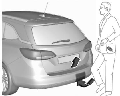
Pour ouvrir ou fermer le hayon, avancer et reculer le pied sous le pare-chocs arrière dans la zone illustrée. Si le véhicule est équipé de l'aide au stationnement, cette zone est reconnaissable sous le capteur indiqué. Ne pas laisser le pied trop longtemps ou le bouger trop lentement sous le pare-chocs. La clé électronique doit se trouver à l'extérieur du véhicule dans un rayon d'environ 1 m du hayon.
