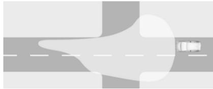
Activés automatiquement à une vitesse maximale d'environ 55 km/h et en cas de lumière ambiante extérieure. Le faisceau lumineux est large et symétrique. Un type spécial de faisceau lumineux permet d'éviter d'éblouir les autres usagers de la route.
