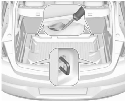
Sur les véhicules équipés d'un kit de réparation des pneus, les anneaux d'arrimage avant sont placés sous le revêtement du plancher arrière, derrière les sièges arrière. Pour accéder aux anneaux d'arrimage, ouvrir les parties perforées du revêtement à l'aide d'un tournevis.
