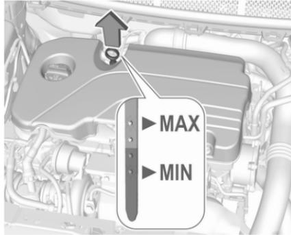
Retirer la jauge d'huile, la nettoyer, la réinsérer entièrement, la retirer et lire le niveau d'huile moteur.
