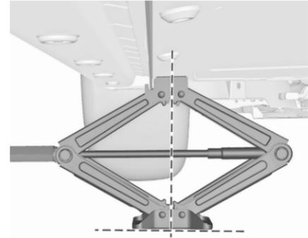
4. Régler le cric à la hauteur requise. Le positionner directement sous le point de levage de manière telle qu'il ne glisse pas.
