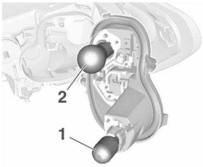
7. Enlever et remplacer les ampoules :
