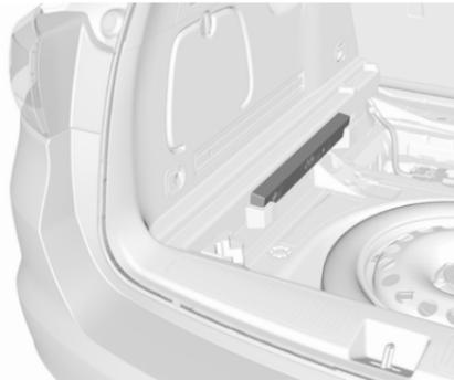
Ranger le triangle de présignalisation dans le renforcement sous le couvercle de plancher arrière du côté droit ou du côté gauche.
