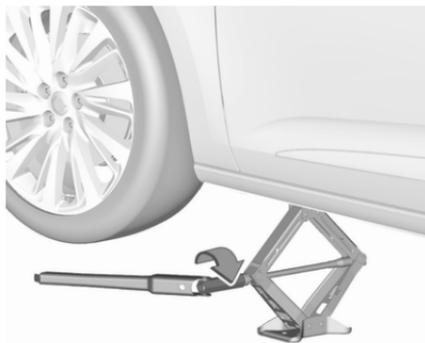
Attacher la clé de roue, aligner correctement le cric et tourner la clé de roue jusqu'à ce que la roue ait quitté le sol.
