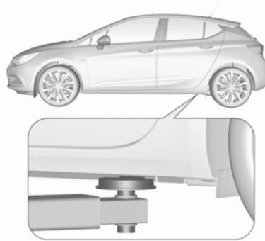
Position de centrage du bras porteur arrière du pont élévateur sous le point de levage du véhicule.
