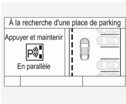
Sélectionner une place de stationnement parallèle ou perpendiculaire dans le centre d'informations du conducteur par une pression longue sur **P**.
