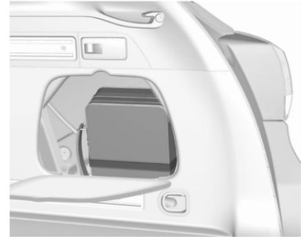
Ouvrir le recouvrement sur le côté droit du coffre.
