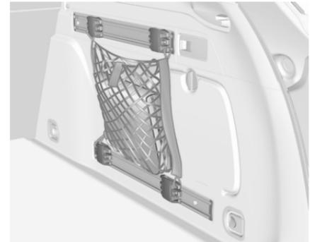
Introduire les adaptateurs dans les rails à la position désirée. Le filet de rangement peut être accroché aux adaptateurs.
