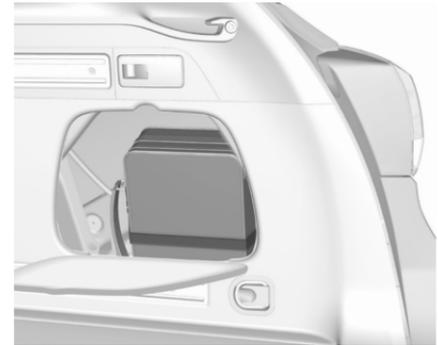
Sur le Sports Tourer, le kit de réparation des pneus se trouve dans une valise sur le côté droit du coffre derrière un couvercle. La valise est maintenue par une sangle.
