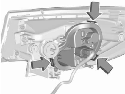
6. Enfoncer les trois pattes de retenue et enlever le support d'ampoule de l'ensemble de feu.
