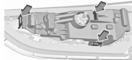
5. Enfoncer les trois pattes de retenue et enlever le support d'ampoule de l'ensemble de feu.
