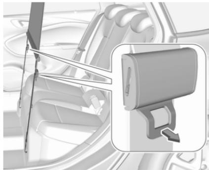
Tirer le volet au niveau du tendeur des deux côtés pour libérer les attaches. Détacher les crochets des anneaux.
