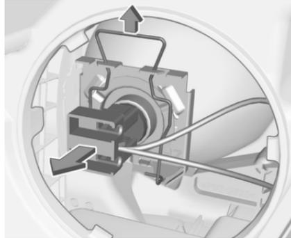
2. Dégager le clip à ressort du dispositif de retenue en tirant. Retirer la douille de l'ampoule du boîtier du réflecteur.
