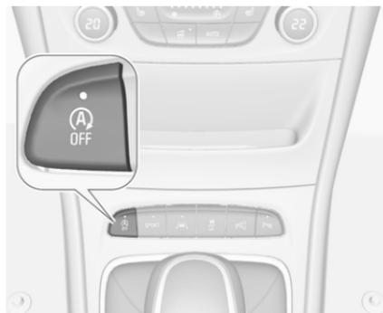
Pour désactiver le système d'arrêt-démarrage manuellement, appuyer sur
