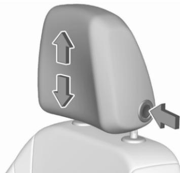
Appuyer sur le bouton de déverrouillage, régler la hauteur, engager.
