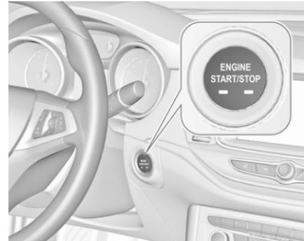
La clé électronique doit se trouver à l'intérieur du véhicule.
