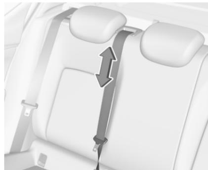
La ceinture de sécurité du siège central peut être bloquée quand le dossier est relevé trop rapidement. Pour débloquer l'enrouleur, rentrer la ceinture de sécurité ou la sortir d'environ 20 mm, puis relâcher.
