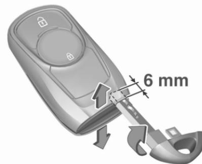
2. Insérer de nouveau le panne de la clé sur environ 6 mm et tourner la clé pour ouvrir le boîtier. Une insertion plus profonde de la clé peut endommager le boîtier.
