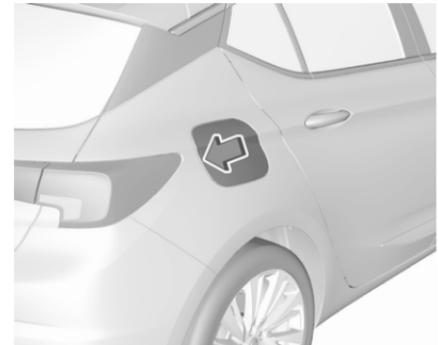
La trappe de réservoir ne peut être ouverte que si le véhicule est déverrouillé. Ouvrir la trappe à carburant en la poussant.
