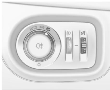
La luminosité des phares suivants peut être réglée en position **AUTO** lorsque le capteur de lumière détecte des conditions de nuit, ou en position **D** ou **D**.
