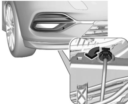
1. Enlever la vis avec un tournevis Torx et retirer la plaquette.
