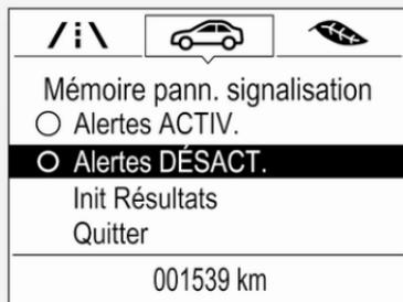
Sélectionner **Alertes ACTIV.** ou **Alertes DÉSACT.** en tournant la molette de réglage et appuyer sur **SET/CLR**.
