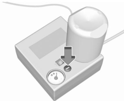
Si la pression de pneu prescrite n'est pas atteinte dans les 10 minutes, démonter le kit de réparation de pneus. Avancer ou reculer le véhicule d'un tour de roue. Brancher à nouveau le kit de réparation de pneus et poursuivre
