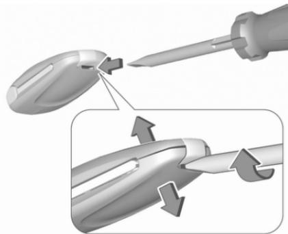
1. Introduire un tournevis plat dans la fente et détacher le couvercle noir de la télécommande en tournant légèrement le tournevis.
