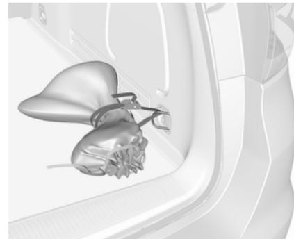
Ranger la barre d'attelage à rotule dans le sac et fixer celui-ci en passant la sangle dans l'anneau d'arrimage arrière droit. Passer deux fois autour et serrer la sangle pour fixer le sac.
