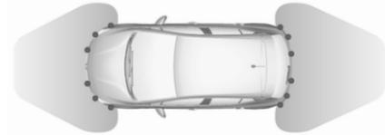
Le système avancé d'assistance au stationnement est toujours associé à l'aide au stationnement avant-arrière. Les deux systèmes utilisent les mêmes capteurs sur les pare-chocs avant et arrière.
