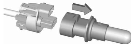
4. Tirer l'ampoule de la douille d'ampoule et la remplacer.
