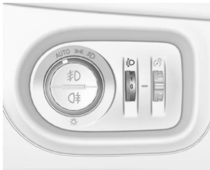
Pour adapter la portée des phares en fonction du chargement du véhicule afin d'éviter l'éblouissement : tourner la molette **D** dans la position désirée.
