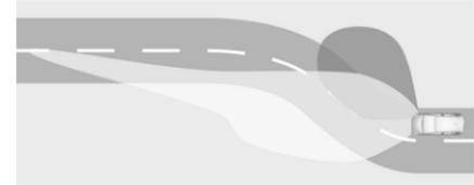
Des LED particulières, basées sur l'angle de braquage et la vitesse, sont en plus déclenchées pour améliorer l'éclairage dans les virages. Cette fonction est activée à des vitesses entre 40 km/h et 70 km/h et réagit à l'angle de braquage.
