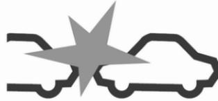
Lorsque la distance par rapport à un véhicule qui précède devient temporairement trop courte et qu'une collision est imminente, le symbole d'alerte de collision s'affiche dans le centre d'informations du conducteur et le conducteur est averti par un signal sonore d'avertissement.
