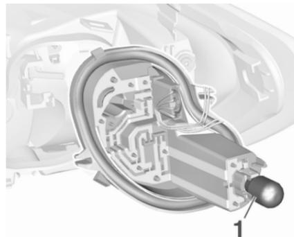
Sur la version avec feux arrière à DEL et feux stop à DEL, seule l'ampoule du feu de direction (1) peut être retirée et remplacée.
