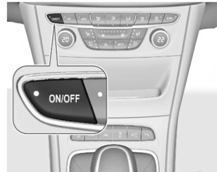
Le refroidissement, le ventilateur et le mode automatique peuvent être désactivés en appuyant sur **ON/OFF**. Lorsque le système est désactivé, la LED du bouton **ON/OFF** ne s'allume pas.
