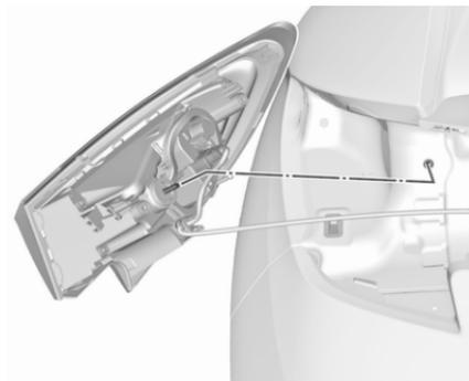
4. Retirer avec précaution l'ensemble de feu arrière du renforcement et le déposer.
