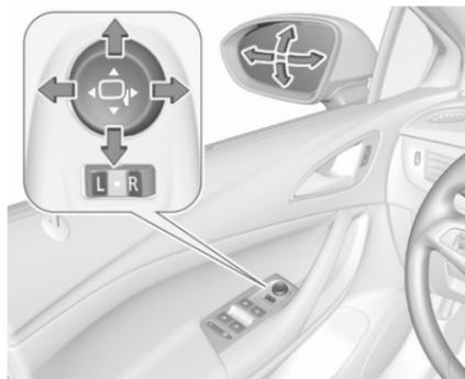
Sélectionner le rétroviseur extérieur souhaité en tournant la commande vers la gauche (**L**) ou vers la droite (**R**). Puis pivoter le bouton de commande pour régler le rétroviseur.
