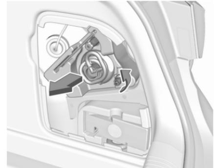
2. Véhicules avec kit de réparation des pneus : Pour remplacer les ampoules du côté droit, dévisser d'abord l'écrou en plastique et retirer l'insert avec la bouteille de produit d'étanchéité.
