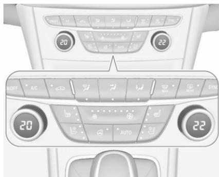
Régler les températures à la valeur souhaitée. Le bouton du côté passager permet de modifier la température du côté passager. Le bouton du côté conducteur permet de modifier la température du côté conducteur ou des deux côtés selon l'activation de la synchronisation **SYNC**.
