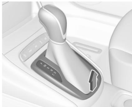
2. Dégager la garniture du levier sélecteur de la console centrale. Enfoncer un doigt dans la douille en cuir sous le levier sélecteur et pousser la garniture vers le haut. Déplacer la garniture sur la gauche.
