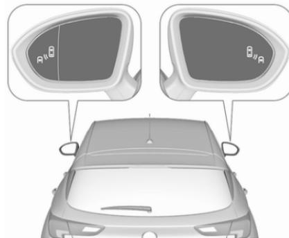
L'alerte d'angle mort latéral est activée lorsque le véhicule roule à des vitesses allant de 10 km/h à 140 km/h. Conduire à une vitesse supérieure à 140 km/h désactive le
