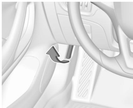
Tirer le levier de déverrouillage du capot et le replacer à sa position d'origine.
