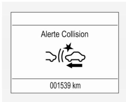
Il est à noter que le réglage de sensibilité de temporisation d'alerte est partagé avec le réglage de la distance vers l'avant du régulateur de vitesse adaptatif. Donc modifier la sensibilité de la temporisation d'alerte change le réglage de distance vers l'avant du régulateur de vitesse adaptatif.
