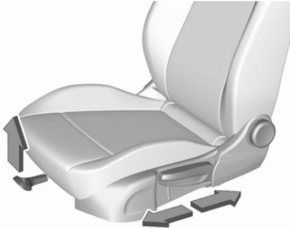
Tirer la poignée, déplacer le siège et relâcher la poignée. Essayer de déplacer le siège vers l'arrière et l'avant pour s'assurer que le siège est verrouillé en place.
