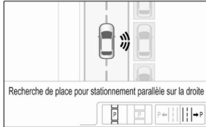
Sélectionner une place de stationnement parallèle ou perpendiculaire en appuyant sur l'icône correspondante de l'affichage.
