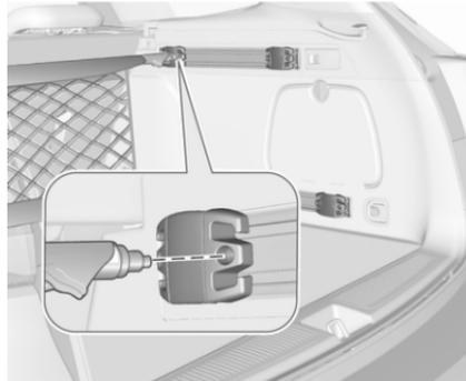
Introduire les adaptateurs dans les rails à la position désirée. Assembler les moitiés des barres de filet.
