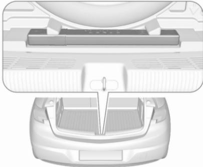
Ranger le triangle de présignalisation dans le renforcement à l'arrière du coffre.
