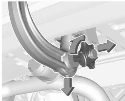
Ouvrir le volet de protection et tourner la clé en position
