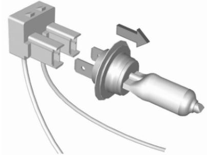
3. Séparer l'ampoule de la douille d'ampoule et remplacer l'ampoule.
