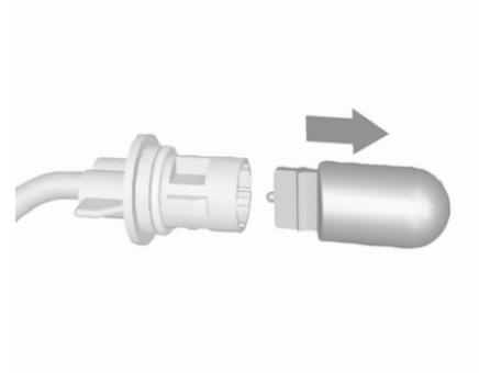
3. Tirer l'ampoule de la douille d'ampoule et la remplacer.
