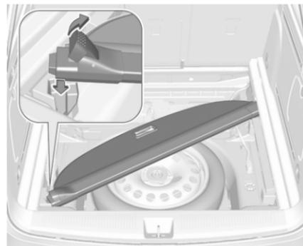
Pour toutes les versions de motorisation, à l'exception du GNC : une fois retiré, le store peut être rangé sous le recouvrement de plancher arrière comme illustré. Insérer d'abord le côté gauche du cache enroulé dans le renforcement avant droit, tirer le levier vers le haut et insérer le côté droit dans le renforcement avant gauche.
