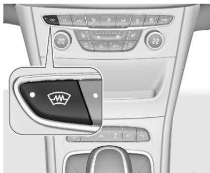
Si le véhicule est équipé d'un pare-brise chauffant, le bouton **ON/OFF** est remplacé par le bouton
