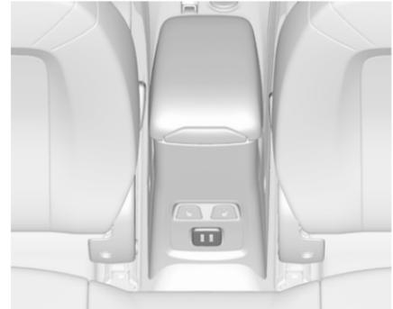
Deux ports USB réservés à la charge de périphériques sont situés à l'arrière de la console centrale.
