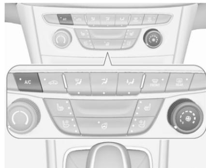
Appuyer sur **A/C** pour mettre le refroidissement en marche. L'activation est signalée par la LED dans le bouton. Le refroidissement ne fonctionne que
