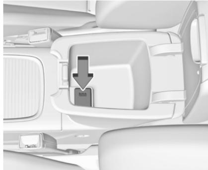
Selon l'Infotainment System, un ou deux ports USB de charge d'appareils se trouvent entre les sièges avant. Ces ports disposent également d'une connexion de données à l'Infotainment System. Pour de plus amples informations, consulter le guide de l'Infotainment.
