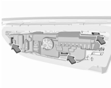
Sur la version avec feux arrière à DEL, la position des pattes de retenue est légèrement différente.
