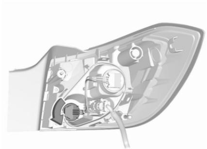
Sur la version avec feux arrière à DEL et feu stop à DEL, seule l'ampoule du feu de direction peut être remplacée : déposer le porte-ampoule dans l'ensemble de feu en le tournant. Replacer l'ampoule dans le porte-ampoule.
