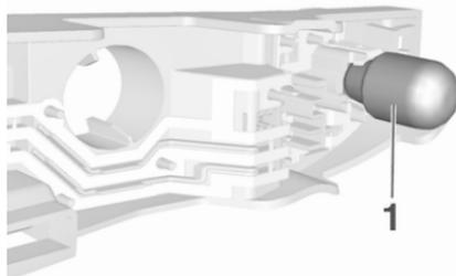
Sur la version avec feux arrière à DEL, seule l'ampoule de feu de recul (1) peut être déposée et remplacée.
