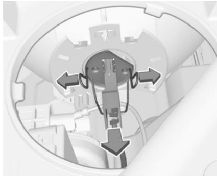
2. Dégager le clip à ressort du dispositif de retenue en le déplaçant vers l'avant et sur le côté. Faire pivoter le clip à ressort vers le bas.
