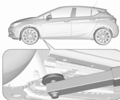
Position de centrage du bras porteur avant du pont élévateur sous le point de levage du véhicule.
