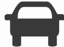
Le témoin de véhicule à l'avant allumé en vert
