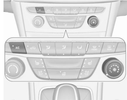
Appuyer sur **A/C** pour mettre le refroidissement en marche. L'activation est signalée par la LED dans le bouton. Le refroidissement ne fonctionne que
