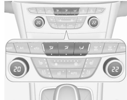
Appuyer sur le bouton approprié pour le réglage souhaité. L'activation est signalée par l'éclairage de la LED dans le bouton.
