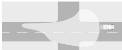
Activés automatiquement à une vitesse maximale d'environ 55 km/h et en cas de lumière ambiante extérieure. Le faisceau lumineux est large et symétrique. Un type spécial de faisceau lumineux permet d'éviter d'éblouir les autres usagers de la route.
