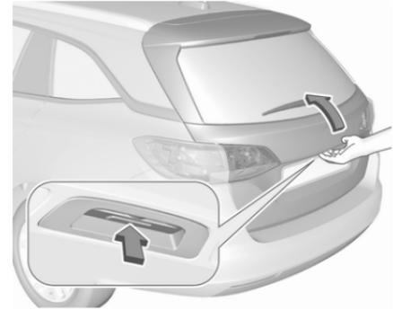
Après le déverrouillage, appuyer sur le bouton du hayon sous la moulure du hayon et ouvrir le hayon manuellement.
