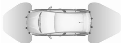
Quatre capteurs de stationnement à ultrasons sont présents dans chaque pare-chocs avant et arrière.
