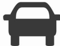
Le témoin de véhicule à l'avant allumé en vert
