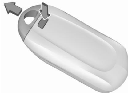
1. Appuyer sur le bouton au dos de la clé électronique et retirer la lame de la clé du boîtier.
