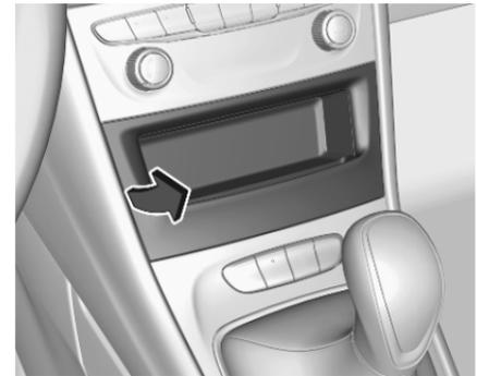
2. Replier le côté gauche du couvercle vers l'avant. S'assurer que le collier de fixation est guidé comme indiqué dans l'illustration.
