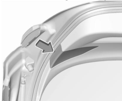
1. Détacher le couvercle dans le hayon et le déposer.
