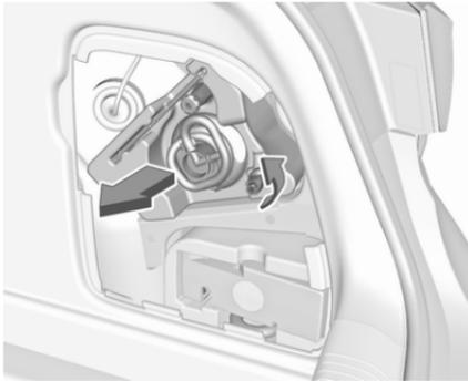
2. Véhicules avec kit de réparation des pneus : Pour remplacer les ampoules du côté droit, dévisser d'abord l'écrou en plastique et retirer l'insert avec la bouteille de produit d'étanchéité.
