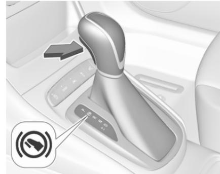
Le levier sélecteur est verrouillé en position **P** et ne peut être déplacé que lorsque le contact est mis, lorsque le bouton de déverrouillage sur le levier sélecteur est poussé et que la pédale de frein est enfoncée.
