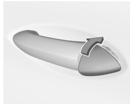
Après le verrouillage, recouvrir le barillet de serrure avec le capuchon : insérer le bas du capuchon dans le renforcement, le faire pivoter et le pousser jusqu'à ce que le haut du capuchon s'enclenche.
