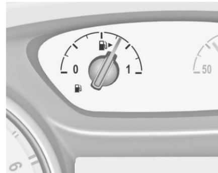
Affiche le niveau de carburant ou de gaz (GNC) contenu dans le réservoir selon le mode de fonctionnement actif.
