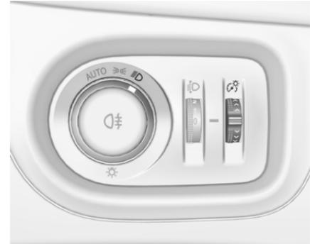
La luminosité des phares suivants peut être réglée en position **AUTO** lorsque le capteur de lumière détecte des conditions de nuit, ou en position  $\Rightarrow$  ou  $\Leftarrow$  D.
