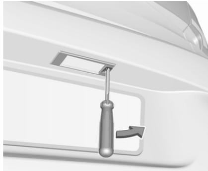
1. Introduire un tournevis dans le creux du couvercle, appuyer sur le côté et libérer le ressort.
