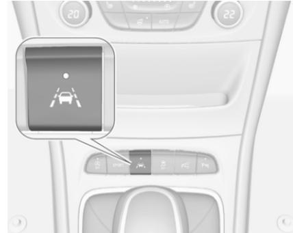
L'assistance au maintien de trajectoire est activée avec le démarrage du moteur ou en appuyant sur
