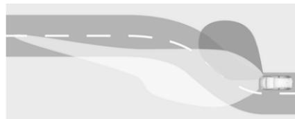
Des LED particulières, basées sur l'angle de braquage et la vitesse, sont en plus déclenchées pour améliorer l'éclairage dans les virages. Cette fonction est activée à des vitesses entre 40 km/h et 70 km/h et réagit à l'angle de braquage.
