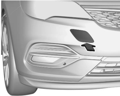
Envelopper d'un linge l'extrémité d'un tournevis plat pour ne pas endommager la peinture. Insérer le tournevis dans la fente sur le bord du capuchon. Libérer le capuchon en faisant doucement lever dessus.
