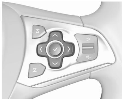
Sur l'affichage de niveau supérieur, choisir le menu **Info** à l'aide des boutons à droite du volant et appuyer sur **∨** ou **∧** pour sélectionner la page d'assistant de détection des panneaux routiers
