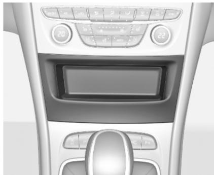
Un compartiment mixte de rangement et d'appareil mobile se trouve dans l'étagère centrale du tableau de bord.
