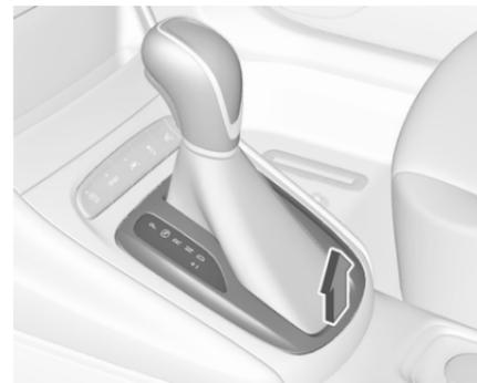
2. Dégager la garniture du levier sélecteur de la console centrale. Enfoncer un doigt dans la douille
