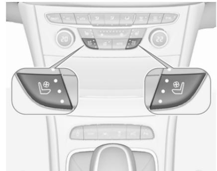
Régler la ventilation au niveau souhaité en appuyant une ou plusieurs fois sur du siège correspondant. Le témoin dans le bouton indique le réglage sélectionné.
