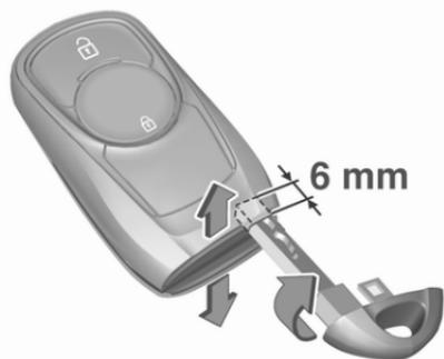
2. Insérer de nouveau la lame de la clé sur environ 6 mm et tourner la clé pour ouvrir le boîtier. Une insertion plus profonde de la clé peut endommager le boîtier.
