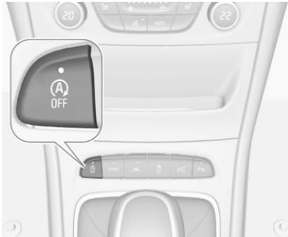
Pour désactiver le système d'arrêt-démarrage manuellement, appuyer sur
