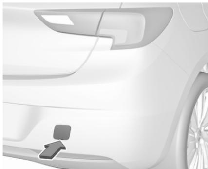
Insérer le tournevis dans la fente sur le bord du capuchon. Libérer le capuchon en faisant doucement levier dessus.
