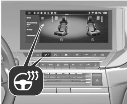
Activer le chauffage en appuyant sur
