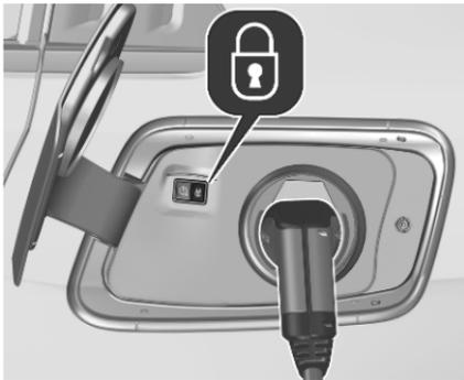
Pendant le chargement, la fiche du véhicule est verrouillée sur le port de chargement et ne peut être débranchée en cours de chargement. L'indicateur
