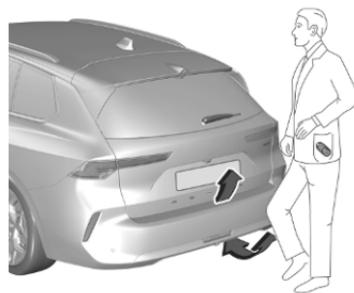
Pour ouvrir ou fermer le hayon, avancer et reculer le pied sous le pare-chocs arrière dans la zone illustrée. Si le véhicule est équipé de l'aide au stationnement, cette zone est reconnaissable sous le capteur. Ne pas laisser le pied trop longtemps ou le bouger trop lentement sous le pare-chocs. La clé électronique doit se trouver à l'extérieur du véhicule dans un rayon d'environ 1 m du hayon.
