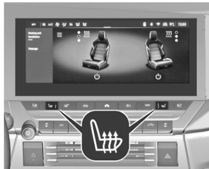
Régler le chauffage sur l'intensité voulue en appuyant une ou plusieurs fois sur
