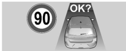
Appuyer sur **OK** pour mémoriser la vitesse actuelle du véhicule et activer le régulateur de vitesse. Sur l'écran du régulateur de vitesse adaptatif, la vitesse réglée et un élément de la route s'affichent en vert. La pédale d'accélérateur peut être relâchée.
