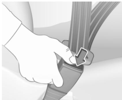
Pour relâcher la ceinture de sécurité, appuyer sur le bouton rouge de la boucle de ceinture de sécurité et guider la ceinture de sécurité vers l'arrière.
