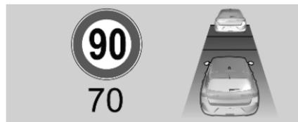
Si le système détecte un véhicule sur la voie de circulation, l'écran du régulateur de vitesse adaptatif change en conséquence.
