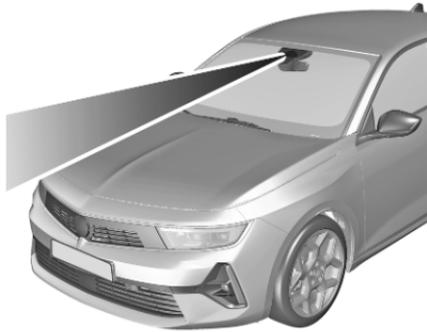
Le système activé repère les marques de la voie à l'aide de la caméra placée en haut du pare-brise. Il dirige le véhicule à l'intérieur de la voie détectée. Le conducteur remarque un mouvement de rotation du volant.
