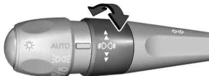
Tourner la molette de réglage vers l'avant/l'arrière pour allumer/éteindre les phares antibrouillard.
