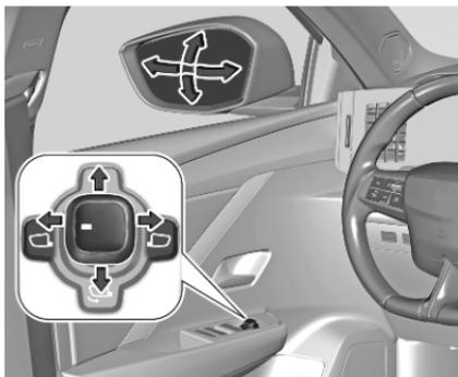
Sélectionner le rétroviseur extérieur souhaité en tournant la commande. Ensuite, faire pivoter la commande pour régler le rétroviseur sélectionné.
