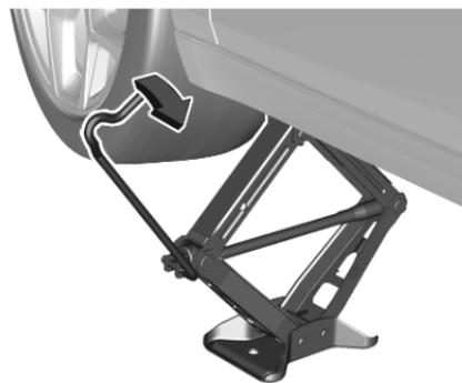
Quand le cric est bien aligné, tourner la clé à écrou de roue jusqu'à ce que la roue ne touche plus le sol.
