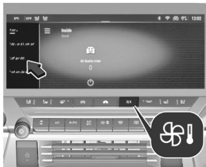
Sélectionner **Qualité air** dans le menu sur le côté gauche de l'écran pour afficher l'indice de qualité de l'air et pour activer/désactiver la fonction.
