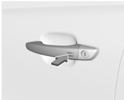
Le verrouillage central peut également être actionné en touchant le capteur de la poignée de porte du conducteur.
