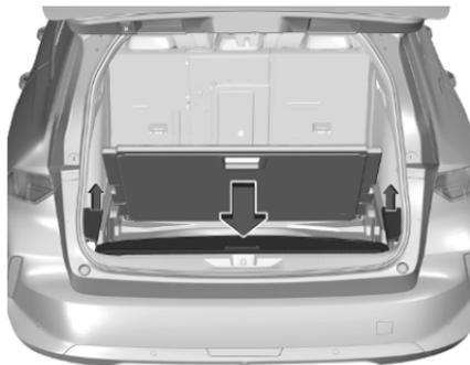
Soulever le recouvrement de plancher arrière et déposer les recouvrements des deux côtés du coffre pour accéder aux logements.
