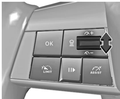
La vitesse mémorisée peut être modifiée en déplaçant la molette sur  $\curvearrowright$  pour augmenter la vitesse ou sur  $\curvearrowleft$  pour la réduire. Déplacer la molette à plusieurs reprises pour modifier la vitesse par petits incréments ; déplacer et maintenir pour modifier la vitesse par grands incréments.
