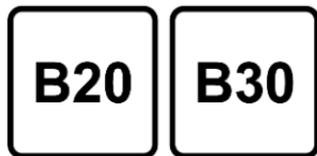
L'utilisation d'un carburant B20 ou B30 conforme à la norme EB16709 est possible dans nos moteurs diesel. Toutefois, cette utilisation, même occasionnelle, exige une application
