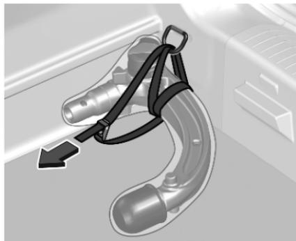
Le sac contenant la barre d'attelage à rotule et ranger sur le tapis de sol arrière dans le coffre.
