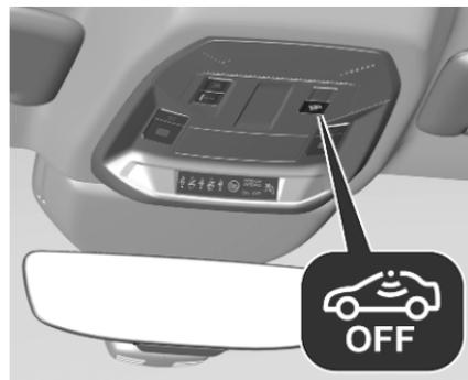
Désactiver la surveillance de l'habitacle et de l'inclinaison du véhicule quand des animaux sont laissés dans le véhicule en raison de la grande quantité de signaux ultrasoniques ou de leurs mouvements déclenchant l'alarme. Le désactiver également quand le véhicule est à bord d'un ferry ou d'un train.
