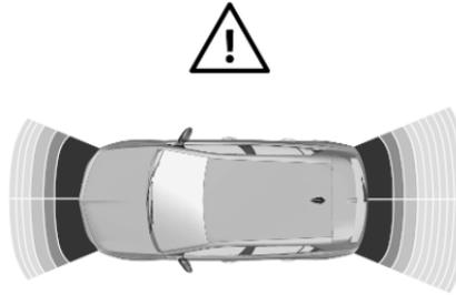
L'intervalle entre les signaux sonores se réduit au fur et à mesure que le véhicule se rapproche de l'obstacle dans le sens de la conduite. Lorsque la distance est inférieure à environ 30 cm, le signal sonore est continu.
