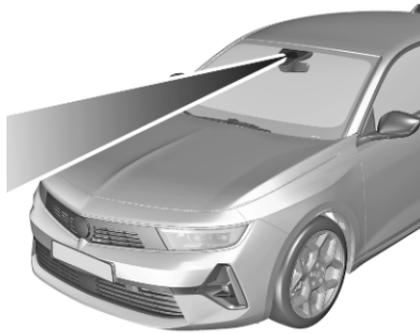
Le système activé repère les marquages de la voie à l'aide de la caméra placée en haut du pare-brise. Il dirige le véhicule à l'intérieur de la voie détectée. Le conducteur remarque un mouvement de rotation du volant.
