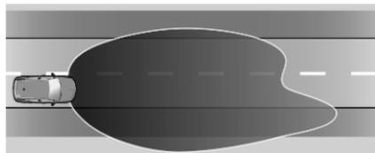
Activés automatiquement par la vitesse du véhicule en conduisant dans des zones rurales. L'éclairage de la voie et du bas-côté est adapté. Les véhicules qui arrivent et qui précèdent ne sont pas éblouis.
