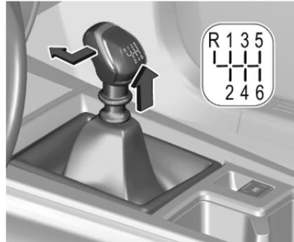
Pour engager la marche arrière, le véhicule étant arrêté et le moteur au ralenti, enfoncer la pédale d'embrayage, soulever la bague sous le levier sélecteur et engager le rapport.
