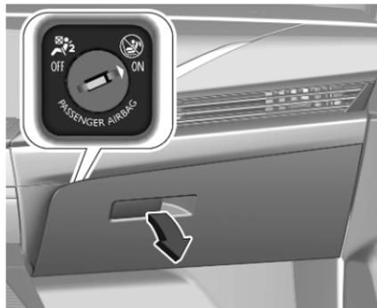
Le système d'airbag du passager avant peut être désactivé via un commutateur à clé dans la boîte à gants.
