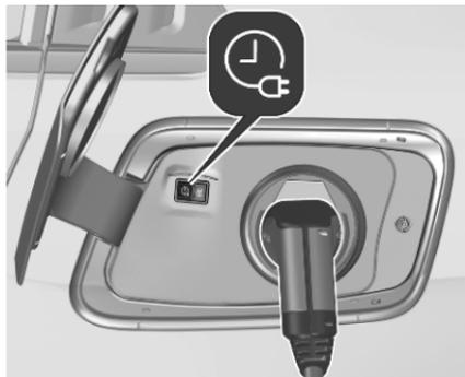
8. En moins d'une minute, appuyer sur
