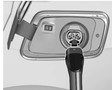
6. Brancher la fiche côté véhicule du câble de chargement dans le port de chargement du véhicule.
