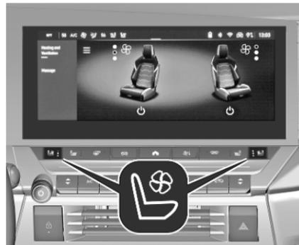
Régler la ventilation sur l'intensité voulue en appuyant une ou plusieurs fois sur
