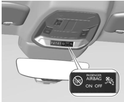
Si le témoin
