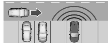
Le système détecte des obstacles qui se déplacent à une vitesse supérieure à 3 km/h et à une distance maximale de 40 m.
