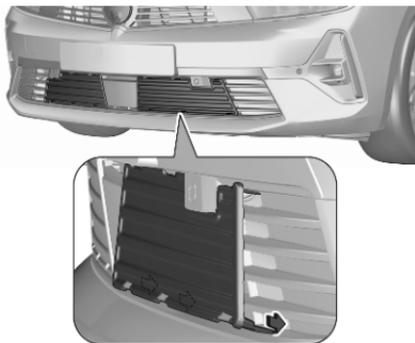
Appuyer les caches de protection contre la lame de la grille. S'assurer que les caches de protection sont solidement fixés.
