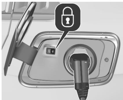
Pendant le chargement, la fiche du véhicule est verrouillée sur le port de chargement et ne peut être débranchée en cours de chargement. L'indicateur
