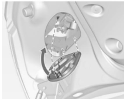
5. Fermer le couvercle en commençant par insérer les agrafes de fixation. Verrouiller le couvercle en tournant la vis dans le sens horaire à l'aide d'une pièce de monnaie.
