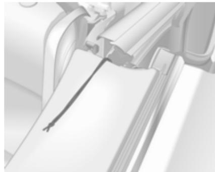
Déposer l'extrémité des cordes sur l'avant.
