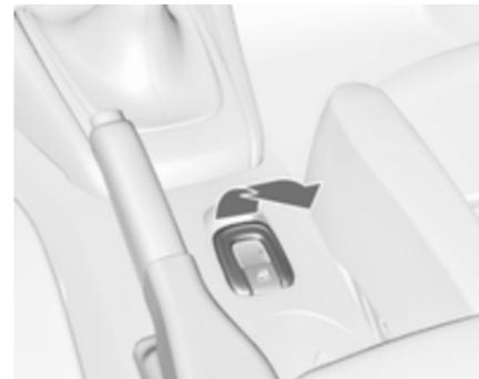
Maintenir la traction sur le commutateur jusqu'à ce que le toit souple soit complètement ouvert et que le couvercle du toit souple soit fermé. Toutes les vitres seront ouvertes pendant cette opération.
