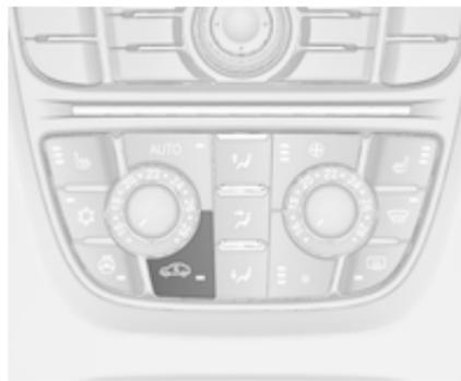
Appuyer sur le bouton
