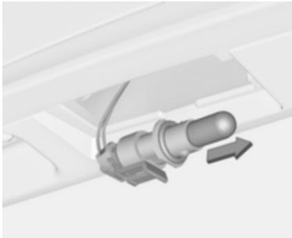
4. Tirer l'ampoule de la douille d'ampoule et la remplacer.
