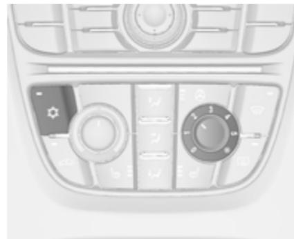
Appuyer sur le bouton
