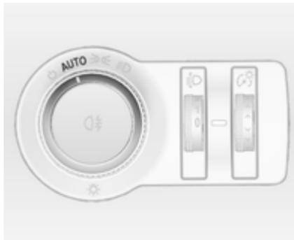
Quand la fonction de commande automatique des feux est activée et que le moteur tourne, le système bascule automatiquement entre les feux de jour et les phares en fonction des conditions d'éclairage et de l'information communiquée par le système de détecteur de pluie.
