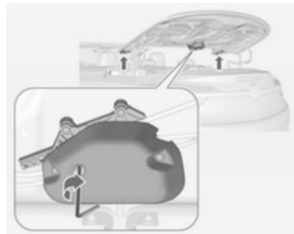
6. Insérer la clé Allen de 4 mm dans la position marquée sur l'unité d'entraînement de rabat. Tourner complètement la clé Allen dans le sens horaire jusqu'à la butée, de manière à ce que les rabats latéraux pivotent vers l'intérieur.
