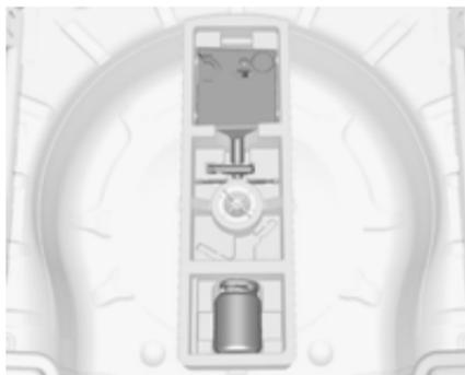
Certains outils et l'oeillet de remorquage sont rangés avec le kit de réparation des pneus dans une boîte à outils dans le coffre sous le recouvrement de plancher.
