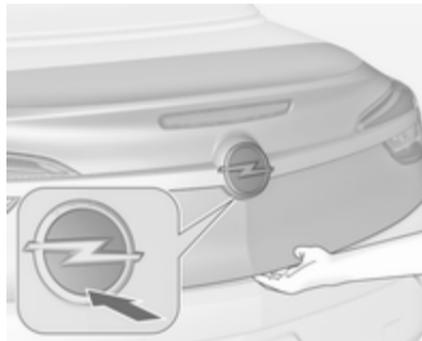
Appuyer sur le bouton
