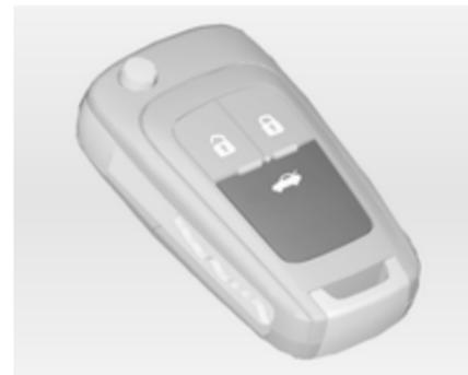
Une pression du bouton
