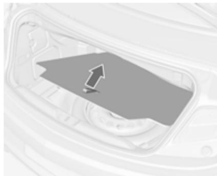
Le recouvrement de plancher arrière peut être soulevé et déposé. Sous le recouvrement se trouvent la roue de secours, les outils du véhicule ou le kit de réparation des pneus.
