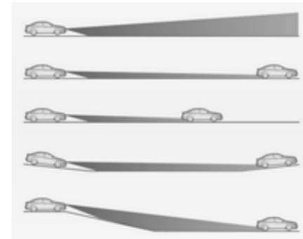
Une fonction d'évaluation topographique spéciale détecte les véhicules en avant lors de la conduite sur des pentes ou collines en reconnaissant le mouvement de l'éclairage arrière du véhicule en avant. Le système règle la hauteur de la portée de feux afin d'assurer un éclairage optimal de la route en avant sans éblouissement.
