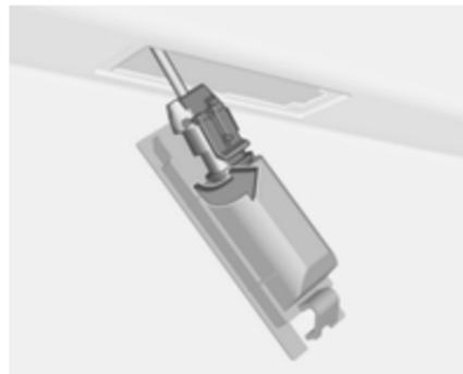
3. Déposer la douille d'ampoule du logement de feu en la tournant dans le sens anti-horaire.
