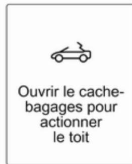
Si l'une de ces exigences n'est pas respectée, un signal sonore retentit et un message s'affiche au centre d'informations du conducteur lorsque le commutateur est actionné et le toit souple ne s'ouvrira ou ne se fermera pas.
