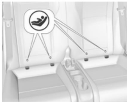
Déposer le déflecteur d'air ↗ 44 avant de monter un système de sécurité pour enfant et déposer au besoin l'appui-tête arrière ↗ 66.
