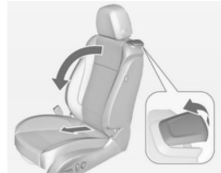
Soulever la poignée de déverrouillage et replier le dossier vers l'avant. Le siège glisse automatiquement vers l'avant jusqu'à la butée.
