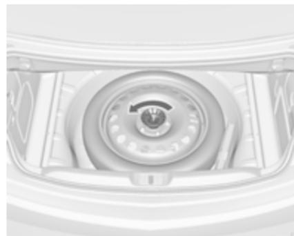
3. La roue de secours est fixée par un écrou papillon dans la niche.
