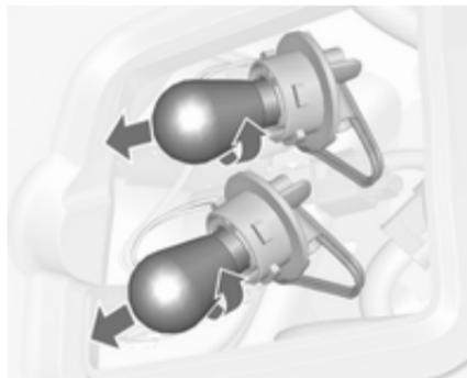
4. Déposer et remplacer l'ampoule.
