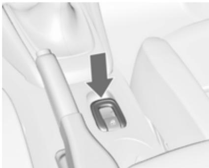
Maintenir la pression sur le commutateur jusqu'à ce que le toit souple et son couvercle soient complètement fermés. Lorsque les vitres commen-
