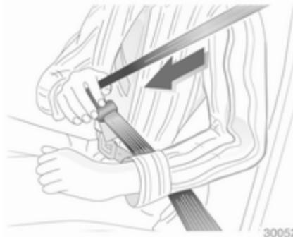
Tirer la ceinture hors de l'enrouleur, la guider sur le corps sans la vriller et insérer le verrou plat dans la serrure. En roulant, tendre régulièrement la sangle abdominale en tirant sur la sangle thoracique.
