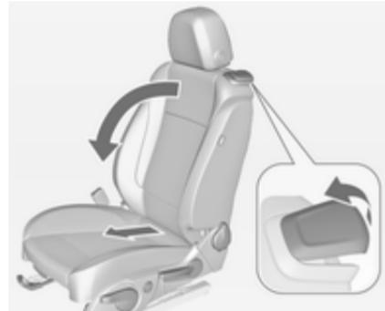
Soulever la poignée de déverrouillage et replier le dossier vers l'avant. Glisser ensuite le siège vers l'avant jusqu'à ce qu'il soit bloqué.
