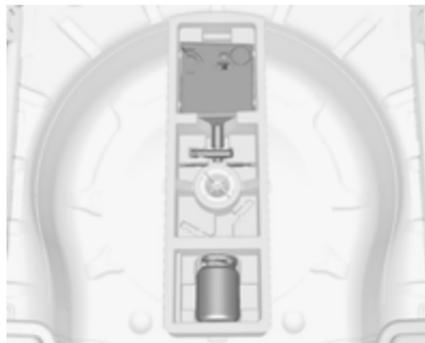
Le kit de réparation des pneus se trouve dans une boîte sous le recouvrement de plancher du coffre.
