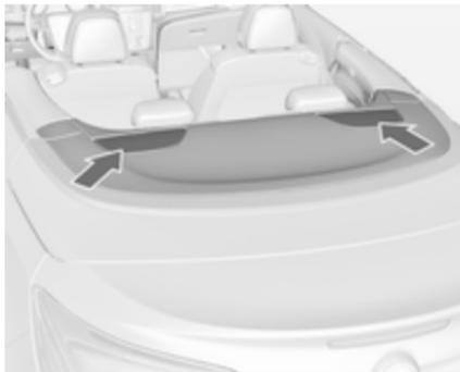
En cas de tonneau, de collision frontale ou de collision latérale, les arceaux de protection contre les tonneaux se déploient automatiquement en quelques millisecondes. Ils se déploient également en même temps que les systèmes d'airbags avant et latéraux.
