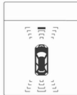
L'indication de la distance affichée sur le centre d'informations du conducteur peut être interrompue par les messages véhicule ayant une plus grande priorité. Pour faire à nouveau apparaître l'indication de distance, approuver le message en appuyant sur le bouton **SET/CLR** du levier de clignotant.
