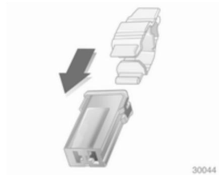
Placer la pince à fusibles par le haut ou le côté sur les différents types de fusibles et retirer le fusible.
