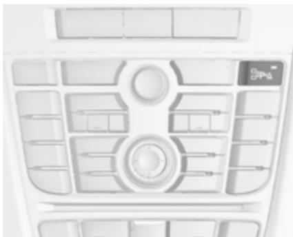
En marche avant à petite vitesse, l'aide au stationnement avant peut également être activée en pressant brièvement le bouton d'aide au stationnement **P**▲ ou **P**▲.
