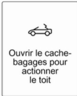
Un signal sonore retentit et un message s'affiche au centre d'informations du conducteur si le séparateur de coffre n'est pas déplié lorsque l'on actionne le commutateur pour ouvrir le toit souple.
