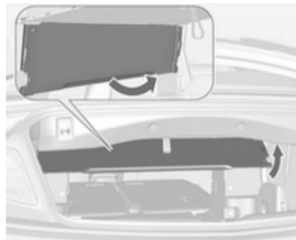
Pour transporter des objets longs dans le coffre, une trappe de passage entre le coffre et l'habitacle du véhicule peut être ouverte :
