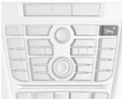
Lors de la recherche d'un emplacement de stationnement, le système est armé en pressant le bouton
