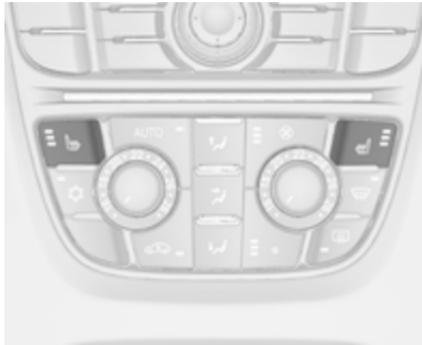
En fonction du niveau de chauffage voulu, appuyer une ou plusieurs fois sur le bouton
