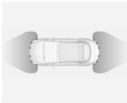
Le système avancé d'assistance au stationnement guide le conducteur dans un emplacement de stationnement en lui donnant des instructions au centre d'informations du conducteur et en émettant des signaux sonores. Le conducteur doit contrôler l'accélération, le freinage, la direction et les changements de vitesses.
