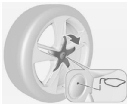
Roues en alliage léger avec capuchon d'écrou central : Dégager le capuchon central en insérant et en tirant l'extracteur ↗ 212 dans le creux de l'emblème de la marque.
