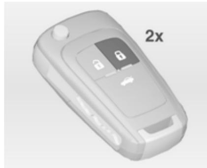
Appuyer deux fois brièvement sur le bouton
