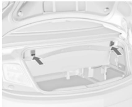
Utiliser les crochets du bord supérieur du coffre pour accrocher des sacoches. Charge maximale : 5 kg.
