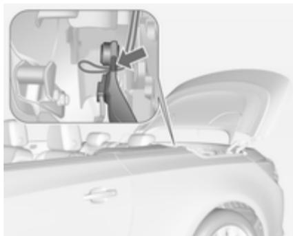
9. Une marque visible figure des deux côtés sur la charnière, sous les couvercles en plastique.
