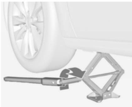
Attacher la clé de roue, aligner correctement le cric et tourner la clé jusqu'à ce que la roue ait quitté le sol.
