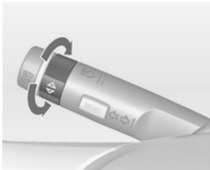
Les panneaux routiers sont affichés sur la page **Détection des panneaux routiers** sur le centre d'informations du conducteur, en sélectionnant avec la roue moletée de la manette des clignotants ↷ 97.
