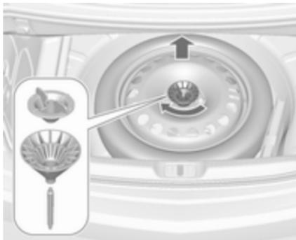
5. Insérer et tourner le cône excéntrique dans le creux de la roue de secours de manière à ce que la
