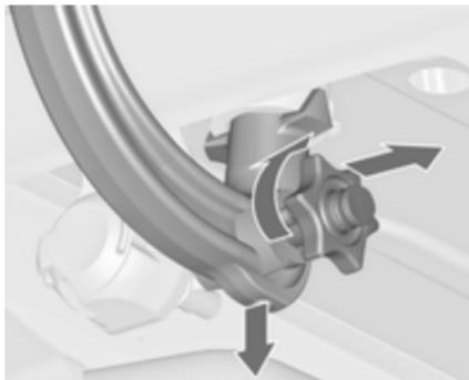
Ouvrir le volet de protection et tourner la clé en position
