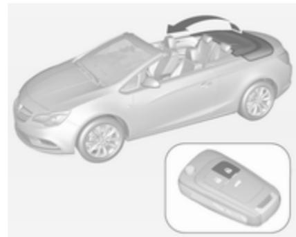
Maintenir le bouton
