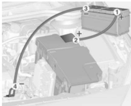
Séquence de raccordement des câbles :
