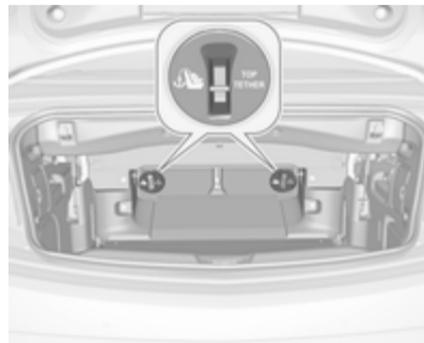
Outre la fixation ISOFIX, fixer la sangle Top-Tether aux anneaux de fixation Top-Tether situés au dos des sièges arrière. Rabattement des dossiers de siège arrière ↗ 73.
