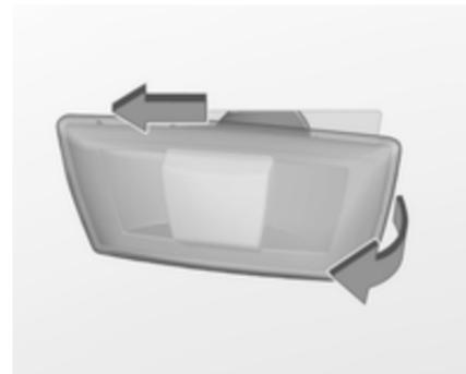
1. Sur le côté gauche du véhicule, faire glisser le phare vers l'avant et retirer de l'aile avec l'extrémité arrière.
