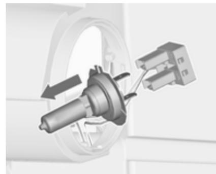
3. Désengager l'ampoule du connecteur en tirant.
