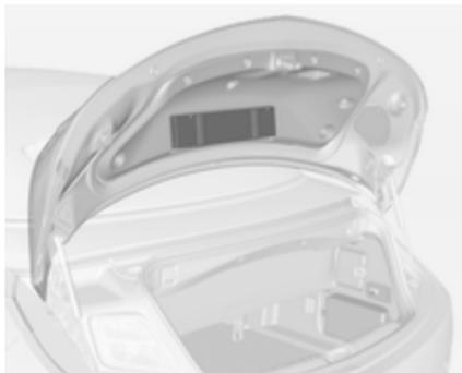
Le triangle de présignalisation est rangé dans l'espace situé à l'intérieur du couvercle du coffre et est maintenu par des sangles.
