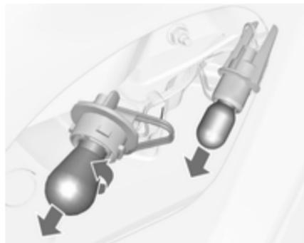
3. Déposer et remplacer l'ampoule.
