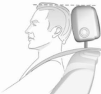
Le bord supérieur de l'appui-tête doit toujours être au niveau du haut de la tête. Si cela s'avérait impossible pour des personnes de très grande taille, l'appui-tête doit être réglé sur la posi-
