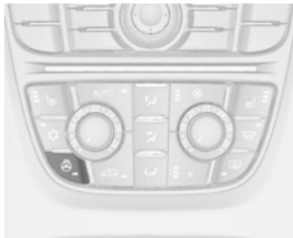
Activer le chauffage en appuyant sur le bouton
