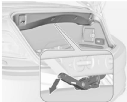
3. Sur le côté intérieur du cadre supérieur de couvercle de coffre figure un levier de déverrouillage du couvercle du toit souple. Repérer le levier et le déverrouiller en le basculant vers le bas.
