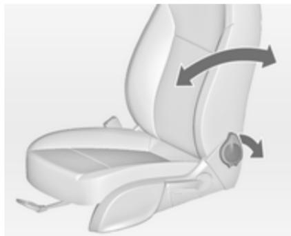
Tourner le levier vers l'arrière, régler l'inclinaison et relâcher le levier. Laisser le siège s'encliqueter de manière audible.
