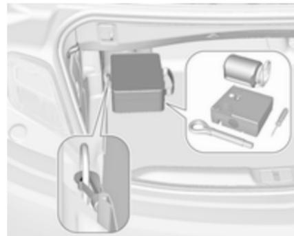
Certains outils et l'oeillet de remorquage sont rangés avec le kit de réparation des pneus dans un sac fixé à l'anneau d'arrimage avant gauche du coffre.
