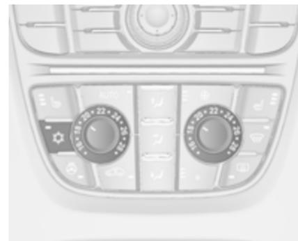
Appuyer sur le bouton
