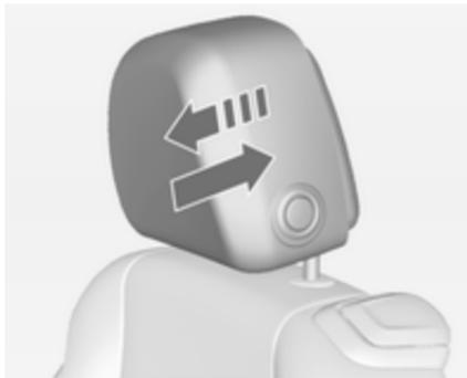
Tirer lentement le rembourrage de l'appui-tête vers l'avant. Il s'enclenche dans plusieurs positions.
