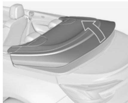
5. Soulever simultanément les deux côtés du couvercle du toit souple jusqu'à mi-hauteur environ.
