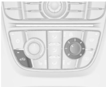
Appuyer sur le bouton
