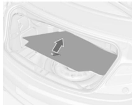
2. Déposer le recouvrement de plancher.
