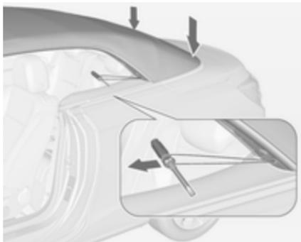
17. Enfoncer fermement chaque côté de l'arceau de tension. Tirer simultanément vers l'avant la corde avec un tournevis passé dans la boucle, lentement et de manière continue. Trouver éventuellement un appui sur l'encadrement de
