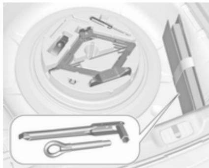
Sous la roue de secours se trouvent une boîte et un sac contenant les outils du véhicule.
