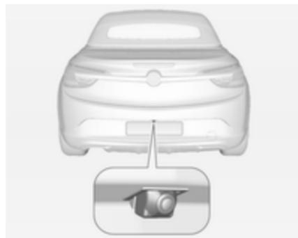
La caméra est montée entre les lampes d'éclairage de la plaque d'immatriculation et à un angle de vision de 130°.
