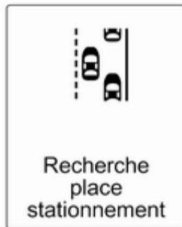
Quand le véhicule passe le long d'une rangée de voitures et que le système est activé, le système avancé d'assistance au stationnement commence à rechercher un emplacement
