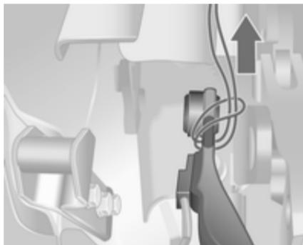
10. Passer les cordes attachées autour de la position marquée sur les charnières des deux côtés, et tirer l'extrémité de la corde à travers la boucle, comme illustré.
