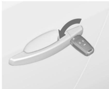
Déverrouiller manuellement la porte du conducteur en tournant la clé dans la serrure. Mettre le contact et appuyer sur le bouton de verrouillage central
