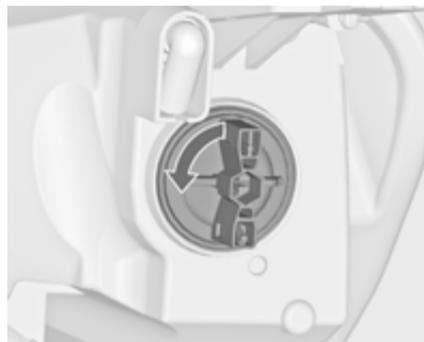
1. Faire tourner la douille de l'ampoule (2) dans le sens antihoraire pour la désencliqueter. Retirer la douille de l'ampoule du réflecteur.
