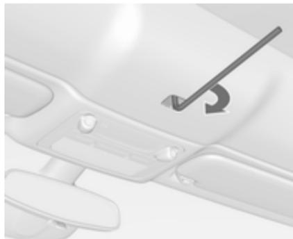
14. Insérer la clé Allen de 6 mm dans le panneau de fermeture et verrouiller l'attache en tournant la clé Allen dans le sens horaire jusqu'à la butée.
