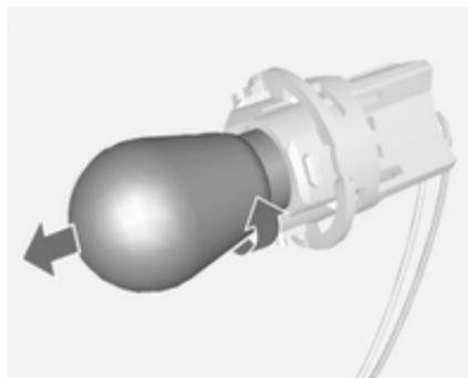
3. Retirer l'ampoule de la douille en tournant dans le sens anti-horaire.
