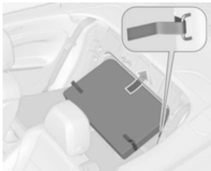
Rabattre les dossiers des sièges arrière. Aligner le couvercle rigide du sac sur le coffre. Mettre en place le sac de bas en haut sur le guide latéral situé dans le renforcement du cadre supérieur. Fixer le sac avec la fixation Velcro aux anneaux d'arrimage des deux côtés. Relever les dossiers des sièges arrière.
