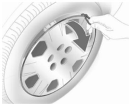
1. Dégager et retirer les capuchons des écrous de roue à l'aide d'un tournevis. Enlever l'enjoliveur à l'aide du crochet. Outillage de bord ↗ 212.
