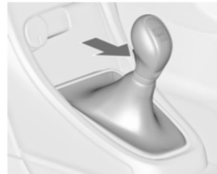
Marche arrière : lorsque le véhicule est à l'arrêt, enfoncer le bouton de déverrouillage du levier sélecteur 3 secondes après avoir enfoncer la pédale d'embrayage et engager la marche arrière.
