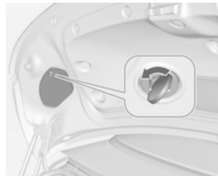
1. Ouvrir et déposer le recouvrement de l'intérieur du couvercle de coffre en desserrant la vis à l'aide d'une pièce de monnaie.
