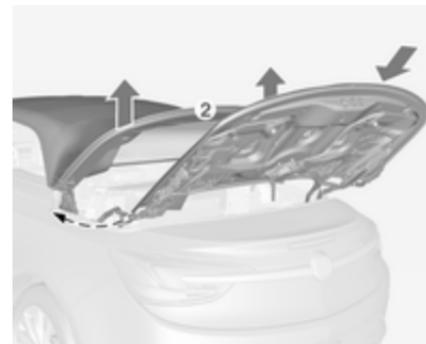
15. Soulever les deux côtés de l'arceau de tension (2) du toit souple. Relever lentement le couvercle du toit souple à mi-course environ puis le laisser glisser en position fermée.
