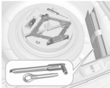
Ouvrir le recouvrement de plancher du coffre. Le cric, les outils et une sangle de fixation pour roue endommagée se trouvent dans la boîte à outils, sous la roue de secours dans le coffre. La clé de roue et l'oeillet de remorquage sont rangés dans un sac à outils se trouvant dans la niche de roue de secours, à côté de la boîte à outils. Roue de secours ↗ 225.
