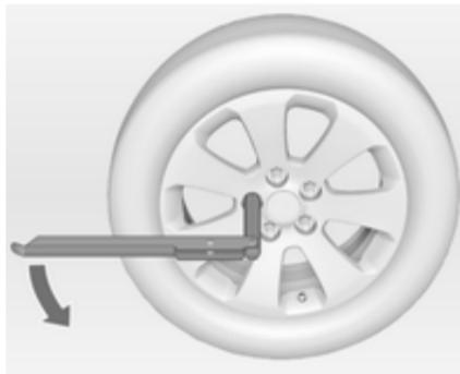
2. Placer la clé de roue en s'assurant qu'elle soit bien positionnée et desserrer chaque écrou de roue d'un demi-tour.
