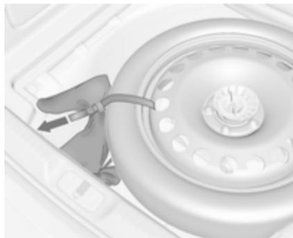
Le sac contenant la barre d'attelage est placé à proximité de la roue de secours, sous le recouvrement de plancher du coffre.
