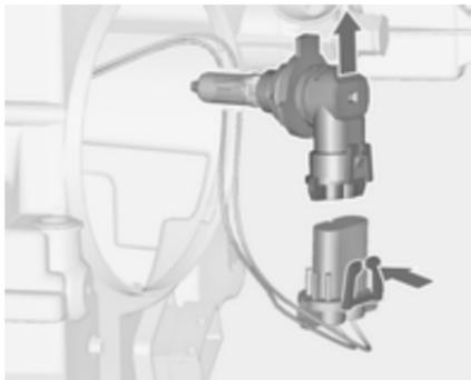
3. Dégager la douille d'ampoule du connecteur en enfouissant la patte de retenue.
