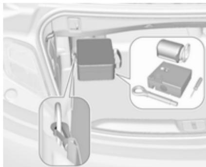
Sur une autre version, un sac contenant le kit de réparation des pneus est fixé à l'anneau d'arrimage arrière gauche du coffre.
