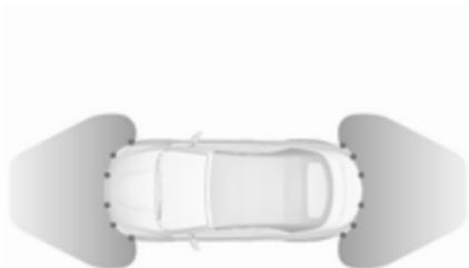
Le système avancé d'assistance au stationnement guide le conducteur dans un emplacement de stationnement en lui fournissant des instructions par le biais du centre d'informations du conducteur et des signaux sonores. Le conducteur doit contrôler l'accélération, le freinage, la direction et les changements de vitesses.
