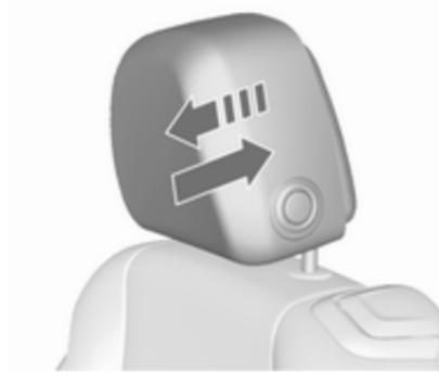
Tirer lentement le rembourrage de l'appui-tête vers l'avant. Il s'enclenche dans plusieurs positions.
