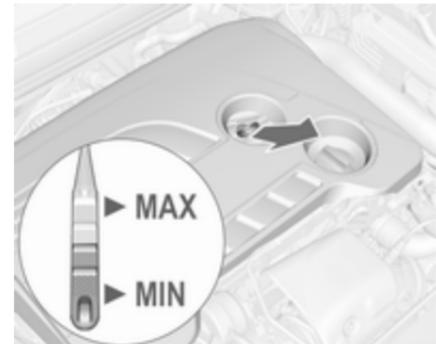
En fonction du moteur, différentes jauges d'huile sont utilisées.
