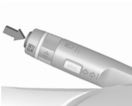
La fonction d'alerte peut être activée ou désactivée sur le menu réglages de la page d'assistant de détection des panneaux routiers en appuyant sur **SET/CLR** sur le levier des clignotants.
