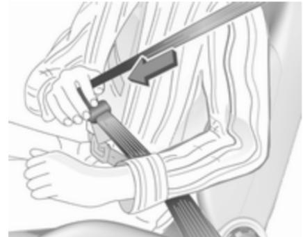
Tirer la ceinture hors de l'enrouleur, la guider sur le corps sans la vriller et insérer le verrou plat dans la serrure.
