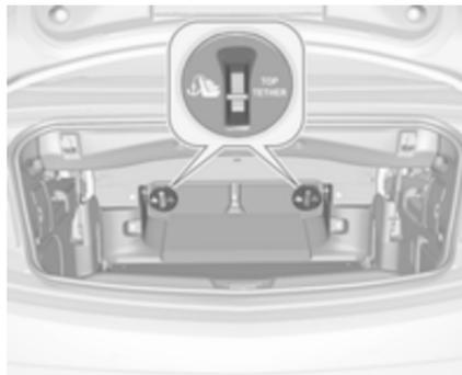
Outre la fixation ISOFIX, fixer la sangle Top-Tether aux anneaux de fixation Top-Tether situés au dos des sièges arrière. Rabattement des dossiers de siège arrière ↻ 74.
