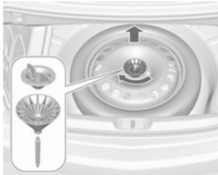
5. Insérer et tourner le cône excentrique dans le creux de la roue de secours de manière à ce que la roue soit positionnée autant que
