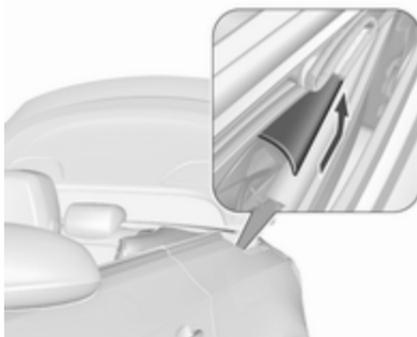
8. Déposer les couvercles en plastique des deux côtés en les poussant et en les faisant coulisser vers l'arrière, voir l'illustration.
