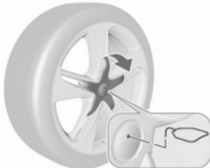
Roues en alliage léger avec capuchon d'écrou central : Dégager le capuchon central en insérant et en tirant l'extracteur ↪ 224 dans le creux de l'emblème de la marque.
