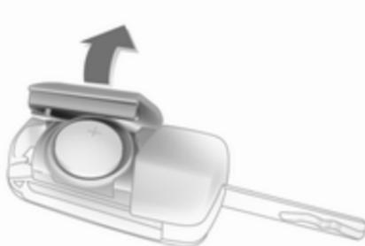
Sortir la clé et ouvrir l'unité latéralement. Remplacer la pile (type CR 2032) en faisant attention à la position de montage. Fermer l'unité et la programmer.
