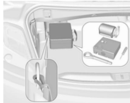
Sur une autre version, un sac contenant le kit de réparation des pneus est fixé à l'anneau d'arrimage arrière gauche du coffre.
