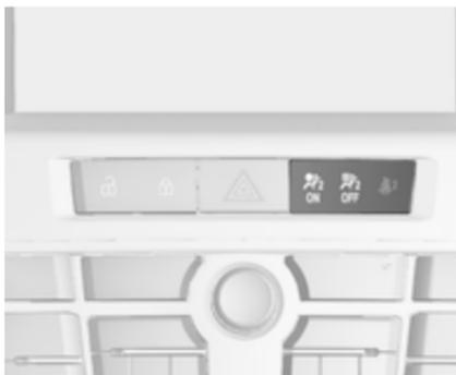
Si le témoin
