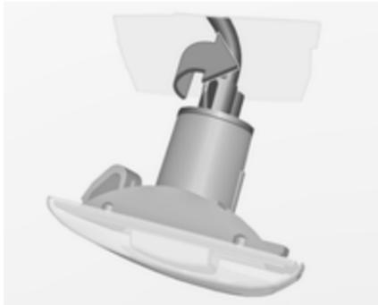
2. Tourner la douille d'ampoule dans le sens anti-horaire et la déposer du logement.
