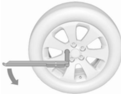
2. Placer la clé de roue en s'assurant qu'elle soit bien positionnée et desserrer chaque écrou de roue d'un demi-tour.
