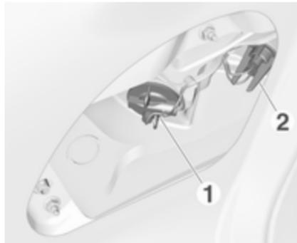
Déposer la douille d'ampoule en la tournant dans le sens antihoraire.
