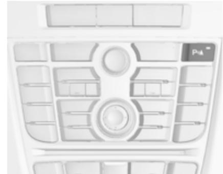
L'aide au stationnement avant-arrière est dotée du bouton **P**
