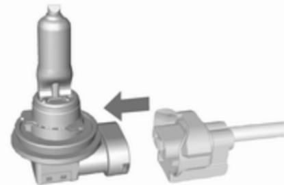
2. Dégager la douille d'ampoule du connecteur en enfonçant la patte de retenue.
