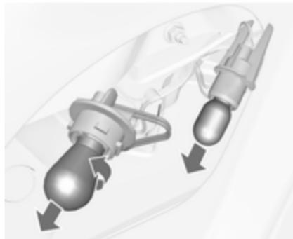
3. Déposer et remplacer l'ampoule
