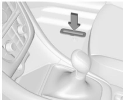
Le numéro d'identification du véhicule peut être frappé sur la plaque d'identification et sur le plancher, sous le tapis de sol, abrité par un cache.
