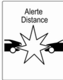
Si un véhicule directement devant est approché trop rapidement, un carillon d'avertissement retentit et une alarme est affichée sur le centre d'informations du conducteur.
