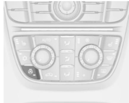
Activer le chauffage en appuyant sur
