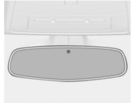
L'éblouissement dû aux véhicules suivants est automatiquement réduit lors des déplacements de nuit.
