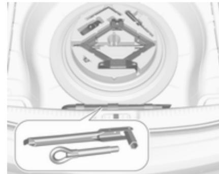
Sous la roue de secours se trouvent une boîte et un sac contenant les outils du véhicule. Le sac à outils est fixé avec une sangle à la tige d'arrimage. Déposer la boîte à outils et la sangle du sac à outils de la tige d'arrimage afin de pouvoir avoir accès aux outils du sac. Outillage de bord ⇨ 224.
