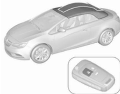
Appuyer et maintenir enfoncé
