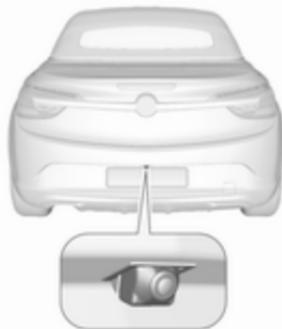
La caméra est montée entre les lampes d'éclairage de la plaque d'immatriculation et a un angle de vision de 130°.
