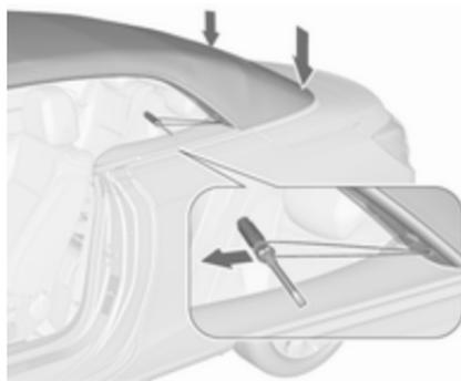
18. Enfoncer fermement chaque côté de l'arceau de tension. Tirer simultanément vers l'avant la corde avec un tournevis passé dans la boucle, lentement et de manière continue. Trouver éventuellement vous-même un appui sur l'encadrement de porte avec l'autre main. Exécuter ceci des deux côtés afin de verrouiller le toit souple à l'arrière.
