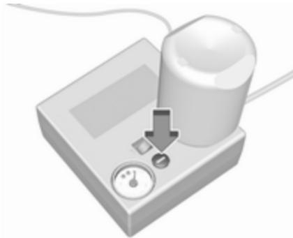
Si la pression de pneu prescrite n'est pas atteinte dans les 10 minutes, démonter le kit de réparation de pneus. Avancer ou reculer le véhicule d'un tour de roue. Brancher à nouveau le kit de réparation de pneus et poursuivre la procédure de remplissage pen-
