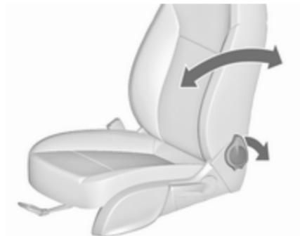
Tourner le levier vers l'arrière, régler l'inclinaison et relâcher le levier. Laisser le siège s'encliqueter de manière audible.
