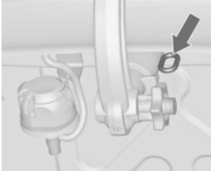
Attacher le câble de rupture d'attelage à l'œillet.
