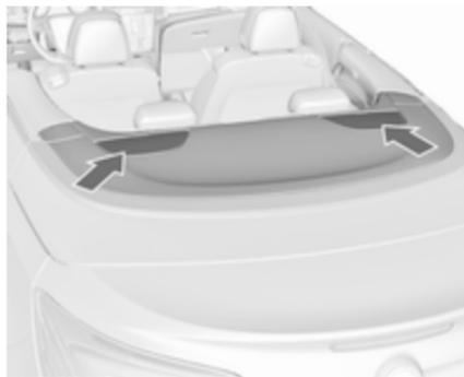
En cas de tonneau, de collision frontale ou de collision latérale, les arceaux de sécurité se déploient automatiquement en quelques millisecon-
