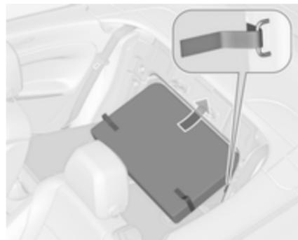
Rabattre les dossiers des sièges arrière. Aligner le couvercle rigide du sac sur le coffre. Mettre en place le sac de bas en haut sur le guide latéral situé dans le renforcement du cadre supérieur. Fixer le sac avec la fixation
