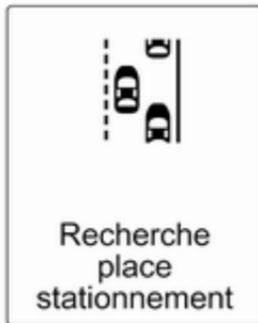
Quand le véhicule passe le long d'une rangée de voitures et que le système est activé, le système avancé d'assistance au stationnement commence à rechercher un emplacement de stationnement adéquat. Lorsqu'un emplacement adéquat est trouvé,
