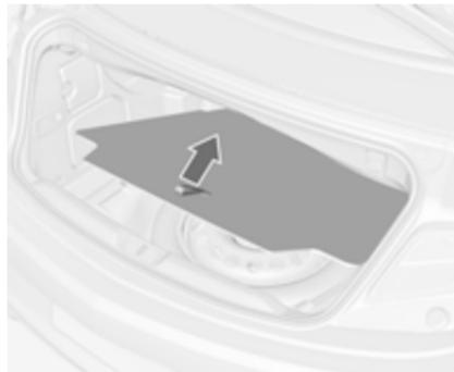
2. Déposer le recouvrement de plancher.
