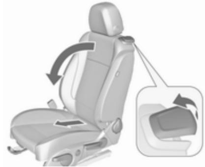
Soulever le levier de débrayage et replier le dossier vers l'avant, puis faire glisser le siège vers l'avant jusqu'à la butée.
