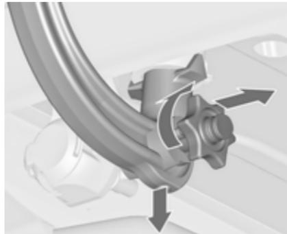
Ouvrir le volet de protection et tourner la clé en position
