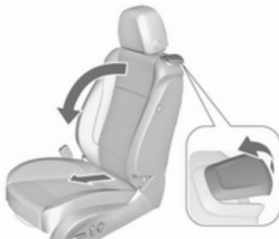
Soulever la poignée de déverrouillage et replier le dossier vers l'avant. Le siège glisse automatiquement vers l'avant jusqu'à la butée.
