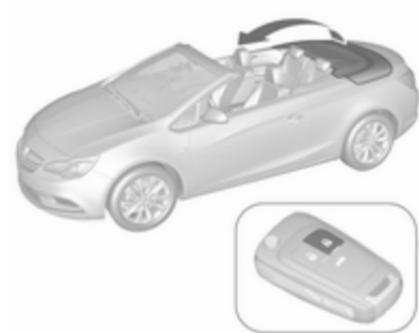
Appuyer et maintenir enfoncé
