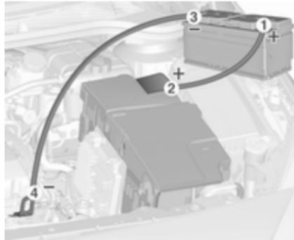
Séquence de raccordement des câbles :
