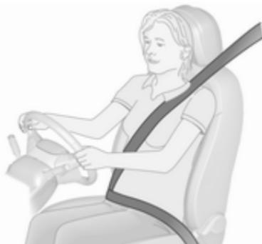
Tirer la ceinture de sécurité et l'enclencher dans la serrure de ceinture. La ceinture de sécurité ne doit pas être vrillée et doit être placée près du corps. Le dossier ne doit pas être incliné trop en arrière (environ 25° maximum).
