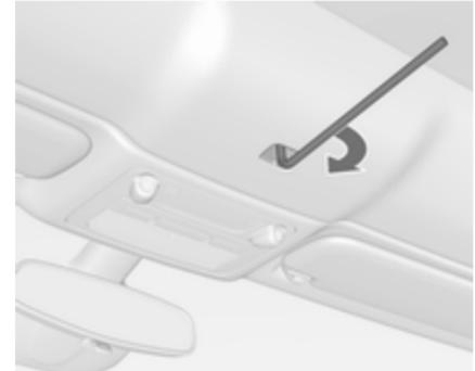
15. Insérer la clé Allen de 6 mm dans le panneau de fermeture et verrouiller l'attache en tournant la clé Allen dans le sens horaire jusqu'à la butée.
