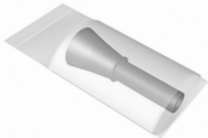
L'entonnoir est situé dans le coffre. Placer l'entonnoir en ligne droite par rapport au goulot de remplissage et pousser légèrement pour l'insérer. Utiliser l'entonnoir pour remplir le goulot de remplissage de carburant diesel.
