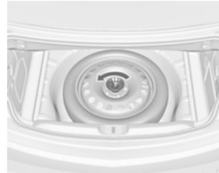
3. La roue de secours est fixée par un écrou papillon dans la niche. Dévisser l'écrou, retirer le cône et sortir la roue de secours.
