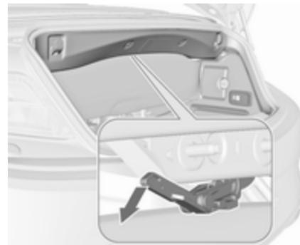
3. À l'intérieur du bord supérieur du bord du coffre figure un levier de déverrouillage du couvercle du toit souple. Repérer le levier et le déverrouiller en le basculant vers le bas.
