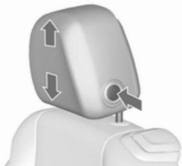
Appuyer sur le bouton de déverrouillage, régler la hauteur, verrouiller.
