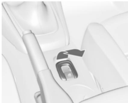
Maintenir la traction sur le commutateur jusqu'à ce que le toit souple soit complètement ouvert et que le couvercle du toit souple soit fermé. Toutes les vitres seront ouvertes pendant cette opération.
