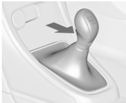
Marche arrière : le véhicule étant à l'arrêt, enfoncer la pédale d'embrayage, enfoncer le bouton de déverrouillage du levier sélecteur et engager le rapport.
