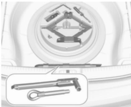
Ouvrir le recouvrement de plancher du coffre. Le cric, les outils et une sangle de fixation pour roue endommagée se trouvent dans la boîte à outils, sous la roue de secours dans le coffre.
