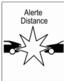
Lorsque la distance avec un véhicule en mouvement à l'avant est trop petite ou lorsque vous approchez trop rapidement d'un autre véhicule et qu'une collision est imminente, le symbole d'alerte de collision s'affiche dans le centre d'informations du conducteur.
