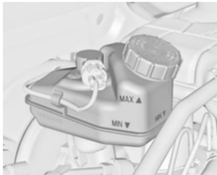
Le niveau de liquide de frein doit se situer entre les repères **MIN** et **MAX**. Si le niveau de liquide est en dessous de la valeur **MIN**, contacter un atelier. Liquide de frein/ d'embrayage ⇨ 250.
