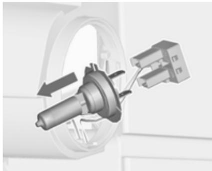
3. Désengager l'ampoule du connecteur en tirant.
