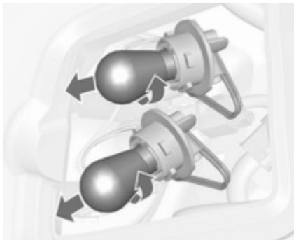
4. Déposer et remplacer l'ampoule.
