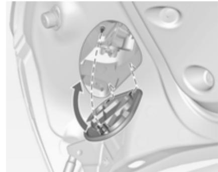
5. Fermer le couvercle en commençant par insérer les agrafes de fixation. Verrouiller le couvercle en tournant la vis dans le sens horaire à l'aide d'une pièce de monnaie.
