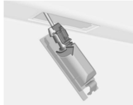
3. Déposer la douille d'ampoule du logement de feu en la tournant dans le sens anti-horaire.
