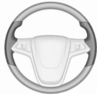
Les zones mises en relief pour tenir le volant sont chauffées plus rapidement et à une température plus élevée que le reste du volant.
