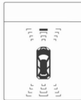
La distance vers l'obstacle avant et arrière est indiquée par des lignes de distance qui se modifient autour du véhicule.
