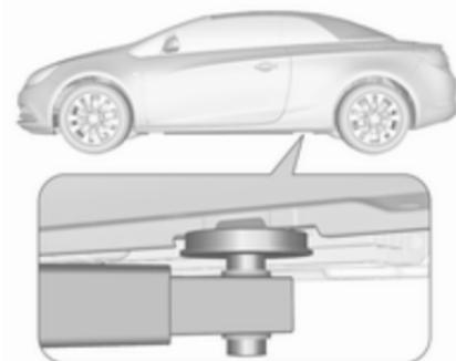
Position du bras arrière du pont élévateur centrée sous le creux du seuil.
