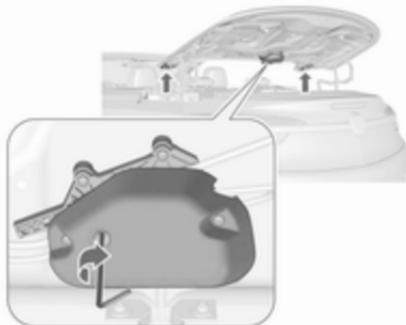
6. Insérer la clé Allen de 4 mm dans la position marquée sur l'unité d'entraînement de rabat. Tourner complètement la clé Allen dans le sens horaire jusqu'à la butée, de manière à ce que les rabats latéraux pivotent vers l'intérieur.
