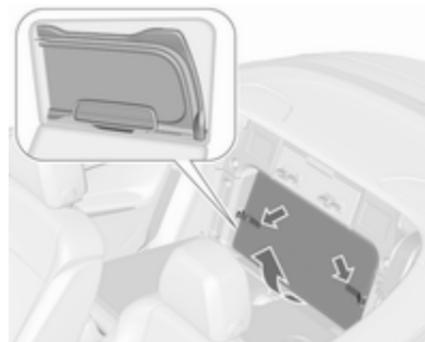
Deux déflecteurs d'air se trouvent dans un sac derrière les dossiers des sièges arrière. Rabattre les dossiers des sièges arrière ↻ 74, ouvrir les fixations Velcro et sortir le sac du renforcement.
