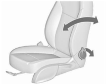
Tourner le levier vers l'arrière, régler l'inclinaison et relâcher le levier. Laisser le dossier s'encliqueter de manière audible.
