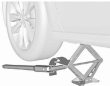
Attacher la clé de roue, aligner correctement le cric et tourner la clé jusqu'à ce que la roue ait quitté le sol.
