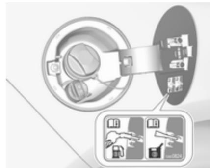
L'inhibiteur de carburant garantit que la trappe du goulot de remplissage de carburant ne peut être ouverte qu'au moyen d'une buse pour carburant diesel ou d'un entonnoir pour appoint d'urgence.
