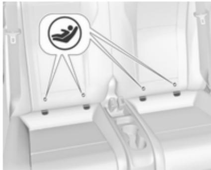
Déposer le déflecteur d'air ↻ 42 avant de monter un système de sécurité pour enfant et déposer au besoin l'appui-tête arrière ↻ 67.
