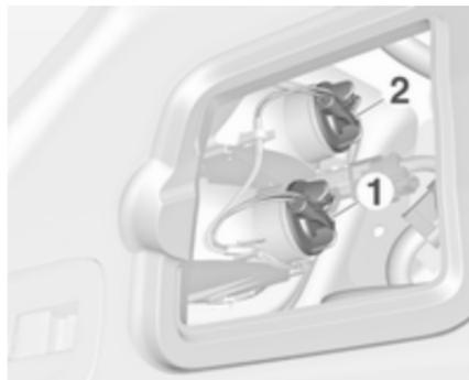
3. Déposer la douille d'ampoule en la tournant dans le sens antihoraire.
