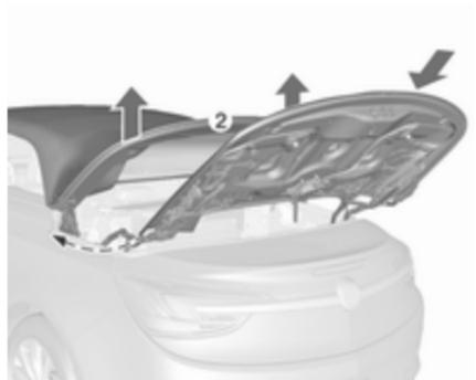
16. Soulever les deux côtés de l'arceau de tension (2) du toit souple. Relever lentement le couvercle du toit souple à mi-course environ puis le laisser glisser en position fermée.
