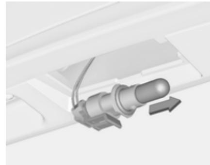
4. Tirer l'ampoule de la douille d'ampoule et la remplacer.
