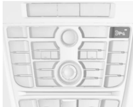
Lors de la recherche d'un emplacement de stationnement, le système est préparé à fonctionner en appuyant sur
