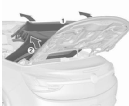
12. Tirer le toit souple en soulevant l'arceau avant (1) et en même temps l'arceau de tension (2) des deux côtés.
