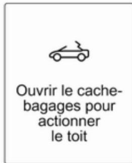
Si l'une de ces exigences n'est pas respectée, un signal sonore retentit et un message s'affiche sur le centre d'informations du conducteur (DIC) lorsque le commutateur est actionné et le toit souple ne s'ouvrira ou ne se fermera pas.
