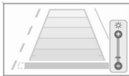
**Navi 650/Navi 950** : La luminosité peut être réglée en appuyant d'abord sur la bague extérieure du bouton multifonction, puis en la tournant.
