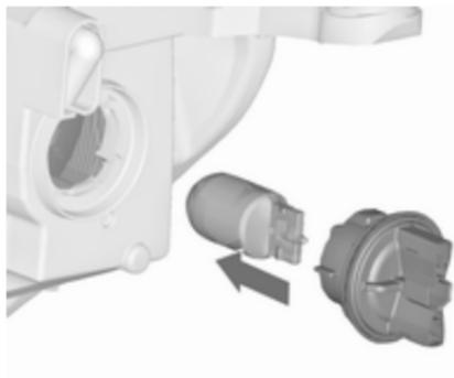
2. Retirer l'ampoule de la douille en tirant.
