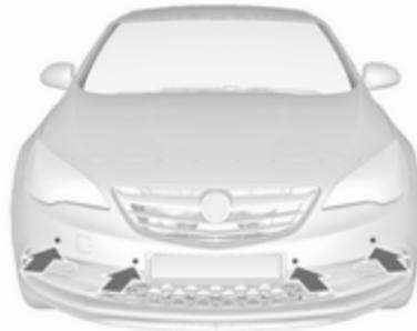
Quatre capteurs de stationnement à ultrasons sont présents dans chaque pare-chocs avant et arrière.
