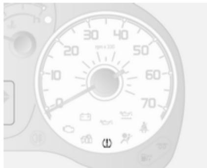
La détection d'un problème de basse pression de pneu est indiquée par l'illumination du témoin (⚠) ⇨ 81 accompagnée par un signal sonore. Dans les véhicules équipés de la version multifonction du centre d'informations du conducteur, un message correspondant est également affiché.
