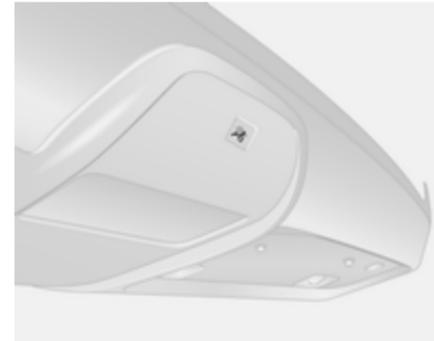
Les airbags du siège de passager avant sont désactivés et ne se déploieront pas en cas de collision. Le témoin
