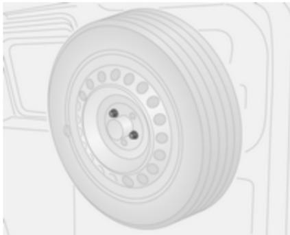
1. Dévisser les deux vis à l'aide de la clé de roue et enlever la roue de secours de son support. Outillage de bord ↻ 151.
