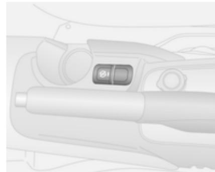
Désactiver le système d'arrêt-démarrage manuellement en enfonçant le bouton
