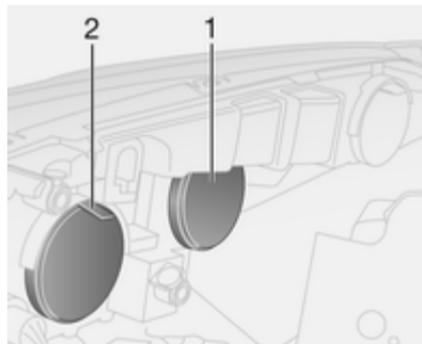
Les phares disposent de systèmes séparés pour les feux de croisement/ de position **1** (ampoule extérieure), feux de route / de jour **2** (ampoule intérieure).
