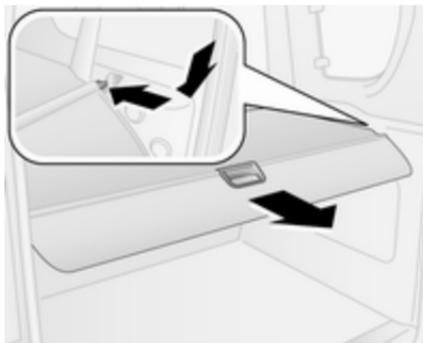
Tirer le cache-bagages par la poignée vers l'arrière et l'accrocher dans les logements latéraux.
