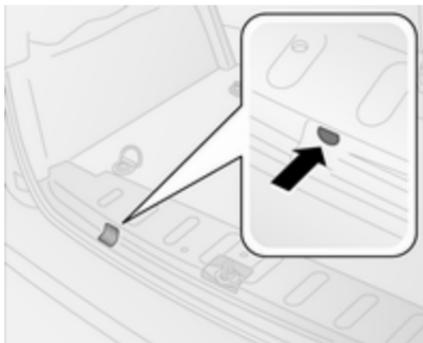
2. Introduire la clé de roue dans l'ouverture dans le plancher du coffre.
