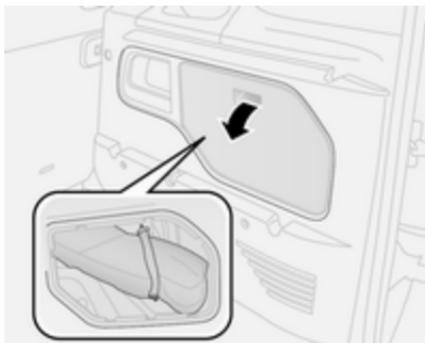
Les outils et l'équipement de levage par cric du véhicule sont rangés dans le coffre, derrière un panneau sur le côté droit.
