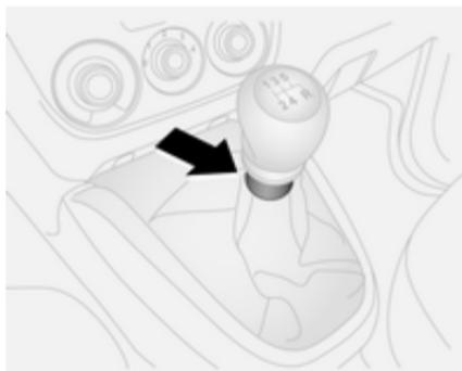
Pour engager la marche arrière, lorsque le véhicule est à l'arrêt, soulever la bague du levier sélecteur 3 secondes après avoir enfoncé la pédale d'embrayage et engager le rapport.
