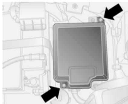
La boîte à fusibles se trouve à droite du compartiment moteur, à côté de la batterie.
