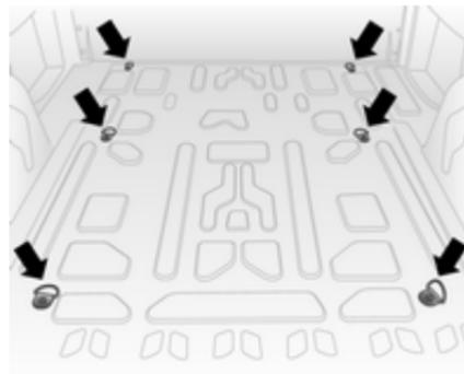
Les anneaux d'arrimage servent à sécuriser les objets pour éviter qu'ils ne glissent, par exemple avec des sangles de serrage ou un filet à bagages.
