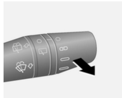
Tirer brièvement sur la manette : du liquide de lave-glace est pulvérisé sur le pare-brise et l'essuie-glace effectue quelques balayages.
