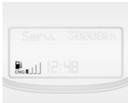
En mode de fonctionnement au gaz naturel, les quatre barres verticales situées à côté de **CNG** correspondent au niveau de méthane dans les cylindres. À mesure que le niveau de carburant diminue, les barres de la jauge à carburant GNV disparaissent.
