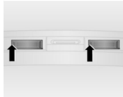
1. Insérer un tournevis comme indiqué par les flèches, appuyer sur le côté et dégager le boîtier d'ampoule.
