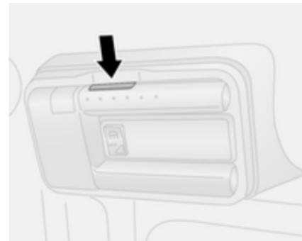
En fonction de la version du modèle, la lampe de courtoisie arrière amovible peut s'allumer lorsque les portes arrière / le hayon ou les portes latérales coulissantes sont ouverts et le commutateur central en position médiane.
