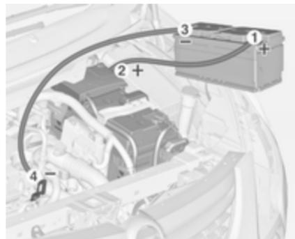
Séquence de raccordement des câbles :
