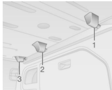
Pour l'enlever, lever la partie avant de la plage arrière en la dégageant des dispositifs de retenue avant (1) des deux côtés.
