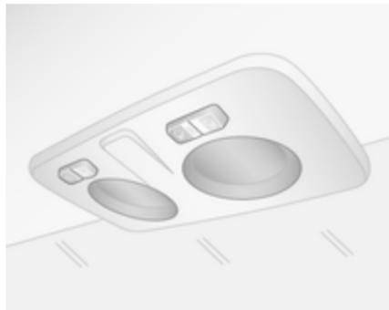
Position centrale du commutateur : éclairage automatique de l'habitacle. Peut être commandé individuellement ou conjointement avec le commutateur
