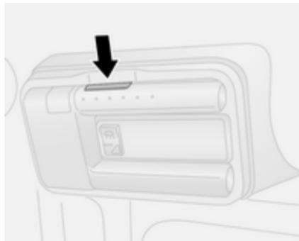
1. Appuyer sur le bouton au dessus de l'ensemble de lampe pour le dégager.
