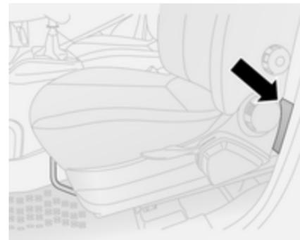
L'outillage et l'équipement de levage du véhicule se trouvent dans le compartiment de rangement derrière le siège avant. Tirer la poignée avant et faire glisser le siège vers l'avant pour accéder ↻ 34.
