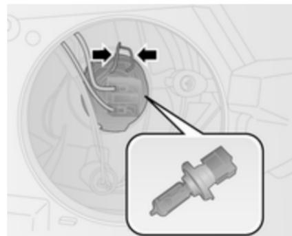
4. Introduire la nouvelle ampoule dans le réflecteur de sorte que l'ergot de positionnement de l'ampoule soit aligné avec le logement du réflecteur.
