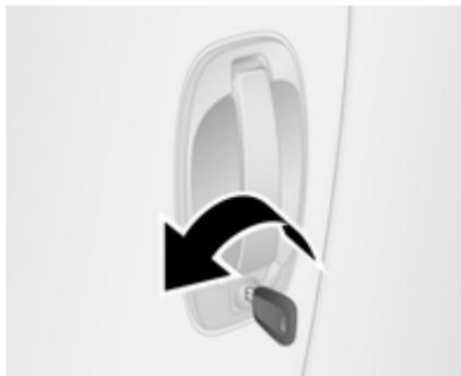
Tourner la clé vers l'avant du véhicule dans la serrure de la porte du conducteur.
