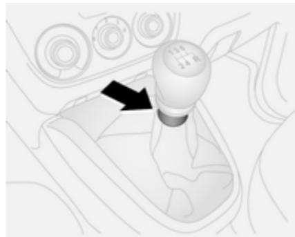
Marche arrière : lorsque le véhicule est à l'arrêt, soulever la bague du levier sélecteur 3 secondes après avoir enfoncé la pédale d'embrayage et engager le rapport.
