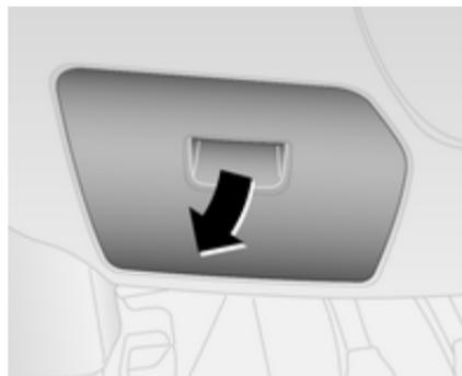
La boîte à fusibles se trouve derrière un couvercle sur la partie inférieure du tableau de bord, du côté du conducteur.
