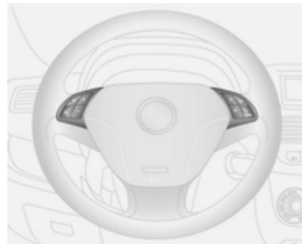
L'Infotainment System et un téléphone mobile connecté peuvent être commandés à partir du volant.
