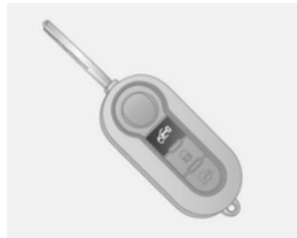
Appuyer sur le bouton
