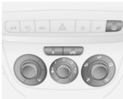
Régler la commande de température sur le niveau le plus chaud.
