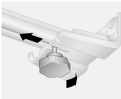
1. D'un côté du véhicule, tourner la poignée sous la première barre (située sous le support) pour la desserrer, puis faire coulisser cette poignée vers l'intérieur, vers le centre du véhicule.
