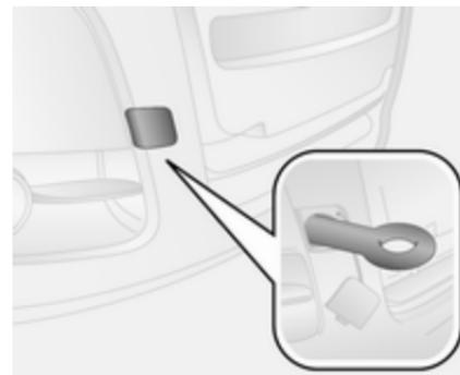
Libérer le cache en le soulevant avec précaution à l'aide d'un tournevis. Pour éviter tout dégât, il est recommandé de placer un chiffon entre le tournevis et le cadre.
