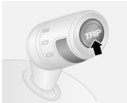
Les fonctions suivantes peuvent être sélectionnées en appuyant plusieurs fois sur le bouton **TRIP** à l'extrémité du levier d'essuie-glace :
