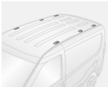
Pour fixer une galerie de toit, insérer les boulons de montage dans les orifices indiqués sur l'illustration.
