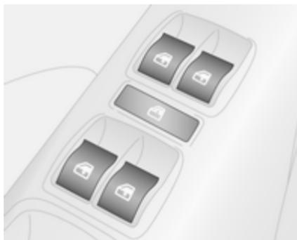
Appuyer sur le bouton
