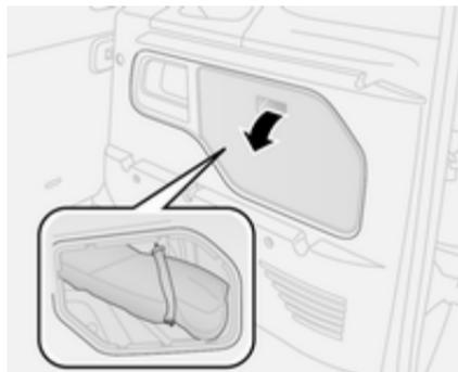
1. Sortir le kit de réparation des pneus du véhicule.
