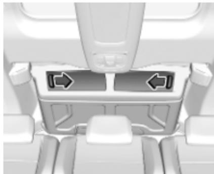
Le caisson de toit est accessible depuis les sièges arrière. Pour l'ouverture, faire glisser les volets.
