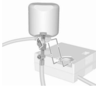
4. Visser le flexible d'air du compresseur sur le raccord de la pompe de produit d'étanchéité.
