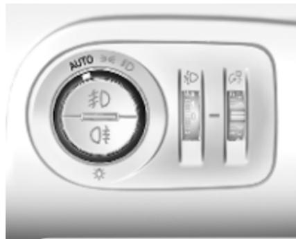
Quand la fonction de commande automatique des feux est activée et que le moteur tourne, le système bascule automatiquement entre les feux de jour et les phares, en fonction
