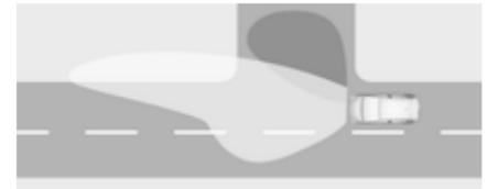
Activé à une vitesse jusqu'à 40 km/h lors de la mise hors tension. Selon l'angle de braquage ou l'activation des feux de direction, les phares anti-brouillard avant éclairent la trajectoire.
