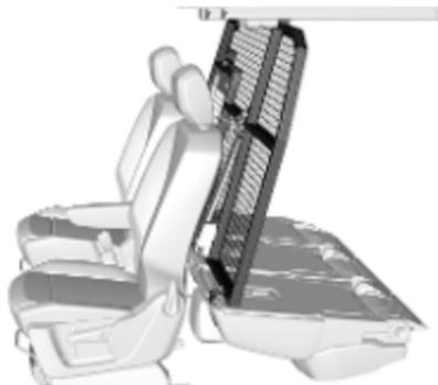
La partition peut être placée derrière les sièges avant ou arrière.
