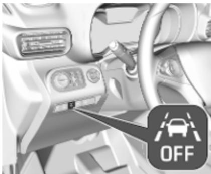
Si le système est activé, la LED intégrée au bouton
