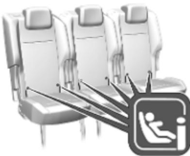
Fixer les systèmes de sécurité pour enfant ISOFIX homologués pour le véhicule aux étriers de fixation ISOFIX. Les supports de montage se trouvent sous le symbole i-size de la housse de siège. Les positions des systèmes de sécurité pour enfant
