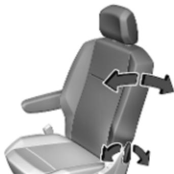
Appuyer sur le levier, régler l'inclinaison et relâcher le levier. Ne pas s'appuyer sur le dossier pendant le réglage.
