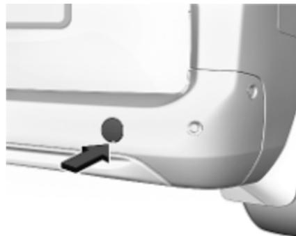
Envelopper d'un linge l'extrémité d'un tournevis plat, par exemple, pour ne pas endommager la peinture. Insérer le tournevis dans la fente sur la partie basse du capuchon. Relâcher prudemment le capuchon.
