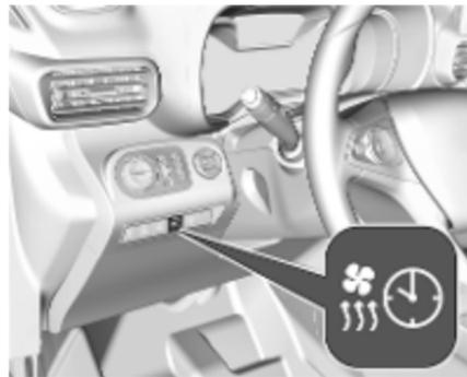
Le statut de fonctionnement du chauffage de stationnement est signalé par un bouton avec DEL.
