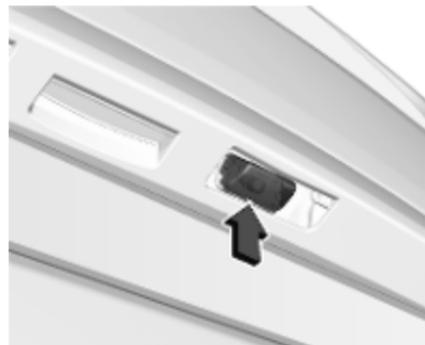
1. Insérer un tournevis, par exemple, dans l'évidement du couvercle et le retirer.
