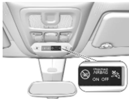
Si le témoin
