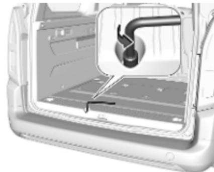
2. Placer la clé de roue sur un boulon hexagonal. Tourner dans le sens antihoraire jusqu'à ce que le support de roue de secours soit suffisamment abaissé pour permettre le décrochage du crochet.
