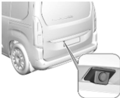
La caméra est montée dans le hayon ou la porte arrière gauche.
