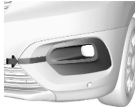
1. Envelopper d'un linge l'extrémité d'un tournevis plat pour ne pas endommager la peinture. Insérer le tournevis dans le renforcement sur le bord du couvercle. Libérer le couvercle en faisant doucement levier dessus.
