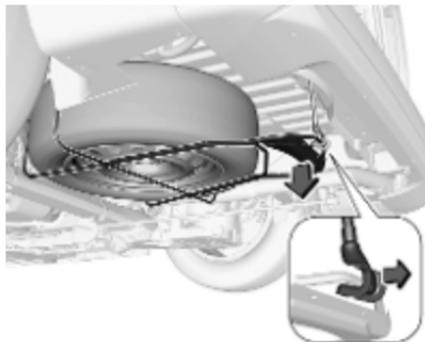
3. Lever le support de roue de secours et décrocher l'attache.
