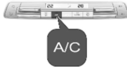
Appuyer sur **A/C** pour mettre le refroidissement en marche. Le refroidissement ne fonctionne que lorsque le moteur est en marche et que le ventilateur de commande de climatisation est en fonction.
