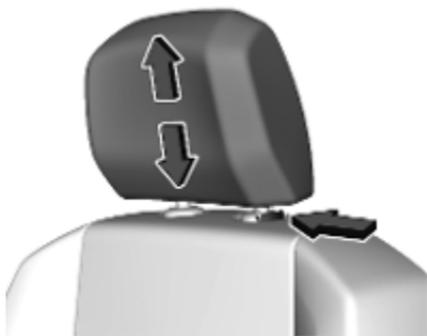
Lever l'appui-tête ou appuyer sur le loquet et le pousser vers le bas.
