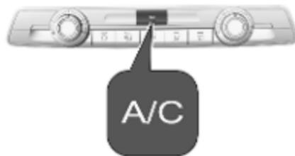
Appuyer sur **A/C** pour mettre le refroidissement en marche. L'activation est signalée par l'allumage de la diode du bouton. Le refroidissement ne fonctionne que lorsque le moteur est en marche et que la soufflerie est allumée.
