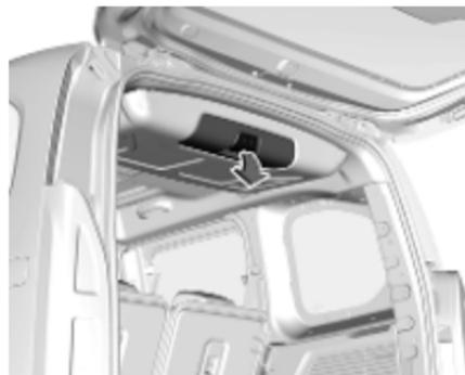
Le caisson de toit est accessible depuis le coffre. Tirer sur la poignée pour ouvrir le caisson du toit.
