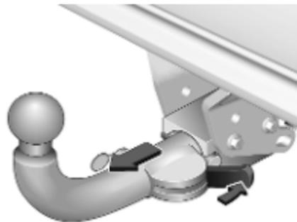
4. Déplacer le levier de la barre d'attelage à la position arrière. Retirer la barre d'attelage en tirant.
