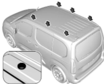
Pour fixer une galerie de toit, dévisser les chapeaux logés dans les bandes de toit. Insérer les prédispositions de montage, comme indiqué, dans la pièce de retenue.
