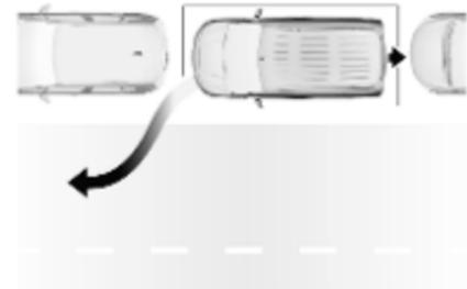
Se déplacer d'avant en arrière tout en observant les avertissements de l'aide au stationnement jusqu'à ce que la fin de la manœuvre soit indiquée. La manœuvre est terminée lorsque les roues avant du véhicule sont hors de l'emplacement de stationnement.
