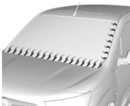
Cette fonction réchauffe le pare-brise ainsi que sa partie inférieure et le long du côté conducteur du pare-brise.
