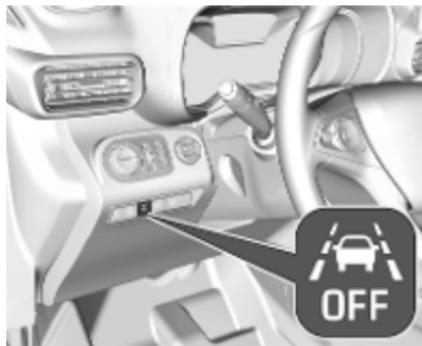
Si le système est activé, la LED intégrée au bouton
