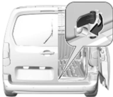
Dans des cas exceptionnels uniquement, il est possible de conduire avec la porte arrière droite ouverte, c'est-à-dire si de longs objets doivent être transportés. Ouvrir la porte arrière gauche puis la porte arrière droite, puis fermer et verrouiller la porte arrière gauche.
