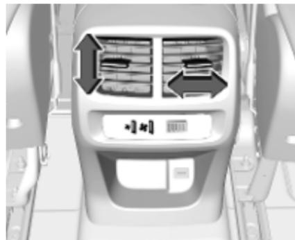
Régler la direction du flux d'air en faisant basculer et pivoter les lamelles.
