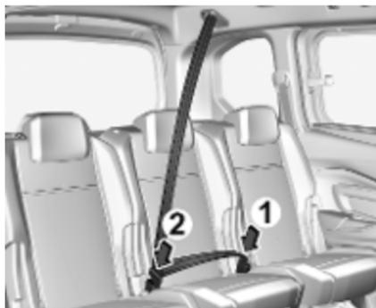
Insérer la plaque de verrouillage inférieure dans la boucle du côté gauche (1) au siège central. Guider le verrou plat supérieur avec la ceinture par-dessus la zone de genou et l'épaule (sans vriller) et l'insérer dans la serrure droite (2) du siège central.
