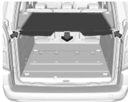
Tirer sur le cache-bagages vers l'arrière et l'engager dans les supports latéraux.
