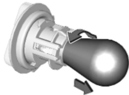
2. Enfoncer légèrement l'ampoule, la faire tourner dans le sens antihoraire et la retirer de la douille.
