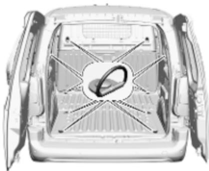
Les anneaux d'arrimage peuvent être situés sur le plancher du véhicule et / ou dans la cloison. Le nombre et l'emplacement des anneaux d'arrimage peuvent varier en fonction du véhicule.
