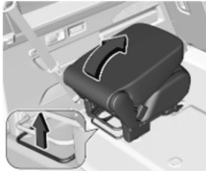
3. Tirer sur la poignée et incliner le siège entier vers l'avant.
