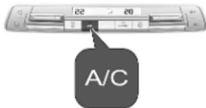
Appuyer sur **A/C** pour mettre le refroidissement en marche. Le refroidissement ne fonctionne que lorsque le moteur est en marche et que la soufflerie de la climatisation est allumée.
