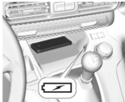
L'appareil portable à charger doit être compatible avec la norme Qi, soit pour conception, soit en utilisant un socle compatible. La zone de chargement est identifiée par le symbole Qi.
