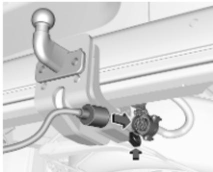
1. Connecter la prise de remorque à la douille et fixer le câble d'arrêt de rupture à l'œillet sur le support.
