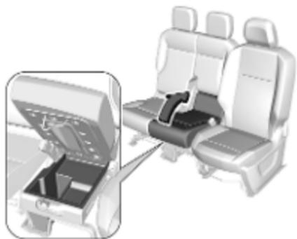
Il peut exister un casier de rangement sous le siège banquette centrale. Lever l'assise de siège en tirant sur la poignée. Le casier de rangement peut être verrouillé par un cadenas.
