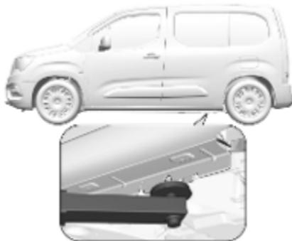
La position de bras arrière de la plateforme de levage est centrale sous le point concerné de levage du véhicule.
