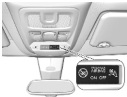
Si le témoin
