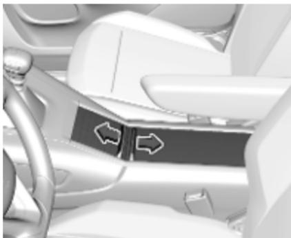
Un casier de rangement peut se trouver dans la console centrale. Appuyer sur le couvercle pour l'ouvrir.
