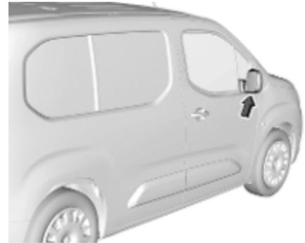
La caméra est montée au bas du rétroviseur extérieur côté passager.
