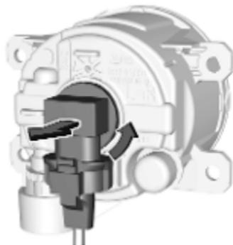
3. Tourner la douille d'ampoule dans le sens antihoraire et l'enlever du bloc optique.
