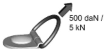
La force appliquée maximale sur les anneaux d'arrimage ne doit pas dépasser 500 daN/5 kN/5 000 N.
