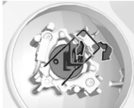
2. Désengager l'agrafe à ressort de la pièce de retenue en la déplaçant vers le côté droit. Faire pivoter l'agrafe à ressort vers le bas. Retirer la douille de l'ampoule du boîtier du réflecteur.
