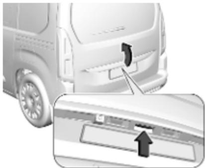
Après le déverrouillage, appuyer sur le bouton du milieu du hayon et ouvrir le hayon.
