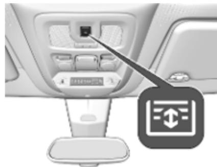
Appuyer doucement sur
