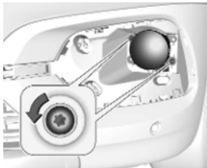
2. Dévisser et retirer les deux vis. Retirer l'ensemble de lampe de l'avant.
