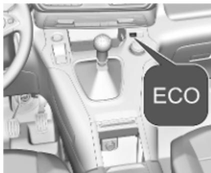
Ce mode ajuste les réglages des systèmes pour favoriser l'économie de carburant, c'est-à-dire en optimisant les points de changement de rapport de la boîte automatique et en adaptant la sensibilité de la pédale d'accélérateur.
