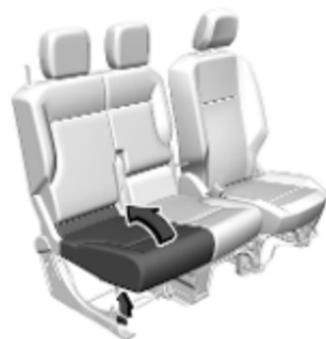
Pour lever l'assise de siège, tirer sur le levier et lever l'assise de siège contre le dossier jusqu'au verrouillage.
