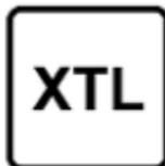
Carburant diesel paraffiné respectant la norme EN15940 mélangé à un biocarburant respectant la norme EN14214 (avec possiblement jusqu'à 7 % d'ester méthylique d'acide gras).
