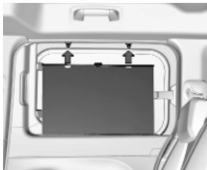
Pour réduire l'exposition au soleil de la deuxième rangée de sièges, relever le store en utilisant la poignée et l'encliqueter sur le haut du cadre de porte.
