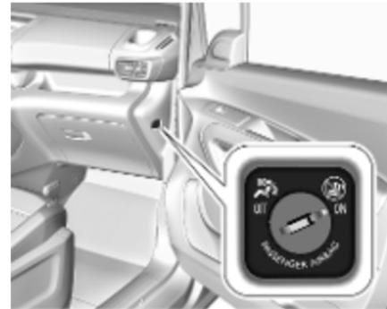
Le système d'airbag de passager avant peut être désactivé via un commutateur à clé situé sur le côté passager de la planche de bord.
