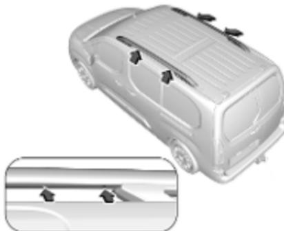
Les points de fixation sont situés sur la partie inférieure des rails de toit.
