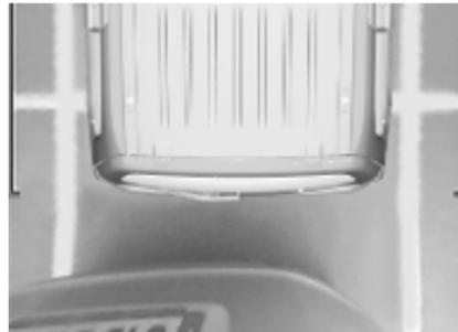
La caméra enregistre les environs du véhicule pendant la manœuvre pour reconstruire une vue depuis le haut de l'arrière du véhicule dans son environnement proche, permettant au véhicule d'être manœuvré autour des obstacles proches. Cette vue est disponible avec **Mode AUTO** activé ou dans le menu de sélection de vue.
