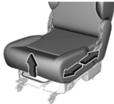
Tirer sur la poignée, faire glisser le siège puis relâcher la poignée. Essayer de déplacer le siège d'avant en arrière pour s'assurer qu'il est bien verrouillé en place.
