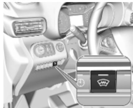
Le chauffage est commandé en appuyant sur
