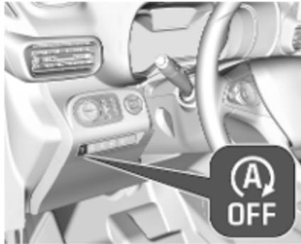
Pour désactiver le système Stop/Start manuellement, appuyer sur
