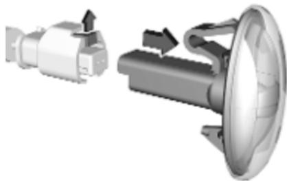
2. Pousser la patte restante vers le haut et retirer la douille d'ampoule du connecteur de prise.
