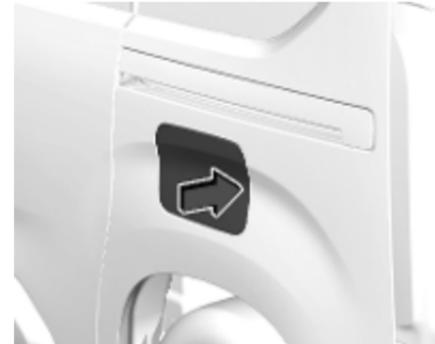
Si le véhicule est équipé d'un système de clé électronique, la trappe à carburant peut uniquement être ouverte si le véhicule est déverrouillé. Selon la version, relâcher la trappe à carburant en appuyant sur le volet ou en tirant dans le coin inférieur droit.
