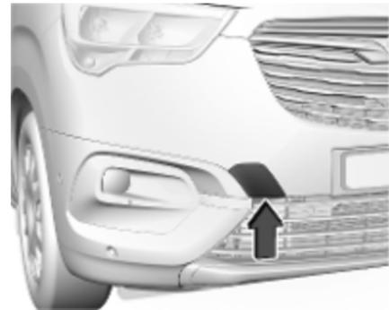
Envelopper d'un linge l'extrémité d'un tournevis plat, par exemple, pour ne pas endommager la peinture. Insérer le tournevis dans la fente sur la partie basse du capuchon. Relâcher prudemment le capuchon.
