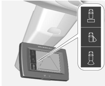
Sélectionner la vue arrière standard ou la vue latérale côté passager en appuyant sur
