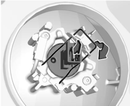
2. Désengager l'agrafe à ressort de la pièce de retenue en la déplaçant vers le côté droit. Faire pivoter l'agrafe à ressort vers le bas. Retirer la douille de l'ampoule du boîtier de réflecteur.
