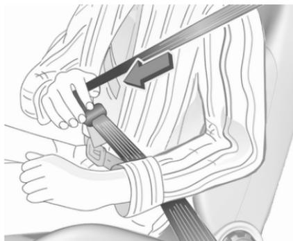
Tirer la ceinture hors de l'enrouleur, la guider sur le corps sans la vriller et insérer le verrou plat dans la serrure. S'assurer que la sangle est bien serrée sur le corps pendant la conduite.
