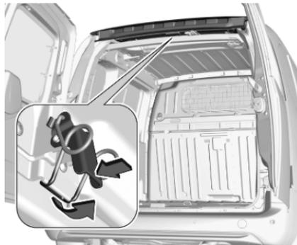
1. Appuyer sur le levier et dégager l'agrafe à ressort de la pièce de retenue en tirant.
