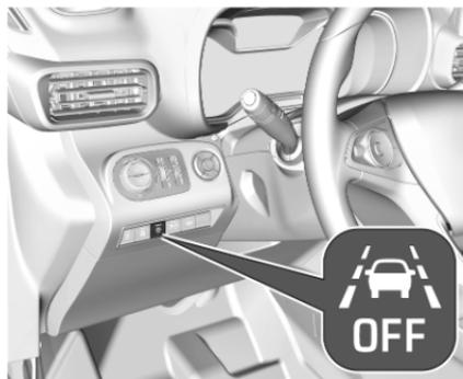
Si le système est activé, la LED intégrée au bouton
