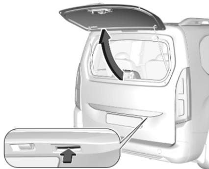
Appuyer sur le bouton du côté droit du hayon et ouvrir la vitre arrière.
