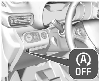
Pour désactiver le système Stop/Start manuellement, appuyer sur
