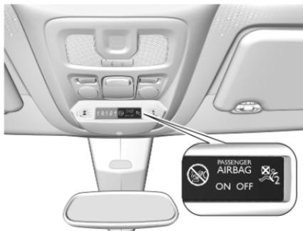
Si le témoin
