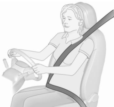
Tirer la ceinture de sécurité et l'attacher dans la boucle de ceinture de sécurité. La ceinture de sécurité ne doit pas être vrillée et doit être placée près du corps. Le dossier ne doit pas être incliné trop en arrière (environ 25° maximum).
