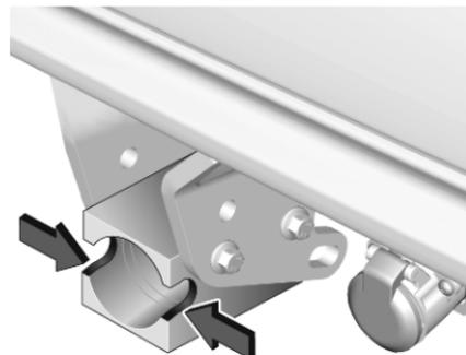
2. Nettoyer les points de contact au moyen des linges propres et souples.
