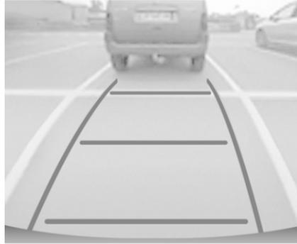
La zone derrière le véhicule est affichée à l'écran. Les lignes verticales représentent la largeur du véhicule avec les rétroviseurs dépliés. La direction des lignes change avec la position du volant de direction.
