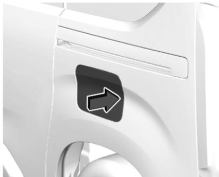
Si le véhicule est équipé d'un système de clé électronique, la trappe à carburant peut uniquement être ouverte si le véhicule est déverrouillé. Selon la version, relâcher la trappe à carburant en appuyant sur le volet ou en tirant dans le coin inférieur droit.
