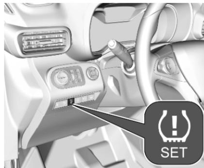
3. Initialiser le système de détection de dégonflage : Si le véhicule possède un affichage graphique des informations, appuyer sur
