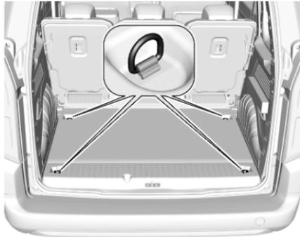
Les anneaux d'arrimage servent à sécuriser les objets pour éviter qu'ils ne glissent, par exemple avec des sangles de serrage ou le filet à bagages.
