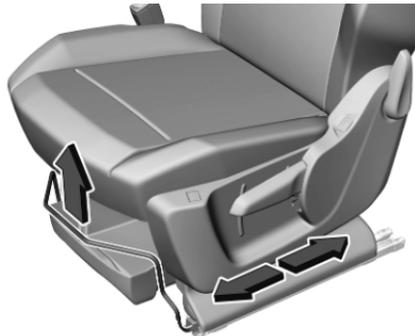
Tirer sur la poignée, faire glisser le siège puis relâcher la poignée. Essayer de déplacer le siège vers l'arrière et l'avant pour s'assurer que le siège est verrouillé en place.
