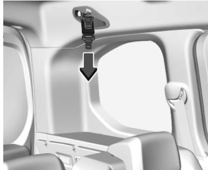
Tirer les verrous plats avec la ceinture de sécurité hors du support de ceinture sécurité du toit.
