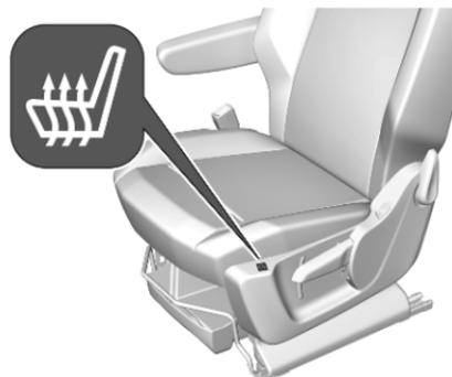
Activer le chauffage du siège en appuyant sur
