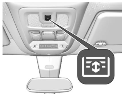
Appuyer doucement sur
