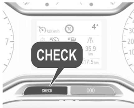
Pour récupérer l'état de l'information d'entretien à un moment quelconque, appuyer sur le bouton **CHECK**. Selon la version, appuyer sur **Check** (vérifier) dans le menu des réglages du véhicule. L'information d'entretien s'affiche pendant quelques secondes.
