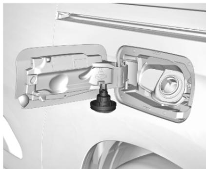
Le bouchon de remplissage de carburant peut être fixé au crochet sur la trappe à carburant.
