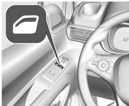
Manœuvrer le commutateur de la vitre concernée en l'appuyant pour l'ouvrir ou en le relevant pour la fermer.
