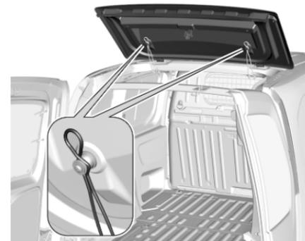
3. Dépasser le point de résistance pour verrouiller la trappe d'échelle au moyen des fixations.
