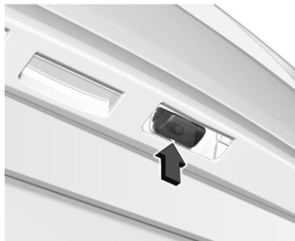
1. Insérer un tournevis, dans l'évidement du couvercle et le retirer.
