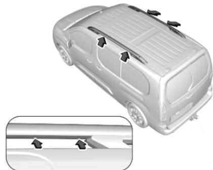
Les points de fixation sont situés sur la partie inférieure des rails de toit.
