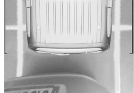
La caméra enregistre les environs du véhicule pendant la manœuvre pour reconstruire une vue depuis le haut de l'arrière du véhicule dans son environnement proche, permettant au véhicule d'être manœuvré autour des obstacles proches. Cette vue est disponible avec **Mode AUTO** activé ou dans le menu de sélection de vue.
