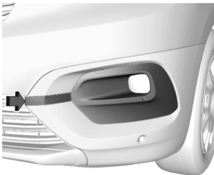
1. Envelopper d'un linge l'extrémité d'un tournevis plat pour ne pas endommager la peinture. Insérer le tournevis dans le renforcement sur le bord du couvercle. Libérer le couvercle en faisant doucement lever dessus.
