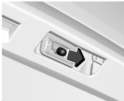
2. Extraire l'ampoule de la douille et la remplacer.
