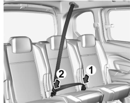
Insérer la plaque de verrouillage inférieure dans la boucle du côté gauche (1) au siège central. Guider le verrou plat supérieur avec la ceinture de sécurité par-dessus la zone de genou et l'épaule (sans vriller) et l'insérer dans la serrure droite (2) du siège central.
