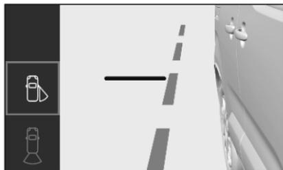
La ligne représente une distance d'environ 4 m derrière le bord du pare-chocs arrière du véhicule.
