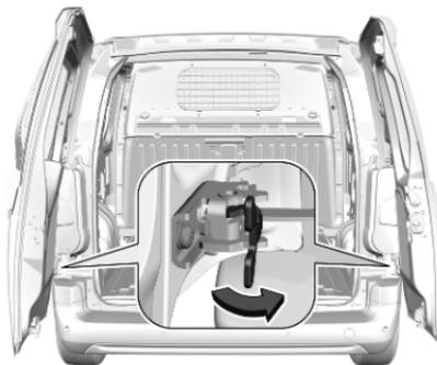
Les portes sont maintenues dans une position à 90°, grâce à des limiteurs d'ouverture. Pour ouvrir les portes à 180°, pousser le loquet et pivoter la porte à la position désirée. Avant de fermer les portes, s'assurer que les étais de verrouillage sont placés à 90°.
