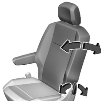
Appuyer sur le levier et régler l'inclinaison. Ne pas s'appuyer sur le dossier pendant le réglage.
