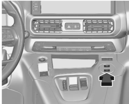
Les ports USB peuvent être utilisés pour charger des appareils externes. Selon la version, un port USB peut être utilisé pour échanger des données.
