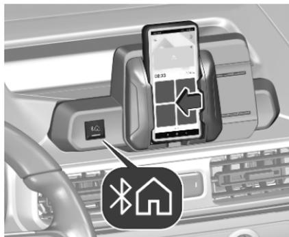
Tirer le support coulissant vers la droite, insérer l'appareil mobile dans le support et le fixer avec le support coulissant.
