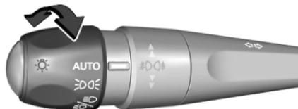
Quand la fonction de commande automatique des feux est activée, le système bascule automatiquement entre les feux de jour et les phares, en fonction des conditions d'éclairage extérieur et des informations communiquées par le système d'essuie-glaces.
