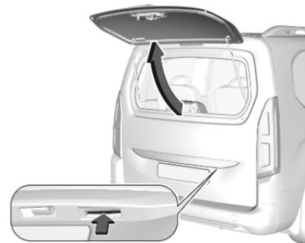
Appuyer sur le bouton du côté droit du hayon et ouvrir la vitre arrière.
