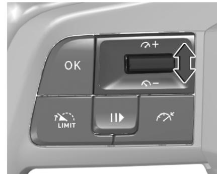
Si le système est actif, la vitesse présélectionnée peut être modifiée en déplaçant la molette sur pour augmenter la vitesse ou sur pour la réduire. Déplacer la molette à plusieurs reprises pour modifier la vitesse par petits incréments ; déplacer et maintenir pour modifier la vitesse par grands incréments.
