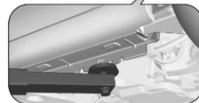
La position de bras arrière de la plateforme de levage est centrale sous le point concerné de levage du véhicule.
