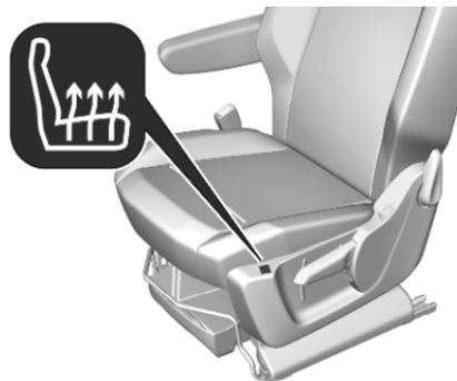
Activer le chauffage du siège en appuyant sur
