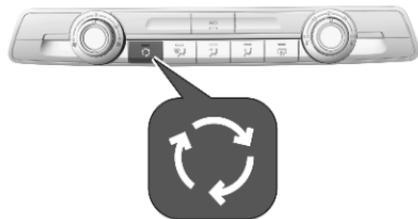
Appuyer sur ↻ pour activer le mode de recyclage de l'air. L'activation est signalée par l'éclairage de la LED dans le bouton.
