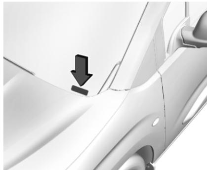
Le numéro d'identification du véhicule peut être estampé sur le tableau de bord, il est alors visible à travers le pare-brise.
