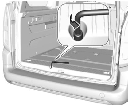
2. Placer la clé de roue sur un boulon hexagonal. Tourner dans le sens antihoraire jusqu'à ce que le support de roue de secours soit
