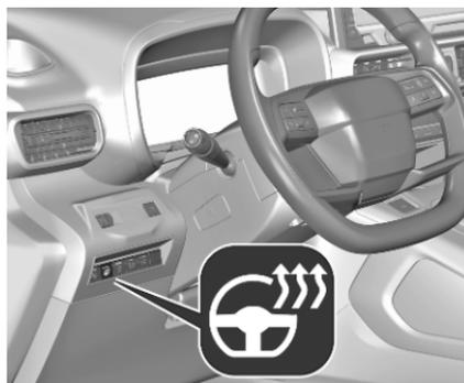
Activer le chauffage en appuyant sur
