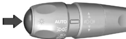
La caméra arrière est activée lorsque le véhicule se déplace en marche avant et que la vue arrière est sélectionnée à l'écran de vue arrière ou en appuyant sur le bouton du levier.
