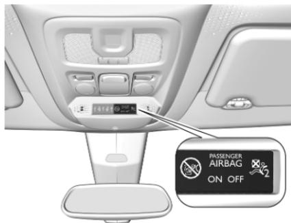
Si le témoin
