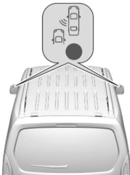
Lorsque le système détecte un véhicule dans la zone aveugle en roulant en avant, une diode s'allume dans le rétroviseur concerné.
