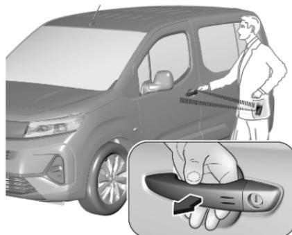
La clé électronique doit se trouver à l'extérieur du véhicule dans un rayon d'environ un mètre du côté de la porte concernée.
