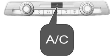
Appuyer sur **A/C** pour mettre le refroidissement en marche. L'activation est signalée par l'éclairage de la LED dans le bouton. Le refroidissement ne fonctionne que lorsque le moteur est en marche et que la soufflerie est allumée.
