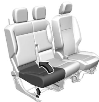
Pour lever l'assise de siège, tirer sur le levier et lever l'assise de siège contre le dossier jusqu'au verrouillage.
