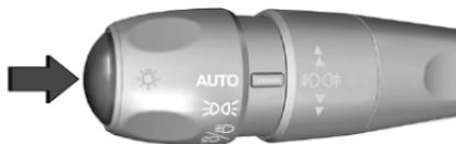
La caméra est activée lorsque le véhicule se déplace en marche avant et que la vue du côté passager est sélectionnée sur l'écran de vue arrière ou en appuyant sur le bouton du levier.
