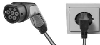
La batterie haute tension du véhicule peut être chargée sur une prise électrique domestique. Brancher le câble
