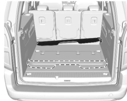
Si le cache-bagages n'est pas utilisé, le ranger dans le coffre. Il peut être arrimé derrière les sièges de seconde ou de troisième rangée.
