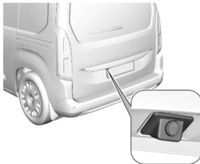
La caméra est montée dans le pare-chocs arrière au-dessus de la plaque d'immatriculation.
