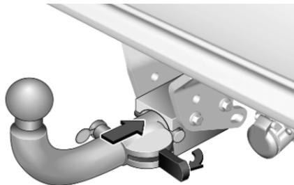
3. Insérer la barre d'attelage dans l'ouverture et pousser fermement jusqu'à la butée.
