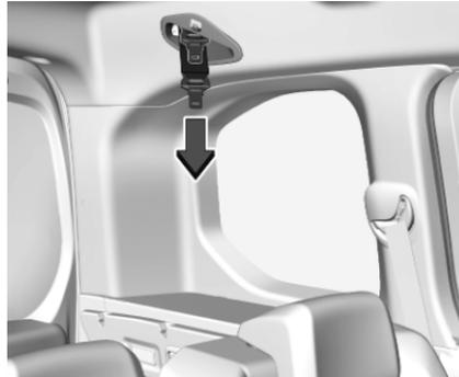
Tirer les plaques de verrouillage avec la ceinture de sécurité hors du support de ceinture sécurité du toit.
