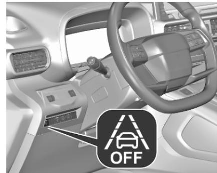
Si le système est activé, la LED du bouton
