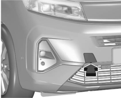
Envelopper d'un linge l'extrémité d'un tournevis plat pour ne pas endommager la peinture. Insérer le tournevis dans la fente sur la partie basse du capuchon. Relâcher prudemment le capuchon.
