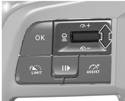
La vitesse mémorisée peut être modifiée en déplaçant la molette sur  $\curvearrowright+$  pour augmenter la vitesse ou sur  $\curvearrowright-$  pour la réduire. Déplacer la molette à plusieurs reprises pour modifier la vitesse par petits incréments ; déplacer et maintenir pour modifier la vitesse par grands incréments.
