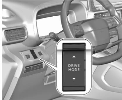
La commande de suspension sélective permet de choisir entre cinq modes de conduite au moyen de l'interrupteur à bascule :
