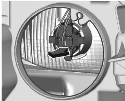
2. Retirer la douille de l'ampoule du boîtier de réflecteur.
