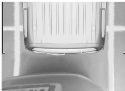
La caméra enregistre les environs du véhicule pendant la manœuvre pour reconstruire une vue depuis le haut du véhicule dans son environnement proche. Le véhicule peut alors être manœuvré autour des obstacles proches.
