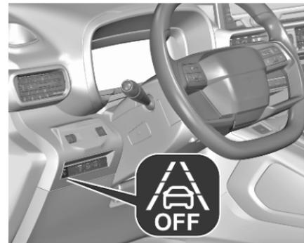
Si le système est activé, la LED intégrée au bouton
