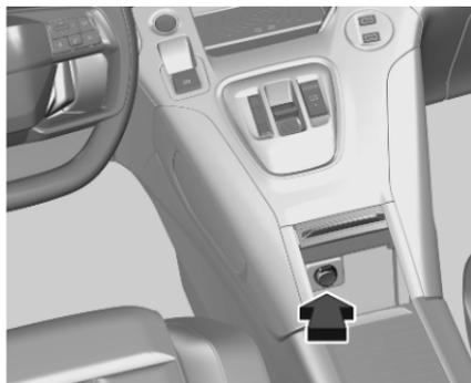
Une prise de courant 12 V se trouve derrière le couvercle de rangement. Pousser le couvercle vers le haut pour l'ouvrir.
