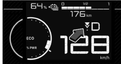
Trois niveaux de freinage peuvent être sélectionnés. Le niveau de freinage respectif est indiqué par trois triangles dans le centre d'informations du conducteur.
