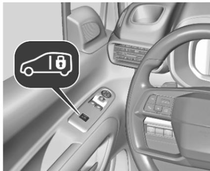
Pour activer, mettre le contact et appuyer sur
