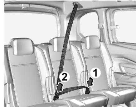
Insérer la plaque de verrouillage inférieure dans la boucle gauche (1) du siège central. Guider la plaque de verrouillage supérieure avec la ceinture de sécurité par-dessus l'abdomen et l'épaule (sans vriller la sangle) et l'insérer dans la boucle droite (2) du siège central.
