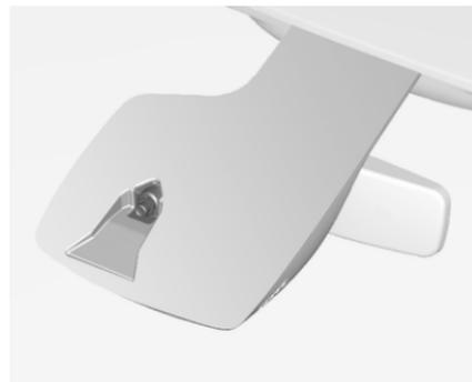
Ne pas placer d'autocollants tels que route à péage ou autres sur le pare-brise, dans la zone du rétroviseur intérieur. Le champ du capteur de pluie doit rester propre, c'est-à-dire sans poussière, saletés, ni givre. Sinon, la zone de détection du détecteur de pluie / capteur de luminosité et la zone de vision de la caméra dans le boîtier du rétroviseur peuvent être restreintes.
