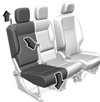
Rabattre le dossier extérieur en tirant sur la boucle. Faire basculer le dossier vers l'avant jusqu'à l'abaissement du siège au plancher.
