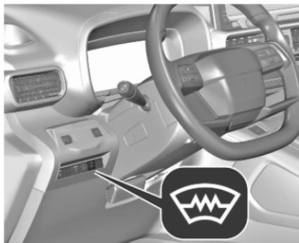
Le chauffage est commandé en appuyant sur ☀️. La DEL du bouton s'allume.
