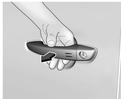
Passer la main derrière la poignée de porte de l'une des portes avant ou arrière pour déverrouiller le véhicule ou appuyer sur le bouton du milieu du hayon.
