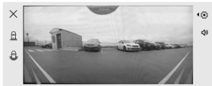
La vue à 180° facilite le recul hors d'un emplacement de stationnement, rendant possible d'observer l'approche des véhicules, des piétons et des cyclistes. Cette vue n'est pas recommandée pour une manœuvre complète. Cette vue est disponible uniquement depuis le menu de sélection de vue.
