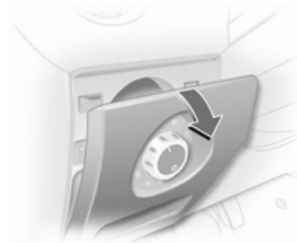
La boîte à fusibles se trouve derrière le commutateur d'éclairage. Tirer sur le bord supérieur du panneau et le rabattre.
