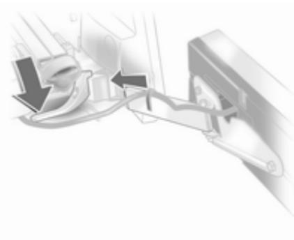
Abaisser le levier de blocage et pousser le support d'ampoules dans le dispositif de retenue jusqu'à ce qu'il touche la butée.
