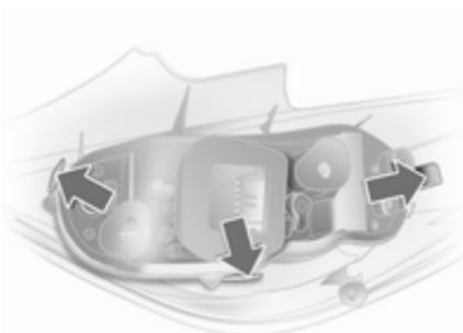
5. Appuyer légèrement sur les trois pattes de verrouillage sur l'extérieur de la douille de l'ampoule et enlever la douille de l'ampoule.
