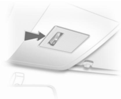
1. Désencliqueter la lentille et l'enlever par l'endroit marqué sur l'illustration en utilisant un tournevis.
