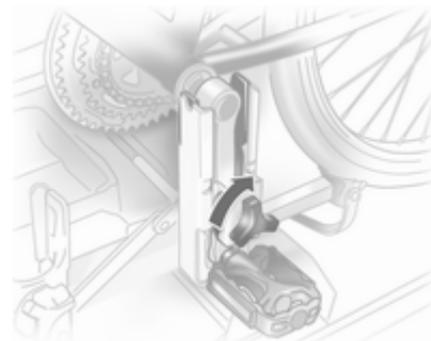
Bloquer la manivelle de pédale en tournant la vis de blocage sur la fixation de pédalier.
