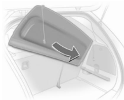
Soulever le cache-bagages vers l'arrière jusqu'à ce qu'il se déverrouille, l'incliner puis l'enlever.
