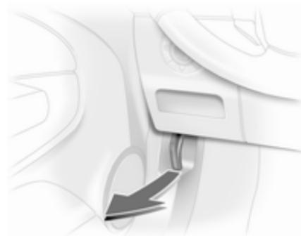
Tirer le levier de déverrouillage et le ramener dans sa position de départ.
