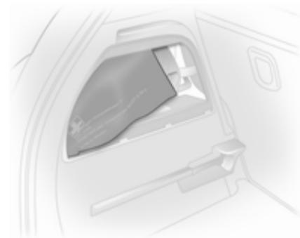
Ranger la boîte (trousse) de secours dans le compartiment de la paroi gauche du coffre.
