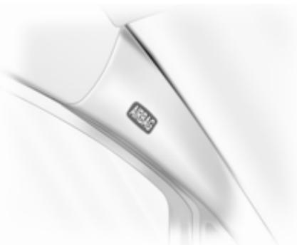
Le système d'airbags rideaux se compose d'un airbag de cadre de toit, de chaque côté du véhicule. Ceci est reconnaissable à l'inscription **AIRBAG** sur les montants de toit.
