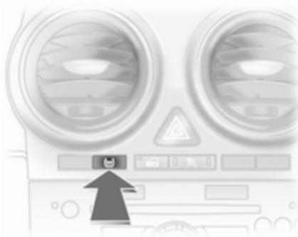
Après une correction de la pression de gonflage ou un changement de roue, il faut initialiser le système : mettre le contact, enfoncer et maintenir le bouton **DDS** pendant 4 secondes environ, le témoin
