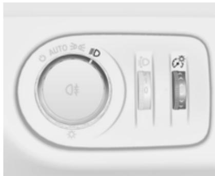
Luminosité réglable lorsque l'éclairage extérieur est allumé :
