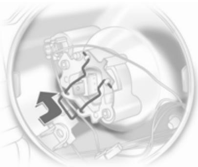
3. Désencliqueter la languette-ressort de l'attache en la déplaçant et la pivotant sur le côté.
