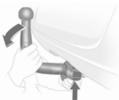
Insérer la barre d'attelage serrée dans le logement et pousser fermement vers le haut jusqu'au déclic audible.
