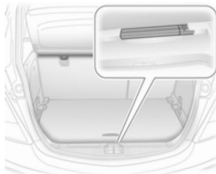
Ranger le triangle de présignalisation dans le coffre arrière : placer d'abord le triangle de présignalisation dans le côté gauche de son logement, puis l'insérer dans le guide à droite.
