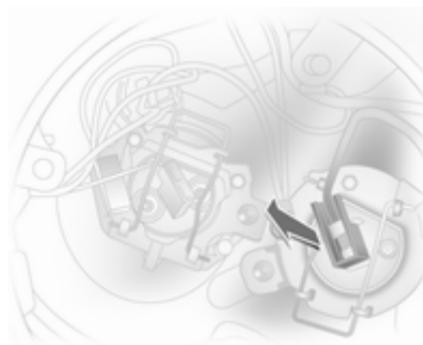
2. Débrancher le connecteur de l'ampoule.
