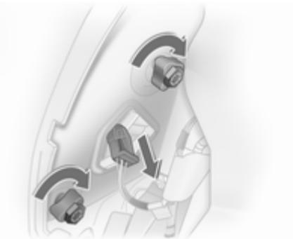
9. Introduire le boîtier de l'ampoule dans la carrosserie, serrer les écrous de fixation à la main. Brancher la fiche. Fermer le cache.
