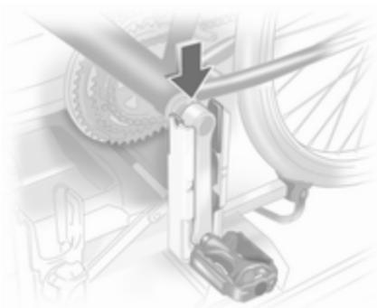
Placer le vélo. La manivelle de pédale devant être placée dans l'ouverture du logement de pédalier, comme montré sur l'illustration.
