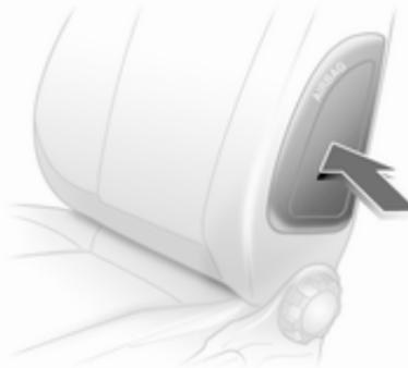
Le système d'airbag latéral se compose d'un airbag dans chacun des dossiers de siège avant et dans les dossiers des sièges arrière extérieurs. Ils sont reconnaissables à l'inscription **AIRBAG**.
