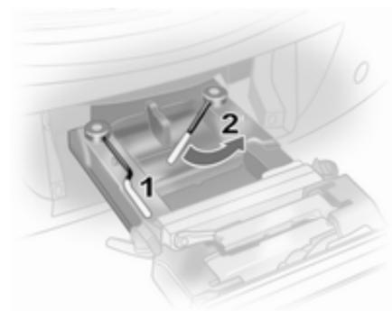
Basculer vers l'arrière le levier de blocage gauche (1) pour commencer, puis le levier de blocage droit (2) jusqu'à ce qu'ils viennent en butée. Les deux leviers de blocage doivent être dirigés vers l'arrière, sinon la sécurité de fonctionnement n'est pas garantie. Fermer le hayon.
