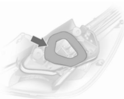
8. S'assurer que le joint de douille de l'ampoule est positionné comme illustré.
