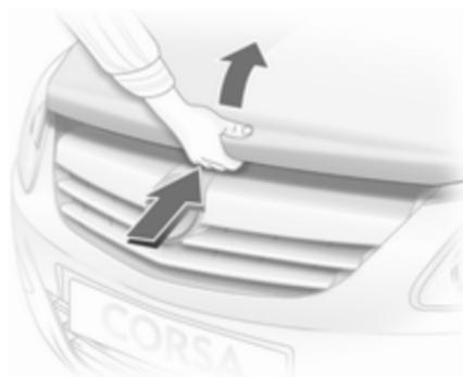
Soulever le verrou de sécurité et ouvrir le capot moteur.
