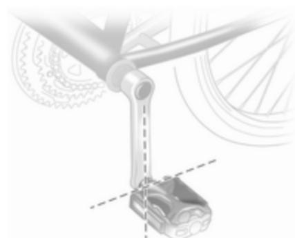
Faire tourner la manivelle de pédale gauche (côté opposé au plateau de chaîne) pour la positionner verticalement vers le bas. La pédale de la manivelle gauche du pédalier doit être à l'horizontale.
