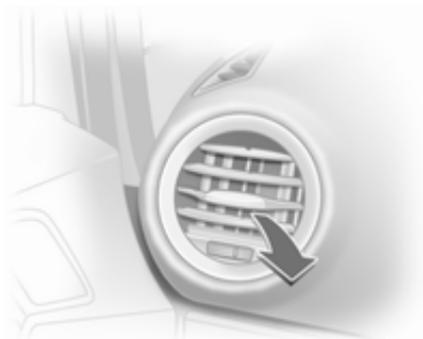
Pour fermer la bouche d'aération, tourner la roue moletée à gauche ou à droite jusqu'en butée.
