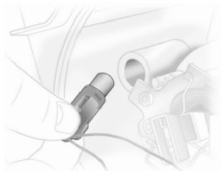
3. Enlever l'ampoule de la douille et remplacer l'ampoule.
