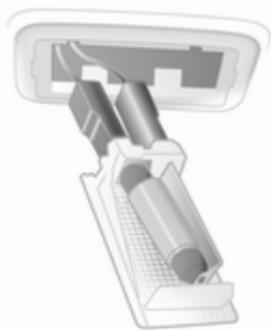
2. Sortir l'ampoule en la poussant légèrement dans la direction de la languette-ressort.
