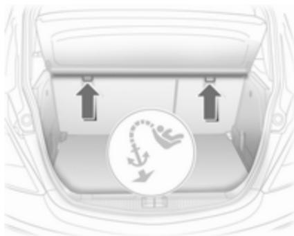
Fixer les systèmes de sécurité pour enfant Top-Tether aux œillets de fixation au dos du siège arrière et au rail du siège passager dans la cave à pieds arrière. La sangle doit alors passer entre les deux tiges de guidage de l'appui-tête.
