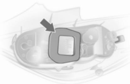
8. S'assurer que le joint de douille de l'ampoule est positionné comme illustré. Poser le joint rond sur la vis de fixation.
