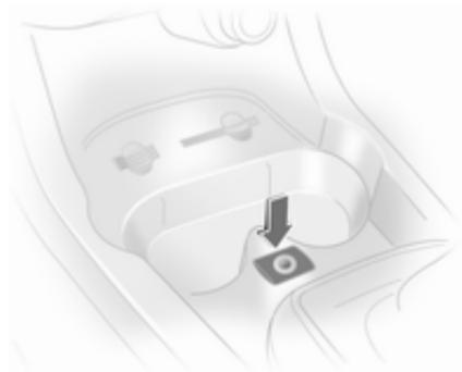
L'entrée AUX permet de brancher une source audio externe, comme un lecteur CD portable par exemple, avec une fiche jack de 3,5 mm.
