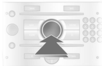
Pour mettre en surbrillance les options de menu ou les commandes et pour sélectionner les fonctions, tourner la commande multifonction.
