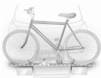
Positionner les logements de roue de sorte que le vélo soit plus ou moins horizontal. La distance entre les pédales et le hayon doit être d'au moins 5 cm.
