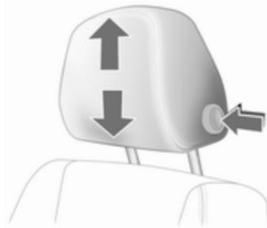
Appuyer sur le bouton, régler la hauteur et encliqueter
