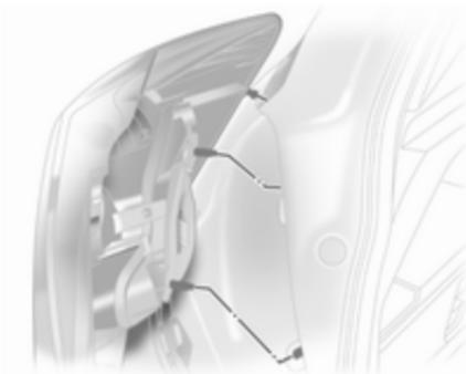
4. Détacher le boîtier de l'ampoule vers l'arrière.
