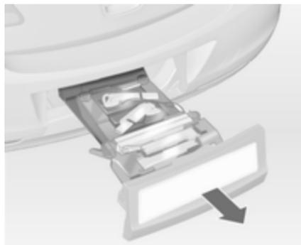
Sortir complètement le système de transport arrière jusqu'à ce qu'il se verrouille.
