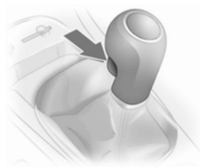
Marche arrière : lorsque le véhicule est à l'arrêt, enfoncer le bouton de déverrouillage du levier sélecteur 3 secondes après avoir enfoncé la pédale d'embrayage et engager la marche arrière.
