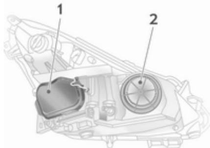
Phares avec systèmes séparés pour les feux de croisement 1 (ampoules extérieures) et les feux de route 2 (ampoules intérieures). Le feu de changement de direction se trouve également derrière le cache de feu de route.
