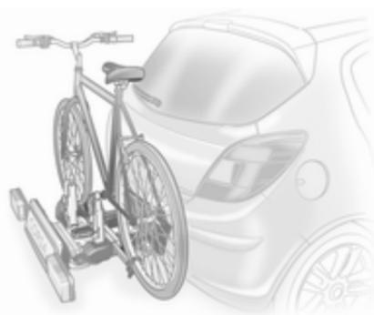
Le système de transport arrière (système Flex-Fix) permet de fixer des vélos au support de transport extractible intégré dans le plancher du véhicule.
