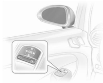
Commencer par sélectionner le rétroviseur extérieur souhaité, puis utiliser la commande pour le régler.
