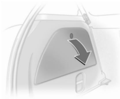
La boîte à fusibles se trouve sur le côté gauche du coffre, derrière un cache. Enlever le cache.
