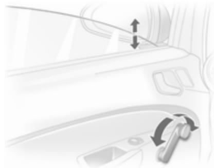
Les vitres peuvent être ouvertes ou fermées au moyen de la manivelle.
