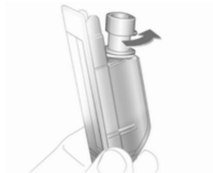
4. Faire tourner la douille de l'ampoule dans le sens antihoraire pour la désencliqueter.
