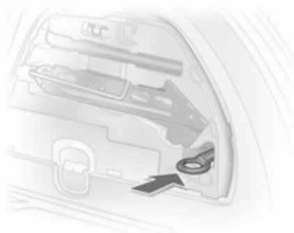
L'œillet de remorquage se trouve dans l'outillage du véhicule ↻ 171. L'œillet de remorquage est rangé dans un logement.
