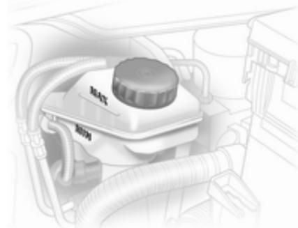
Le niveau de liquide de frein doit se situer entre **MIN** et **MAX**.
