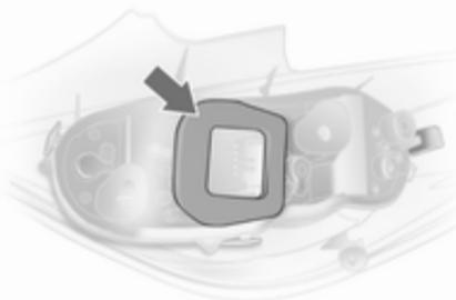
8. S'assurer que le joint de douille de l'ampoule est positionné comme illustré. Poser le joint rond sur la vis de fixation.
