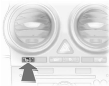
Enclencher le chauffage, en association avec le chauffage de siège, en appuyant sur le bouton
