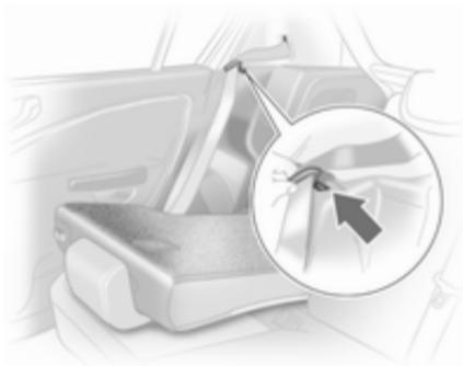
Redresser les dossiers de siège arrière et laisser les mécanismes de verrouillage s'engager de manière audible des deux côtés. Une fois que les dossiers sont verrouillés, le repère rouge ne doit plus dépasser.
