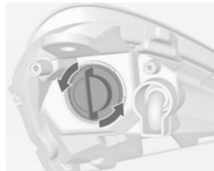
1. Faire tourner la douille de l'ampoule **3** dans le sens antihoraire pour la désencliqueter.
