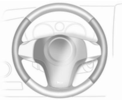
Quand le moteur tourne et pendant Autostop, le volant est chauffé dans les zones représentées sur l'illustration ci-dessus.
