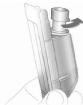
4. Faire tourner la douille de l'ampoule dans le sens antihoraire pour la désencliqueter.
