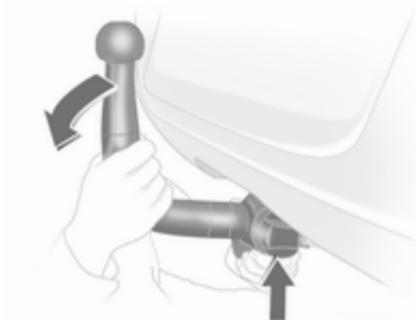
Insérer la barre d'attelage serrée dans le logement et pousser fermement vers le haut jusqu'au déclic audible.
