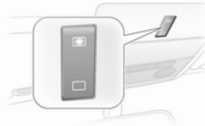
Commande via un commutateur à bascule dans la console de toit.
