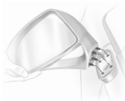
Corsa OPC : afin de protéger les piétons, les rétroviseurs extérieurs de la Corsa OPC sont dégagés de leur support s'ils sont poussés. Placer le boîtier du rétroviseur sur le support en engageant les pattes et en l'encliquetant en frappant légèrement.
