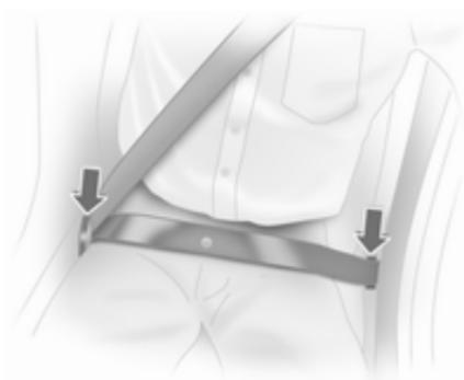
Les ceintures de sécurité des sièges avant sont tendues en cas de collision avant et arrière d'une certaine gravité.
