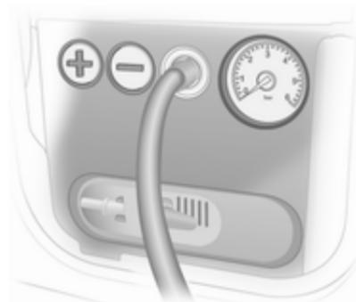
8. Appuyer sur le bouton **+** du compresseur. Le pneu se gonfle en aspirant le produit d'étanchéité.
