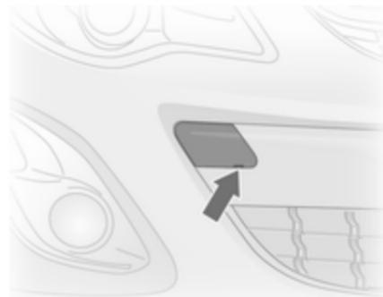
Insérer un tournevis dans la fente sur la partie basse courbe du capuchon. Dégager le capuchon en enfonçant avec précaution le tournevis vers le bas.
