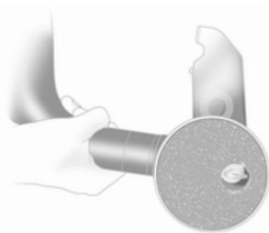
Lors de l'insertion, placer le capuchon de protection sur le bouton rotatif avec la clé.
