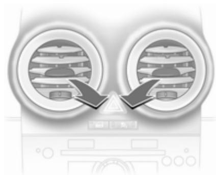
Régler la direction du flux d'air en tournant la roue moletée de droite à gauche et en relevant ou abaissant les lamelles horizontales.
