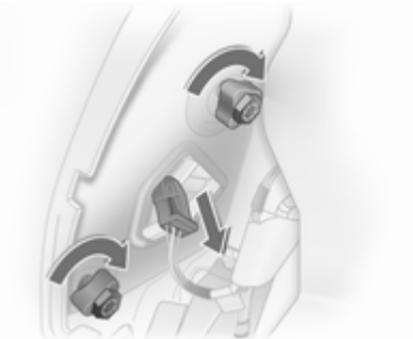
2. Débrancher la fiche en appuyant sur l'ergot de la douille de l'ampoule.
