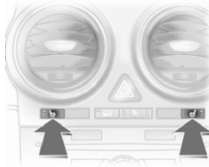
Activer le chauffage en appuyant sur le bouton
