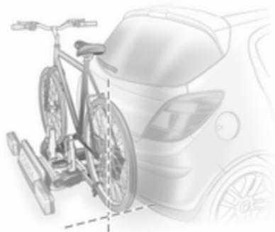
Aligner le vélo dans le sens longitudinal du véhicule : Desserrer légèrement la fixation de pédalier ;
