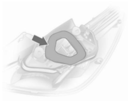
8. S'assurer que le joint de douille de l'ampoule est positionné comme illustré.
