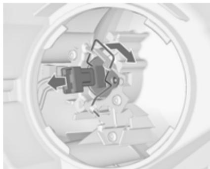
3. Désencliqueter la languette-ressort de l'attache en la déplaçant et la pivotant sur le côté.
