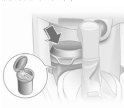
Le cendrier amovible peut être placé dans les porte-gobelets. Ouvrir le couvercle avant utilisation.
