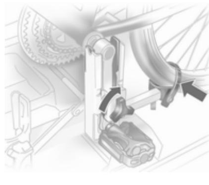
Serrer la vis de blocage de la fixation de pédalier au maximum à la main.
