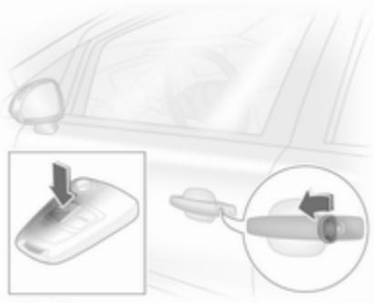
Tourner la clé vers l'avant dans la serrure de la porte du conducteur ou appuyer sur le bouton
