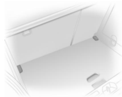
S'il est monté en position supérieure, le volume compris entre le plancher de l'espace de chargement et le cache de la roue de secours peut être utilisé comme compartiment de rangement.
