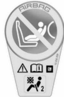
Par ailleurs, un autocollant d'avertissement se trouve sur le côté du tableau de bord, visible quand la porte du passager avant est ouverte.
