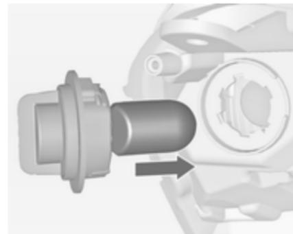
2. Enlever l'ampoule de la douille, introduire une nouvelle ampoule.
