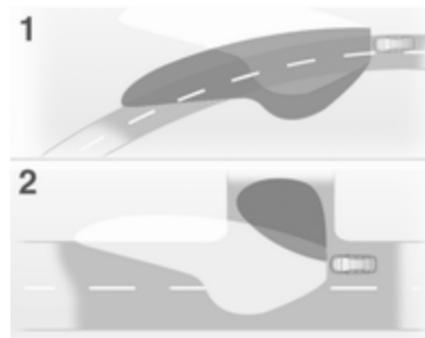
Le faisceau lumineux pivote en fonction de la position du volant et de la vitesse.
