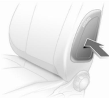
Le système d'airbag latéral se compose d'un airbag dans chacun des dossiers de siège avant et dans les
