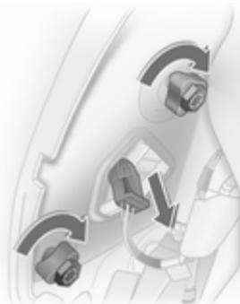
2. Débrancher la fiche en appuyant sur l'ergot de la douille de l'ampoule.
