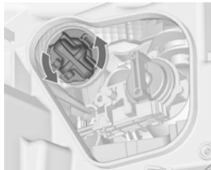
2. Faire tourner la douille de l'ampoule dans le sens antihoraire pour la désencliqueter.
