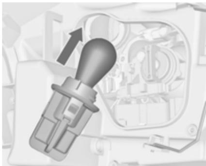
3. Pousser légèrement l'ampoule dans la douille, la tourner dans le sens antihoraire et l'enlever.
