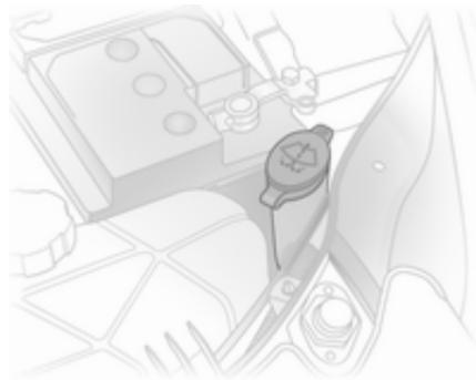
Remplir avec de l'eau propre mélangée d'une quantité adéquate de liquide de lave-glace contenant de l'antigel. La composition correcte du mélange est indiquée sur le réservoir du liquide de lave-glace.
