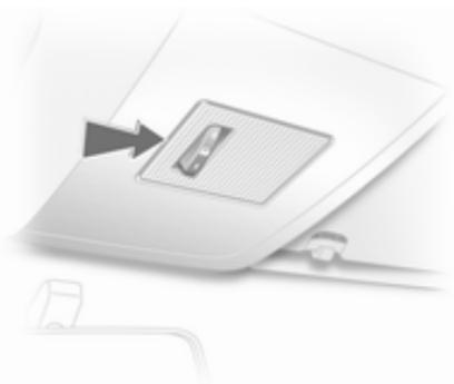
1. Désencliqueter la lentille et l'enlever par l'endroit marqué sur l'illustration en utilisant un tournevis.
