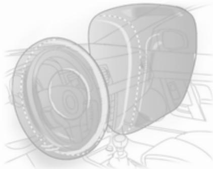
Le mouvement vers l'avant des occupants avant est décéléré, ce qui réduit considérablement le risque de blessure de la tête et de la partie supérieure du corps.
