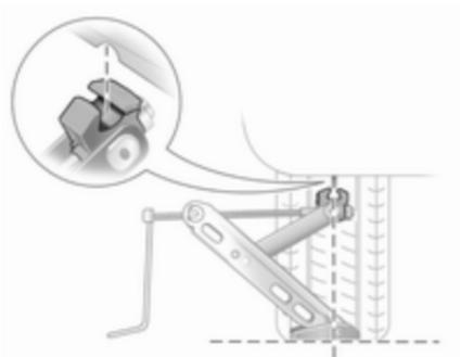
Attacher la manivelle de cric, aligner correctement le cric et tourner la manivelle jusqu'à ce que la roue ait quitté le sol.
