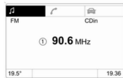
Il y a une page principale (Main) pour chaque gamme de fonctions, celle-ci est sélectionnée au bord supérieur de l'affichage (uniquement avec l'ordinateur de bord et le Mobile Phone Portal) :
