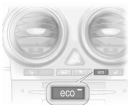
Pour désactiver le système Stop/Start manuellement, appuyer sur le bouton **eco**. La désactivation est signalée par l'extinction de la LED dans le bouton.
