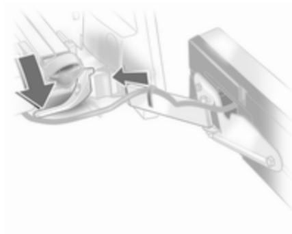
Abaisser le levier de blocage et pousser le support d'ampoules dans le dispositif de retenue jusqu'à la butée. Effectuer cette procédure pour les deux feux arrière.
