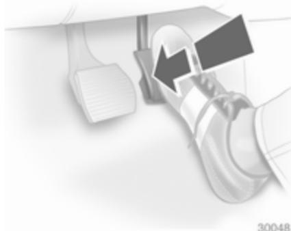
En enfonceant la pédale d'accélérateur au-delà du point de résistance, un rapport inférieur est sélectionné en fonction du régime moteur.
