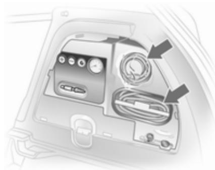
1. Sortir la bouteille de produit d'étanchéité et le support avec le flexible d'air hors du logement.
