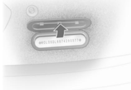
Le numéro d'identification du véhicule est frappé sur la plaquette signalétique et sur le plancher, sous le tapis de sol, abrité par un cache.
