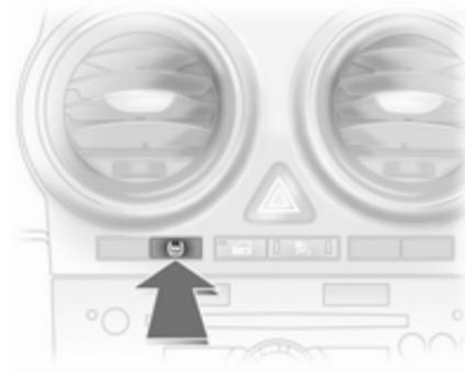
Après une correction de la pression de gonflage ou un changement de roue, il faut initialiser le système : mettre le contact, enfoncer et maintenir le bouton **DDS** pendant 4 secondes environ, le témoin
