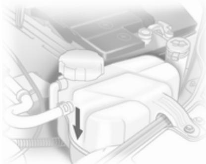
Si le système de refroidissement est froid, le niveau de liquide de refroidissement doit se trouver au-dessus du repère **KALT/COLD**. Faire l'appoint si le niveau est bas.
