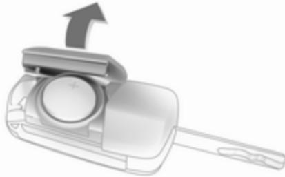
Sortir la clé et ouvrir l'unité. Remplacer la pile (type CR 2032) en faisant attention à la position de montage. Fermer l'unité et la programmer.
