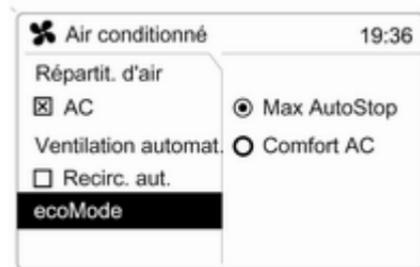
Sur les véhicules avec système Stop/Start, deux réglages de fonctionnement du système de climatisation sont disponibles pendant Autostop.
