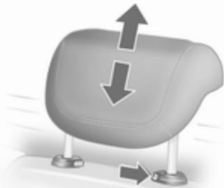
La hauteur des appuis-tête peut être réglée en deux positions. Pour régler l'appui-tête à la première position, le tirer vers le haut ; pour la seconde position, appuyer sur le ressort indiqué sur l'illustration et pousser l'appui-tête verticalement vers le haut. Pour abaisser l'appui-tête, appuyer sur le ressort indiqué sur l'illustration et pousser l'appui-tête vers le bas.
