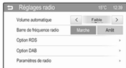
Pour réinitialiser tous les réglages : appuyez sur **Paramètres de radio** et confirmez les messages apparaissant par la suite.
