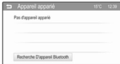
4. Sur l'Infotainment System : appuyez sur le bouton d'écran **Recherche D'appareil Bluetooth**. Une liste de tous les appareils Bluetooth détectables dans l'environnement est affichée.
