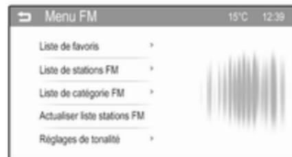
Dans les menus, une pression du bouton d'écran ↵ dans le sous-menu correspondant permet de revenir au niveau de menu supérieur suivant.
