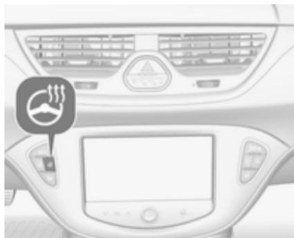
Activer le chauffage en appuyant sur le bouton
