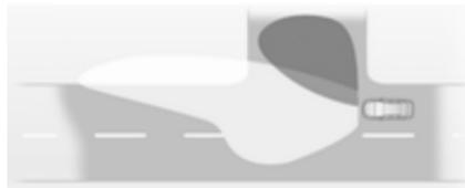
Dans les virages serrés ou lors des changements de direction, en fonction de l'angle de braquage du volant ou des clignotants, un réflecteur supplémentaire, à gauche ou à droite, est activé pour éclairer la route dans la direction du déplacement. Il est activé jusqu'à une vitesse de 40 km/h.
