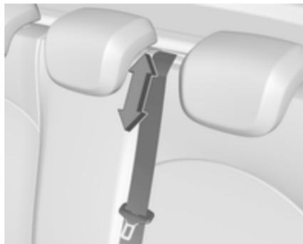
La ceinture de sécurité du siège central pourrait coincée lorsque le dossier est soulevé trop rapidement. Pour débloquer l'enrouleur, rentrer la ceinture de sécurité ou la sortir d'environ 20 mm, puis la laisser aller.
