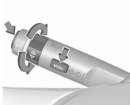
Les panneaux routiers s'affichent à la page **Détection des panneaux routiers** sur le centre d'informations du conducteur. Sélectionner **Véhicule** via le bouton Menu, puis sélectionner **Détection des panneaux routiers** à l'aide de la molette de réglage de la manette des clignotants ⇄ 99.
