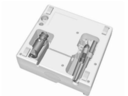
3. Enlever le câble de raccordement électrique et le flexible d'air de leur espace de rangement sur la face inférieure du compresseur.
