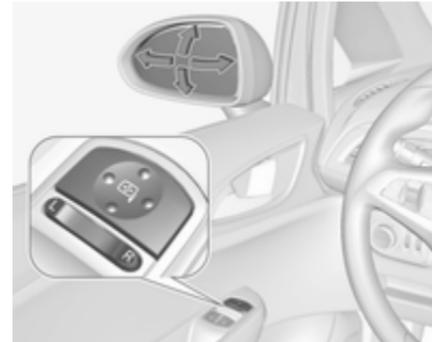
Sélectionner le rétroviseur extérieur souhaité en appuyant sur le commutateur à bascule vers la gauche (L) ou
