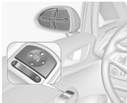
Sélectionner le rétroviseur extérieur concerné avec le commutateur à bascule et régler le rétroviseur avec la commande
