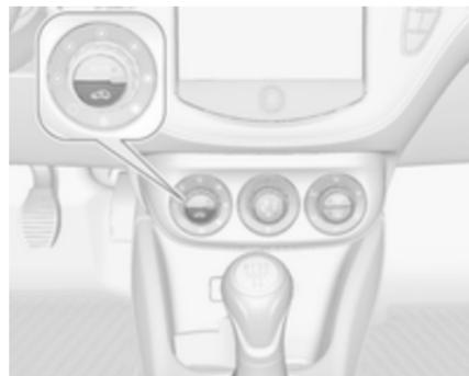
Appuyer sur le bouton
