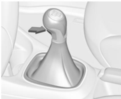
Marche arrière : le véhicule étant à l'arrêt, enfoncer la pédale d'embrayage puis enfoncer le bouton de déverrouillage du levier sélecteur et engager le rapport.
