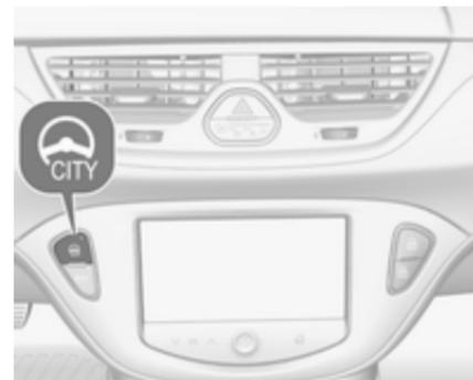
Appuyer sur le bouton
