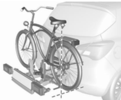
Aligner le vélo dans le sens longitudinal du véhicule : desserrer légèrement la fixation de pédalier ;
