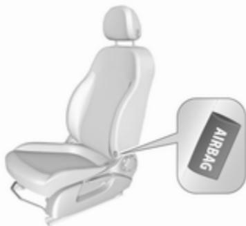
Le système d'airbags latéraux se compose d'un airbag dans chacun des dossiers de siège avant. L'emplacement est reconnaissable à l'inscription **AIRBAG**.
