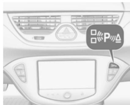
Les véhicules dotés de l'aide au stationnement avant-arrière et du système avancé d'assistance au stationnement sont reconnaissables grâce au bouton
