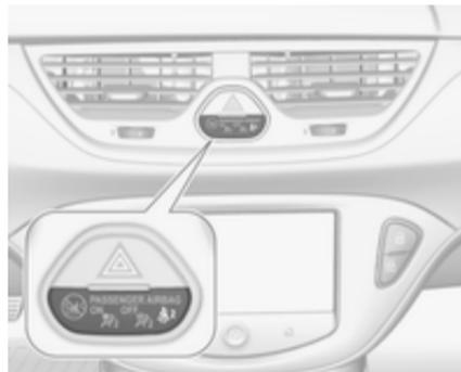
⚠ pour le siège passager avant s'allume ou clignote en rouge sur la console centrale quand le siège est occupé.
