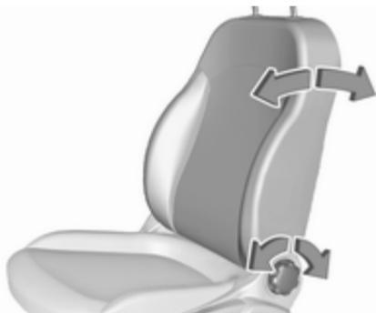
Tourner le volant pour régler l'inclinaison. Ne pas s'appuyer sur le dossier pendant le réglage.
