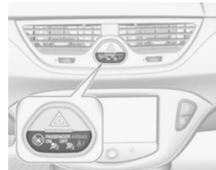
Si le témoin
