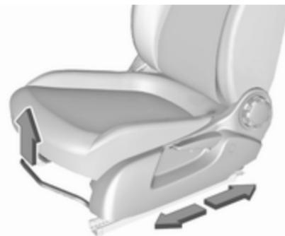
Tirer la poignée, déplacer le siège et relâcher la poignée. Laisser le siège s'enclencher.
