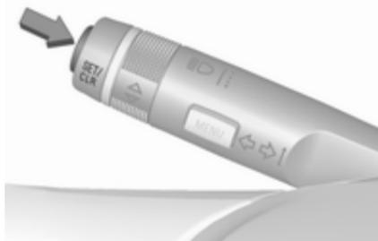
Sélectionner une place de stationnement parallèle ou perpendiculaire dans le centre d'informations du conducteur (CIC) en appuyant sur le bouton **SET/CLR**.
