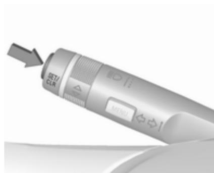
La fonction d'alerte peut être activée ou désactivée sur le menu réglages de la page d'assistant de détection des panneaux routiers en appuyant sur le bouton **SET/CLR** de la manette des clignotants.
