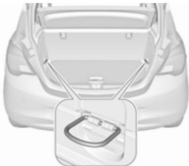
Les anneaux d'arrimage servent à sécuriser les objets pour éviter qu'ils ne glissent, par exemple avec des sangles de serrage ou le filet à bagages.
