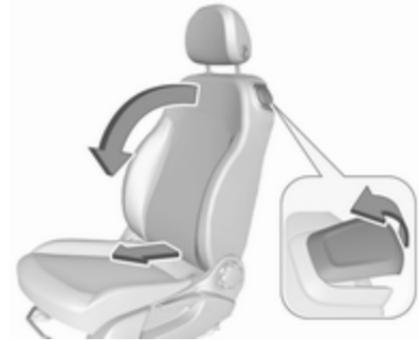
Tirer la poignée de déverrouillage vers l'avant et plier le dossier vers l'avant. Glisser ensuite le siège vers l'avant jusqu'à ce qu'il soit bloqué.
