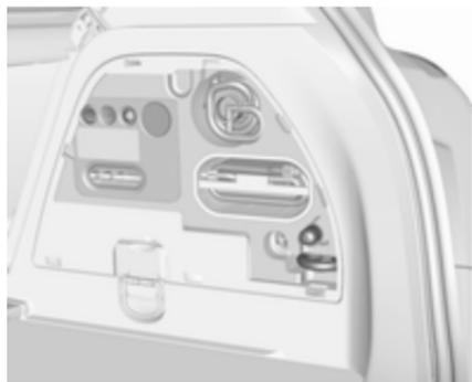
Sur les versions avec système de transport arrière ou double plancher de chargement, l'outillage ainsi que l'œillet de remorquage et le kit de réparation de pneu sont rangés sur le côté droit du coffre, derrière un cache.
