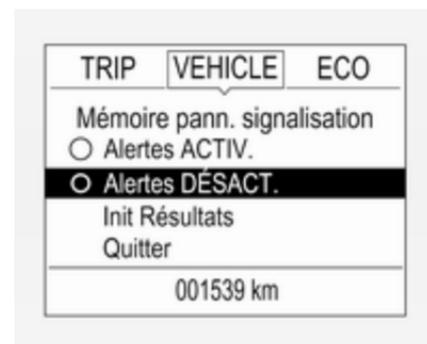
Lorsque la page réglages est affichée, sélectionner **Alertes ACTIV.** pour activer l'alerte en surimpression. Désactiver en sélectionnant **Alertes DÉSACT.** En mettant le contact, la fonction d'alerte est désactivée.
