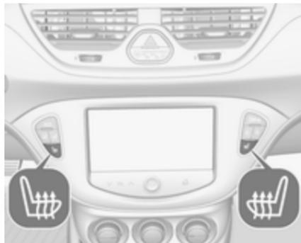
Activer le chauffage du siège en appuyant sur le bouton
