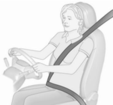
Tirer la ceinture de sécurité et l'encliqueter dans la serrure de ceinture. La ceinture de sécurité ne doit pas être vrillée et doit être placée près du corps. Le dossier ne doit pas être incliné trop en arrière (environ 25° maximum).
