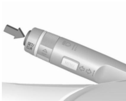
La fonction d'alerte peut être activée ou désactivée sur le menu réglages de la page d'assistant de détection des panneaux routiers en appuyant sur **SET/CLR** de la manette des cli-gnotants.
