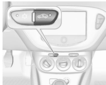
Appuyer sur pour activer le mode de recyclage de l'air. L'activation est signalée par l'allumage de la LED dans le bouton.
