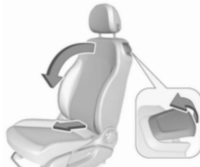
Tirer la poignée de déverrouillage vers l'avant et plier le dossier vers l'avant. Glisser ensuite le siège vers l'avant jusqu'à ce qu'il soit bloqué. Pour rétablir, glisser le siège vers l'arrière jusqu'à ce qu'il soit bloqué. Relever le dossier en position verticale sans actionner la manette de déblocage. Laisser le dossier s'encliqueter.
