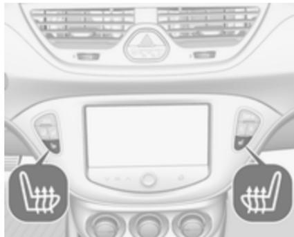
Activer le chauffage du siège en appuyant sur
