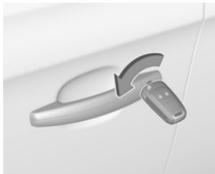
Déverrouiller manuellement la porte du conducteur en tournant la clé dans la serrure. Mettre le contact et appuyer sur le bouton de verrouillage
