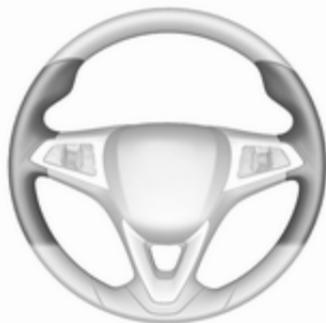
Les zones mises en relief pour tenir le volant sont chauffées plus rapidement et à une température plus élevée que le reste du volant.
