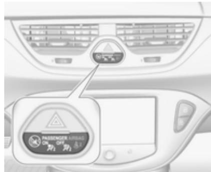
Si le témoin
