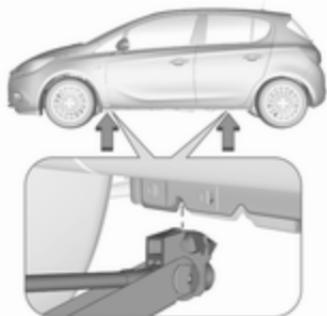
3. Vérifier que le cric est bien positionné sous le point de levage adéquat.
