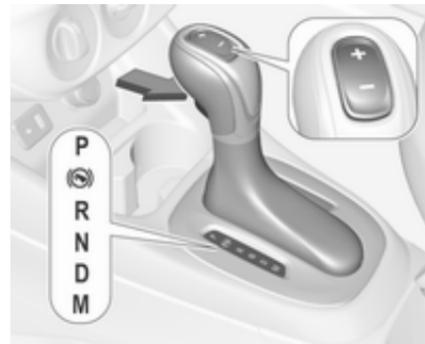
**P** = position de stationnement, les roues sont bloquées, à n'engager que si le véhicule est à l'arrêt et que le frein de stationnement est serré
