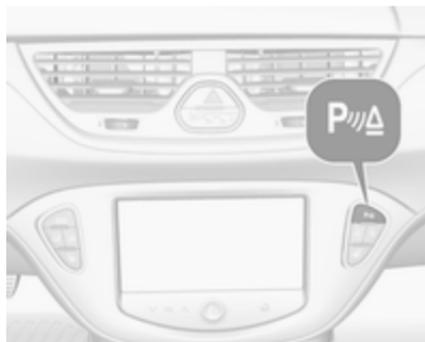
Les véhicules dotés de l'aide au stationnement arrière ou avant-arrière sont munis du bouton **P**▲.
