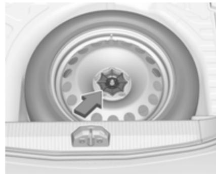
La roue de secours se trouve dans le coffre, sous le recouvrement de plancher. Elle est fixée par un écrou papillon.
