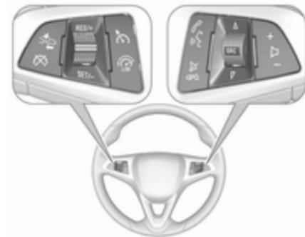
Le régulateur de vitesse, le limiteur de vitesse, le réglage de l'alerte de collision avant, l'Infotainment System et un téléphone portable branché peuvent être opérés en utilisant les commandes au volant.
