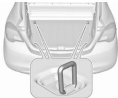
Le chargement peut être fixé dans le coffre par 4 anneaux d'arrimage
