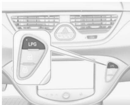
L'actionnement du bouton **LPG** permet de basculer entre les modes de fonctionnement à l'essence et au gaz de pétrole liquéfié dès que les paramètres requis (température de liquide de refroidissement et régime moteur minimal) ont été atteints. Les exigences sont généralement satisfaites après environ 60 secondes (en fonction de la température extérieure) et la première pression ferme sur la pédale d'accélérateur. La LED indique le mode de fonctionnement en cours.
