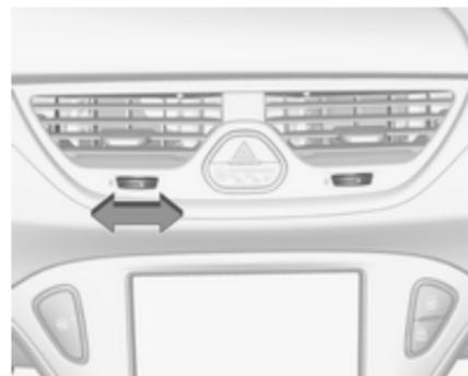
Régler la quantité d'air sortant de la bouche d'aération en tournant la molette. La bouche est fermée lorsque la roue moletée est tournée pour être fermée vers la gauche ou la droite.
