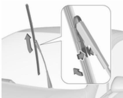
Soulever le bras de l'essuie-glace jusqu'à ce qu'il reste en position levée. Presser les loquets des deux côtés, incliner le balai de l'essuie-glace à un angle de 90° par rapport au bras et le retirer par le haut.
