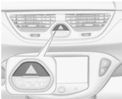
Pour les enclencher, appuyer sur
