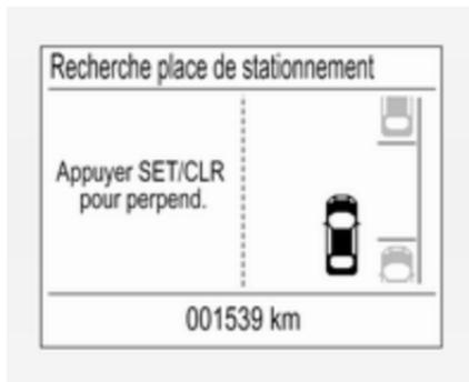
Sélectionner une place de stationnement parallèle ou perpendiculaire dans le centre d'informations du conducteur (CIC) en appuyant sur **SET/CLR**.
