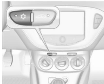
Appuyer sur pour mettre le refroidissement en marche. L'activation est signalée par l'allumage de la LED dans le bouton. Le refroidissement ne fonctionne que lorsque le moteur est en marche et que le ventilateur de commande de climatisation est en fonction.
