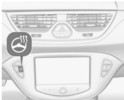
Activer le chauffage en appuyant sur
