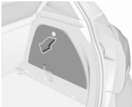
Pour ouvrir le compartiment, désencliqueter le couvercle et l'ouvrir.
