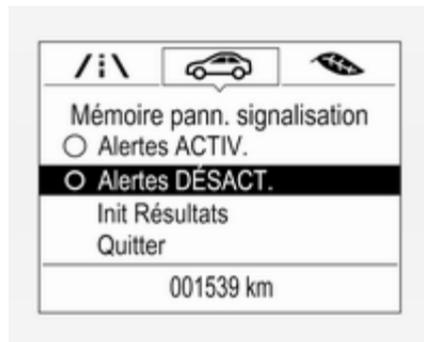
Une fois la page de réglage affichée, sélectionner **Alertes ACTIV.** pour activer l'alerte de surimpression. Désactiver en sélectionnant **Alertes DÉFACT.**. En mettant le contact, la fonction d'alerte est désactivée.
