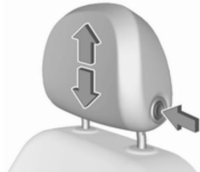
Appuyer sur le bouton de déverrouillage, régler la hauteur, verrouiller.
