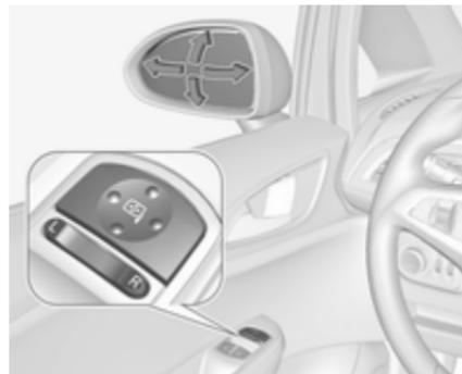
Sélectionner le rétroviseur extérieur souhaité en appuyant sur le commutateur à bascule vers la gauche (L) ou
