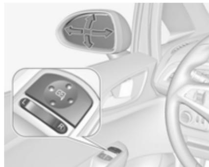
Sélectionner le rétroviseur extérieur concerné avec le commutateur à bascule et régler le rétroviseur avec la commande
