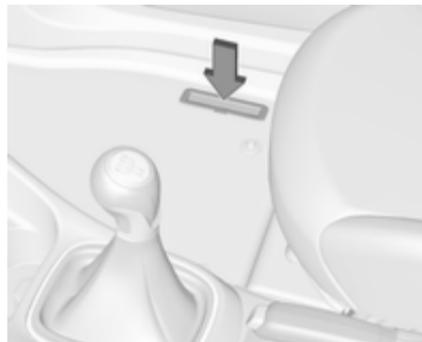
Le numéro d'identification du véhicule est frappé sur la plaquette signalétique et sur le plancher, sous le tapis de sol, abrité par un cache.
