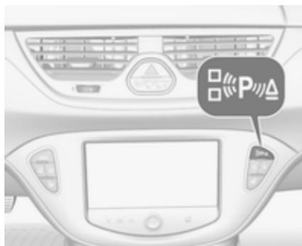
Les véhicules dotés de l'aide au stationnement avant-arrière et du système avancé d'assistance au stationnement sont reconnaissables grâce à **P**■▲.
