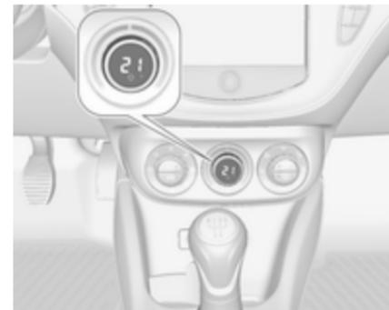
Si la température minimale **Lo** est réglée, le système de commande de climatisation fonctionne avec sa capacité maximale de refroidissement, si le refroidissement
