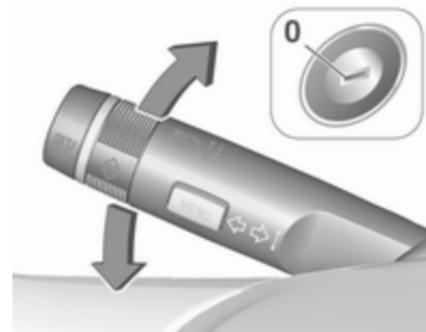
Quand le véhicule est stationné, les feux de stationnement peuvent être allumés d'un côté :
