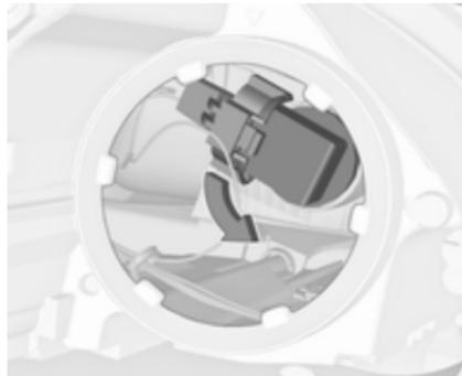
2. Faire tourner la douille de l'ampoule dans le sens antihoraire pour la désencliqueter. Retirer la douille de l'ampoule du réflecteur.
