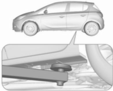
Position du bras arrière du pont élévateur centralisée sous le creux du seuil.
