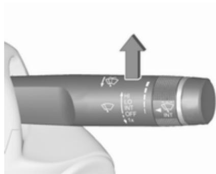
INT : balayage automatique avec capteur de pluie
