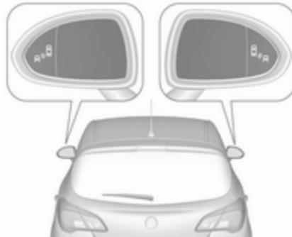
L'alerte d'angle mort latéral est activée lorsque le véhicule roule à des vitesses allant de 10 km/h à 140 km/h. Conduire à une vitesse supérieure à 140 km/h désactive le système, ce qui est indiqué par les symboles d'avertissement à faible luminosité  $\text{A}^{\text{B}}$  sur les deux rétroviseurs extérieurs. Ralentir
