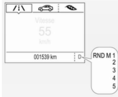
En mode automatique, le programme de conduite est signalé par **D** sur le centre d'informations du conducteur.
