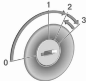
Tourner la clé en position 1 pour déverrouiller le volant.
