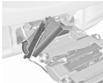
Ouvrir complètement le support d'ampoule au dos du feu arrière jusqu'à la butée.
