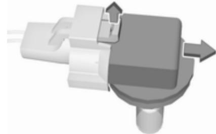
3. Déposer l'ampoule du connecteur en le désengageant et en le tirant.
