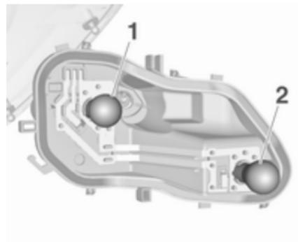
5. Déposer et remplacer l'ampoule en poussant légèrement dans la douille et la faire tourner dans le sens anti-horaire :
