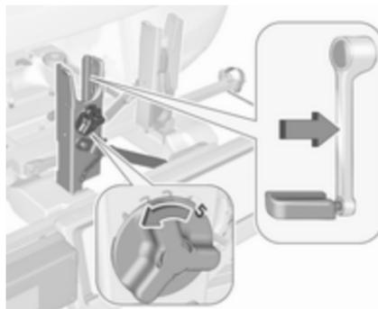
À l'aide du levier rotatif du logement de pédalier, adapter grossièrement l'unité réglable de pédalier au débordement de la manivelle de pédale.
