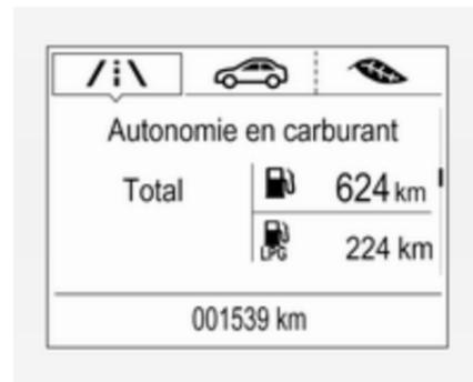
Affichage de l'autonomie approximative en carburant pour chaque réservoir de carburant (GPL et essence). Un niveau bas de carburant dans un réservoir est indiqué par **FAIBLE** dans la section correspondante.
