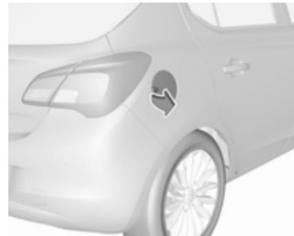
La trappe de réservoir ne peut être ouverte que si le véhicule est déverrouillé. Ouvrir la trappe à carburant en la poussant.
