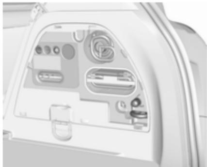
Sur la version OPC ou GPL ou bien sur les versions avec système de transport arrière ou double plancher de chargement, l'outillage ainsi que l'œillet de remorquage et le kit de réparation de pneu sont rangés sur le côté droit du coffre, derrière un cache.
