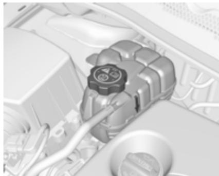
Si le système de refroidissement est froid, le niveau de liquide de refroidissement doit se trouver au-dessus du repère de niveau de remplissage.
