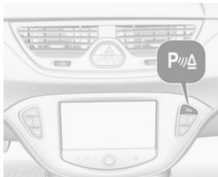
Une LED allumée dans le bouton de l'aide au stationnement **P**▲ indique que le système est prêt à fonctionner. L'aide au stationnement avant peut également être activée à une vitesse allant jusqu'à 11 km/h avec une brève pression sur le bouton d'aide au stationnement.
