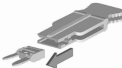
Placer la pince à fusibles par le haut sur les différents types de fusibles et retirer le fusible.
