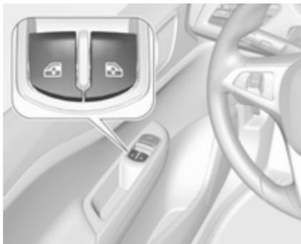
Manœuvrer le commutateur dans la garniture de porte de la vitre concernée en l'appuyant pour l'ouvrir ou en le relevant pour la fermer.
