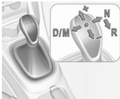
**R** : marche arrière, à n'engager que si le véhicule est à l'arrêt
