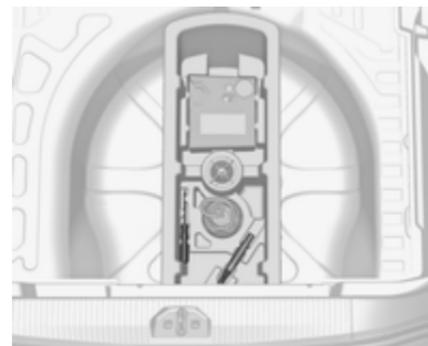
L'outillage ainsi que l'œillet de remorquage et le kit de réparation de pneu sont rangés dans le coffre sous le couvercle de plancher.
