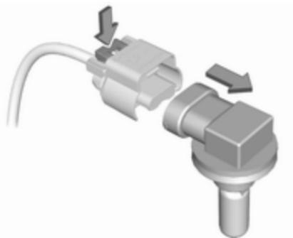
2. Dégager la douille d'ampoule du connecteur en enfonceant la patte de retenue.
