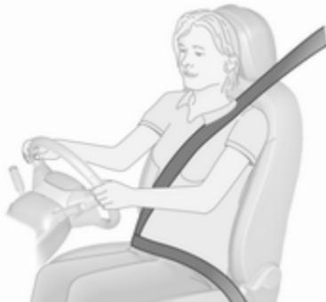
Tirer la ceinture de sécurité et l'encliquer dans la serrure de ceinture. La ceinture de sécurité ne doit pas être vrillée et doit être placée près du corps. Le dossier ne doit pas être incliné trop en arrière (environ 25° maximum).
