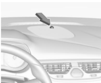
La LED d'état est intégrée dans le capteur sur le haut du tableau de commande.
