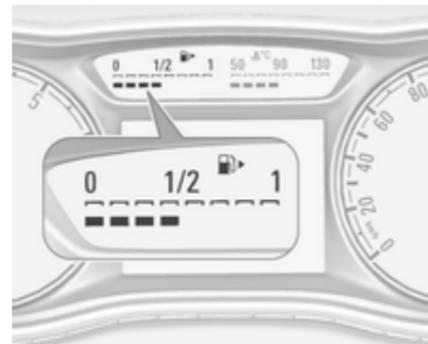
Le nombre de DEL allumées indique le niveau de carburant dans le réservoir à carburant.
