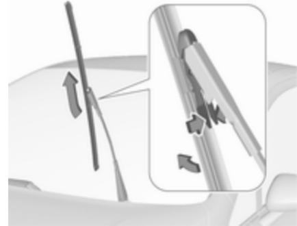
Soulever le bras de l'essuie-glace jusqu'à ce qu'il reste en position levée. Presser les loquets des deux côtés, incliner le balai de l'essuie-glace à un angle de 90° par rapport au bras et le retirer par le haut.
