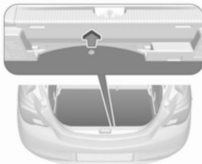
Relever le recouvrement du plancher arrière pour accéder aux équipements de dépannage d'urgence.
