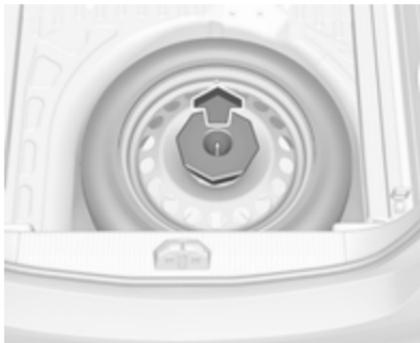
Enlever l'entretoise au-dessus de la roue de secours, soulever la roue, la positionner à la verticale et la retirer par le dessus.
