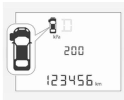
La pression de pneu pour chaque pneu est affichée sur sa propre page. Affichage de niveau supérieur :
