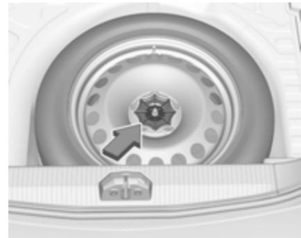
La roue de secours se trouve dans le coffre, sous le recouvrement de plancher. Elle est fixée par un écrou papillon.
