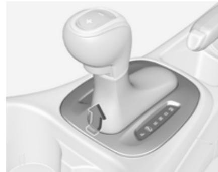
2. Dégager la garniture du levier sélecteur de la console centrale ; passer un doigt dans la prise en cuir sur l'avant du levier sélecteur et pousser par dessous la garniture vers le haut sur le bord avant, comme le montre l'illustration. Déplacer la garniture sur la gauche.
