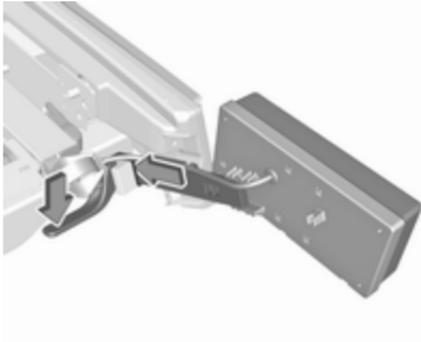
Abaisser le levier de blocage et pousser le support d'ampoules dans le dispositif de retenue jusqu'à la butée.
