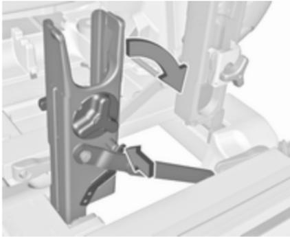
Désencliqueter le levier de verrouillage du support diagonal et rabattre les deux logements de pédalier vers le bas.
