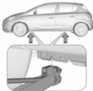
3. Vérifier que le cric est bien positionné sous le point de levage adéquat.
