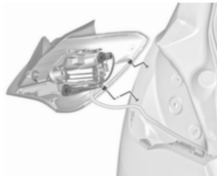
3. Retirer avec précaution l'ensemble de feu arrière du renforcement et le déposer.
