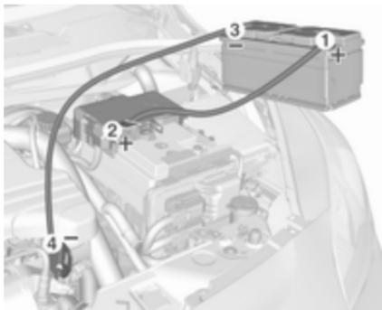
Séquence de raccordement des câbles :
