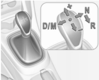
Toujours déplacer le levier sélecteur aussi loin que possible dans la direction adéquate. Quand il est relâché, il revient automatiquement en position centrale.
