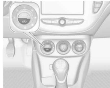
Appuyer sur ↻ pour activer le mode de recyclage de l'air. L'activation est signalée par l'éclairage de la LED dans le bouton.
