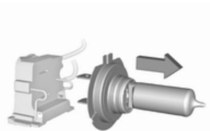
3. Séparer l'ampoule de la douille d'ampoule et remplacer l'ampoule.
