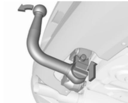
Insérer la barre d'attelage serrée dans le logement et pousser fermement vers le haut jusqu'au déclic audible.
