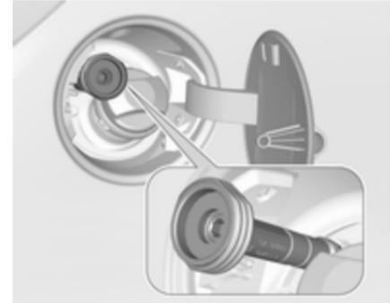
**Adaptateur ACME :** Visser l'écrou du pistolet de remplissage sur l'adaptateur. Abaisser le levier de verrouillage du pistolet de remplissage.
