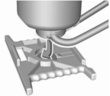
3. Mettre la bouteille de produit d'étanchéité sur le support. S'assurer que la bouteille ne se retourne pas.
