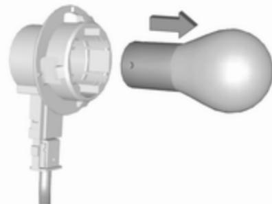
4. Déposer l'ampoule en poussant légèrement dans la douille et la faire tourner dans le sens anti-horaire. Remplacer l'ampoule.
