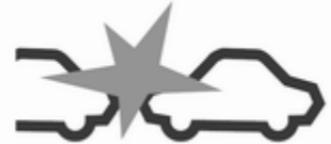
Lorsque le temps avant une collision possible avec le véhicule à l'avant est trop court et qu'une collision est imminente, le symbole d'alerte de collision s'affiche dans le centre d'informations du conducteur et le conducteur est avisé par une bande rouge à DEL clignotante qui est projetée sur le pare-brise dans le champ de vision du conducteur.
