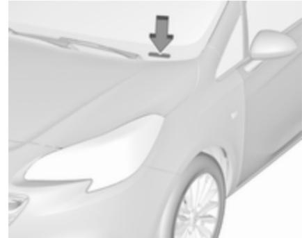
Le numéro d'identification du véhicule peut être estampé sur le tableau de bord, visible à travers le pare-brise ou dans le compartiment moteur sur le panneau de carrosserie de droite.
