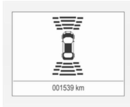
La distance par rapport à des obstacles avant ou arrière est indiquée par un changement des lignes de distance au niveau du centre d'informations du conducteur ↻ 102.
