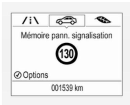
Une fois activée, et lorsque la page de détection des panneaux routiers n'est pas affichée, la limite de vitesse et les panneaux d'interdiction de dépassement récemment détectés sont affichés sous forme d'alertes contextuelles dans le centre d'informations du conducteur.
