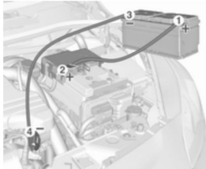
Séquence de raccordement des câbles :
