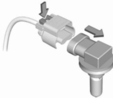
2. Dégager la douille d'ampoule du connecteur en enfonçant la patte de retenue.
