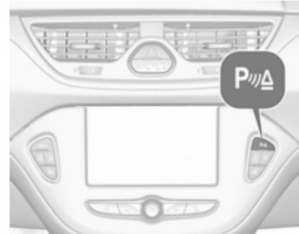
Une LED allumée dans le bouton de l'aide au stationnement **P**
