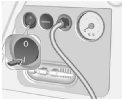
8. Appuyer sur le commutateur marche/arrêt pour démarrer le compresseur. Le pneu se gonfle en aspirant le produit d'étanchéité.
