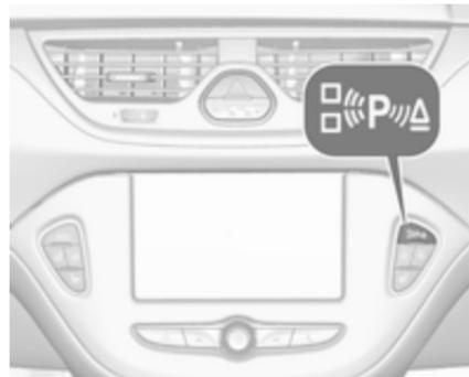
Une LED allumée dans le bouton de l'aide au stationnement
