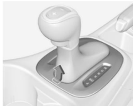
2. Dégager la garniture du levier sélecteur de la console centrale ; passer un doigt dans la prise en cuir sur l'avant du levier sélecteur et pousser par dessous la garniture vers le haut sur le bord avant, comme le montre l'illustration. Déplacer la garniture sur la gauche.
