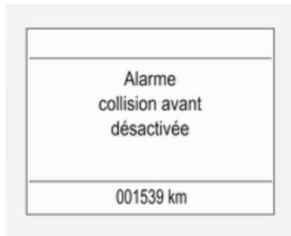
Si l'alerte de collision avant a été désactivée, la sensibilité d'alerte est réglée sur « moyenne » lors de la mise du contact suivante.
