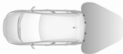
Le système possède quatre capteurs de stationnement à ultrasons disposés dans le pare-chocs arrière.
