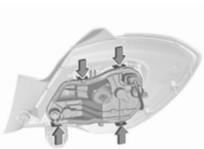
4. Enfoncer les pattes de retenue et enlever le support d'ampoule de l'ensemble de feu.
