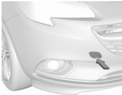
Insérer un tournevis dans la fente sur la partie basse du capuchon. Déga-ger le capuchon en enfonçant avec précaution le tournevis vers le bas.
