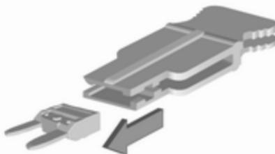
Placer la pince à fusibles par le haut sur les différents types de fusibles et retirer le fusible.
