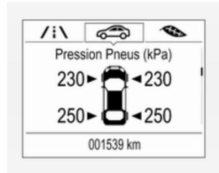
6. Appuyer sur **SET/CLR** pour lancer le processus d'appariement de capteur. Un message demandant d'accepter le processus doit s'afficher.
