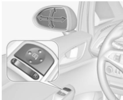
Sélectionner le rétroviseur extérieur concerné avec le commutateur à bascule et régler le rétroviseur avec la commande
