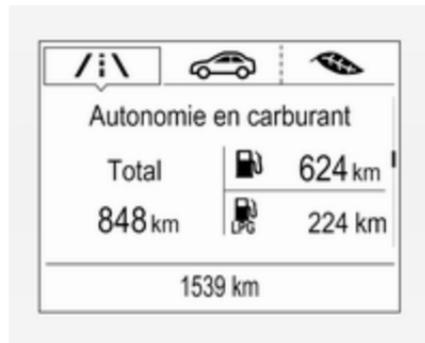
Affichage de l'autonomie approximative en carburant pour chaque réservoir de carburant (GPL et essence). Un niveau bas de carburant dans un des réservoirs est indiqué par **FAIBLE** dans la section correspondante.
