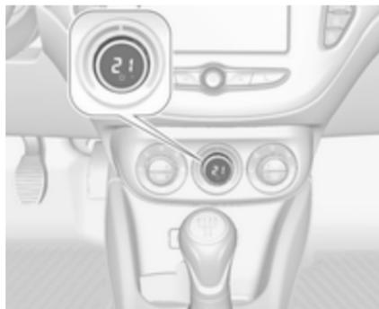
Si la température minimale **Lo** est réglée, le système de commande de climatisation fonctionne à sa capacité maximale de refroidissement, si le refroidissement
