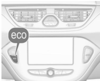
Pour désactiver le système Stop/Start manuellement, appuyer sur **eco**. La désactivation est signalée par l'extinction de la LED dans le bouton.
