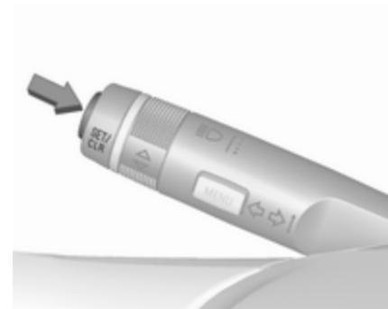
Sélectionner une place de stationnement parallèle ou perpendiculaire dans le centre d'informations du conducteur en appuyant sur **SET/CLR**.
