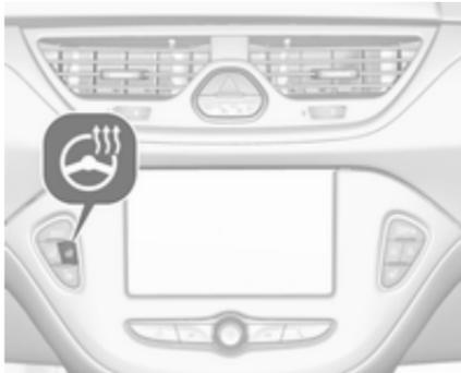
Activer le chauffage en appuyant sur
