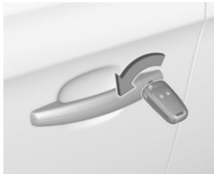
Déverrouiller manuellement la porte du conducteur en tournant la clé dans la serrure. Mettre le contact et appuyer sur le bouton de verrouillage central
