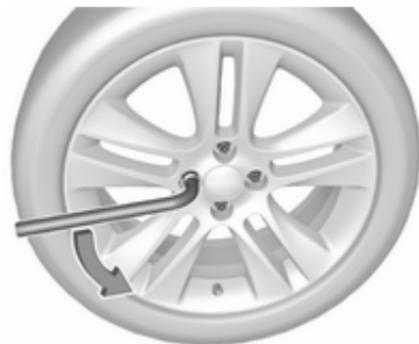
2. Placer la clé de roue en s'assurant qu'elle soit bien positionnée et desserrer chaque vis de roue d'un demi-tour.
