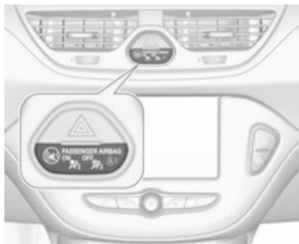
Si le témoin
