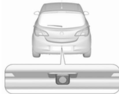
La caméra est montée entre les lampes d'éclairage de la plaque d'immatriculation et a un angle de vision de 130°.
