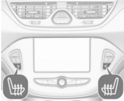
Activer le chauffage du siège en appuyant sur
