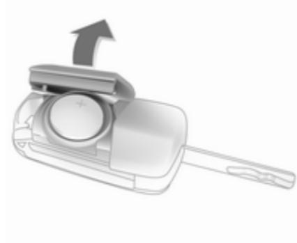
Sortir la clé et ouvrir l'unité latéralement. Remplacer la pile (type CR 2032) en faisant attention à la position de montage. Fermer l'unité et la programmer.
