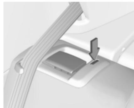
Le dossier arrière n'est verrouillé que si les repères rouges situés des deux côtés près de la poignée de déverrouillage ne sont pas visibles.
