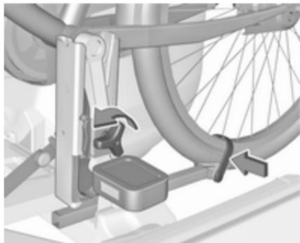
Détacher les dispositifs de retenue par sangle sur les deux roues du vélo. Maintenir le vélo, desserrer la vis de blocage de la fixation du pédalier, puis soulever la fixation de pédalier pour l'enlever.
