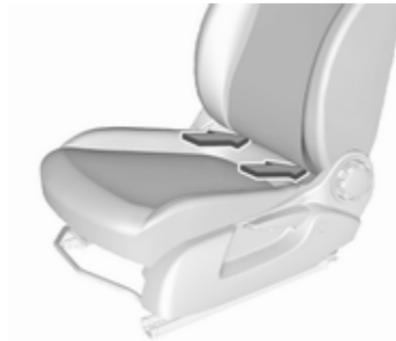
Placer le système de sécurité pour enfant sur le centre du siège et pousser vers l'arrière. Vérifier que le système de sécurité pour enfant est correctement engagé.
