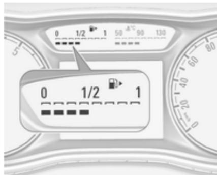
Affiche le niveau de carburant ou de gaz contenu dans le réservoir selon le mode de fonctionnement.
