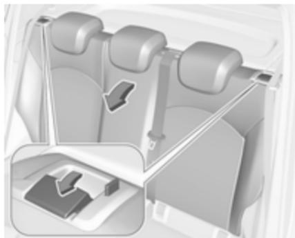
Guider les ceintures de sécurité à travers les supports latéraux afin de les protéger de tout dégât. Lors du rabattement du dossier, entraîner les ceintures de sécurité avec lui.
