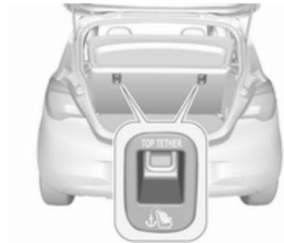
En plus des supports de montage ISOFIX, attacher la sangle Top-Tether aux ancrages Top-Tether.
