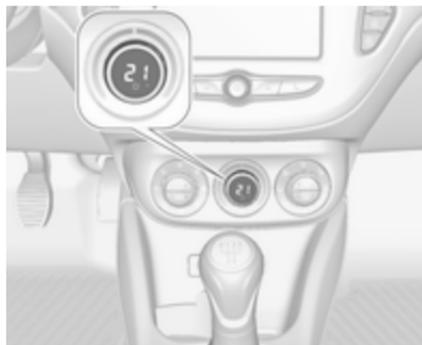
Si la température minimale **Lo** est réglée, le système de commande de climatisation fonctionne à sa capacité maximale de refroidissement, si le refroidissement
