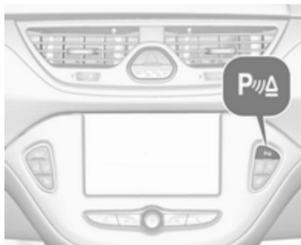
Une LED allumée dans le bouton de l'aide au stationnement **P**▲ indique que le système est prêt à fonctionner.
