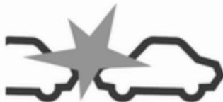
Lorsque le temps avant une collision possible avec le véhicule à l'avant est trop court et qu'une collision est imminente, le symbole d'alerte de collision s'affiche dans le centre d'informations du conducteur et le conducteur est avisé par une bande rouge à DEL clignotante qui est projetée sur le pare-brise dans le champ de vision du conducteur.
