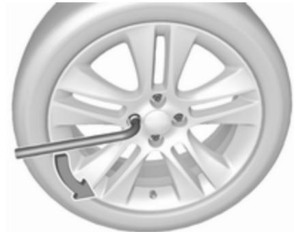
2. Placer la clé de roue en s'assurant qu'elle soit bien positionnée et
