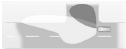
Dans les virages serrés ou lors des changements de direction, en fonction de l'angle de braquage du volant ou des clignotants, un réflecteur supplémentaire, à gauche ou à droite, est activé pour éclairer la route dans
