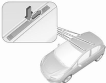
Pousser les caches des fixations de galerie de toit vers le bas et vers l'arrière.
