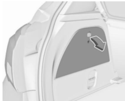
1. Libérer le couvercle du coffre sur le côté concerné et le déposer. Retirer tous les composants, notamment le kit de réparation des pneus ou l'outillage, de l'encart arrière. Comprimer cet insert dans la partie supérieure et retirer de la paroi latérale.
