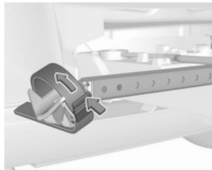
Pousser la poignée de déverrouillage sur le dispositif de retenue par sangle et enlever ce dernier.
