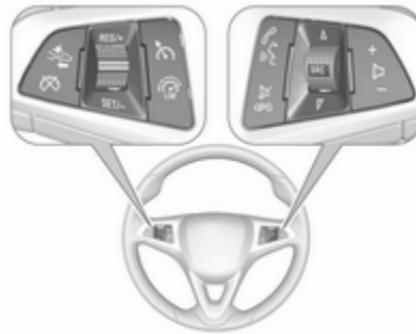
Le régulateur de vitesse et le limiteur de vitesse sont actionnés via les commandes situées sur le côté gauche du volant.
