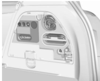
1. Sortir la bouteille de produit d'étanchéité et le support avec le flexible d'air hors du logement.
