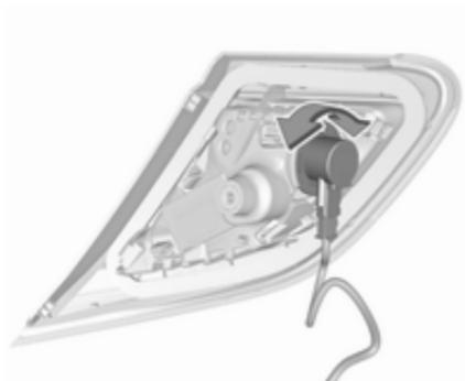
3. Déposer le support de l'ampoule en le tournant.
