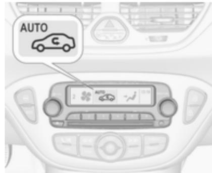
Les réglages de commande de climatisation s'affichent à l'affichage d'informations. Les modifications de réglages sont brièvement affichées, superposées sur le menu actuellement affiché.
