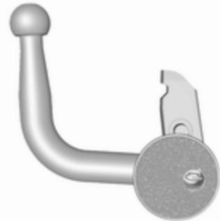
Lors de l'insertion, placer le capuchon de protection sur le bouton rotatif avec la clé.
