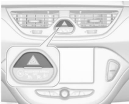
Pour les enclencher, appuyer sur
