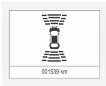
La distance par rapport à des obstacles avant ou arrière est indiquée par un changement des lignes de distance au niveau du centre d'informations du conducteur ↗ 101.
