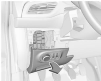
La boîte à fusibles se trouve derrière le commutateur d'éclairage du tableau de bord. Tenir la poignée, puis tirer et rabattre le commutateur d'éclairage.
