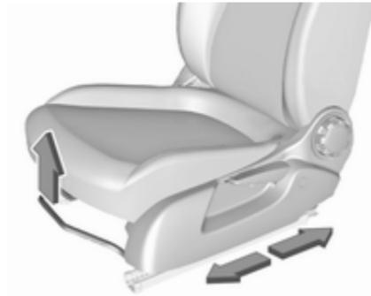
Tirer la poignée, déplacer le siège et relâcher la poignée. Essayer de déplacer le siège vers l'arrière et l'avant pour s'assurer que le siège est verrouillé en place.
