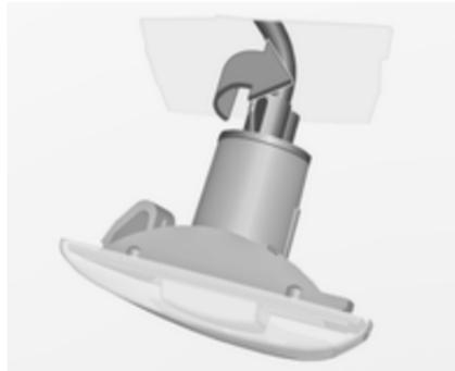
2. Tourner la douille d'ampoule dans le sens anti-horaire et retirer du boîtier.
