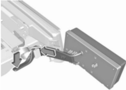
Abaisser le levier de blocage et pousser le support d'ampoules dans le dispositif de retenue jusqu'à la butée. Effectuer cette procédure pour les deux feux arrière.
