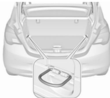
Les anneaux d'arrimage servent à sécuriser les objets pour éviter qu'ils ne glissent, par exemple avec des sangles de serrage ou le filet à bagages.
