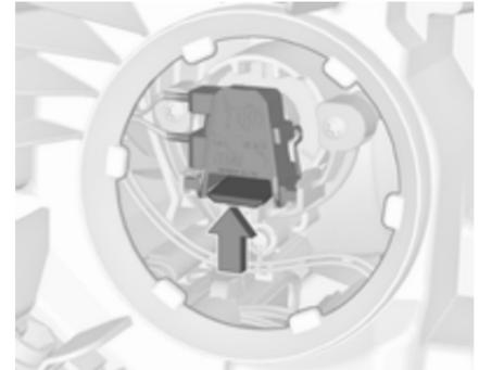
2. Appuyer sur l'attache pour désengager la douille. Retirer la douille de l'ampoule du réflecteur.
