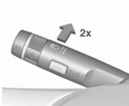
Les feux de route automatiques sont allumés en poussant deux fois la tige lorsque le véhicule roule à une vitesse supérieure à 40 km/h.
