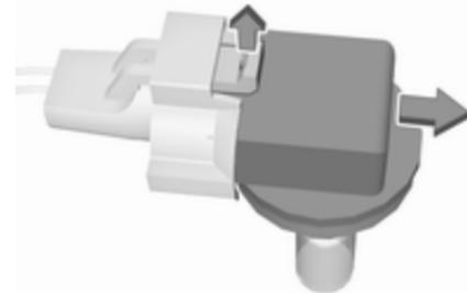
3. Déposer l'ampoule du connecteur en la désengageant et en la tirant.
