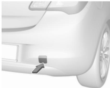
Envelopper d'un linge l'extrémité d'un tournevis plat pour ne pas endommager la peinture. Insérer le tournevis dans la fente sur la partie basse du capuchon. Dégager le capuchon en enfonçant avec précaution le tournevis vers le bas.
