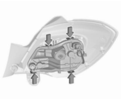
4. Enfoncer les pattes de retenue et enlever le support d'ampoule de l'ensemble de feu.
