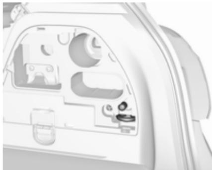
L'outillage et l'œillet de remorquage sont situés sur le côté droit du coffre derrière un cache.
