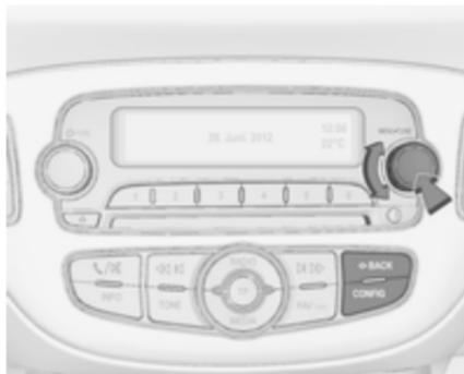
Sélectionner **Paramètres**, puis **Réglages véhicule**.
