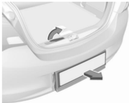
Tirer la poignée de déverrouillage vers le haut. Le système se déverrouille et est éjecté hors du pare-chocs.
