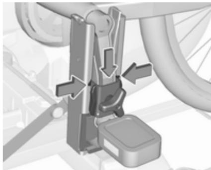
Introduire le support de manivelle dans le rail de chaque logement de manivelle depuis le haut et le coulisser vers le bas au moins jusqu'aux encoches.
