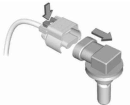
2. Dégager la douille d'ampoule du connecteur en enfonçant la patte de retenue.
