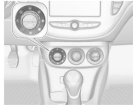
Tourner le bouton rotatif gauche pour réduire ou augmenter la vitesse de soufflerie. La vitesse de soufflerie est indiquée dans l'affichage d'informations.
