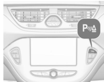
La désactivation manuelle est également possible. Pour cela, appuyer sur le bouton d'aide au stationnement **P**▲.
