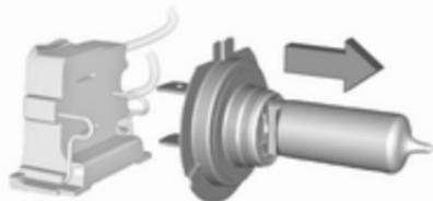
3. Séparer l'ampoule de la douille d'ampoule et remplacer l'ampoule.
