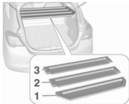
Pour enlever les trois autres éléments (dans l'ordre de 1 à 3), les soulever à l'arrière, les déverrouiller, les tourner et les enlever.
