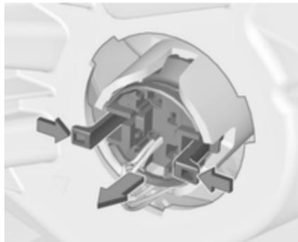
2. Presser les deux clips ensemble et déposer la douille d'ampoule du boîtier de phare.
