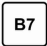
Utiliser uniquement du carburant diesel conforme EN 590 et présentant une concentration en soufre maximale de 10 ppm.
