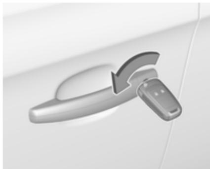
Déverrouiller manuellement la porte du conducteur en tournant la clé dans la serrure. Mettre le contact et appuyer sur le bouton de verrouillage central
