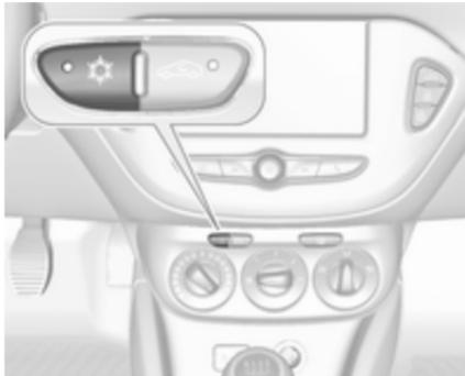
Appuyer sur ☞ pour mettre le refroidissement en marche. L'activation est signalée par l'éclairage de la LED dans le bouton. Le refroidissement ne fonctionne que lorsque le moteur est
