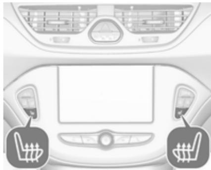
Activer le chauffage du siège en appuyant sur
