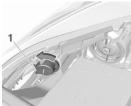
1. Faire tourner la douille de l'ampoule (1) dans le sens antihoraire pour la désencliqueter.
