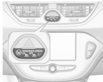
Si le témoin
