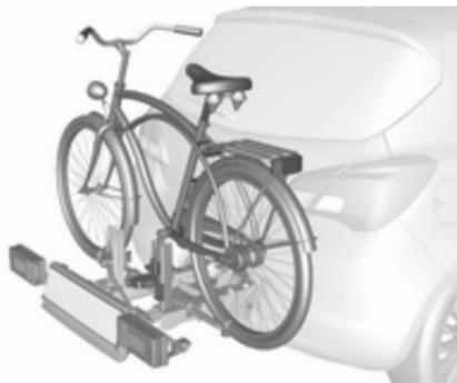
Le système de transport arrière (système Flex-Fix) permet de fixer des bicyclettes au support de transport extensible intégré dans le plancher du véhicule. Le transport d'autres objets n'est pas autorisé.
