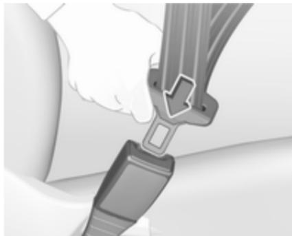
Le port de vêtement larges ou épais gêne la position tendue de la ceinture. Ne pas placer d'objets, comme un sac à main ou un appareil mobile, entre la ceinture et le corps.
