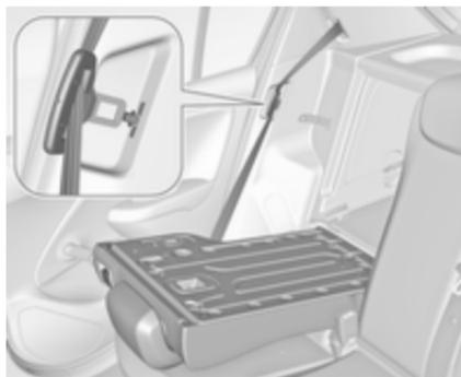
Si le véhicule doit être chargé via une porte arrière, sortir la ceinture de sécurité du guide de dossier et placer le verrou plat dans le logement, comme illustré.
