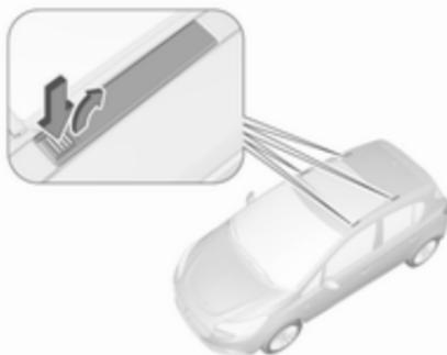
Dégager les caches des fixations de galerie de toit en poussant la partie coulissante dans le sens de la flèche et l'enlever par le haut. Pour obturer les fixations de galerie de toit, introduire d'abord les caches à l'avant, puis engager la partie coulissante à l'arrière.
