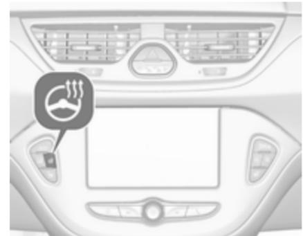
Activer le chauffage en appuyant sur
