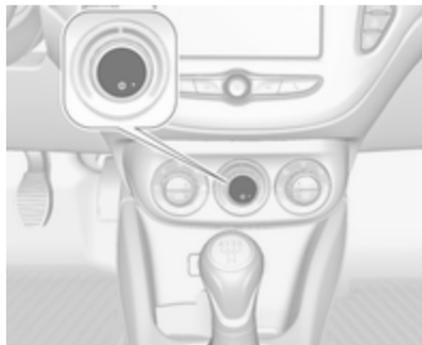
Appuyer sur ❄️ pour mettre le refroidissement en marche. L'activation est signalée par l'éclairage de la LED dans le bouton. Le refroidissement ne fonctionne que lorsque le moteur est en marche et que le ventilateur de commande de climatisation est en fonction.
