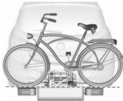
Placer les logements de roue de telle manière que la bicyclette soit à peu près horizontale. La distance entre les pédales et le hayon doit être d'au moins 5 cm.
