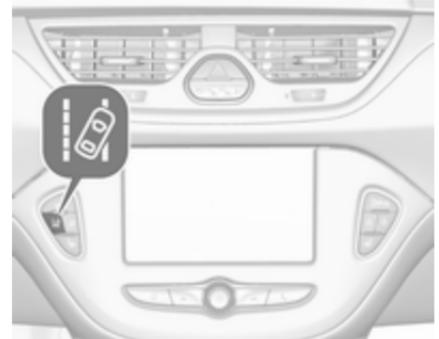
Le système d'avertissement de franchissement de ligne est activé en appuyant sur **L**. La LED allumée dans le bouton indique que le système est activé. Quand le témoin **L** du
