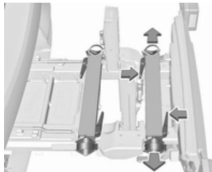
Appuyer sur la poignée de déverrouillage et sortir les logements de roue.
