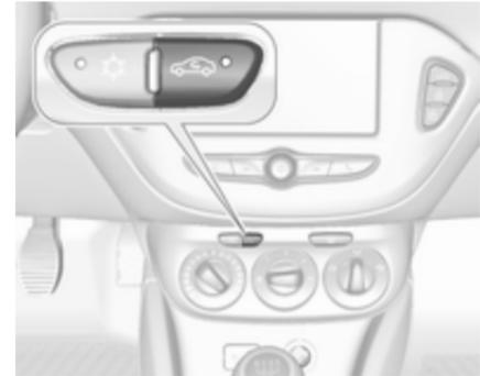
Appuyer sur ☞ pour activer le mode de recyclage de l'air. L'activation est signalée par l'éclairage de la LED dans le bouton.
