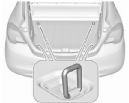
Les chargements peuvent être fixés dans le coffre par quatre anneaux d'arrimage
